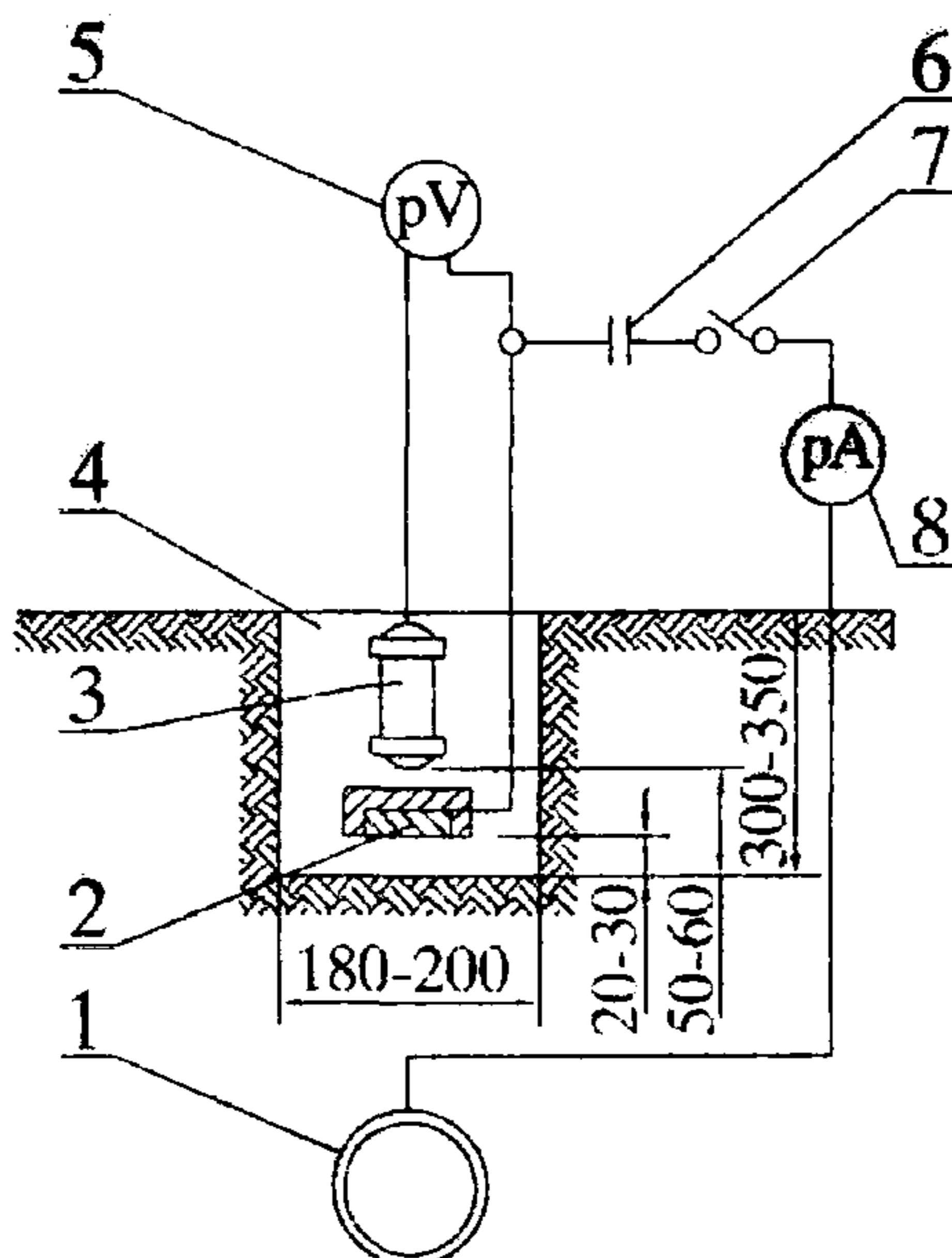
1 – трубопровод; 2 - датчик потенциала; 3 - переносной медносульфатный электрод сравнения; 4 - шурф; 5 - вольтметр постоянного тока; 6 - конденсатор; 7 - выключатель; 8 - амперметр переменного тока.
