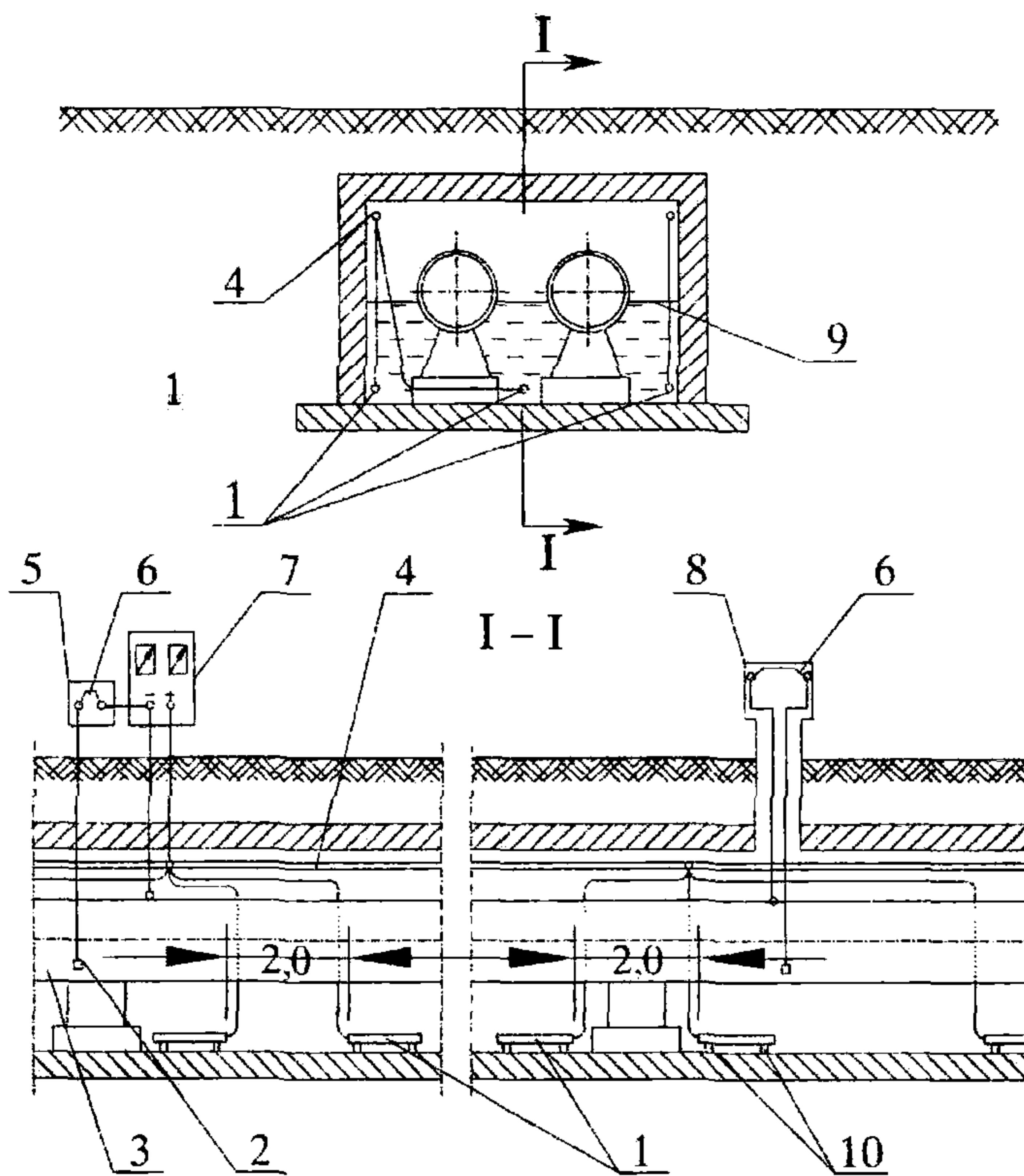
1 – электроды А3 стержневого типа\*; 2 – вспомогательный электрод; 3 – трубопровод;
