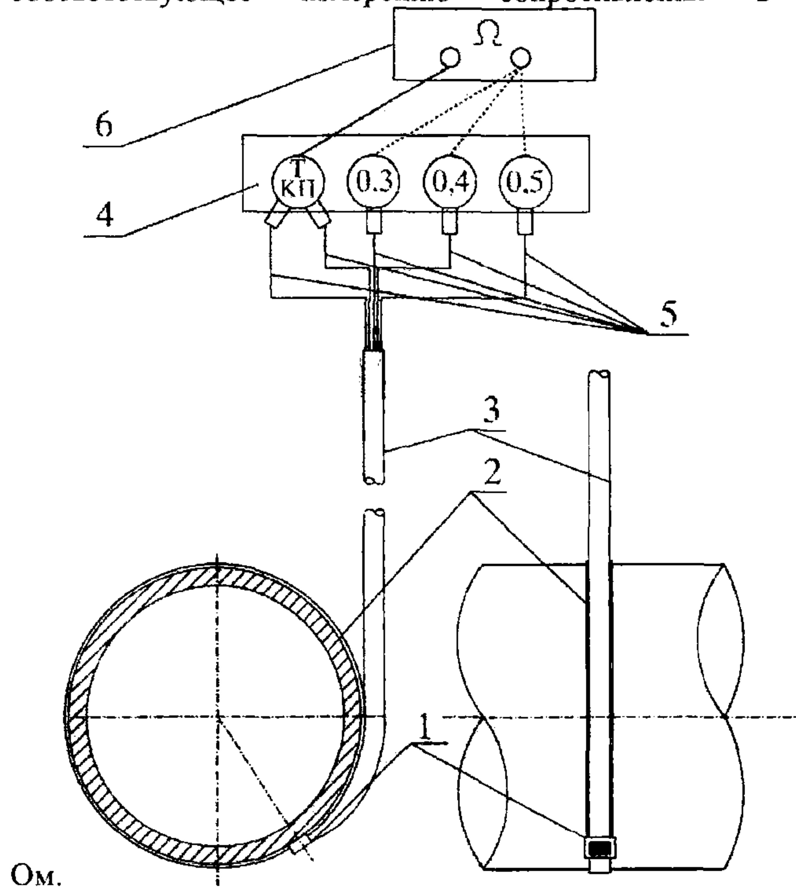
1 – блок индикаторов; 2 – крепежный хомут; 3 – защитная трубка; 4 – клеммник;
