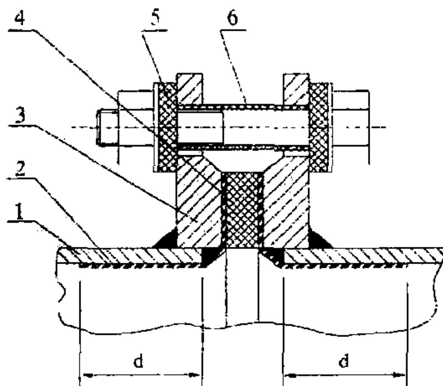
1 – труба; 2 – диэлектрическое антикоррозионное покрытие; 3 – фланец;
