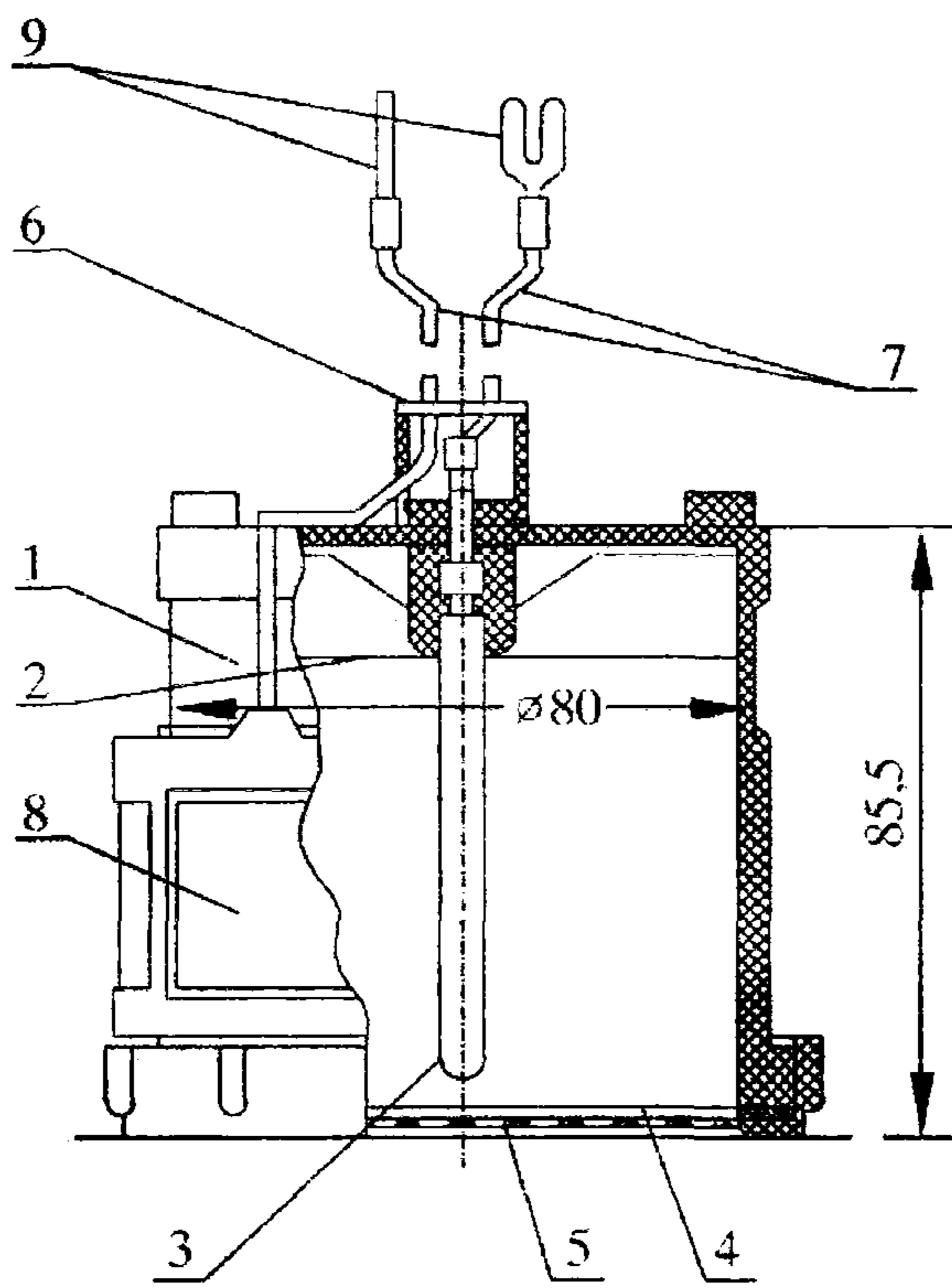
1 – корпус; 2 – электролит; 3 – стержень из красной меди; 4 – ионообменная мембрана; 5 – защитная сетка; 6 – предохранительная трубка; 7 – проводники; 8 – датчик потенциала; 9 – наконечники.
