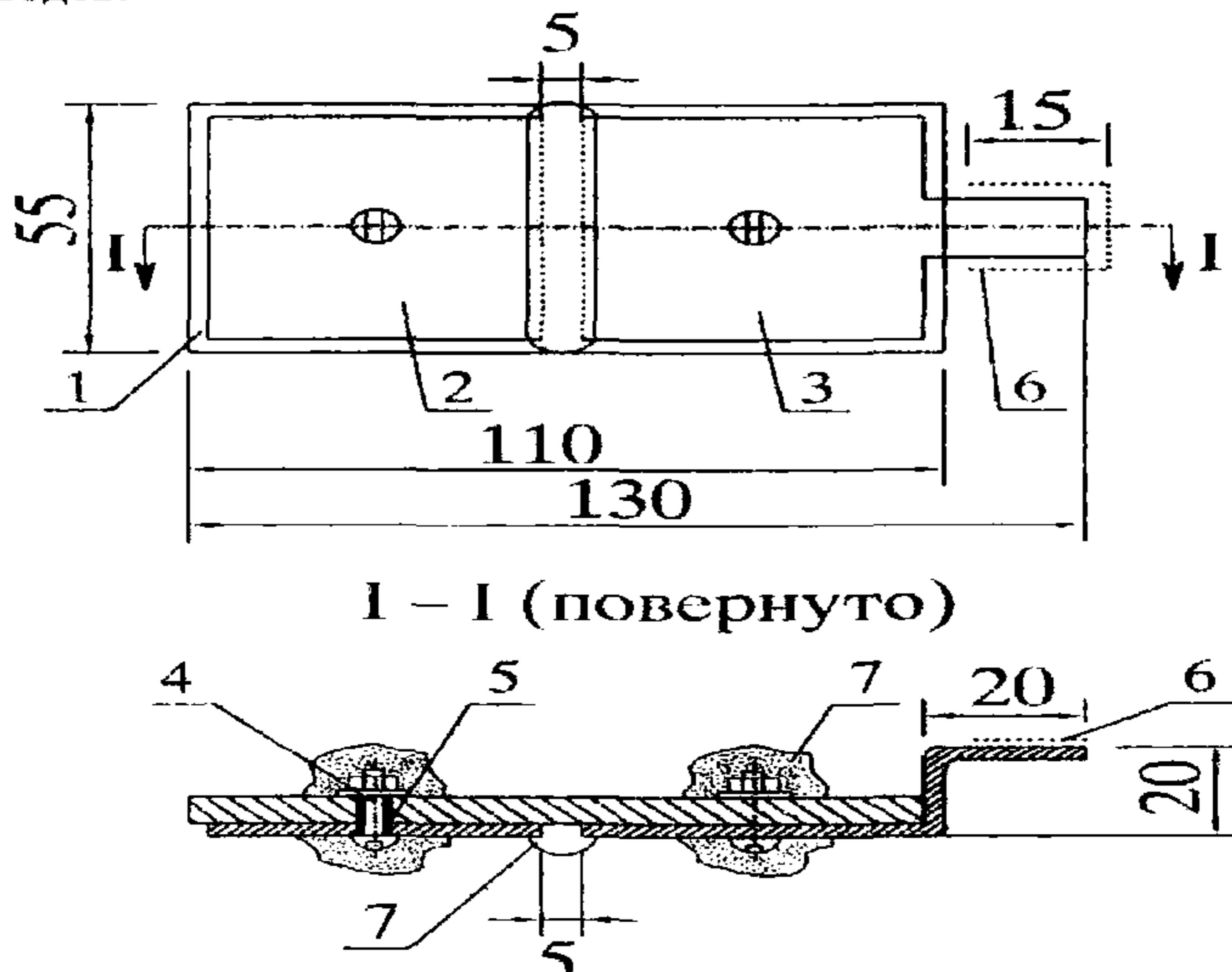
1 – монтажная диэлектрическая плата из фторопласта;
