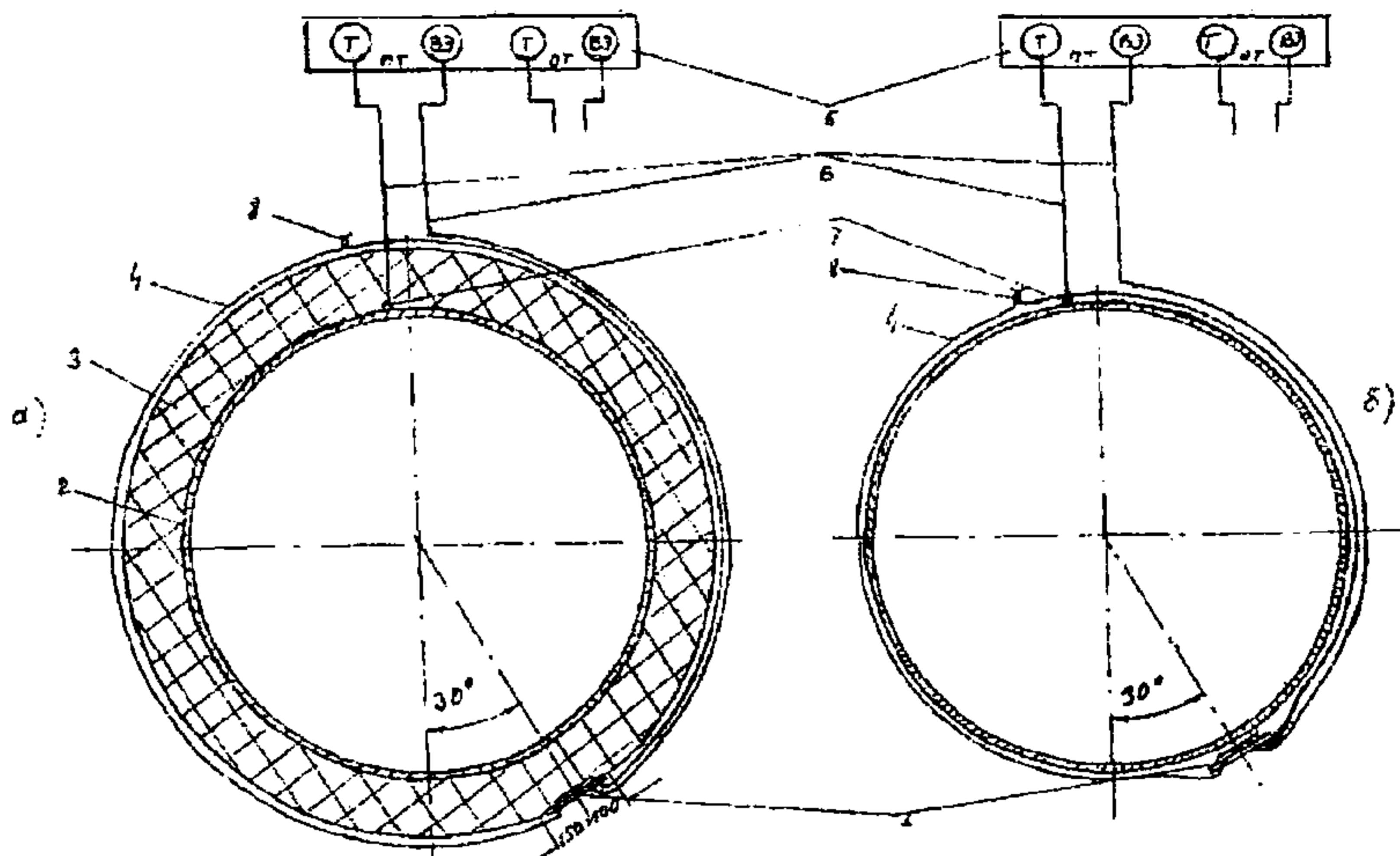
1 – вспомогательный электрод (ВЭ); 2 – трубопровод; 3 – теплоизоляция; 4 – крепежный провод ВЭ; 5 - клеммник КИПа для присоединения контрольных проводников 6 от ПТ и ОТ; в пункте установки ВЭ сетка должна быть снята на участке 100-150 мм; 7- пункт присоединения контрольного проводника 6 к трубопроводу; 8- узел соединения крепежного провода
