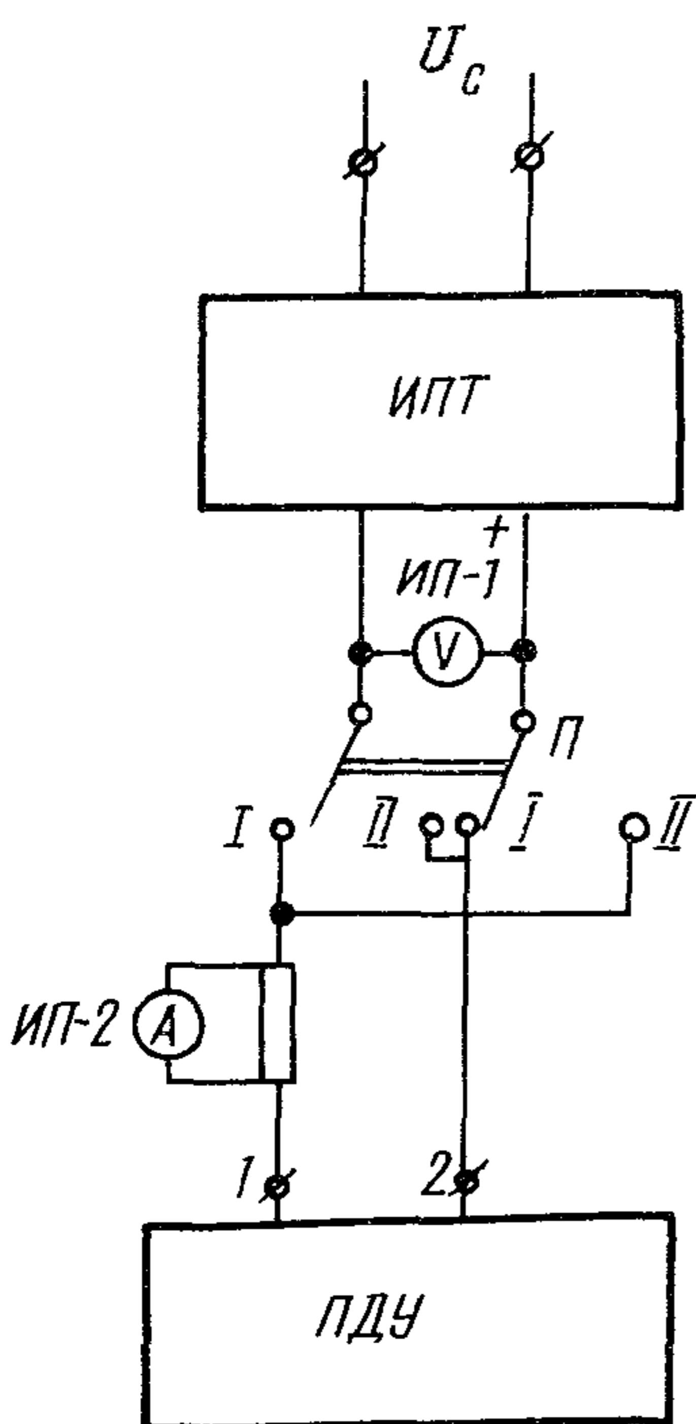
Рис.12. Схема подключения оборудования при проверке поляризованных дренажей:
