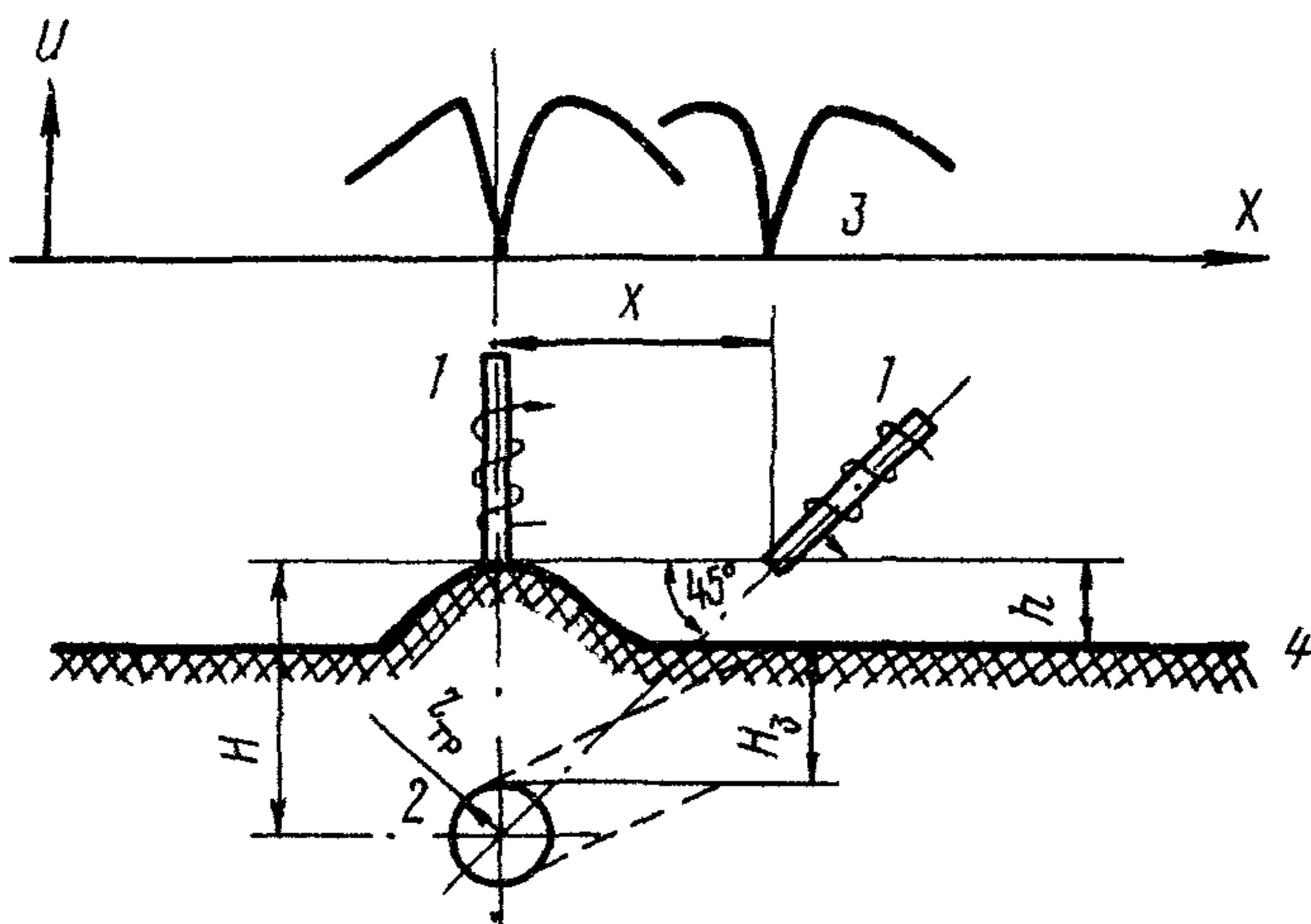
Рис.2. Определение глубины заложения трубопровода:
