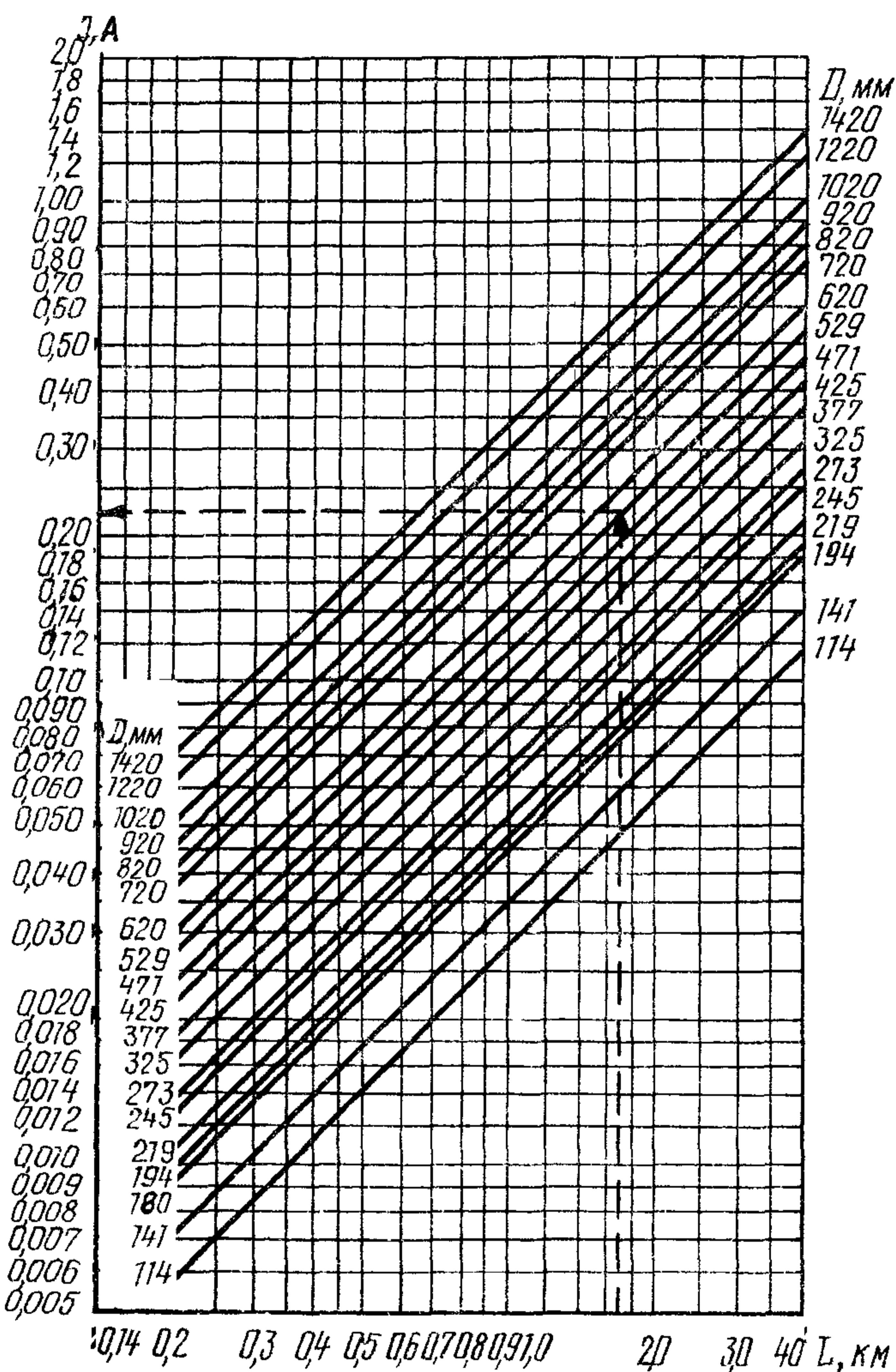
Рис.8. Номограмма определения силы тока для участков трубопровода длиной 0,2-4 км, изоляция из полимерных материалов (пример пользования номограммой для участка длиной 1,7 км, диаметром 529 мм, сила тока при контроле  $J = 1,23 \text{ A}$ )
