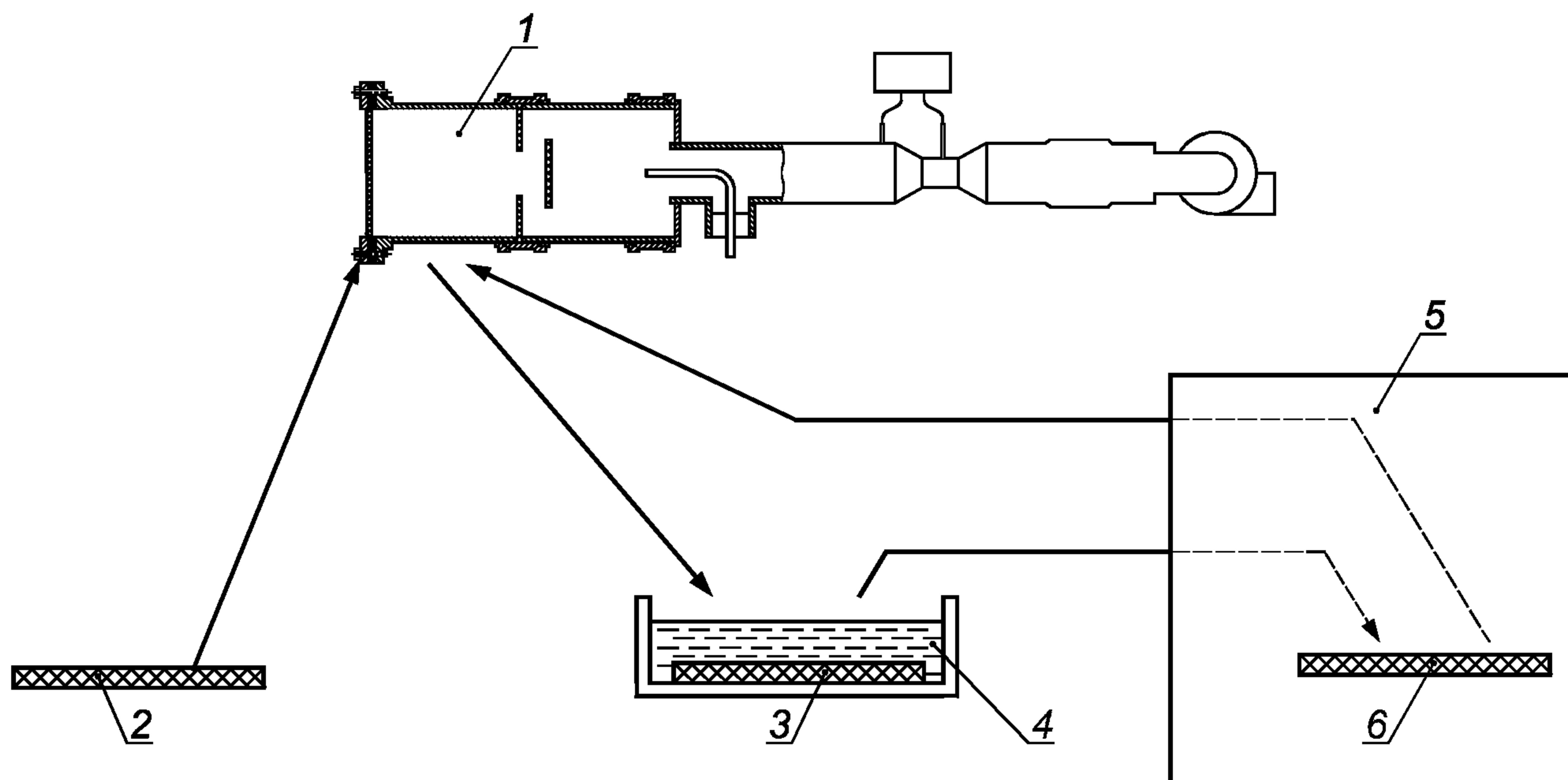
1 — устройства для измерения эффективности; 2 — образец фильтрующего материала; 3 — обработка изопропанолом;
