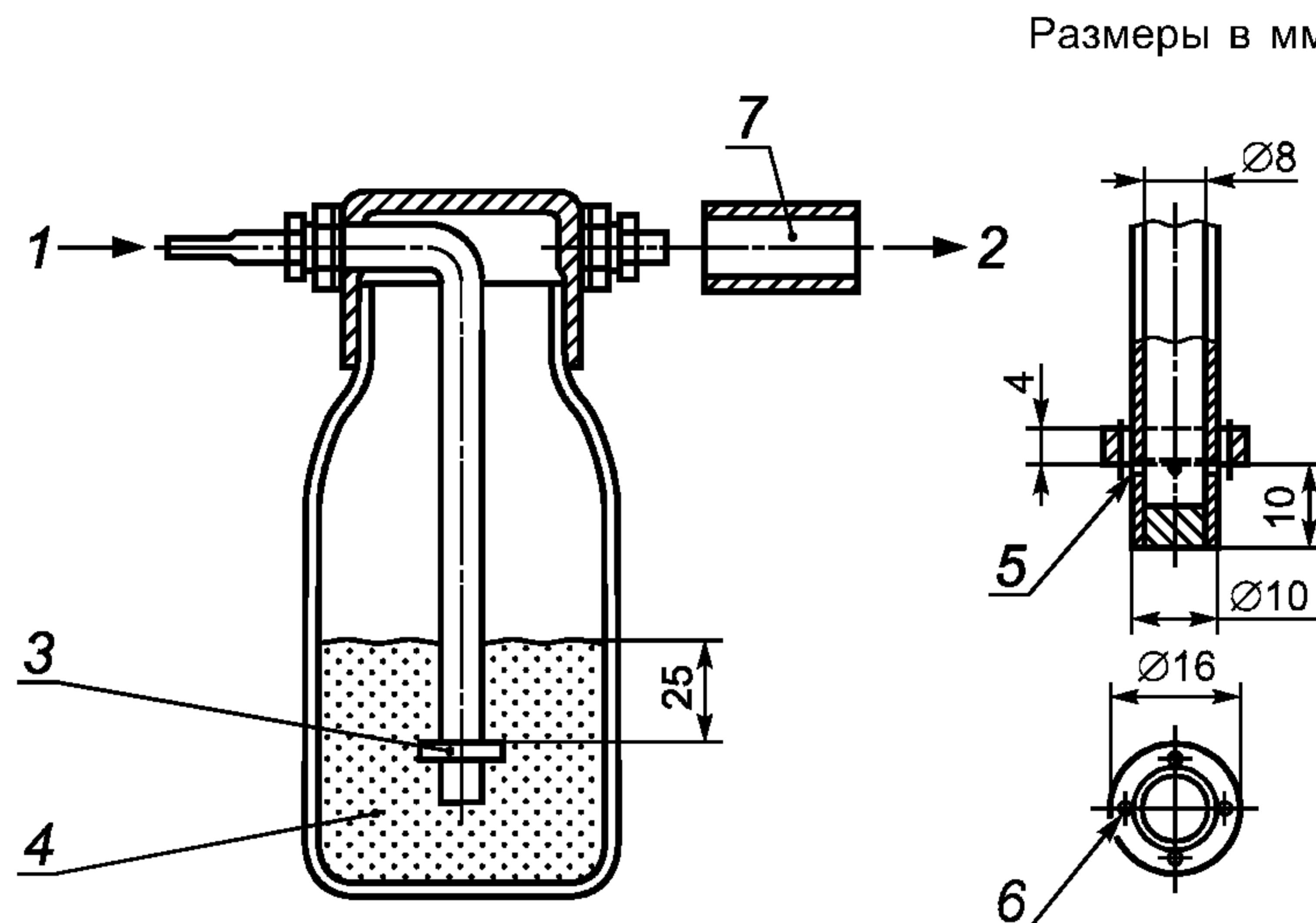
1 — воздух не содержащий частиц (давление около 17 кПа); 2 — направление подачи аэрозоля в испытательный стенд; 3 — распылитель Ласкина; 4 — контрольный аэрозоль (например, DEHS); 5 — четыре отверстия  $\varnothing 1,0$  мм, причем кромка отверстия имеет верхний угол  $90^\circ$  и слегка касается нижней части воротника; 6 — четыре отверстия  $\varnothing 2,0$  мм непосредственно после трубки в линию с радиальными отверстиями; 7 - нейтрализатор
