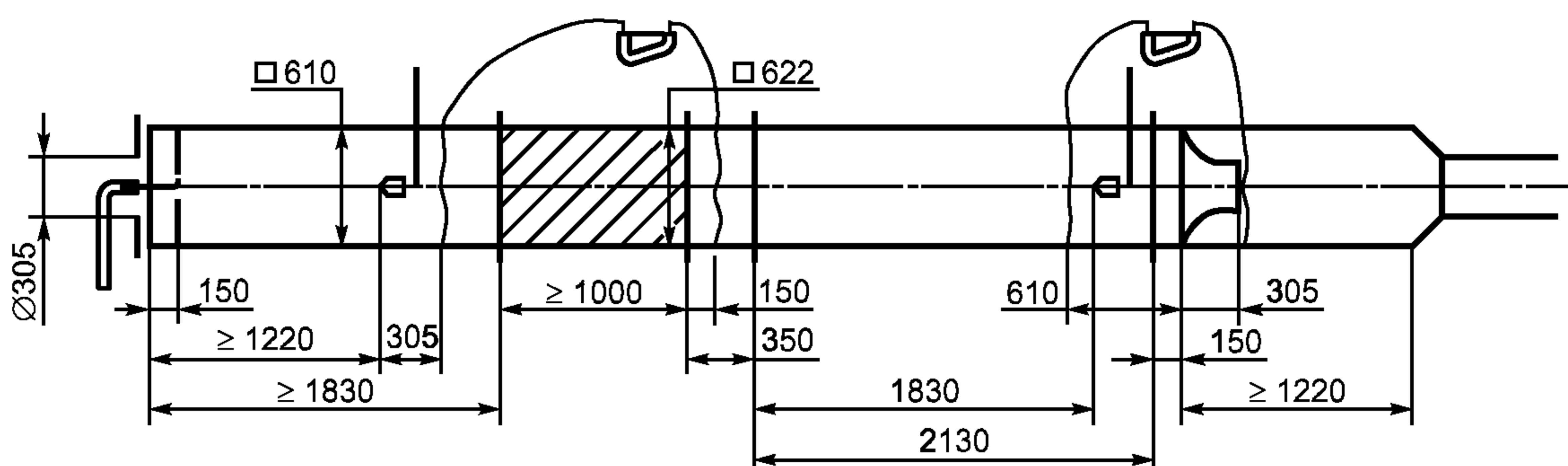
Рисунок 2 — Размеры испытательного стенда
