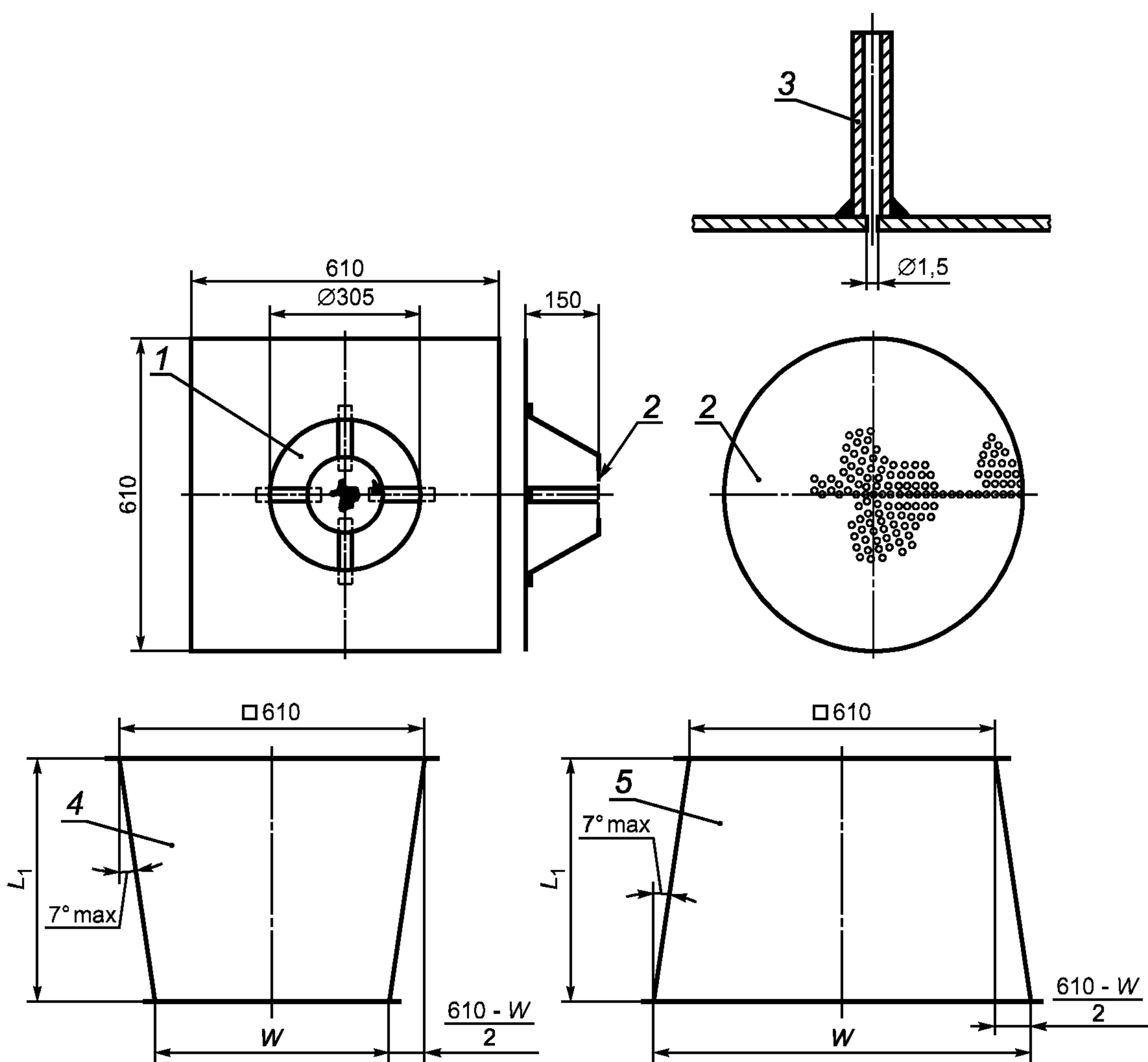
1 — смещающее отверстие; 2 — перфорированная пластина Ж152 ± 2 мм, отверстия занимают 40 % площади; 3 — отвод для измерения давления; 4 — переходной элемент воздуховода (фильтр меньше сечения воздуховода); 5 — переходной элемент воздуховода (фильтр больше сечения воздуховода)
