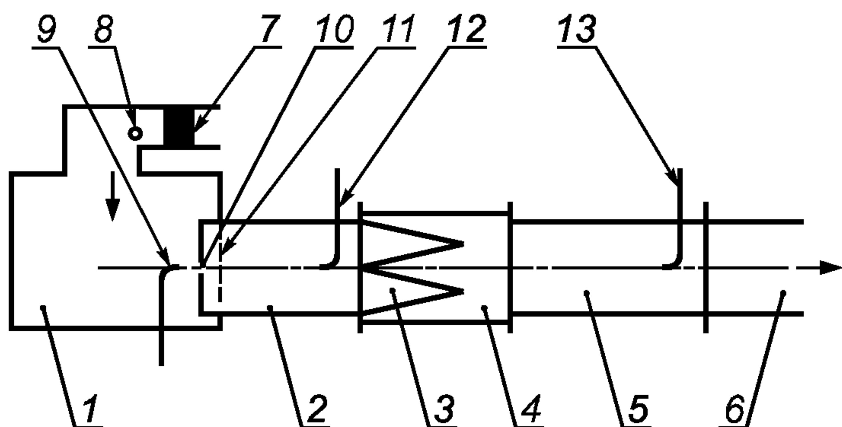
Воздуховод должен быть выполнен из электропроводного материала, должен быть заземлен, иметь гладкие внутренние поверхности и быть достаточно жестким, чтобы сохранять свою форму при воздействии давления в процессе эксплуатации. Небольшие части воздуховодов могут быть изготовлены из стекла или пластмассы для удобства обзора фильтра и оборудования. Рекомендуется предусматривать смотровые окна для наблюдения за ходом испытаний.
