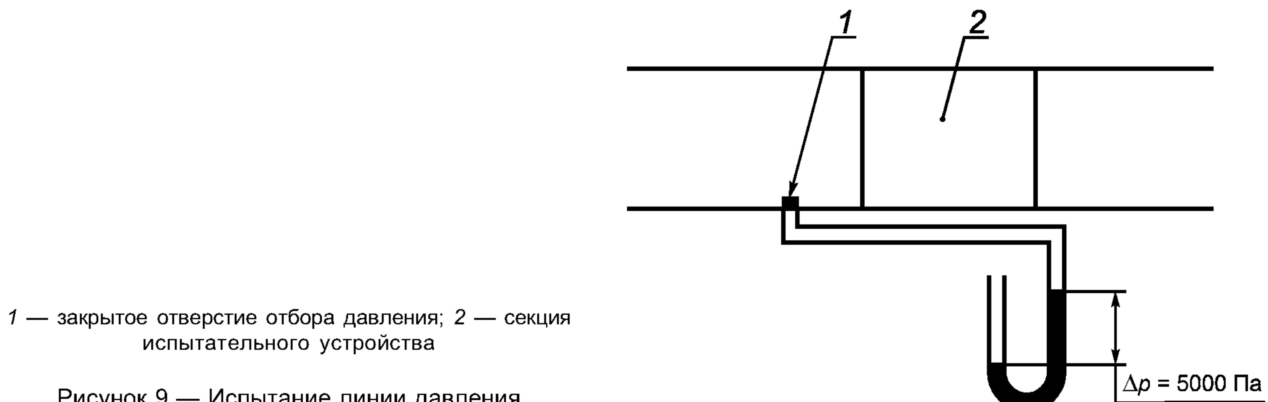
Рисунок 9 — Испытание линии давления
