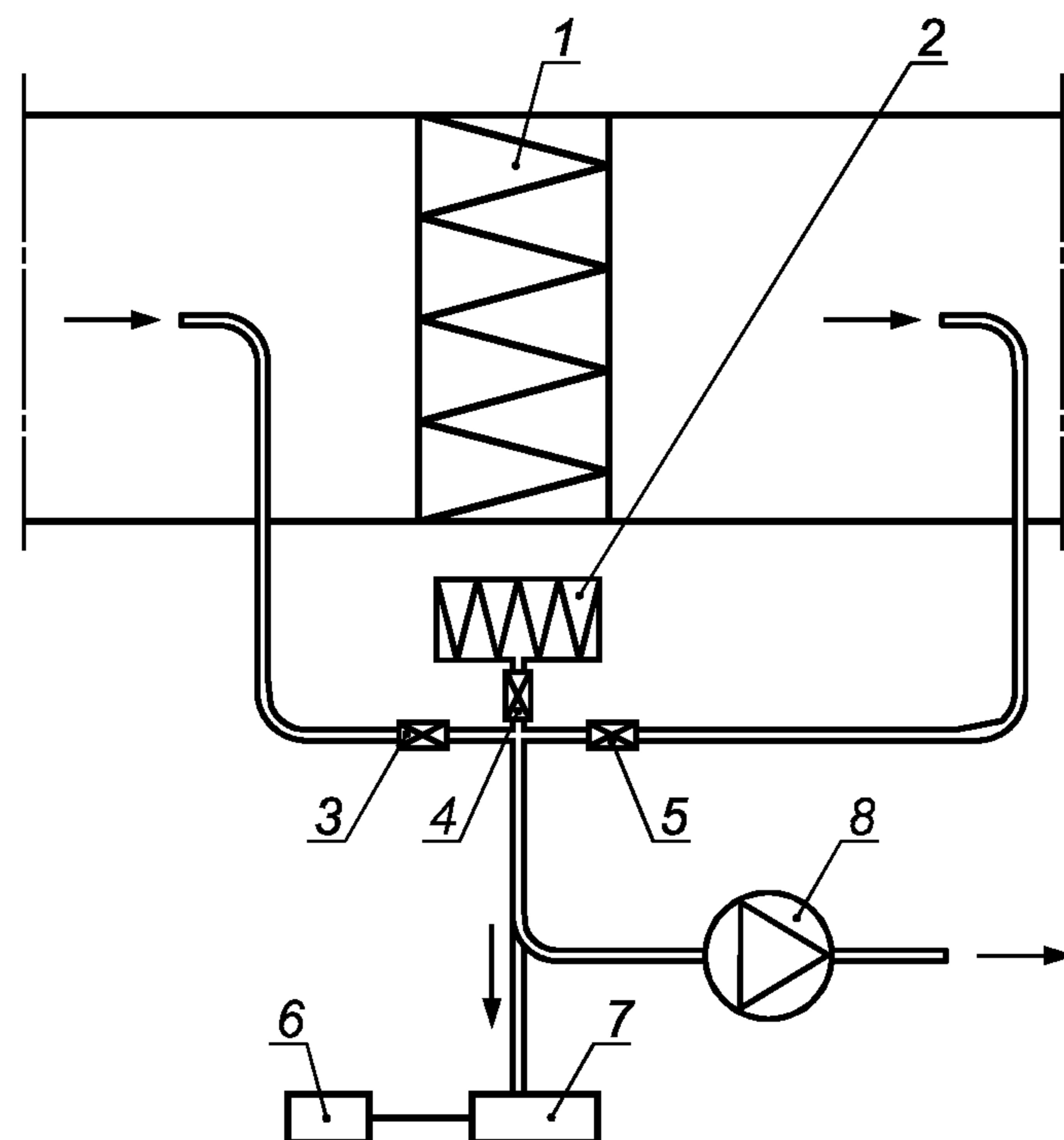
1 — фильтр; 2 — НЕРА-фильтр (чистый воздух); 3 — клапан до фильтра; 4 — клапан чистого воздуха; 5 — клапан после фильтра; 6 — компьютер; 7 — счетчик частиц; 8 — насос
