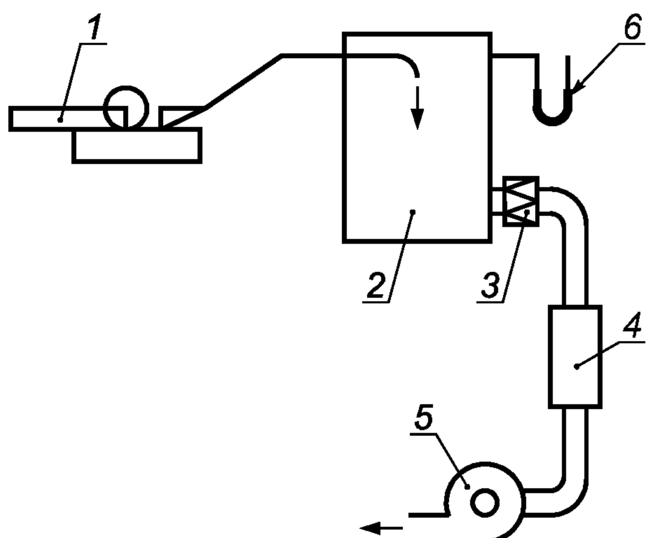
1 — генератор пыли; 2 — емкость объемом не менее 0,25 м<sup>3</sup>; 3 — НЕРА-фильтр; 4 — устройство, измеряющее расход воздуха; 5 — вентилятор; 6 — устройство для измерения перепада давления (перепад давления должен быть равен нулю)
