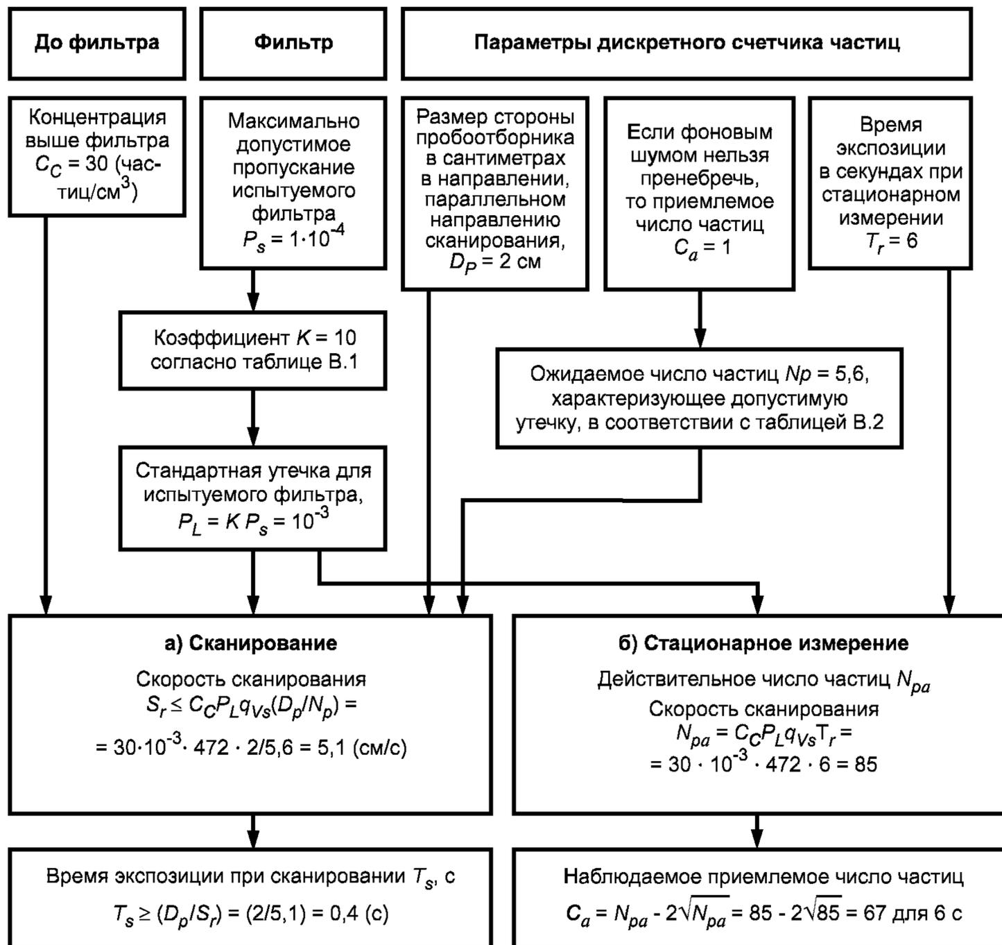
Рисунок В.3 — Схема проведения предварительных расчетов
