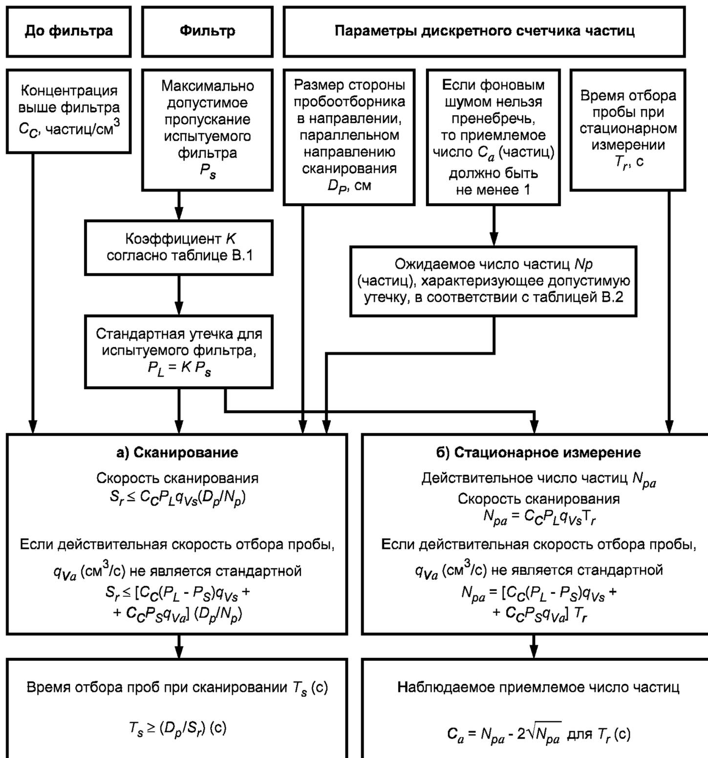
Рисунок В.2 — Схема проведения предварительной оценки
