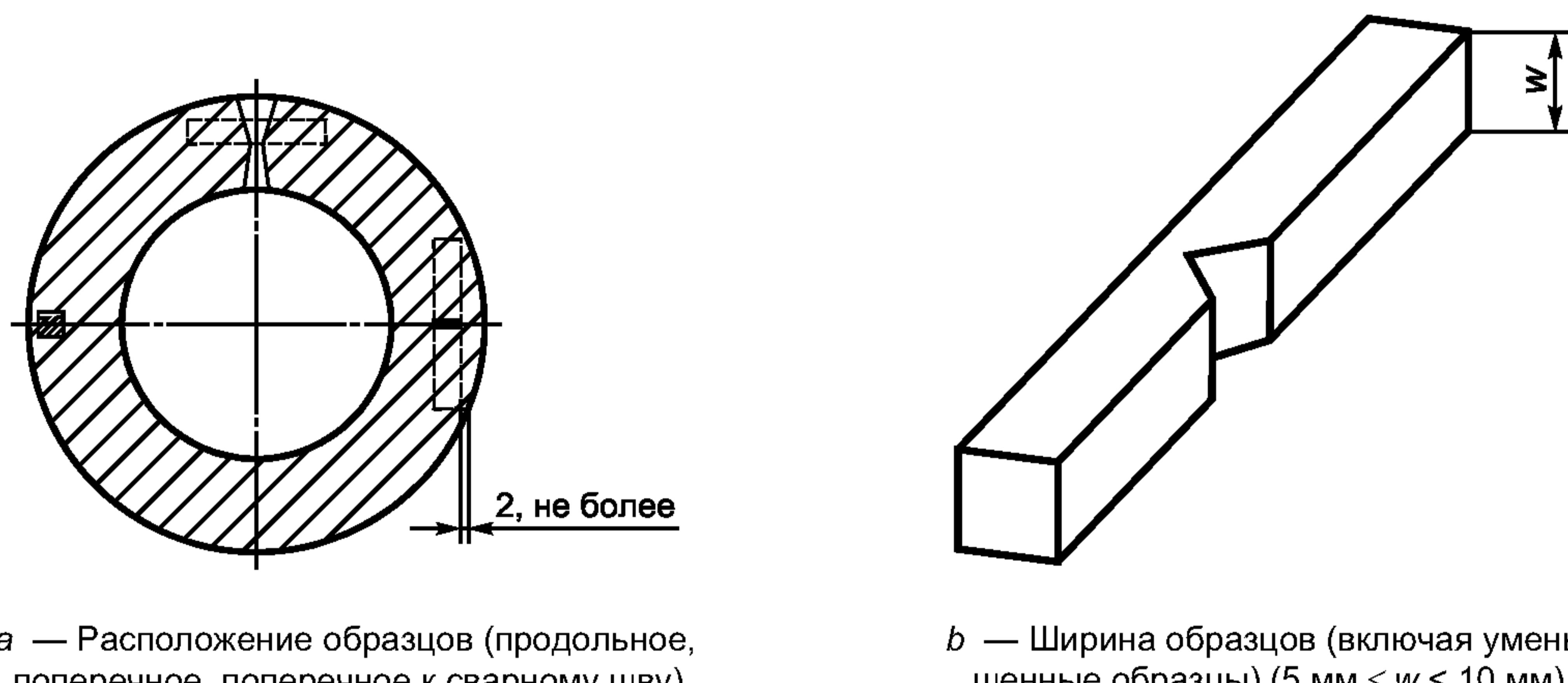
а — Расположение образцов (продольное, поперечное, поперечное к сварному шву)
