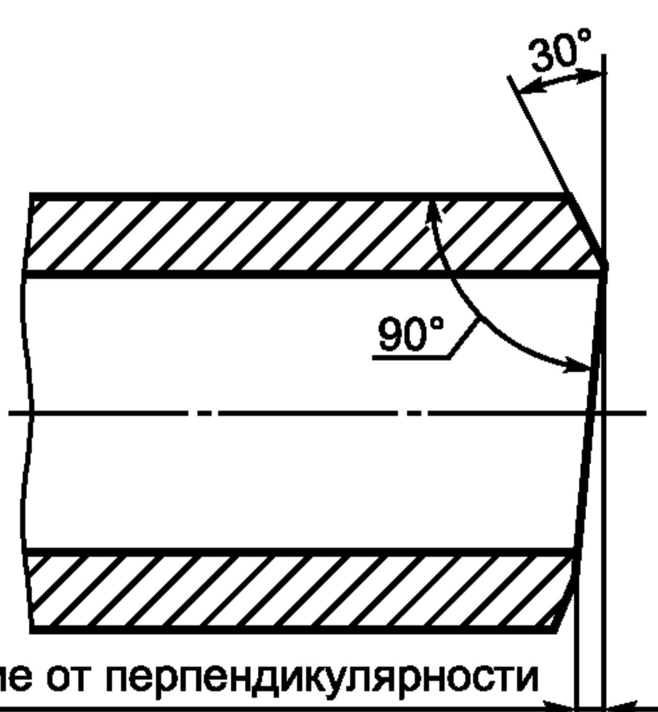
Если выполняют внутренний конус расточкой или шлифованием, угол внутреннего конуса, измеряемый от продольной оси, не должен превышать:
