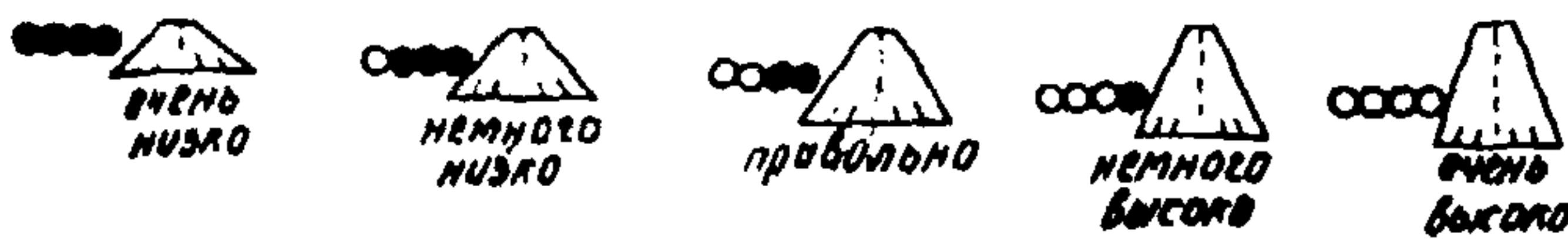
Схема расположения огней системы РАРТ и распределение углов возвышения огней (угол захода на посадку 2°40')
