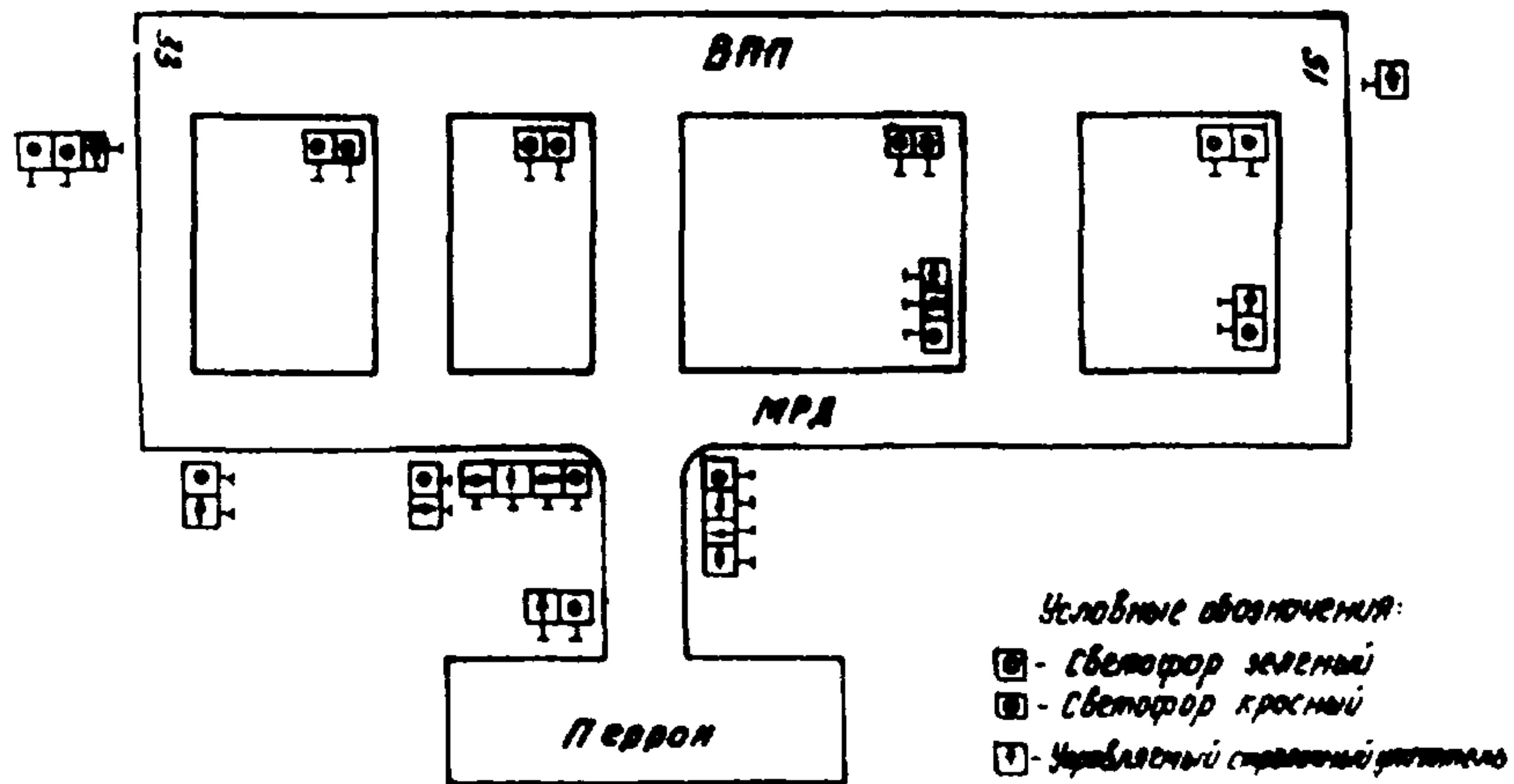
Рис. 12. Пример размещения управляемых световых указателей
