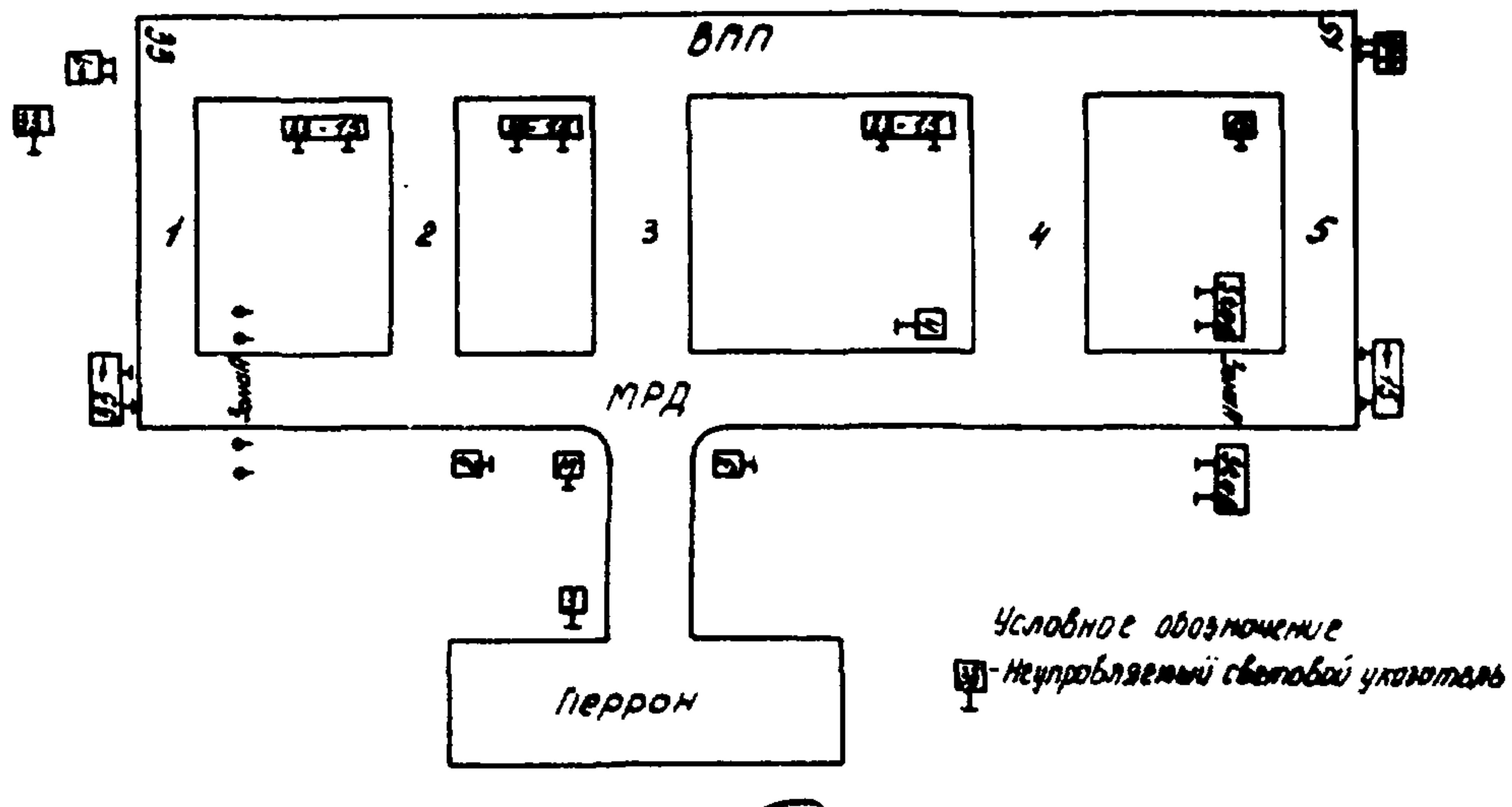
Рис. II. Пример размещения неуправляемых световых указателей; зона А обозначается красными огнями кругового обзора
