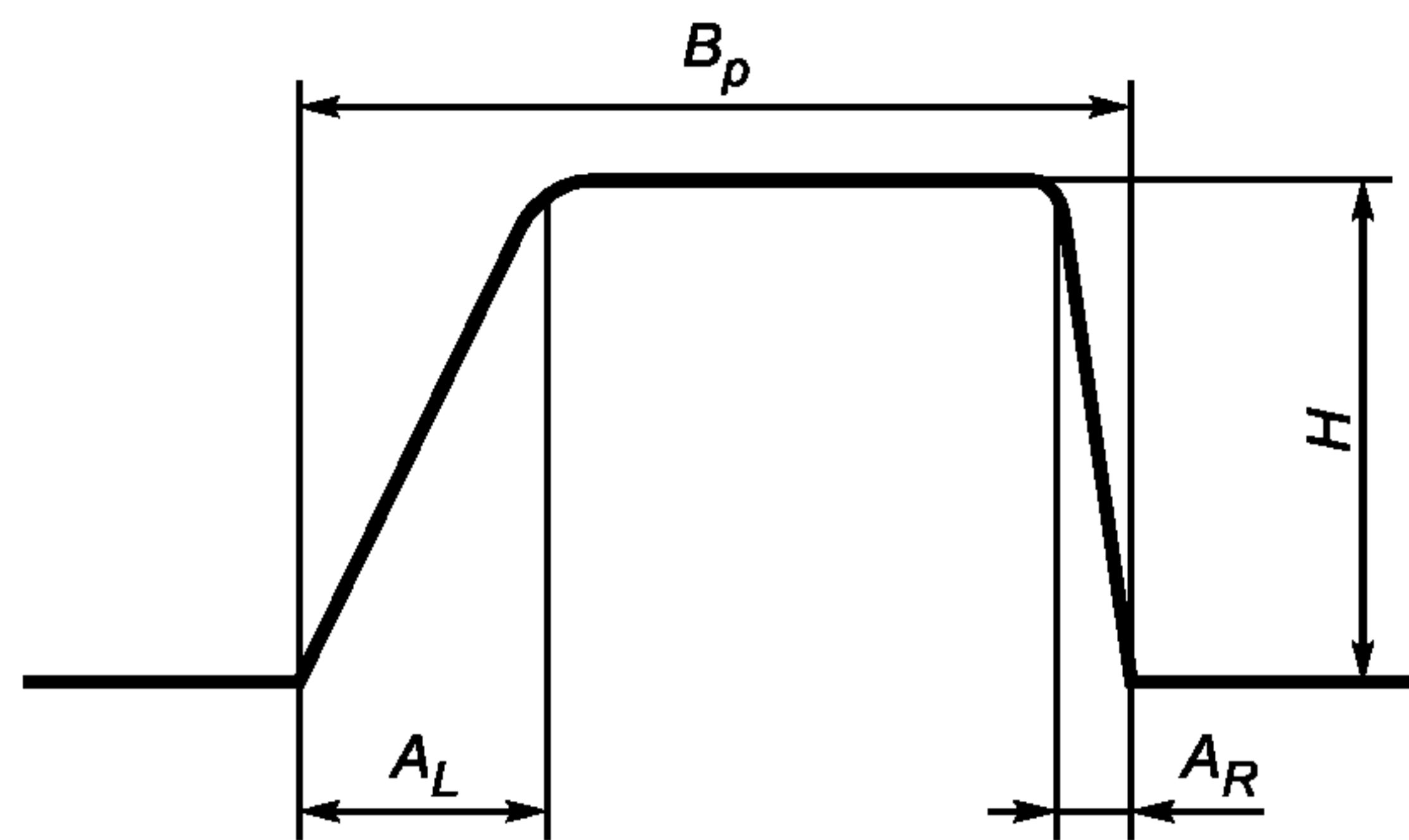
Рисунок 2 — Видеопрофиль (направление сканирования слева направо)
