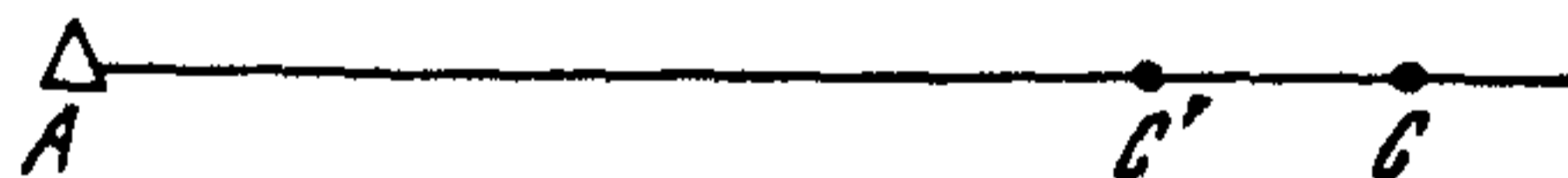
Рис. 15. Вынос в натуру длины линии способом редуцирования
