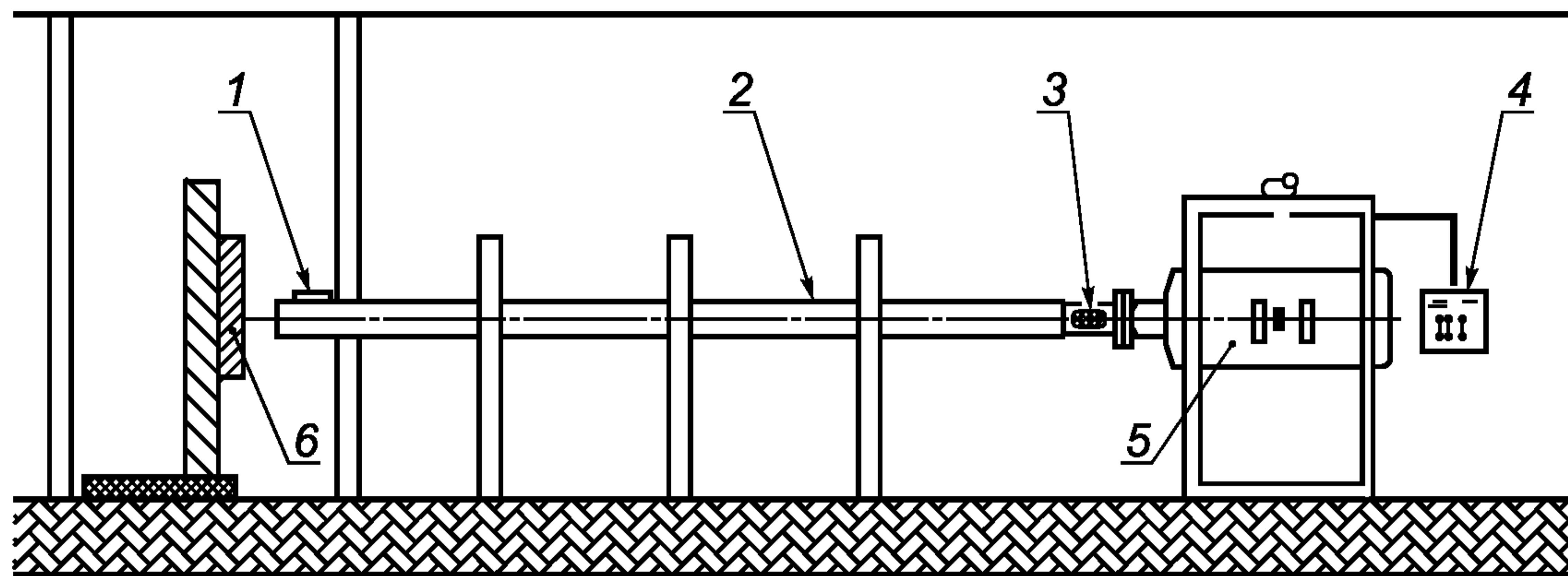
1 — измеритель скорости; 2 — ствол; 3 — перемещаемый снаряд; 4 — пульт управления; 5 — баллон сжатого воздуха;
