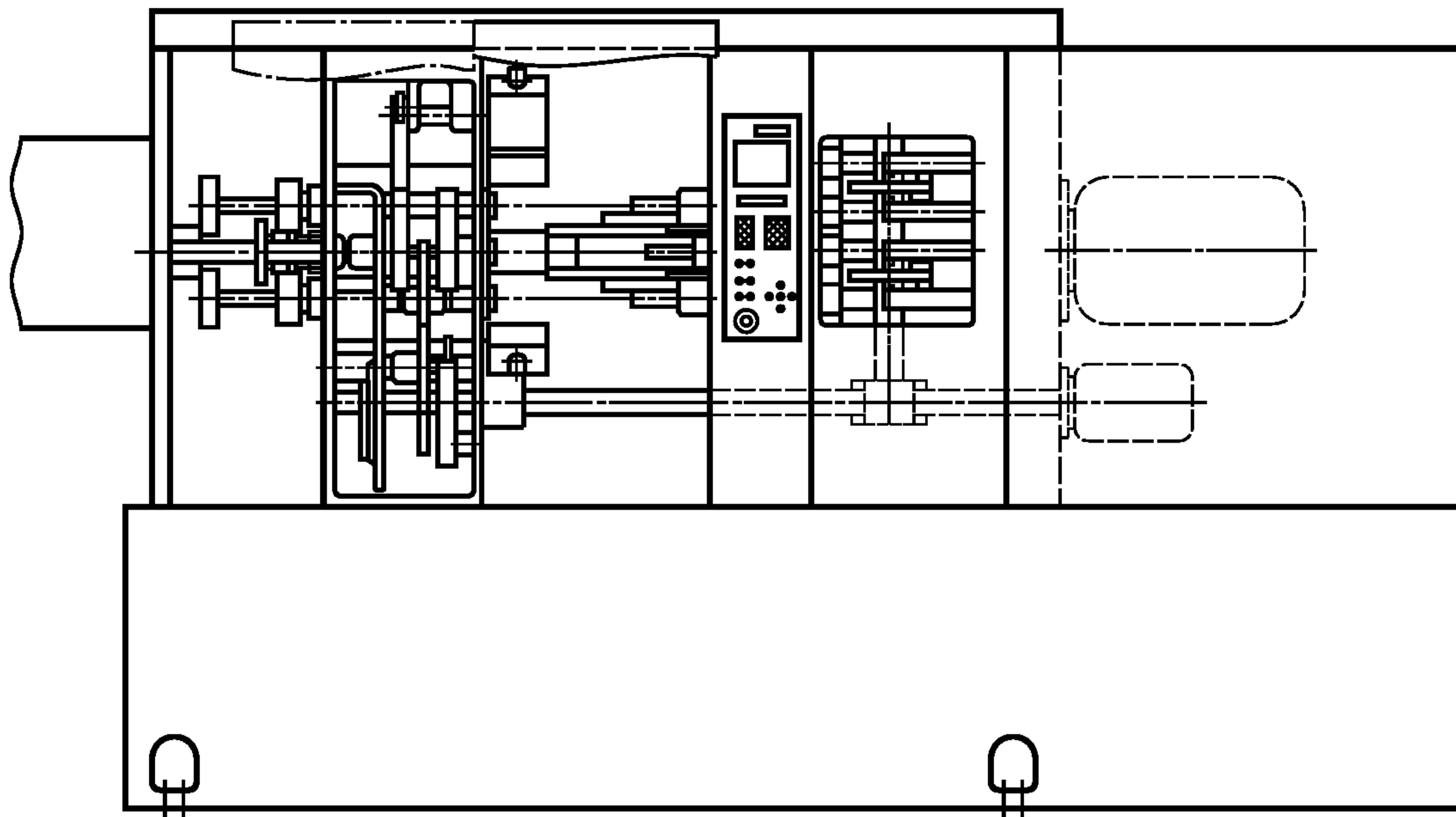
б) Пример многошпиндельного пруткового кулачкового токарного автомата
