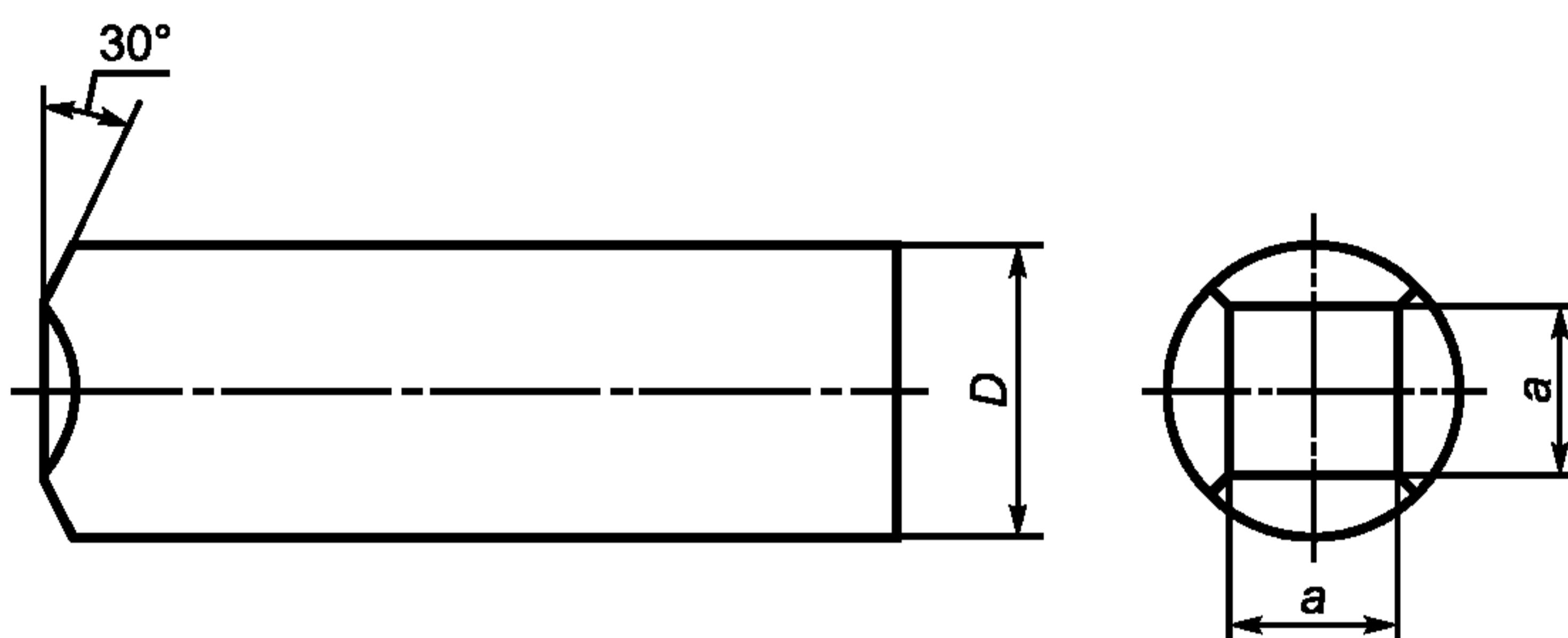
Закалить до  $56^{+4}$  HRC с минимальной глубиной закалки 0,5 мм.
