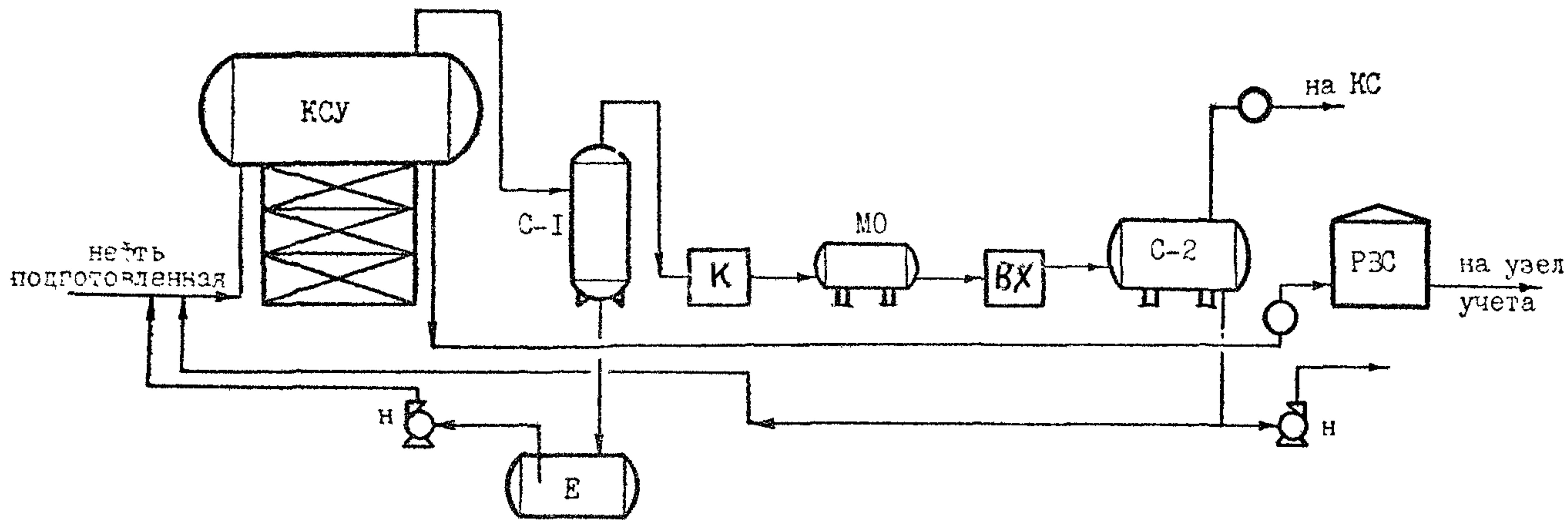
КСУ - концевая сепарационная установка; С-1, С-2 - газосепараторы;
