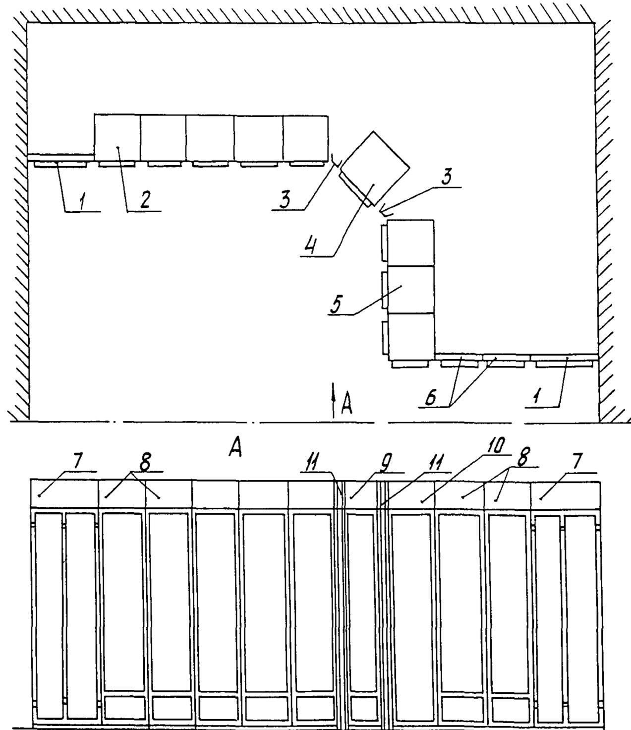
1- панель вспомогательная с дверью ПнВ-д; 2- щит панельный с каркасом ЩПК-Т-600; 3- вставка угловая ВУ-45;
