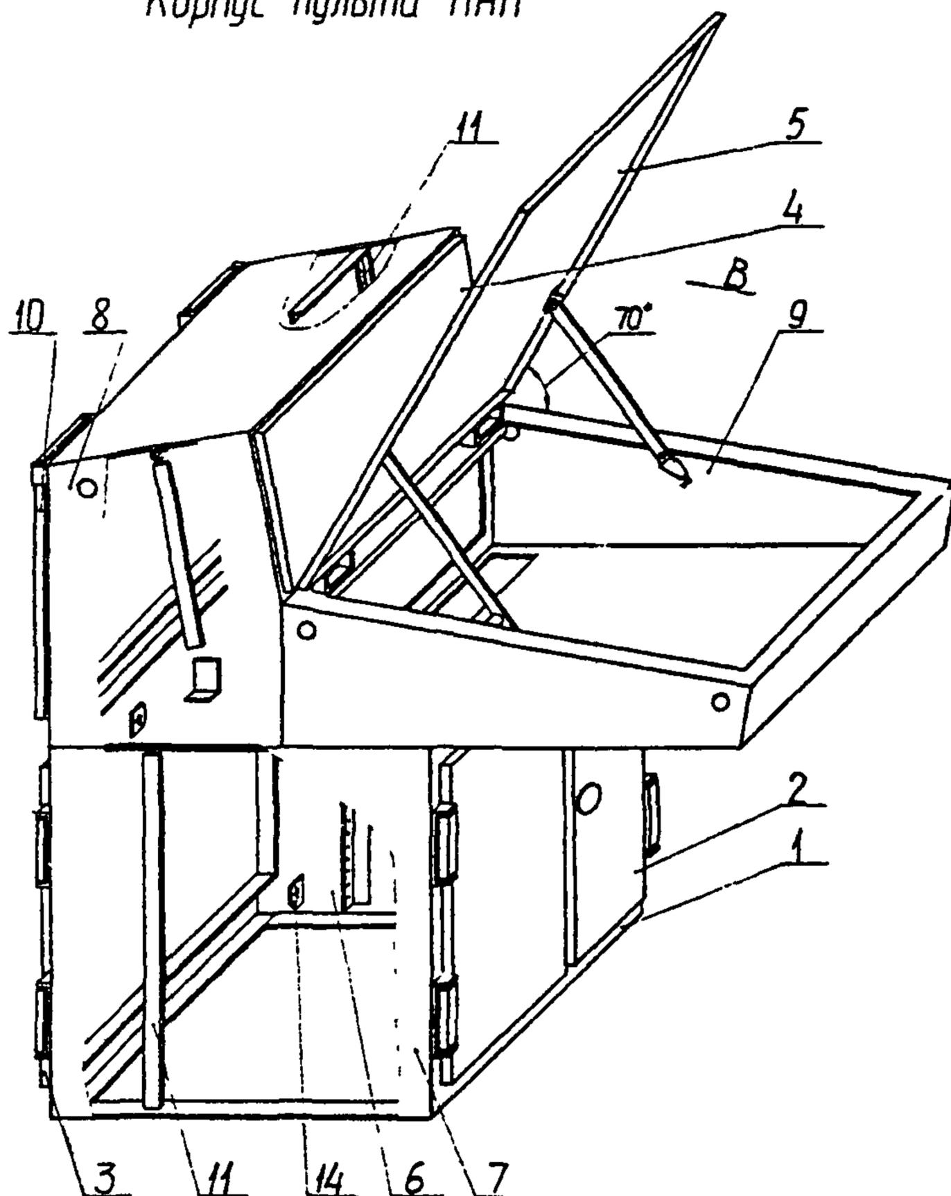
1-каркас; 2,3-двери; 4-панель; 5-панель (столешница);
