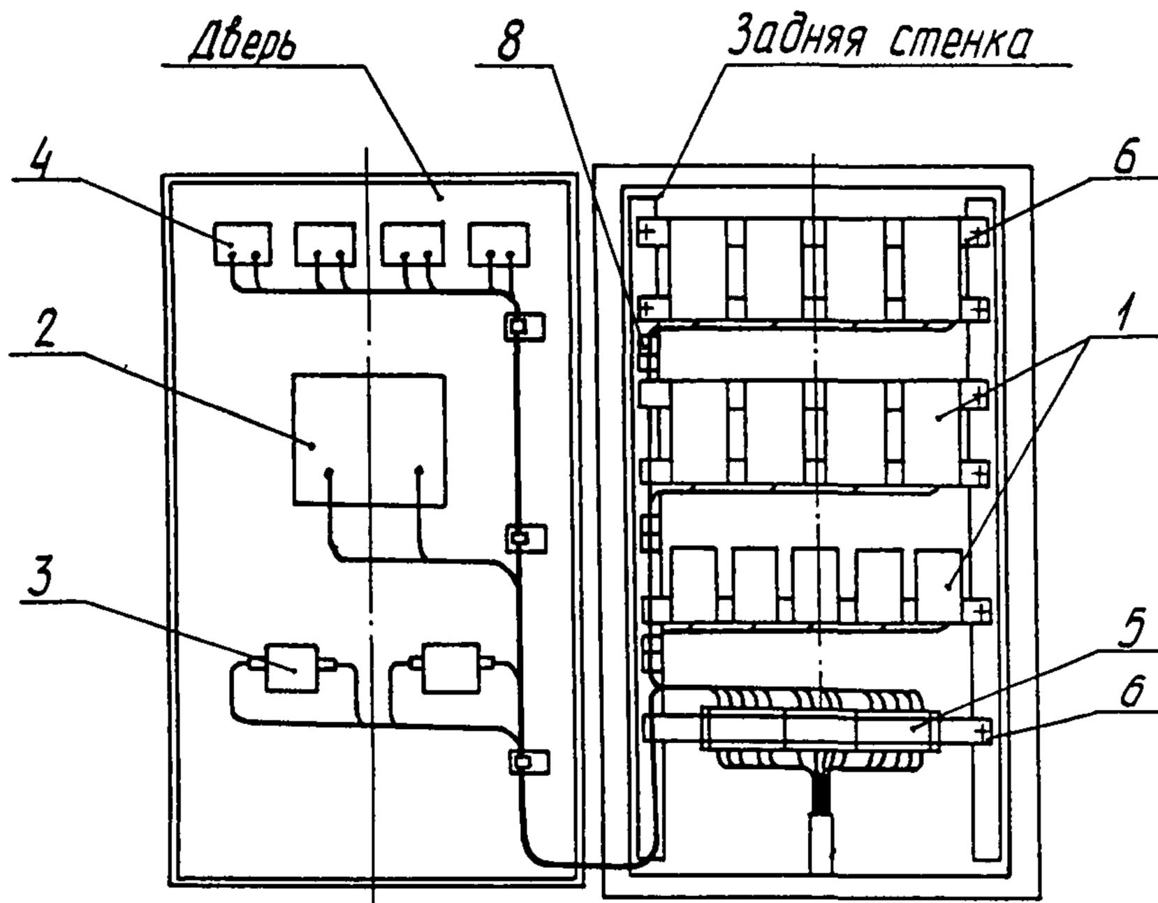
1-реле; 2-автоматический выключатель; 3-переключатель; 4-табло световое; 5-блок зажимов; 6-угольник; 7-угольник У32; 8-кронштейн К51; 9-кронштейн К100; 10-скоба СО; 11-лента К226 с кнопкой К227
