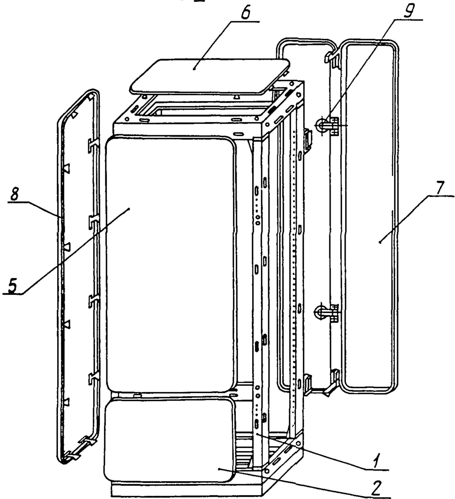
1-каркас; 2,3,4,5-панели; 6-крышка; 7-дверь;
