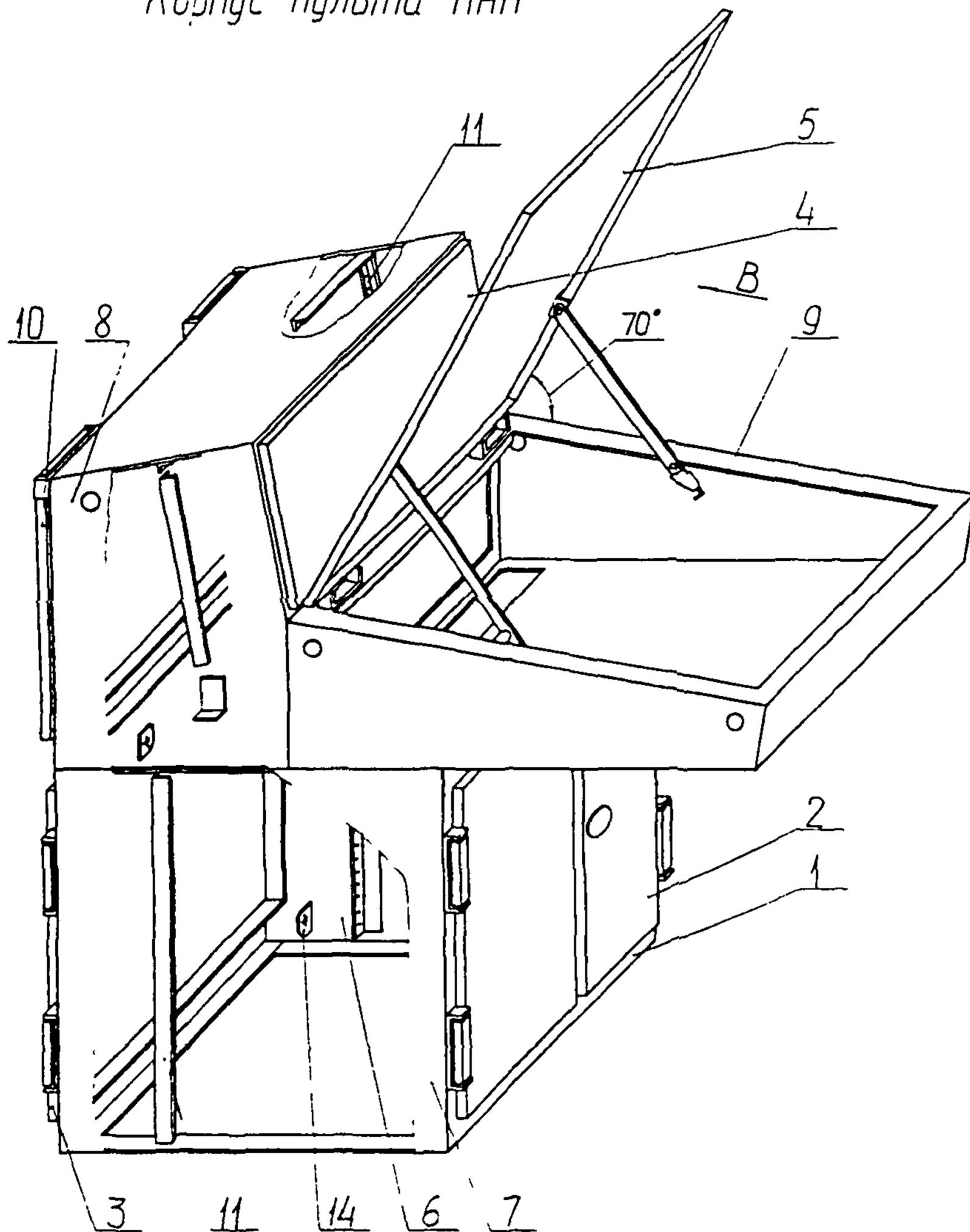
1-каркас; 2,3-двери; 4-панель; 5-панель (столешница),
