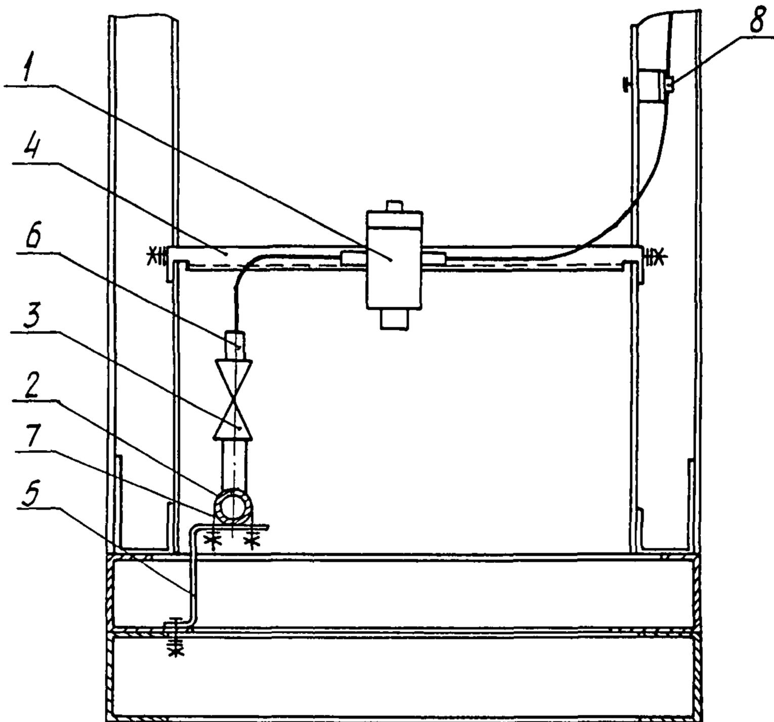
1-редуктор давления с фильтром РДФ-3; 2-коллектор;
