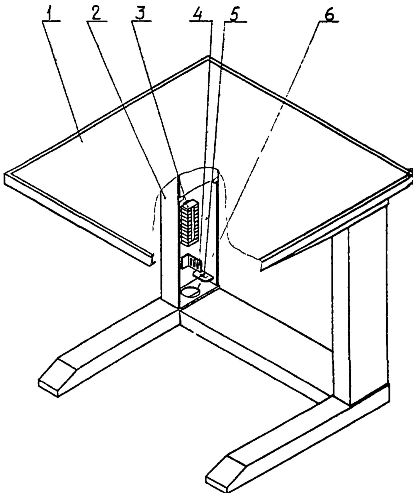
1-столешница , 2-каркас , 3-блок зажимов Б324 ;
