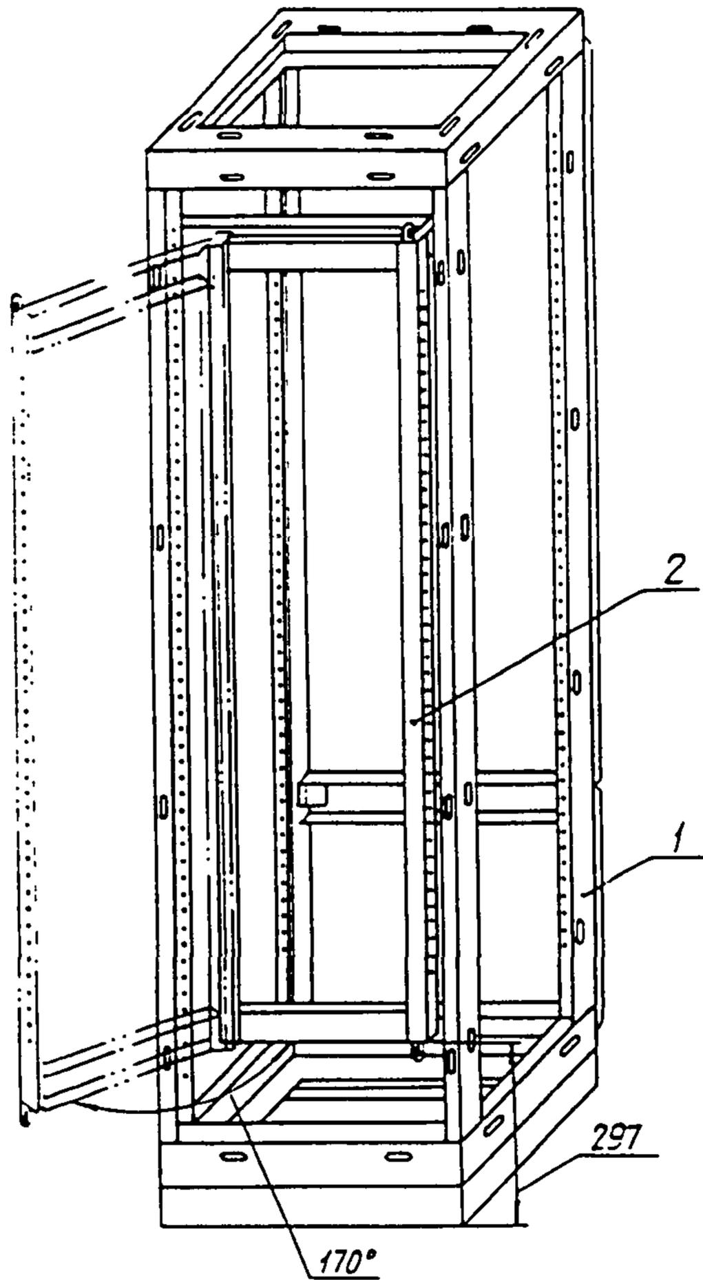
*1- панель с каркасом; 2-рама поворотная*
