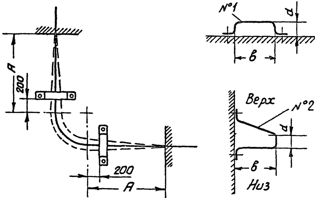
Размер "а" скобы выбирается по наружному диаметру трубы.
