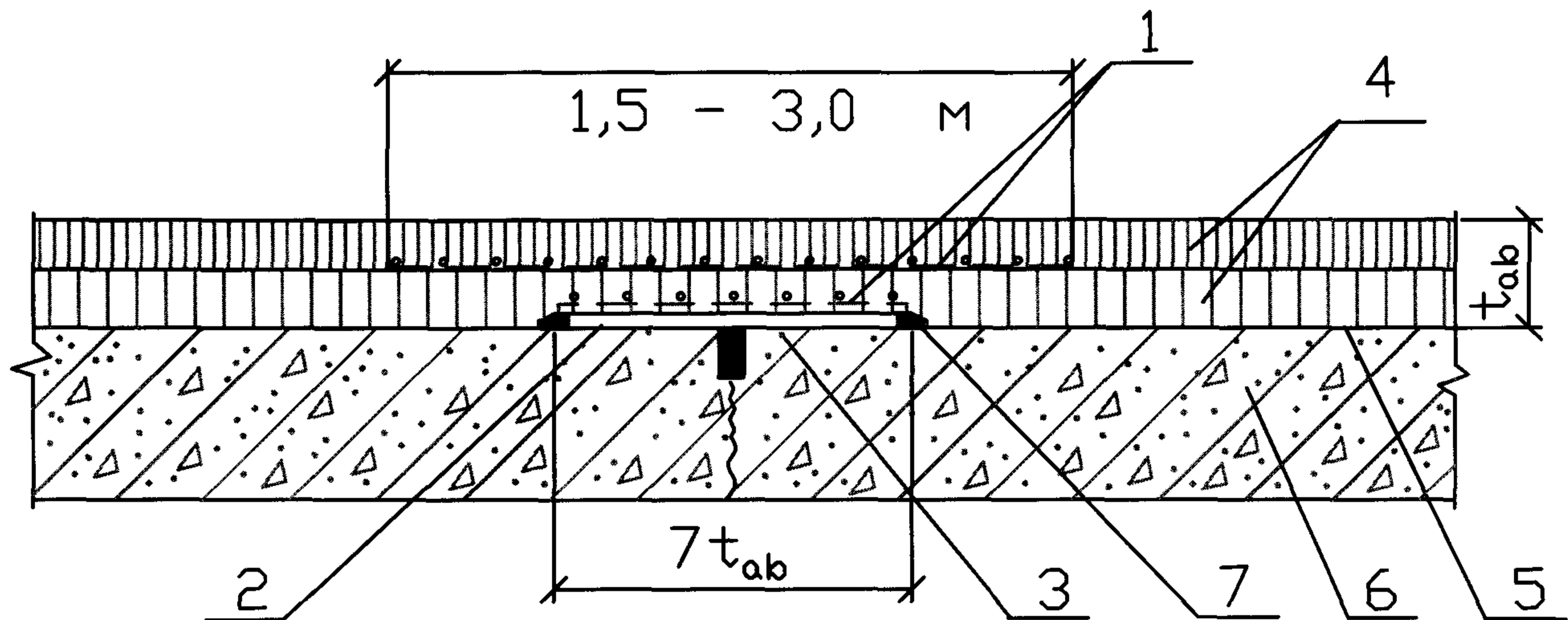
Рис.3.3 Конструкция армирования двухслойного асфальтобетона геосетками ССНП над швом жесткого покрытия
