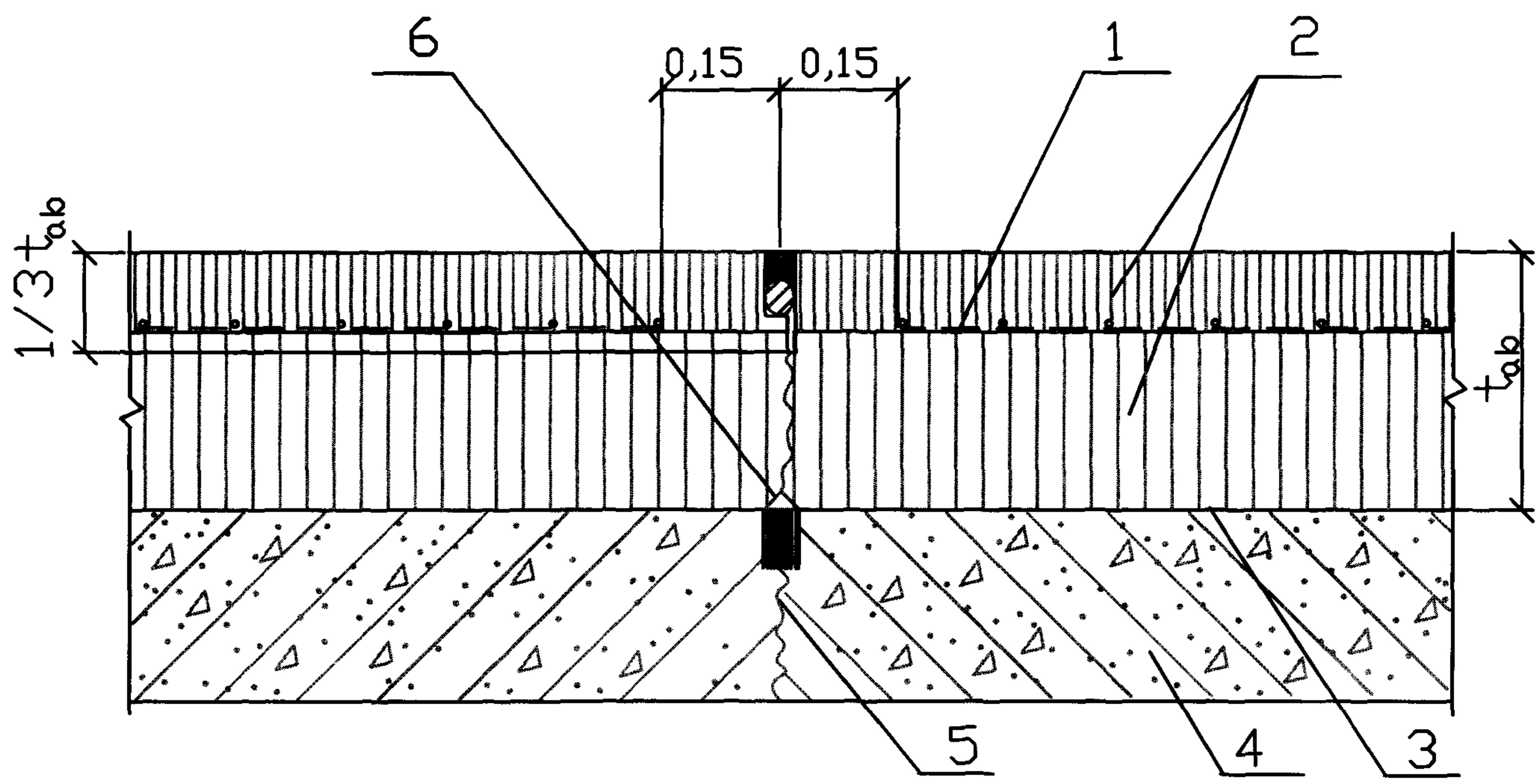
Рис.3.4 Деформационный шов в двухслойном асфальтобетонном покрытии
