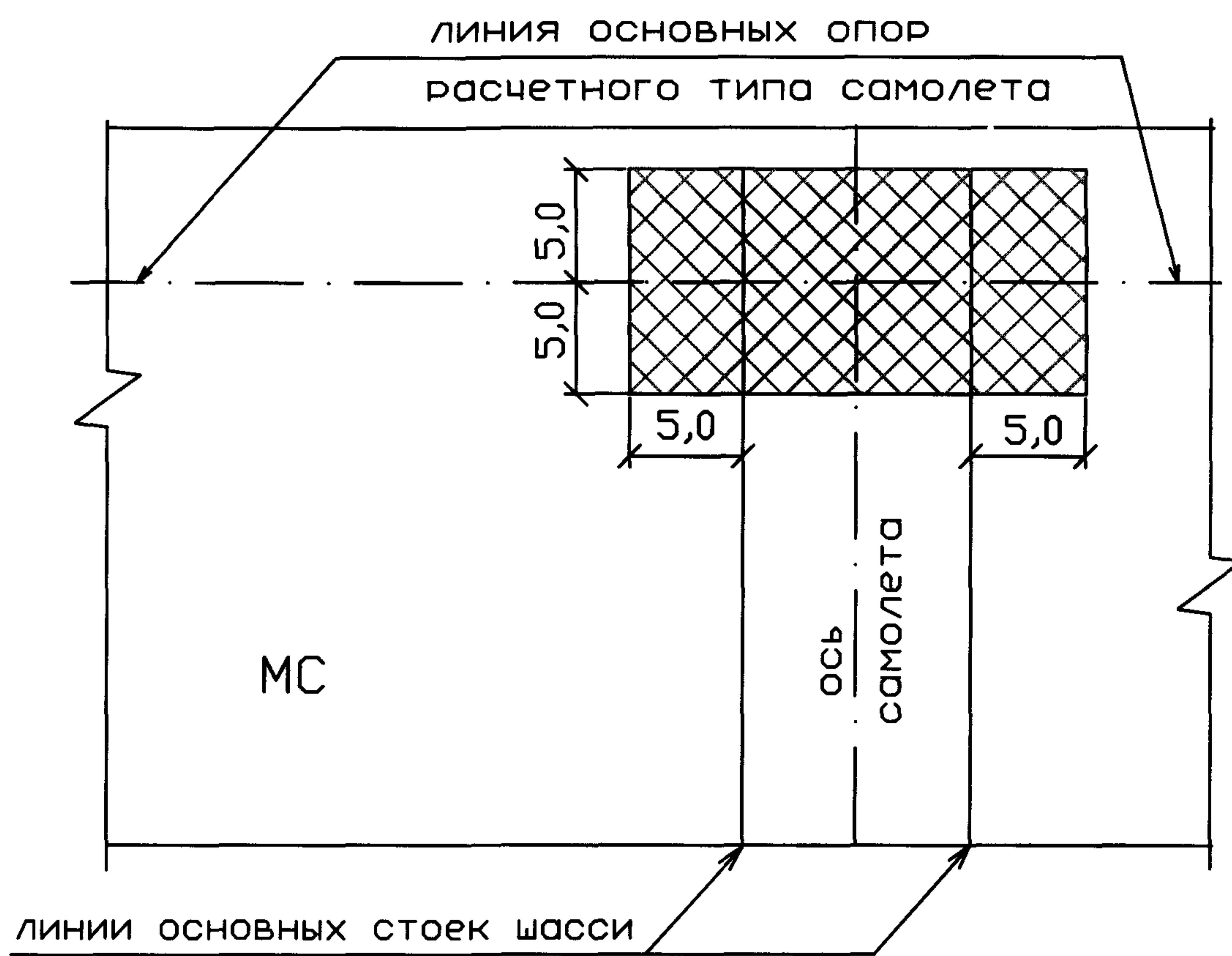
Рис.3.1 Площадь армирования асфальтобетона
