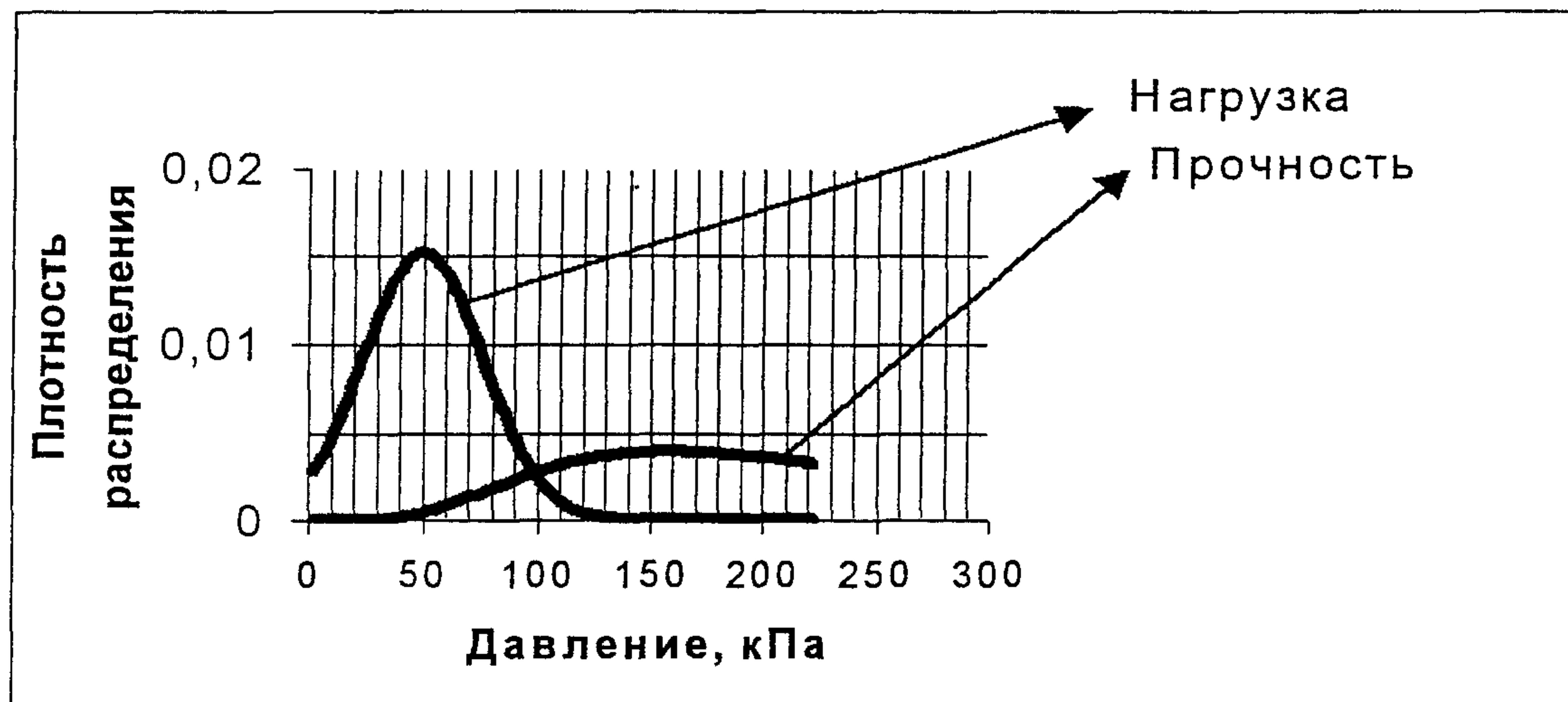
Плотности распределения нагрузки и несущей способности
