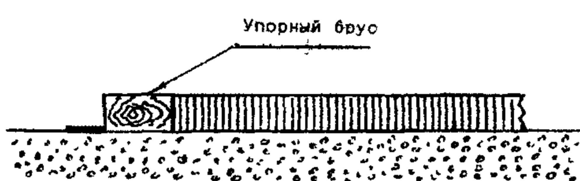
**Рис. 7. Схема установки бруса по окончании работ**
