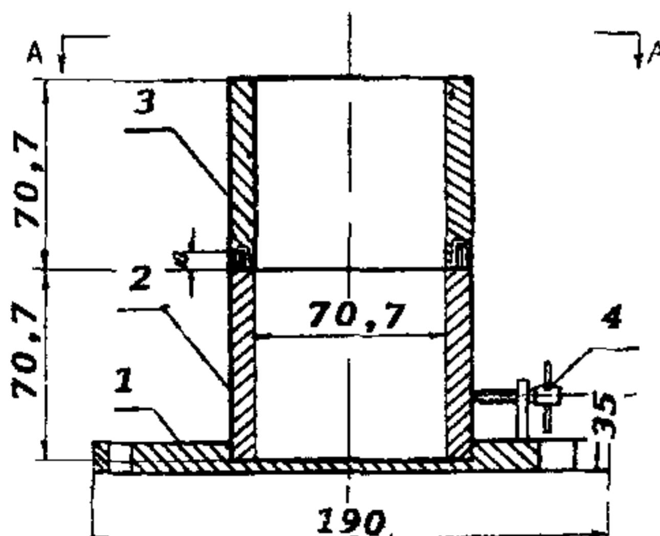
б. форма для изготовления образцов из литьой смеси II и III типов
