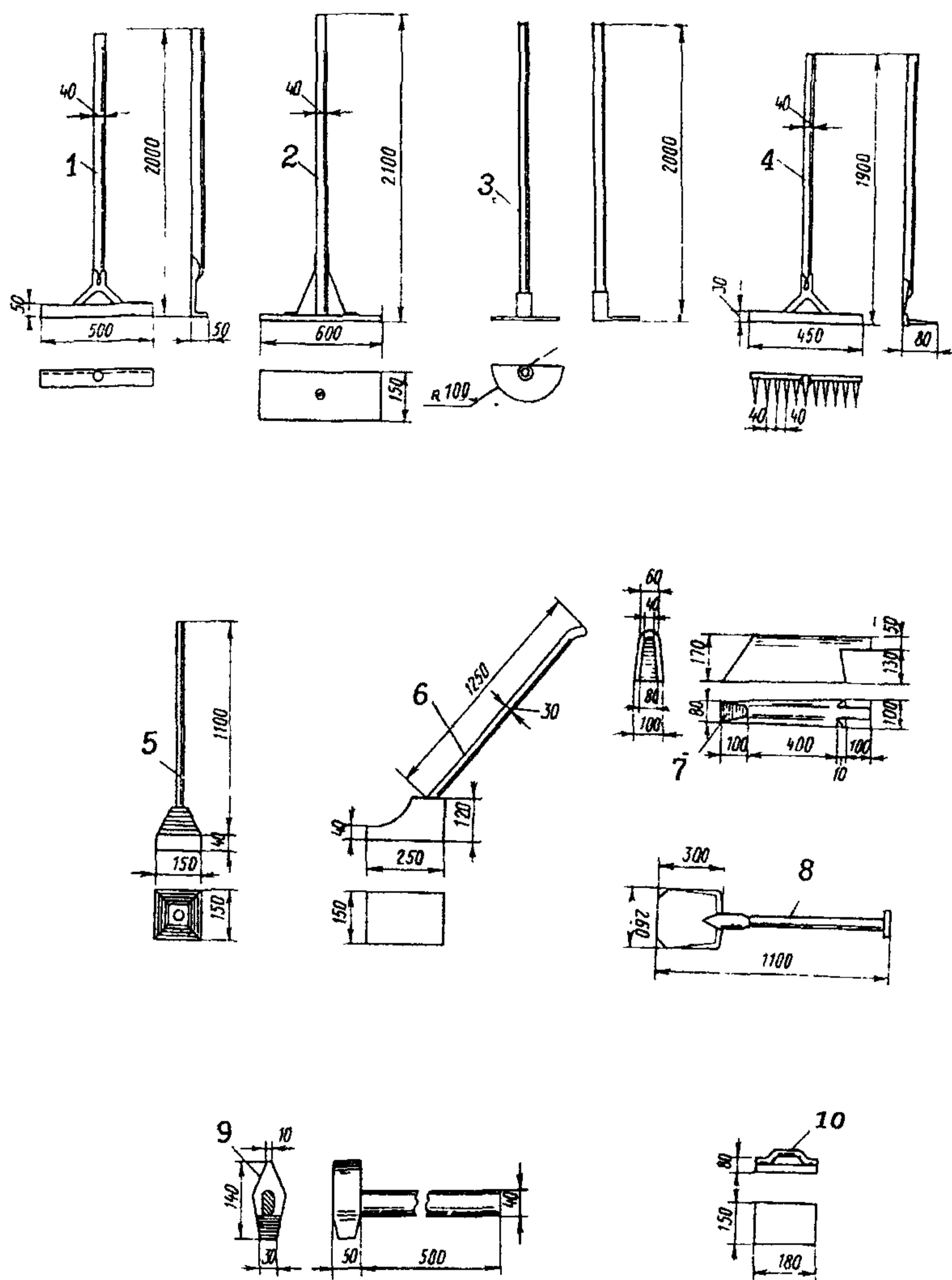
Рис. 4. Инструменты для укладки липкой асфальтобетонной смеси
