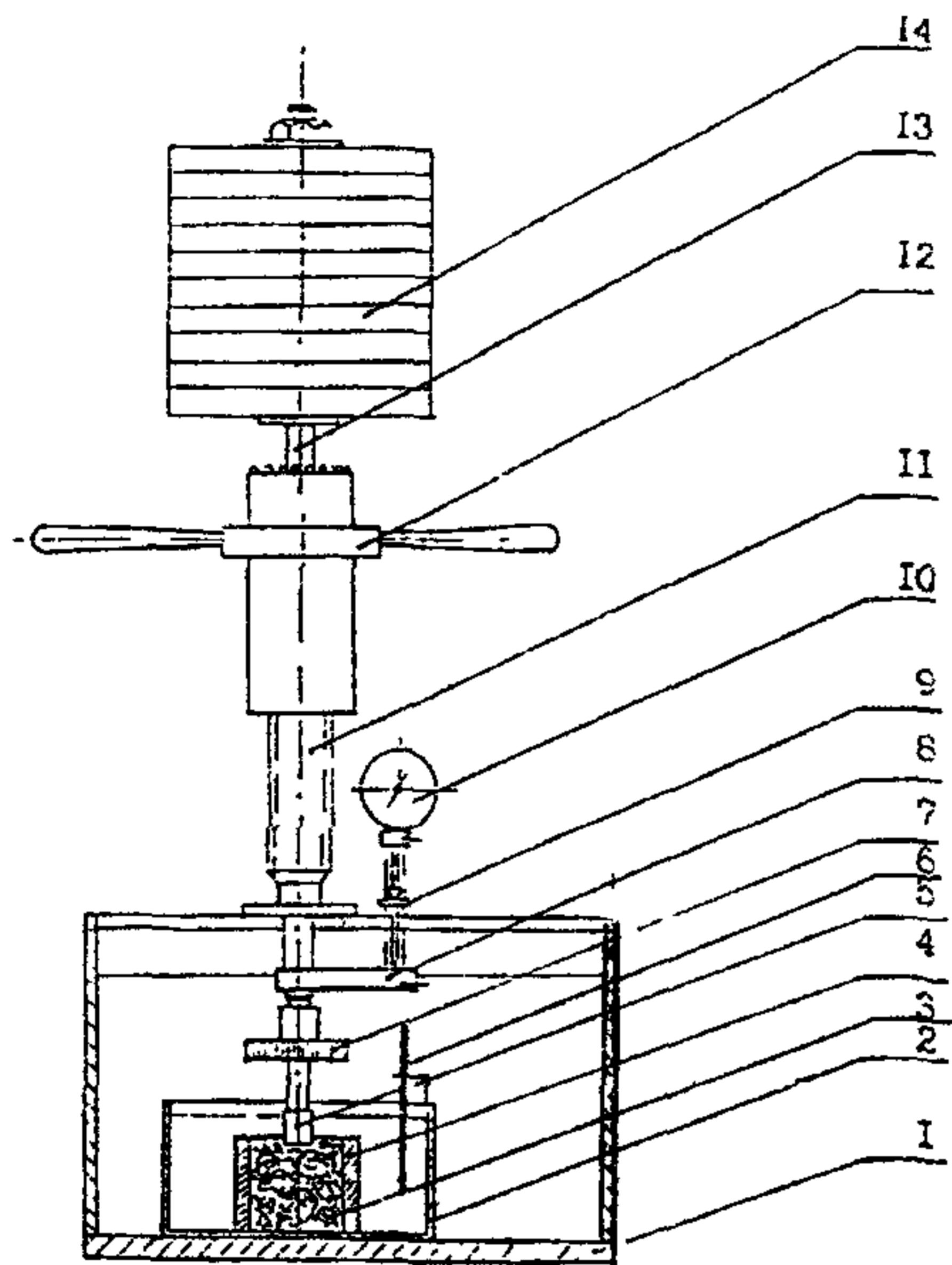
а. прибор для определения глубины вдавливания штампа
