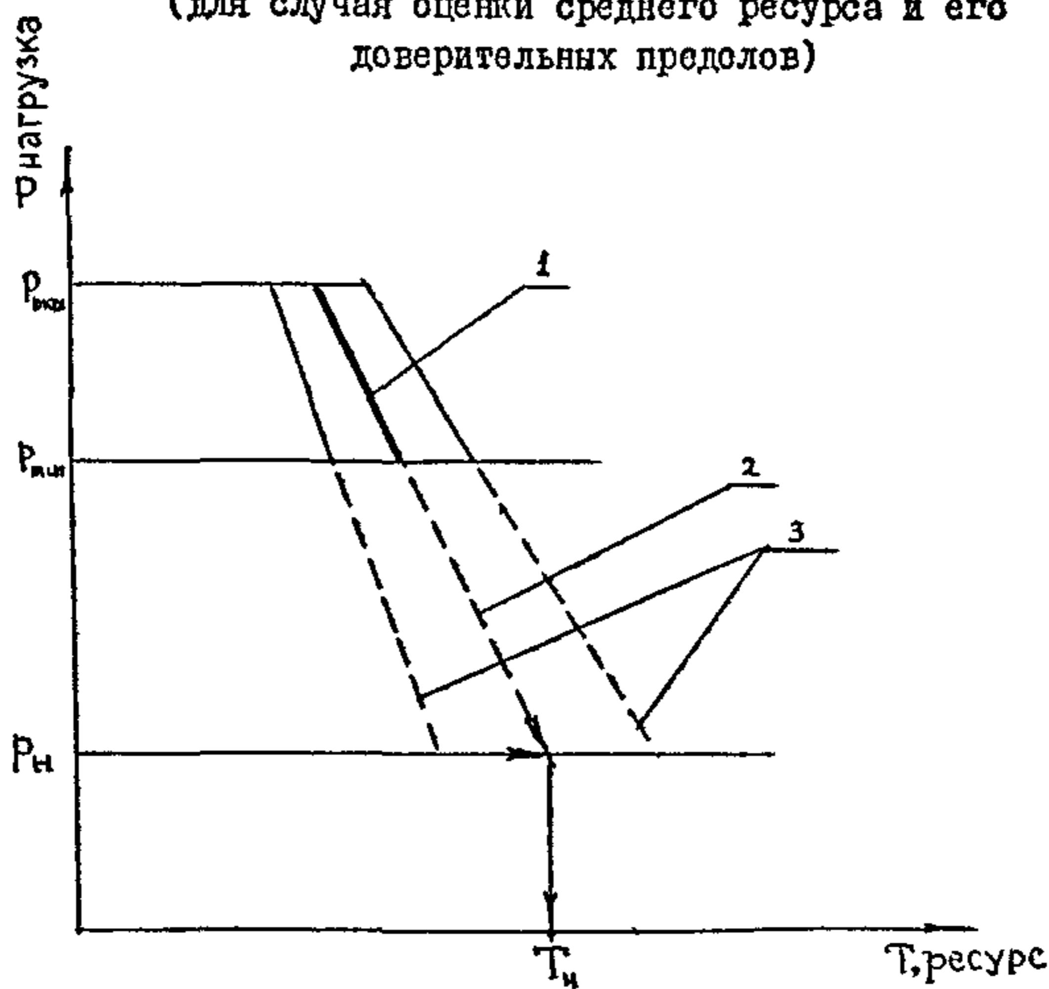
1 - зависимость ресурса от значения нагрузки, установленная испытаниями на форсированных нагрузках,
