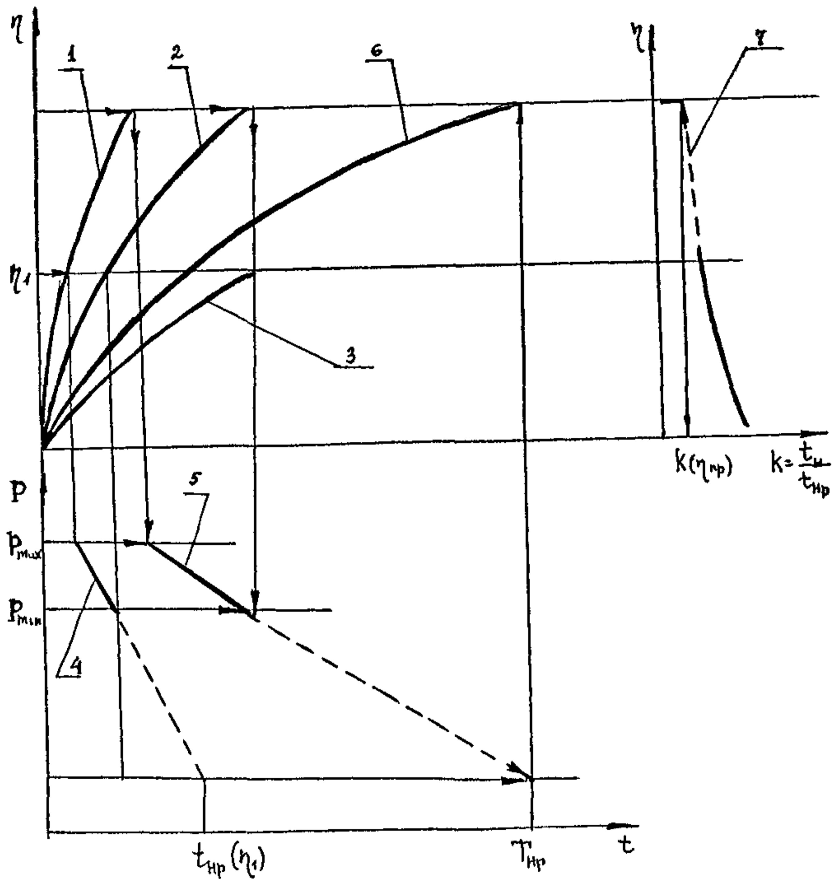
1,2 - функции накопления износа, соответственно, для форсированных нагрузок  $P_{max}$  и  $P_{min}$ ;
