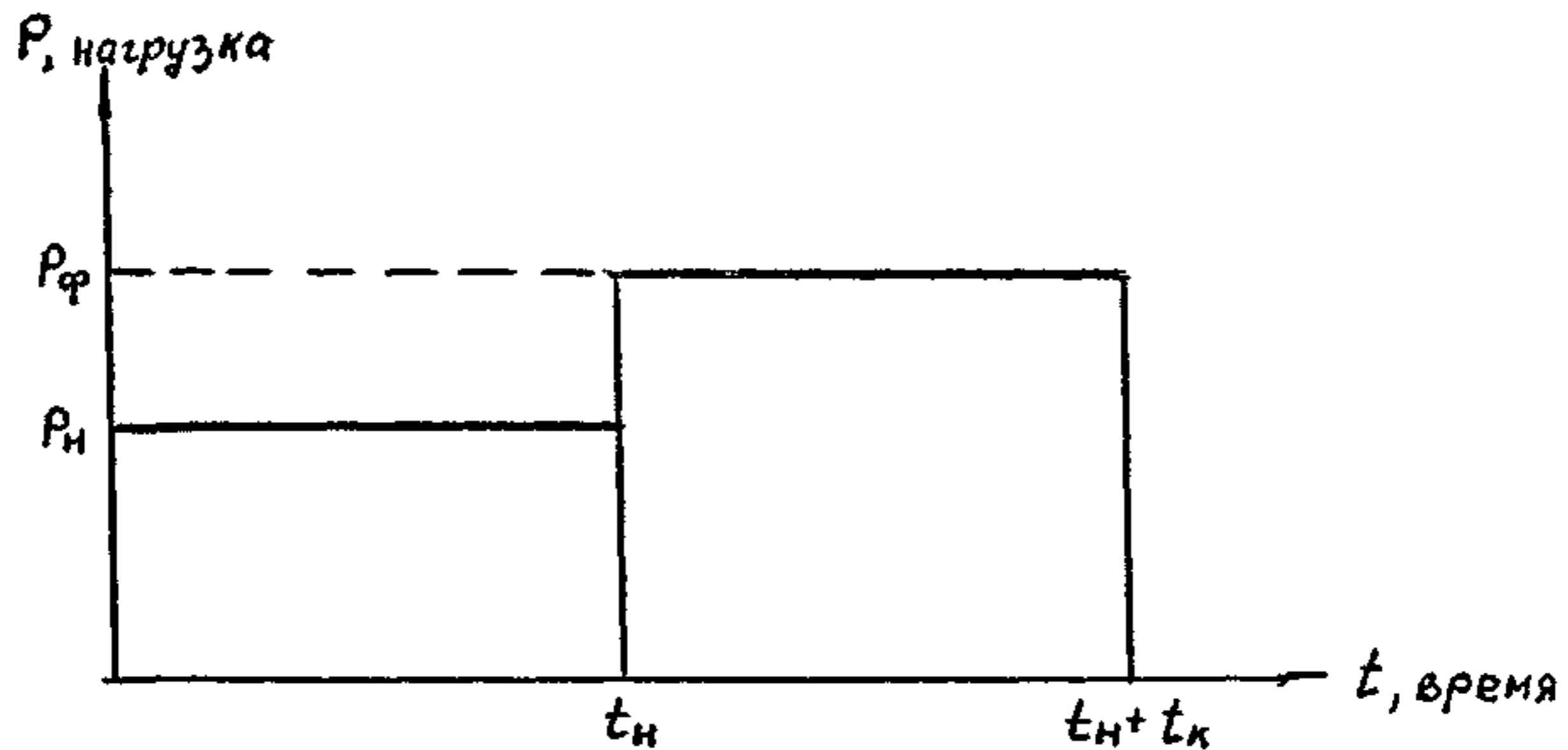
$P_{\Phi}$  — нагрузка при форсированном режиме.
