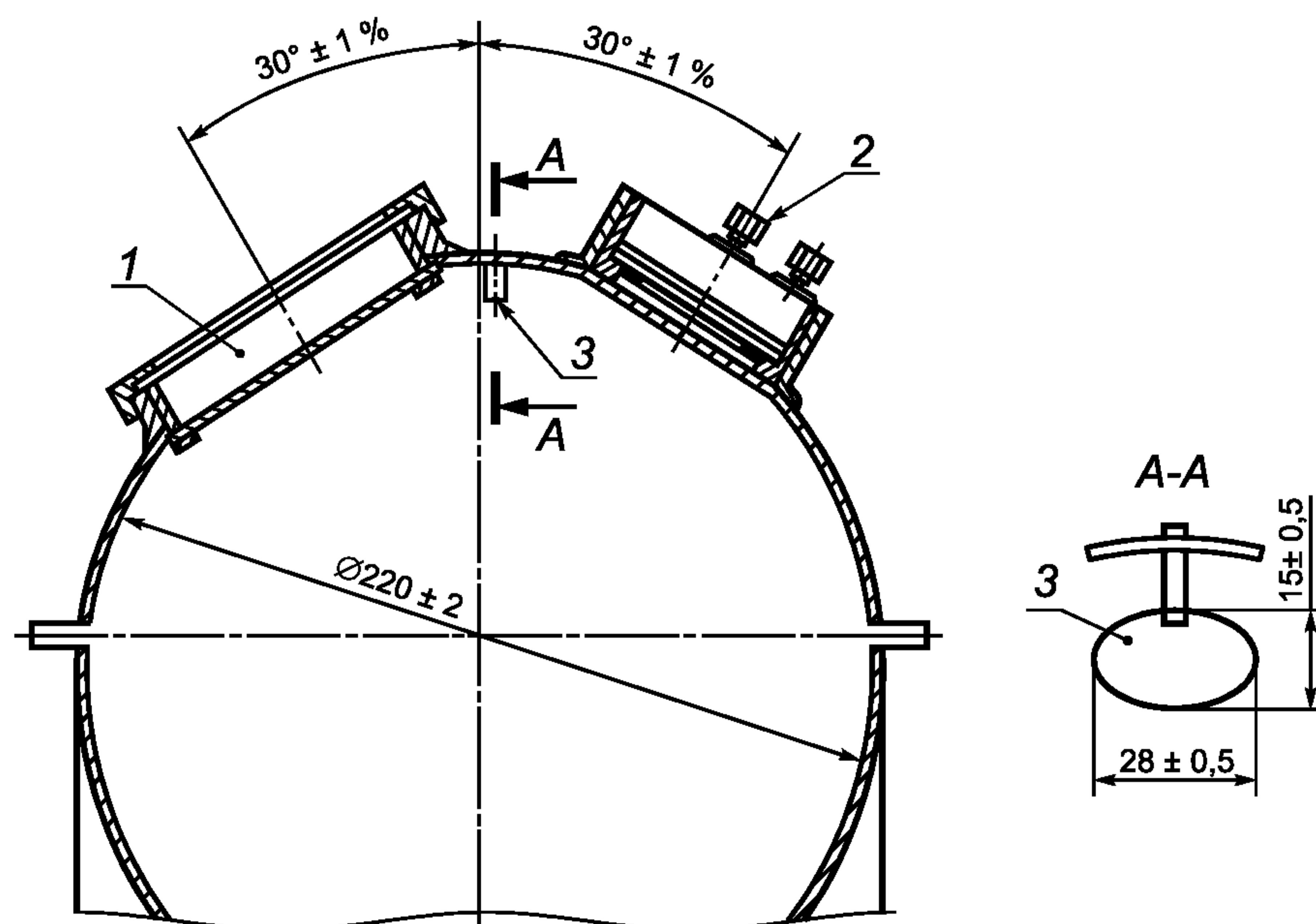
1 — апертура фары; 2 — фотоэлемент; 3 — дефлектор; А — увеличение (расширение) дефлектора
