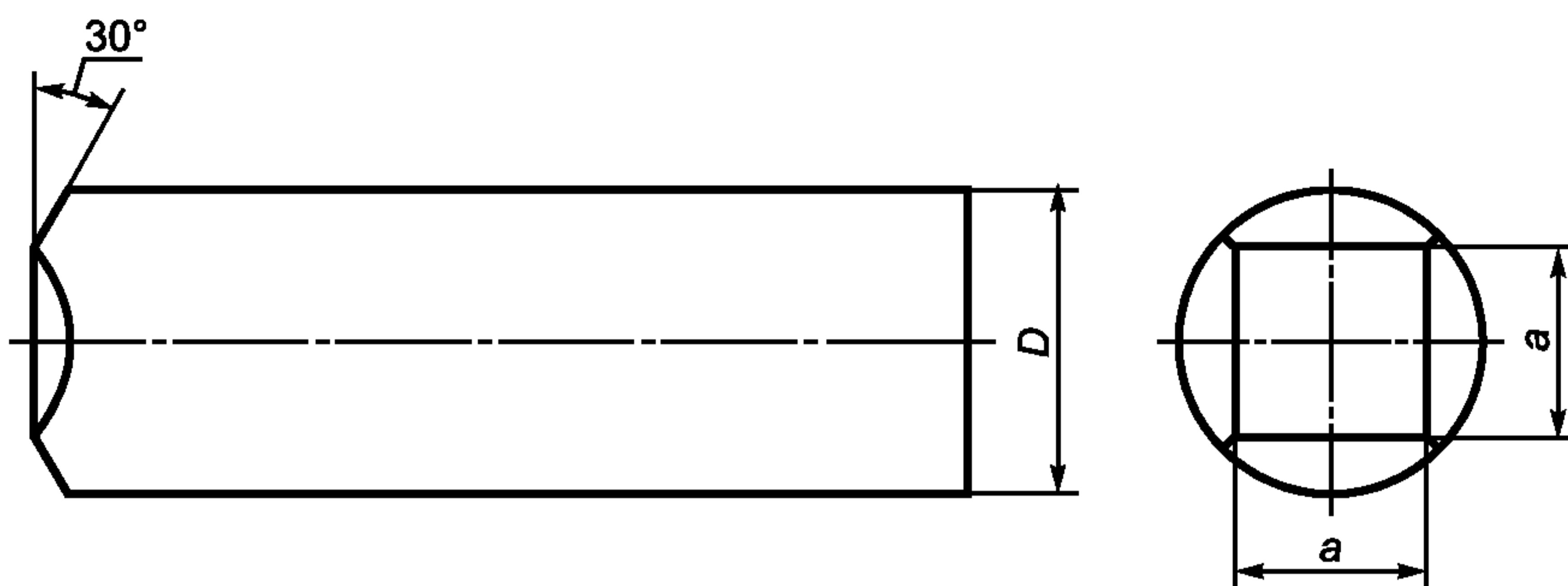
Закалить до  $56^{+4}$  HRC с минимальной глубиной закалки 0,5 мм.
