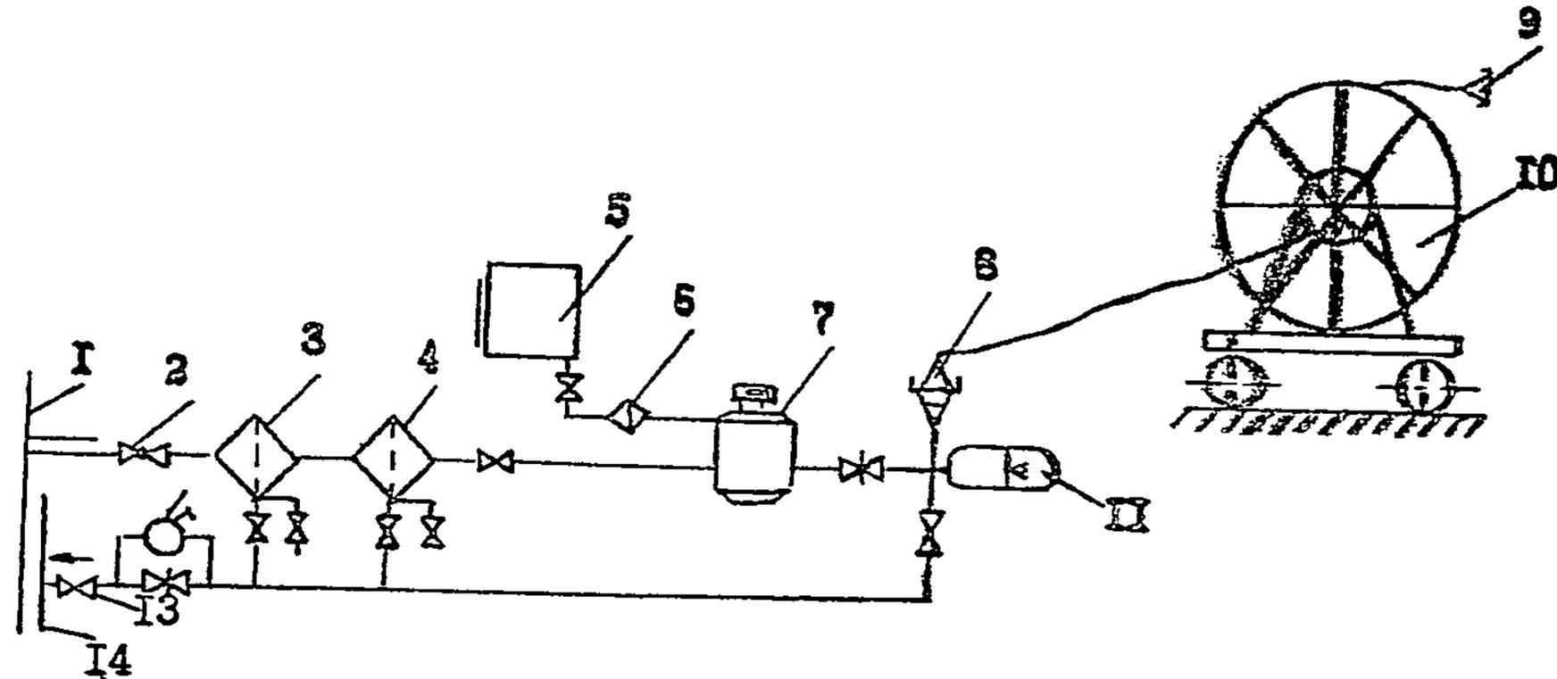
Рис. I. Принципиальная схема заправочного агрегата производительностью до 500 л/мин: I - напорный трубопровод; 2 - кран; 3 - сепаратор; 4 - фильтр тонкой очистки; 5 - расходная емкость с противообледенительной присадкой; 6 - фильтр для противообледенительной жидкости; 7 - установка УИAT; 8 - соединительный наконечник НИП; 9 - катушка для шланга; 10 - шланговая тележка; II - гидроамортизатор; 12 - насос; 13 - обратный клапан; 14 - трубопровод обратного слива
