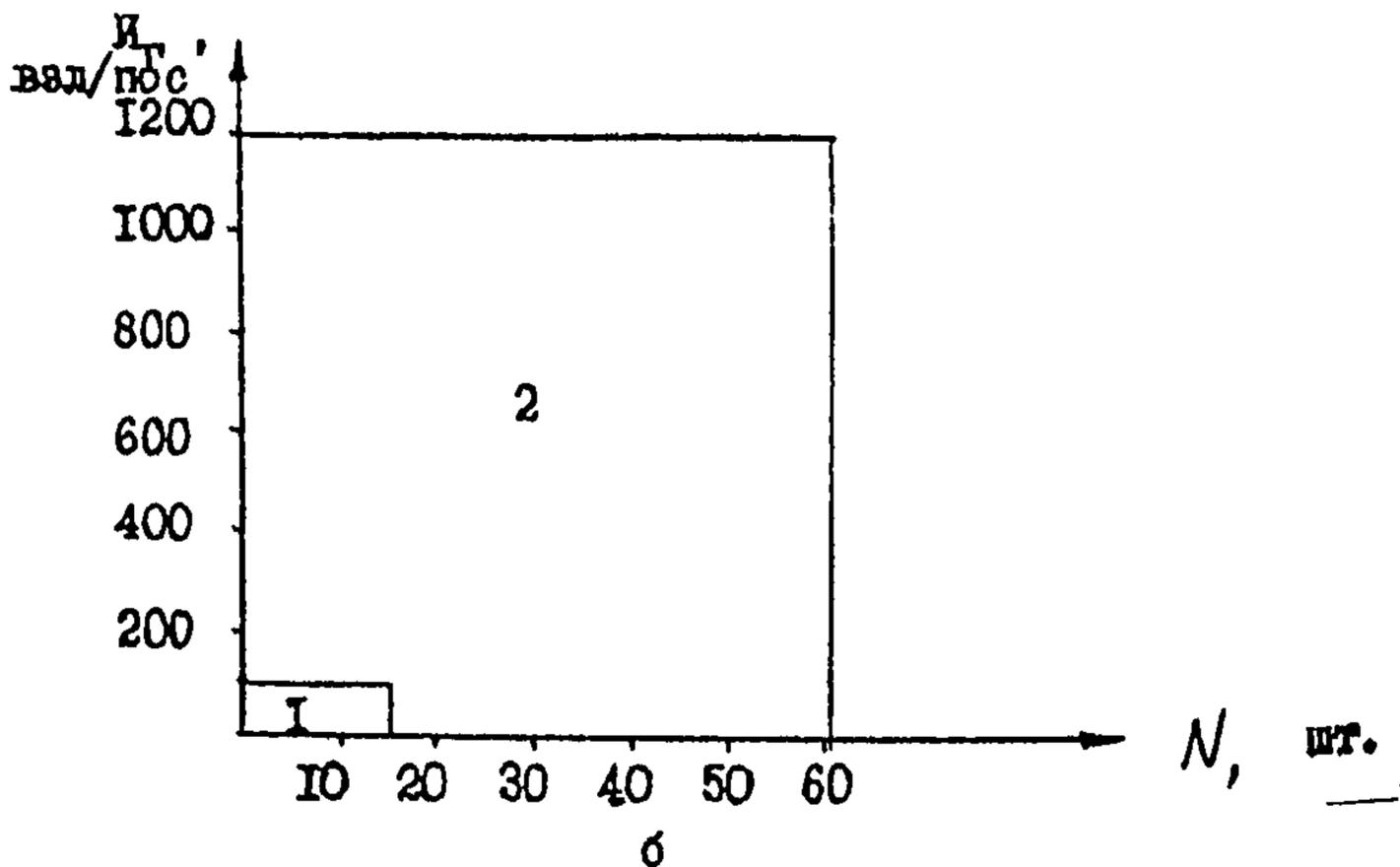
Рис. 9. Графики выбора оптимального способа установки вертолетов II группы на МС при двухрядной (а) и трехрядной (б) схемах расстановки вертолетов в III, IV, V дорожно-климатических зонах: 1 - зона минимальных приведенных затрат при загрузивании вертолетов с помощью буксировщика; 2 - зона минимальных приведенных затрат при загрузивании вертолетов на тяге несущего винта
