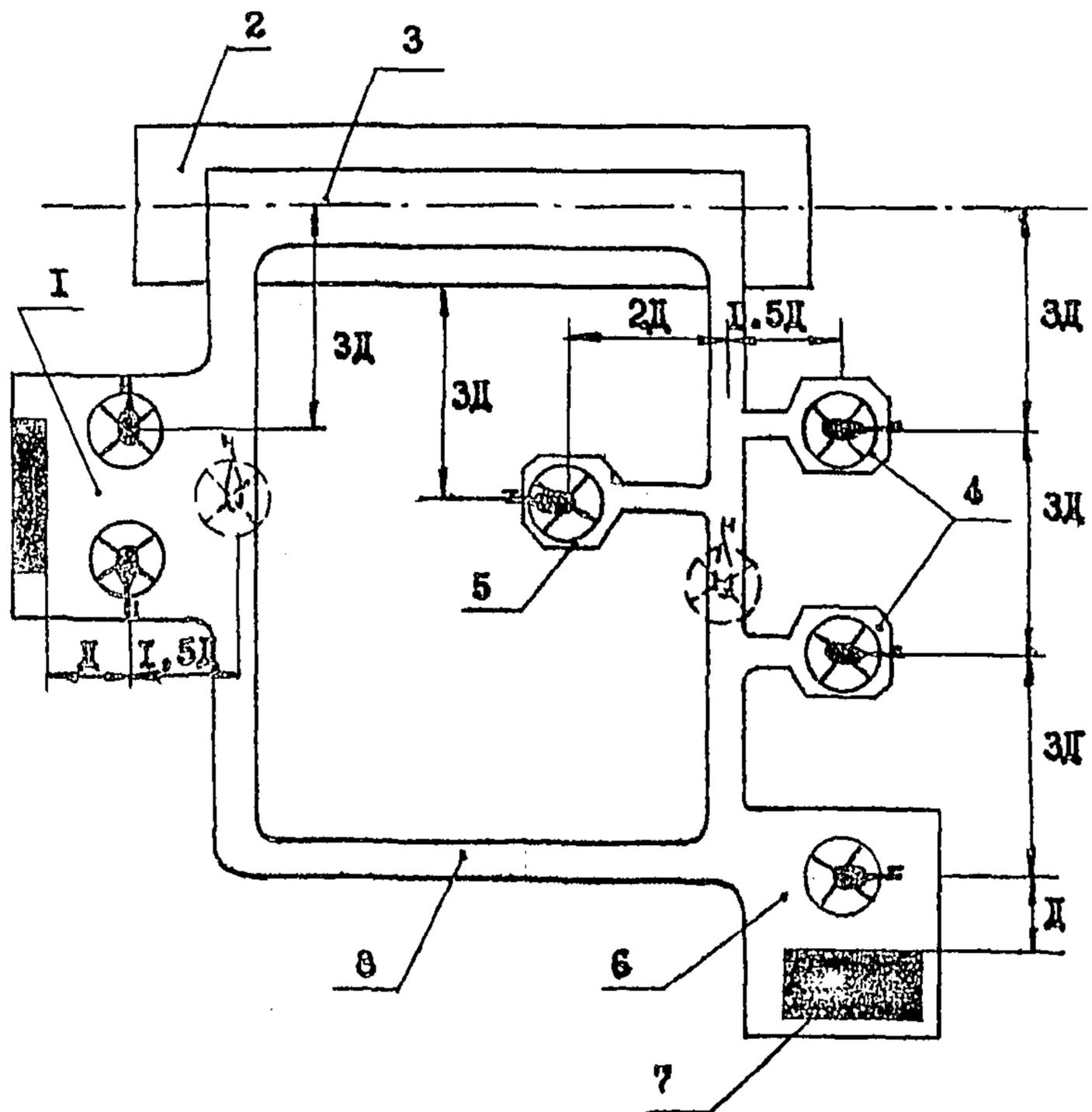
Рис. 2. Взаиморасположение основных элементов вертодромов: 1 - перрон; 2 - полоса безопасности; 3 - ВПП; 4 - индивидуальные МС; 5 - швартовочная площадка; 6 - преддоковая площадка; 7 - док технического обслуживания; 8 - рулежная дорожка
