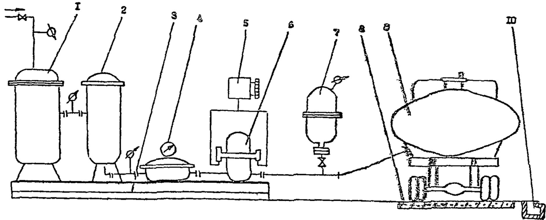
Рис. 2. Принципиальная схема пункта налива: 1 - фильтр-сепаратор; 2 - фильтр с ТФБ; 3 - рама; 4 - счетчик топлива; 5 - бак с присадочной емкостью; 6 - дозатор; 7 - гидроамортизатор; 8 - площадка для ТЗ; 9 - ТЗ; 10 - сборник пролитого топлива
