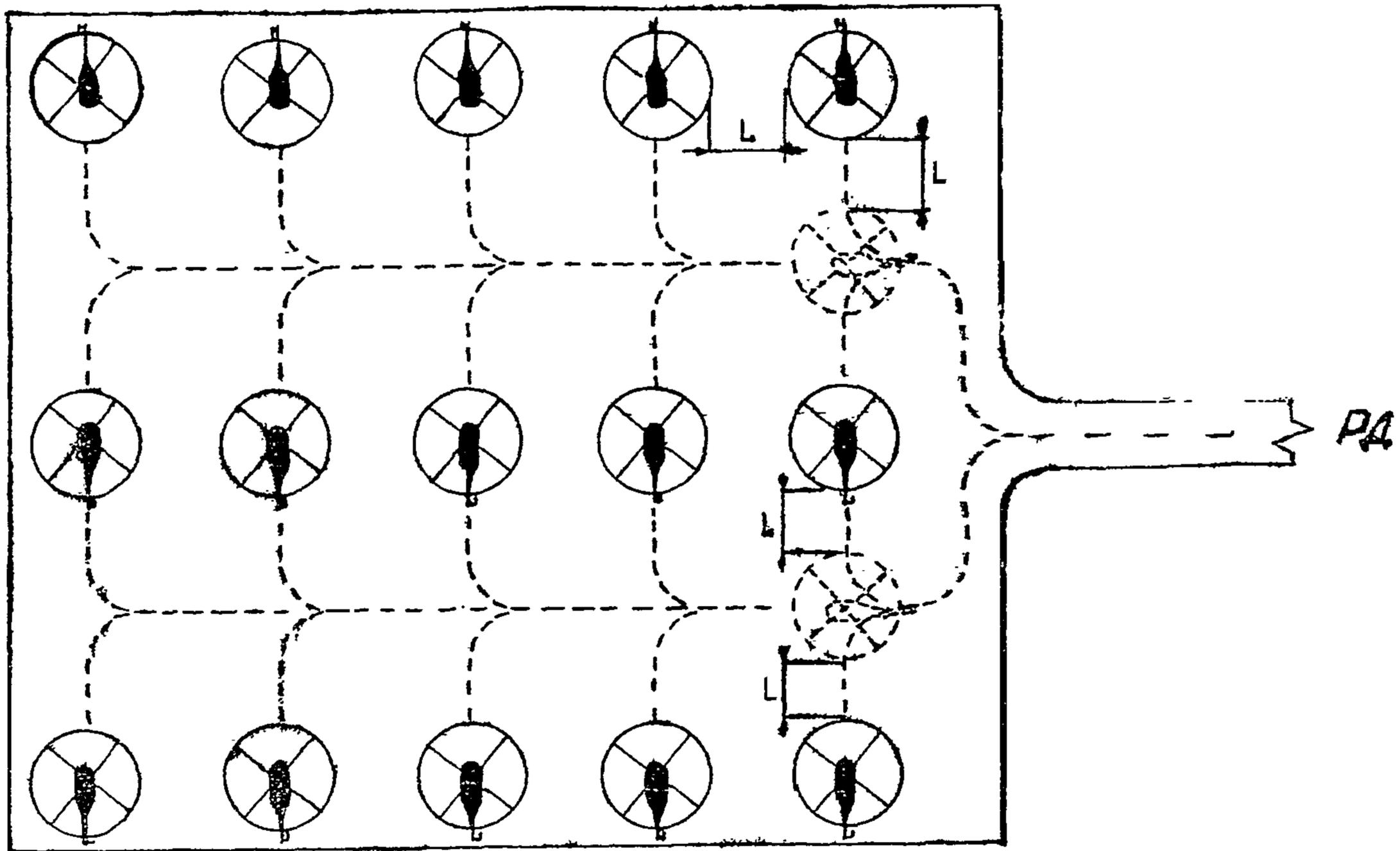
Рис.2. Трехрядная схема расстановки вертолетов на ~~грунтовой~~ БС
