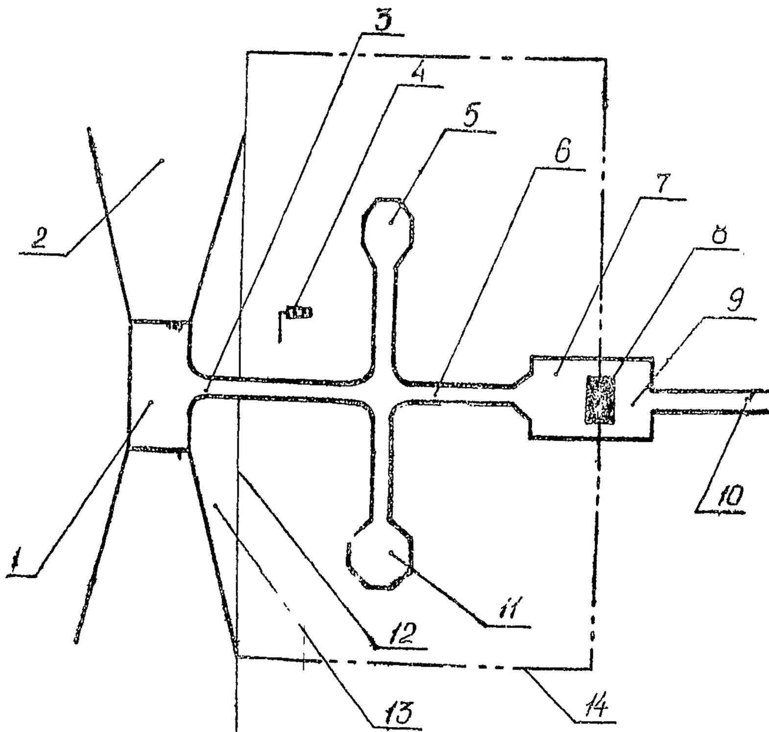
Рис.10. Схема генерального плана вертолетной станции с надводной взлетно-посадочной площадкой: I - ВПП; 2 - полоса воздушных подходов; 3 - трап для транспортировки вертолетов на берег; 4 - ветроукладатель; 5 - место стоянки вертолета; 6 - рулежная дорожка; 7 - перрон; 8 - пассажирский павильон; 9 - призывная площадь; 10 - подземная автомагистраль; 11 - швартовочная площадка; 12 - береговая линия; 13 - водоем; 14 - ограждение вертолетной станции.
