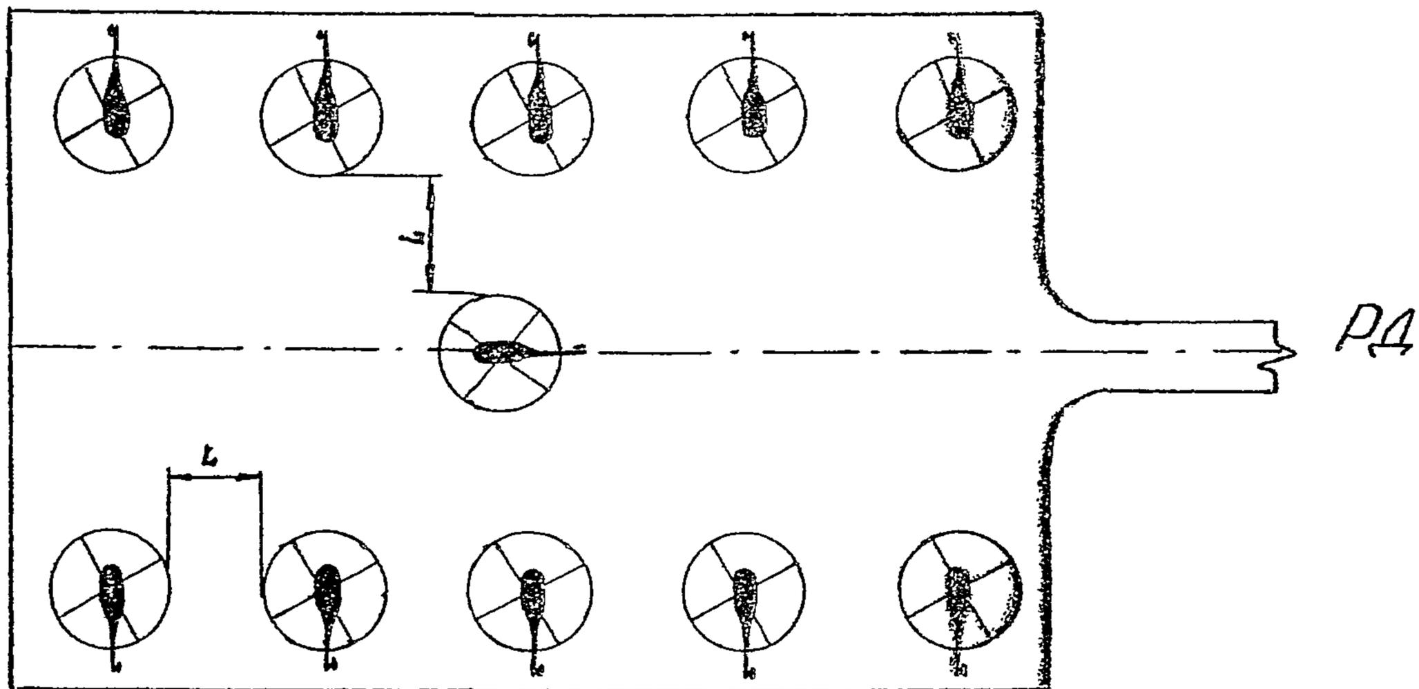
Рис. I. Двухрядная схема расстановки вертолетов на взлетной ВЛ
