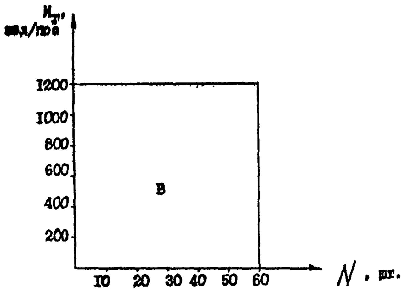
Рис.13. График выбора оптимальной схемы расстановки вертолетов II и III группы при установке с разворотом в воздухе в I, II, III, IV, V дорожно-климатических зонах: Б - зона минимальных приведенных затрат при трехрядной схеме расстановки вертолетов
