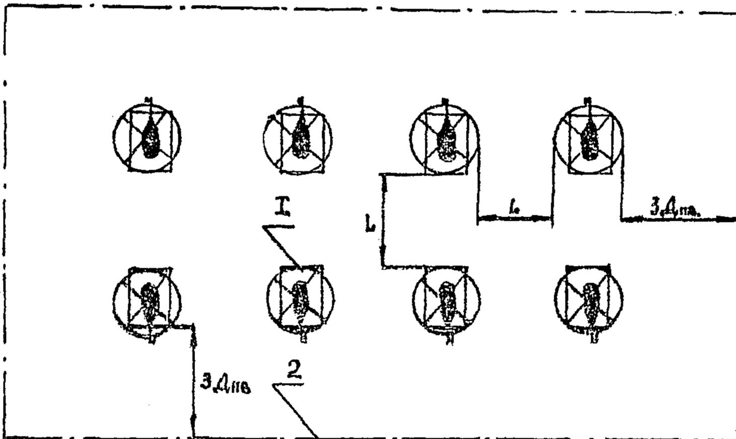
Рис.3. Двухрядная схема расстановки на индивидуальные МС, полетом на малой высоте: I - индивидуальные МС; 2 - граница землеотвода
