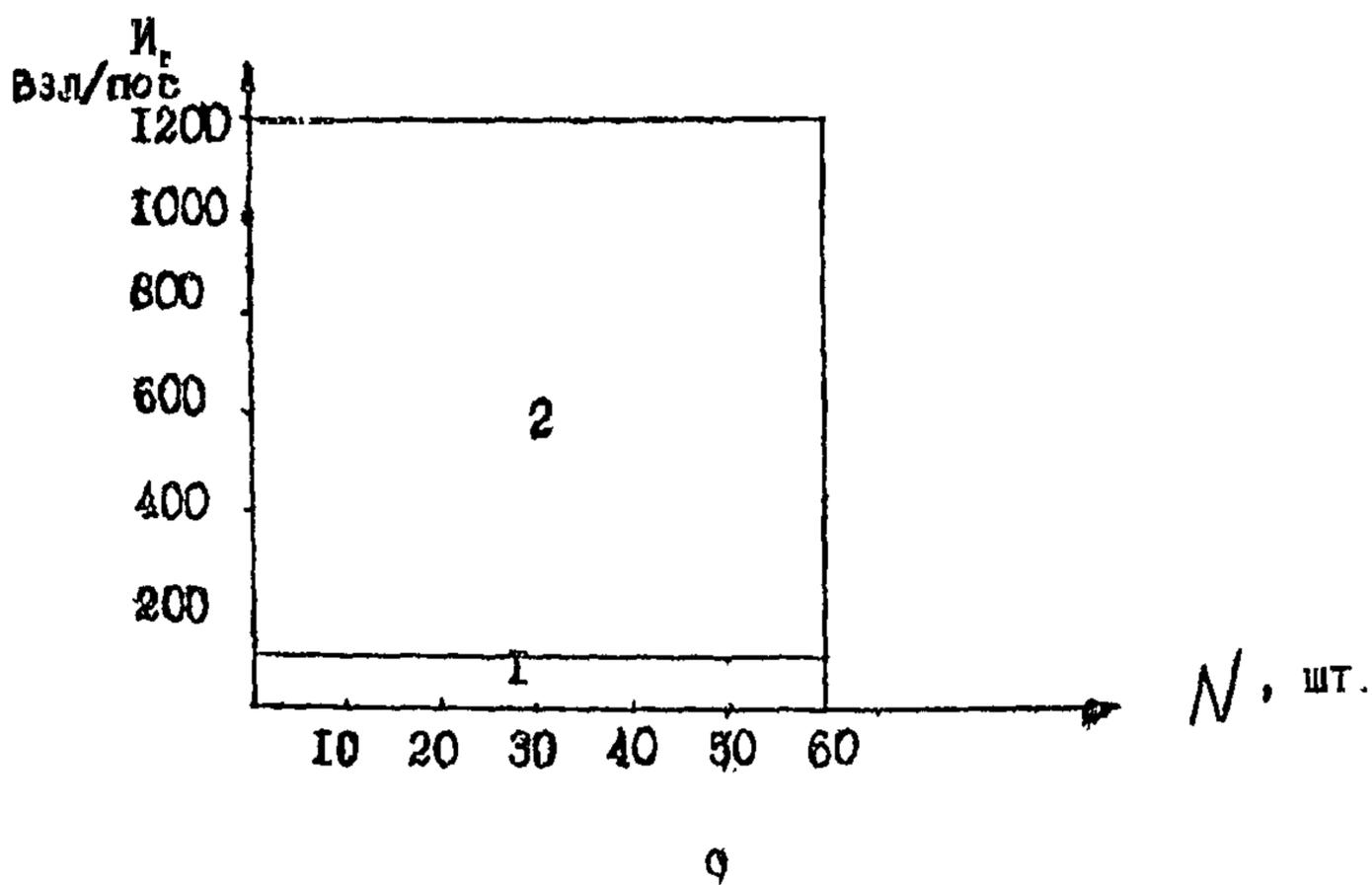
Рис.7. Графики выбора оптимального способа установки вертолетов III группы на МС при двухрядной (а) и трехрядной (б) схемах расстановки в I и II дорожно-климатических зонах: I - зона минимальных приведенных затрат при зарулировании вертолетов с помощью буксировщика; 2 - зона минимальных приведенных затрат при зарулировании вертолетов на тяге несущего винта
