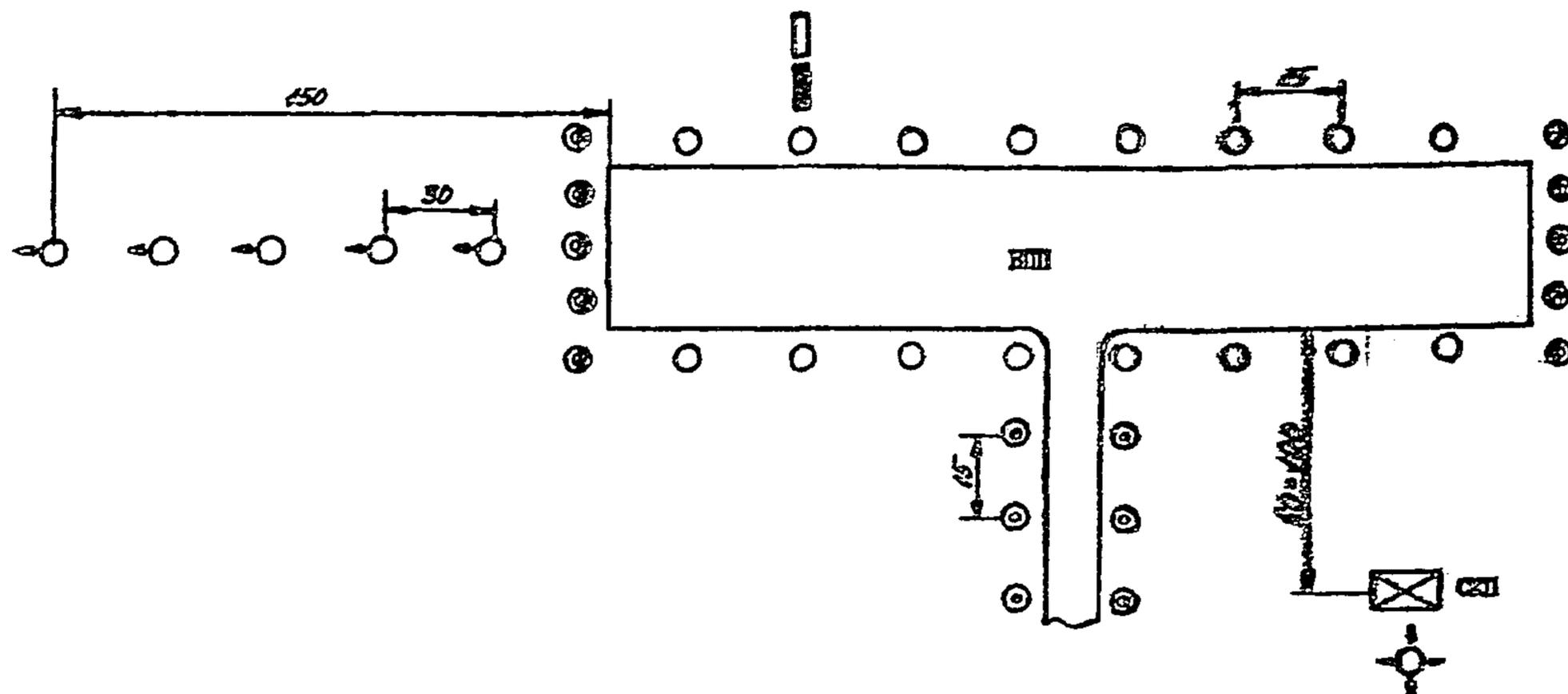
Рис. 13. Схема расположения светосигнального оборудования ~~в аэродроме~~:
