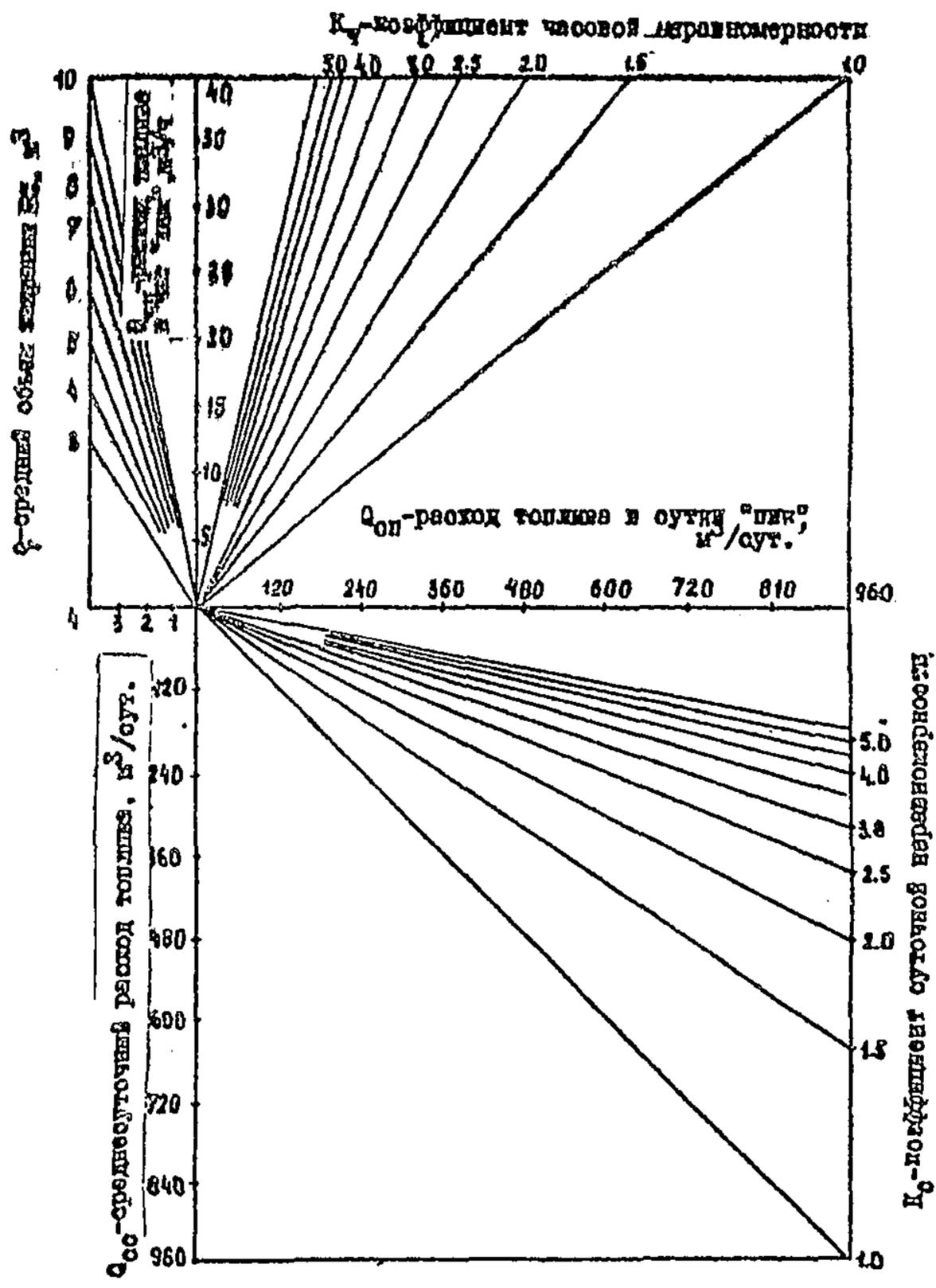
Рис.10. Номограмма определения среднесуточного расхода топлива  $Q_{ср}$  и расхода топлива в сутки "пик"  $Q_{оп}$  в зависимости от интенсивности движения  $\lambda$  в час "пик"  $\lambda$  и среднего объема заправки  $q$ , для  $q \div 10 \text{ м}^3$ .
