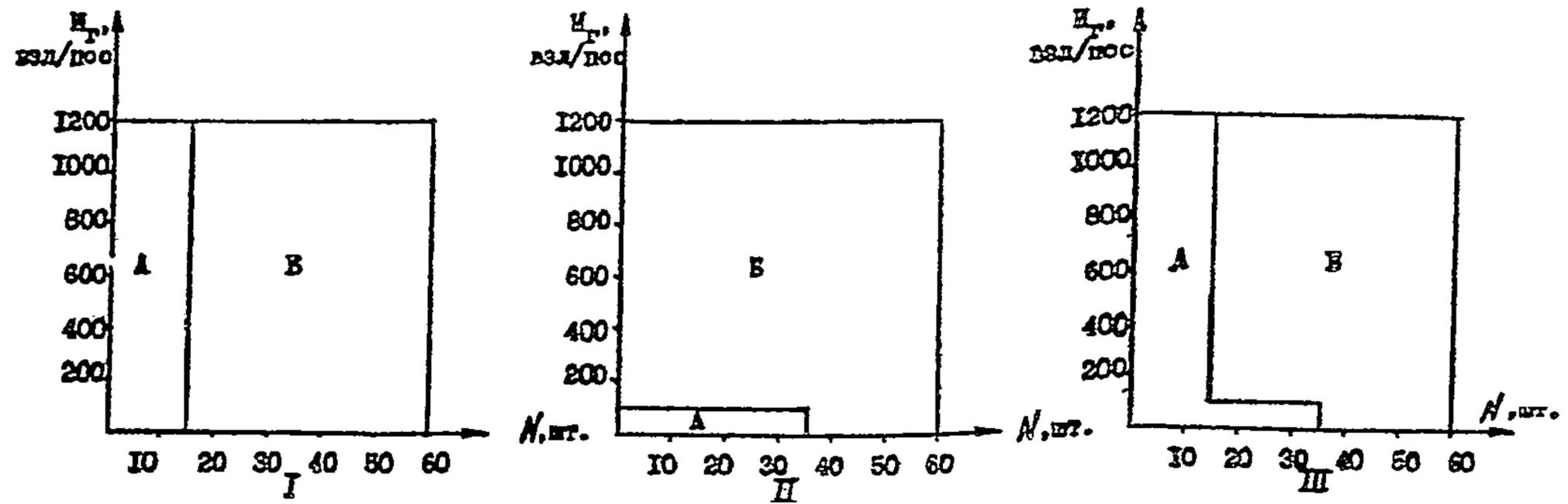
Рис.14. Графики выбора оптимальной схемы расстановки вертолетов I, II, III групп при загрузивании с помощью буксировщика в III, IV, V дорожно-климатических зонах: А - зона минимальных приведенных затрат при двухрядной схеме расстановки вертолетов; Б - зона минимальных приведенных затрат при трехрядной схеме расстановки вертолетов
