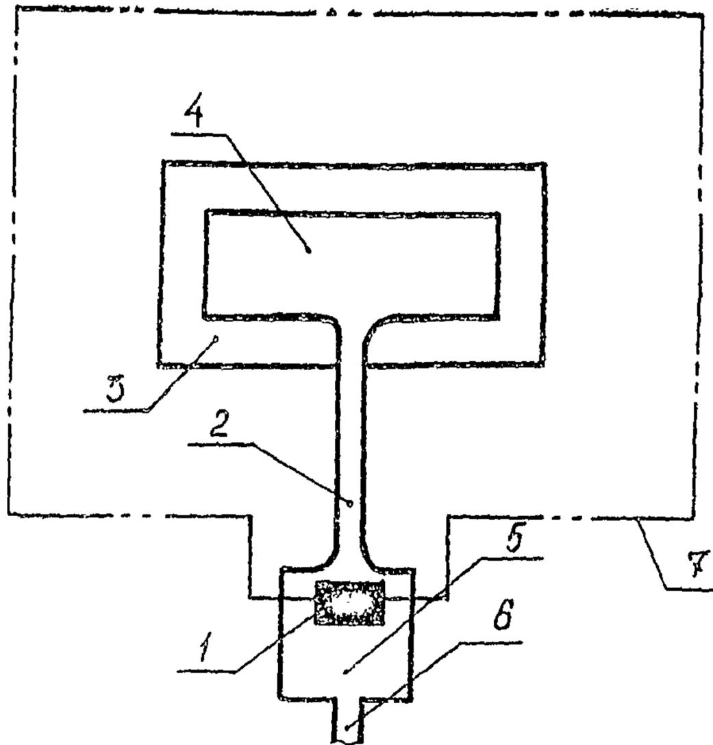
Рис. 8. Схема генерального плана промежуточной вертолетной станции: 1 - пассажирский павильон; 2 - пешеходная дорожка; 3 - летная полоса; 4 - ВПП; 5 - привокзальная площадь; 6 - подъездная автодорога; 7 - ограждение вертолетной станции
