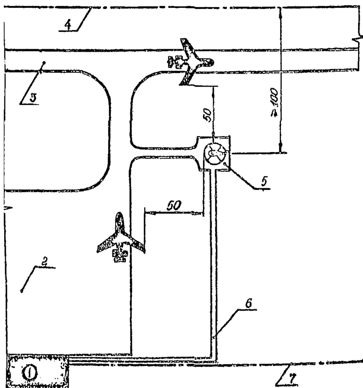
Рис. I. Примерная схема посадочной площадки для вертолетов в аэропорту: 1 - аэровокзал; 2 - перрон; 3 - магистральная рулежная дорожка; 4 - граница летной полосы аэродрома; 5 - посадочная площадка; 6 - пешеходная аллея; 7 - ограждение аэропорта
