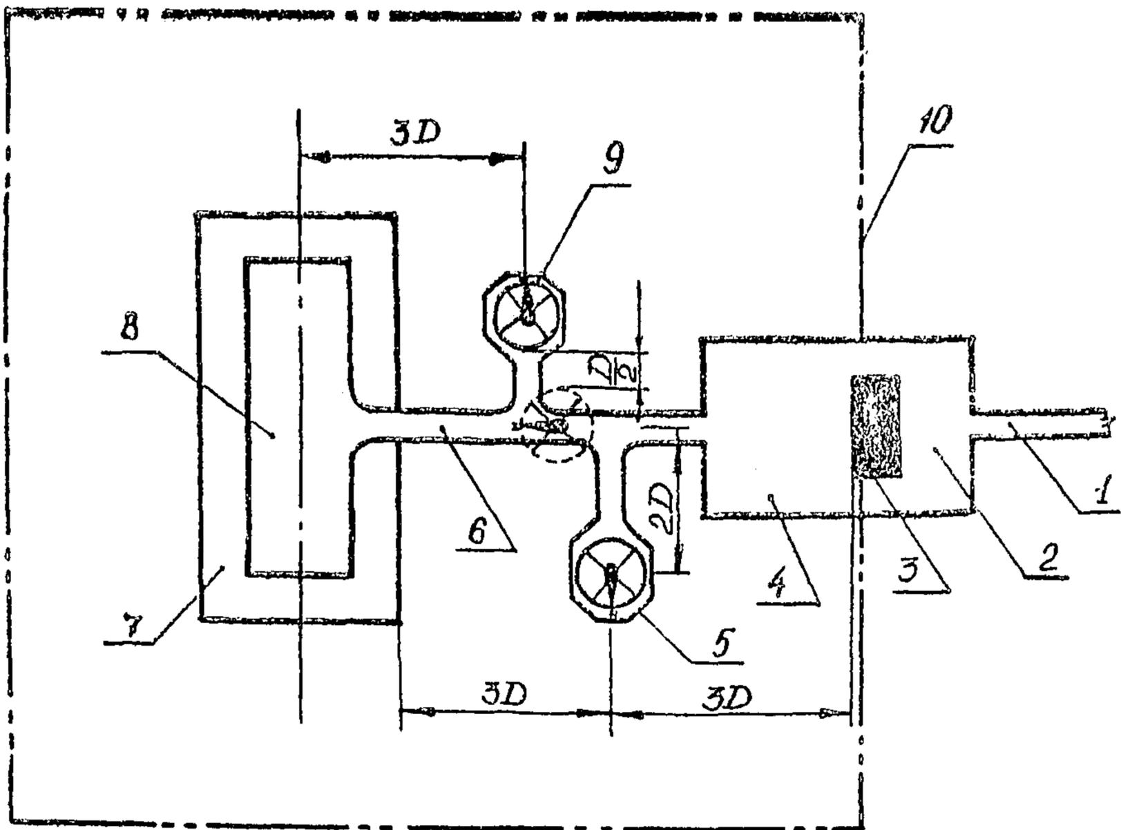
Рис.7. Схема генерального плана конечной вертолетной станции: 1 - подъездная дорога; 2 - привозкзальная площадь; 3 - служебно-пассажи́рское здание с КПИ; 4 - перрон; 5 - швартовочная площадка; 6 - рулежная дорожка; 7 - летная полоса; 8 - ВПИ; 9 - место стоянки вертолета; 10 - ограждение вертолетной станции
