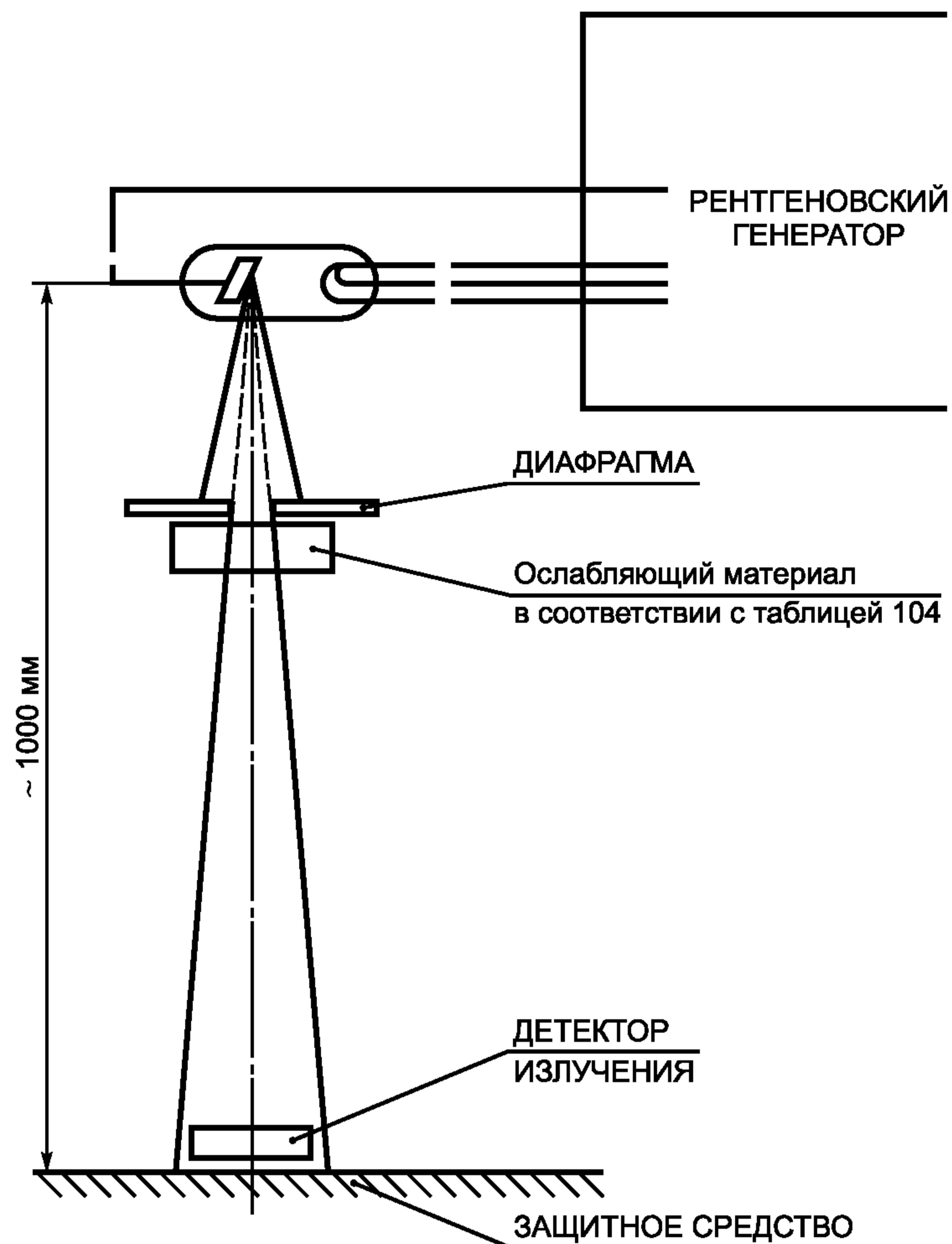
Рисунок 101 — Рекомендуемая геометрия при измерении ВОЗДУШНОЙ КЕРМЫ
