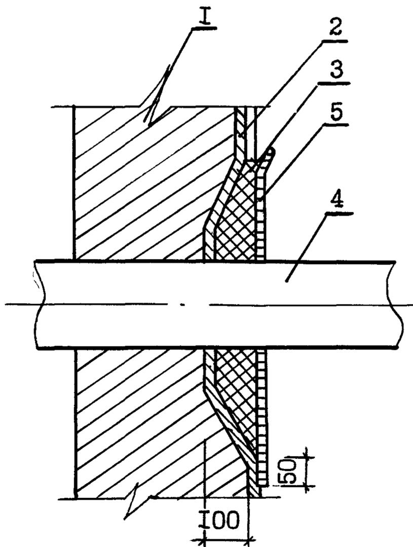
Рис. I. Сопряжение закладных деталей с гидроизоляцией
