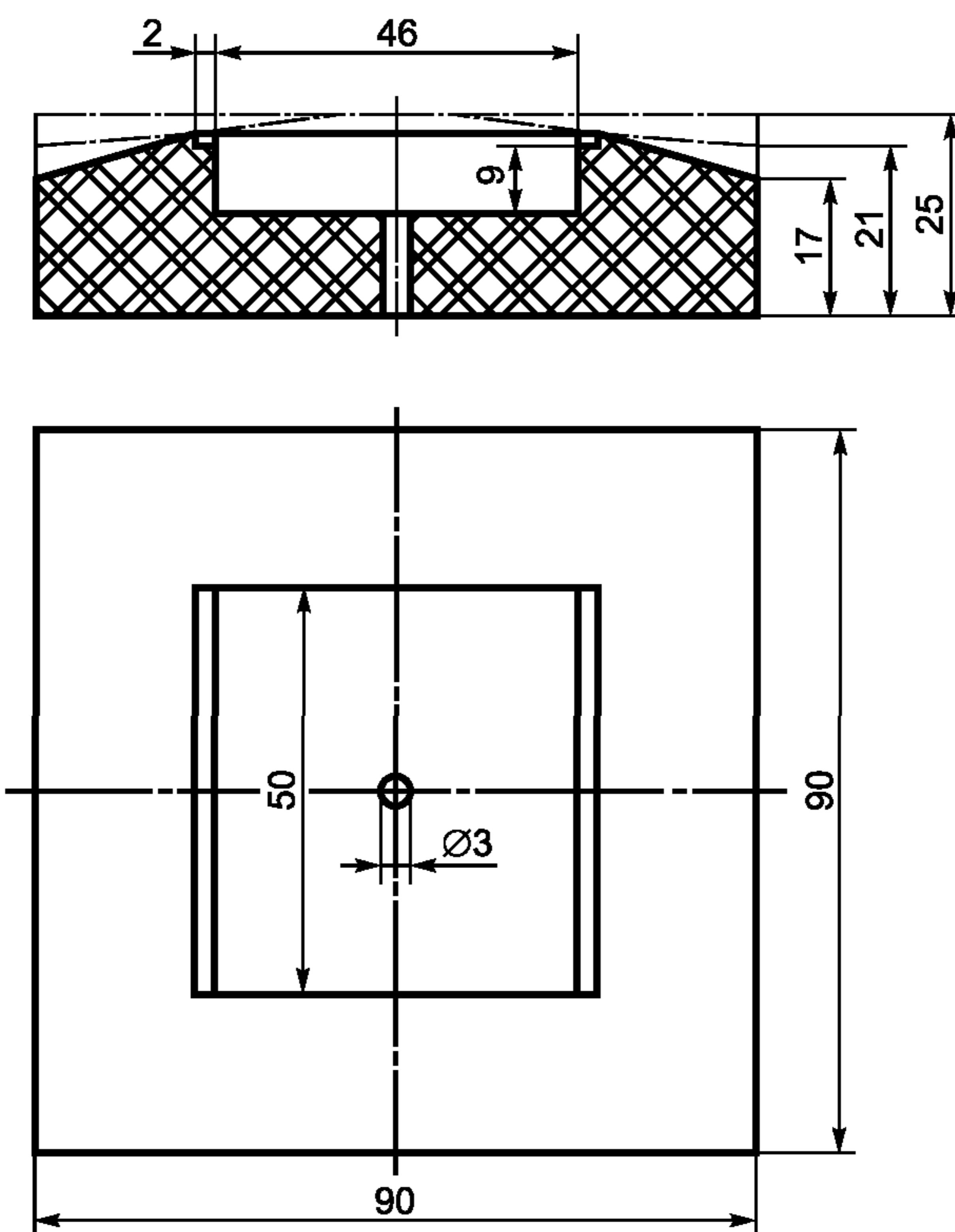
Допустимое отклонение размеров  $\pm 0,1$  мм
