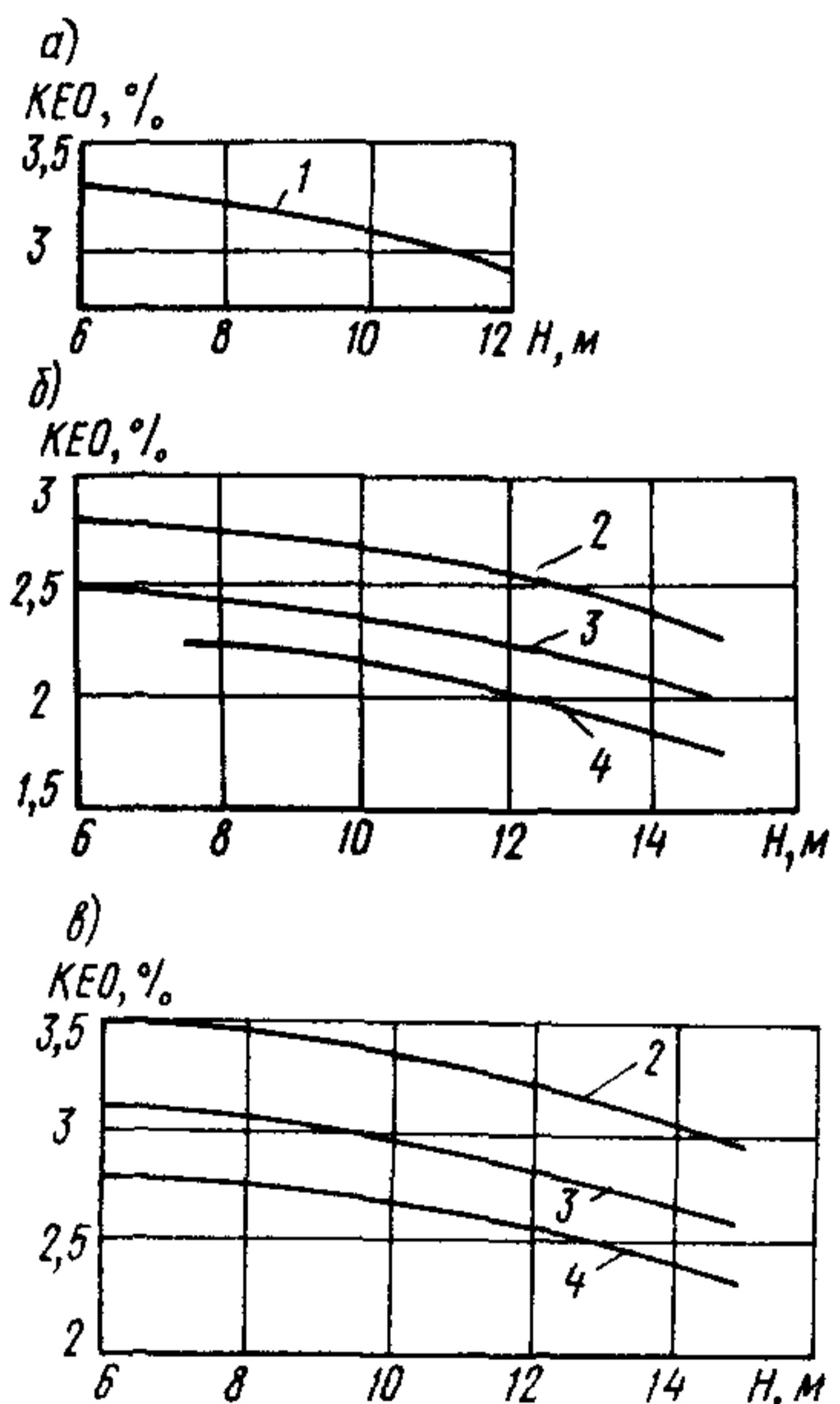
Рис 8 Графики для определения типа и размеров прямоугольных светоаэрационных фонарей
