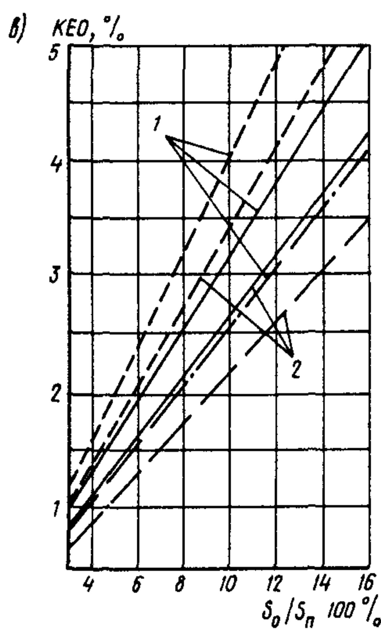
Рис 7 Графики для определения общей площади зенитных фонарей с площадью одного светового проема 2—3 м<sup>2</sup> (а), 3—9 м<sup>2</sup> (б) и 9—18 м<sup>2</sup> (в) при заполнении оконным стеклом в один (пунктирная линия), два (сплошная линия) и три (штрихпунктирная линия) слоя
