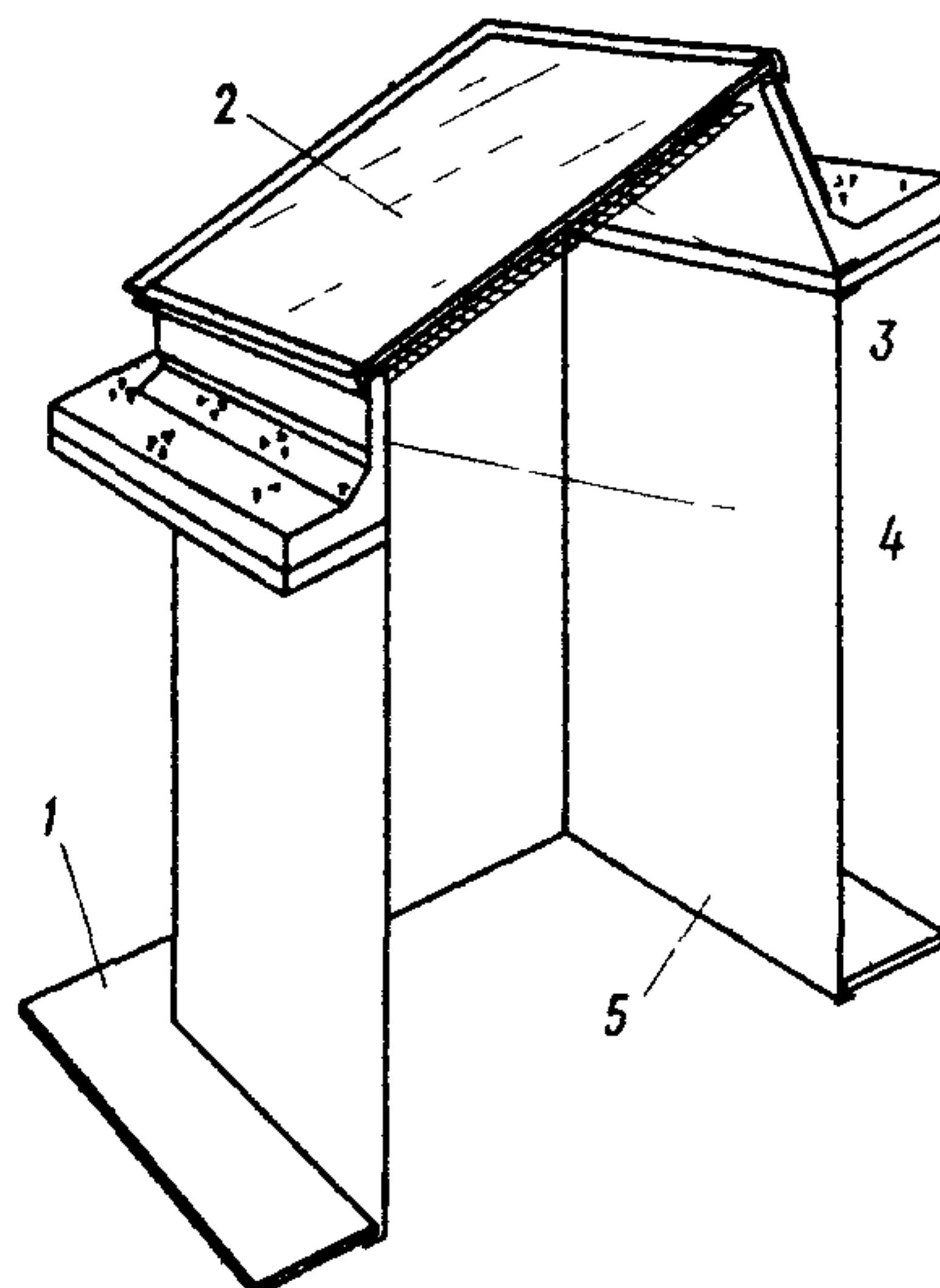
Рис 5 Зенитный фонарь со светопроводной шахтой
