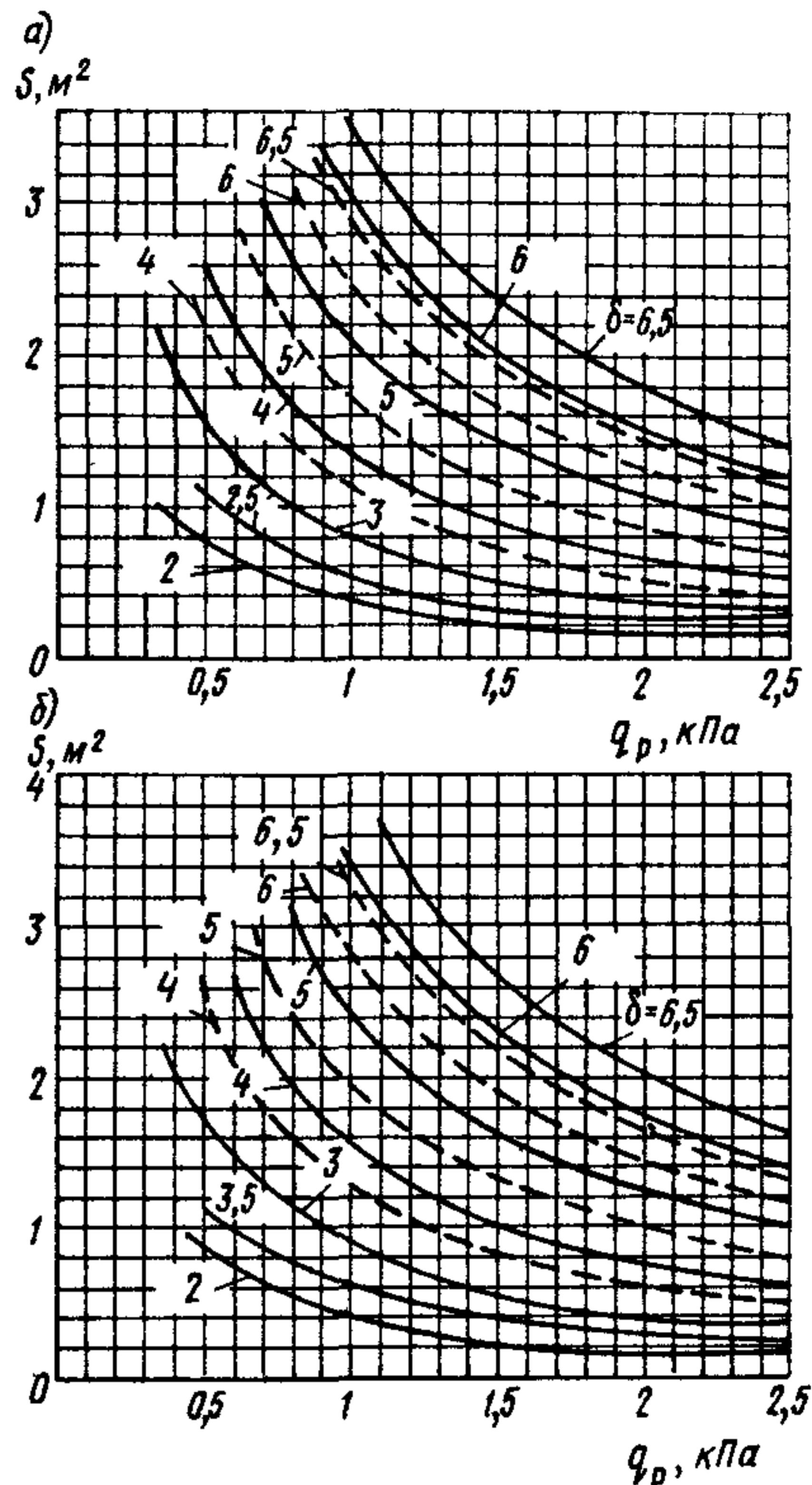
Рис 9 Графики зависимости максимально допустимой площади листов стекла  $S$  толщиной  $\delta$  мм, от нагрузки  $q_p$  и соотношения сторон  $\lambda$ .
