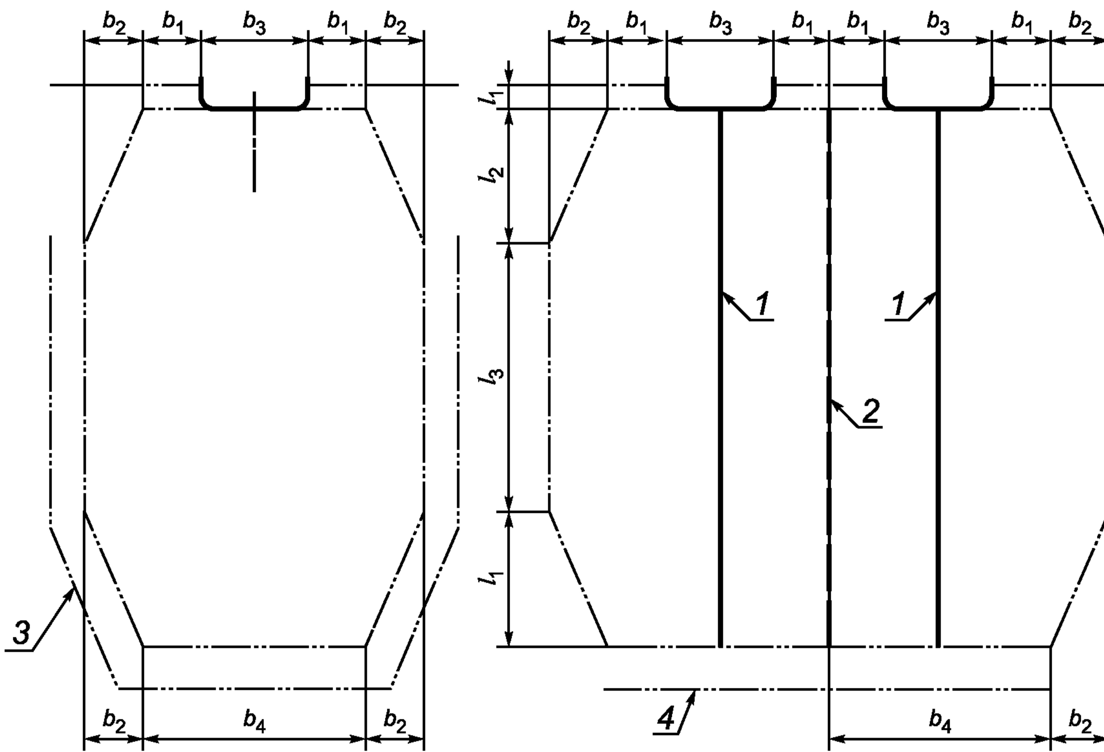
$$\begin{aligned} l_1 &= 200 \text{ мм}; & b_1 &= 500 \text{ мм}; \\ l_2 &= 1000 \text{ мм}; & b_2 &= 500 \text{ мм}; \\ l_3 &= 2000 \text{ мм}; & b_3 &= \text{ширина горки}; \\ b_4 &= b_3 + 2 b_1 \end{aligned}$$
