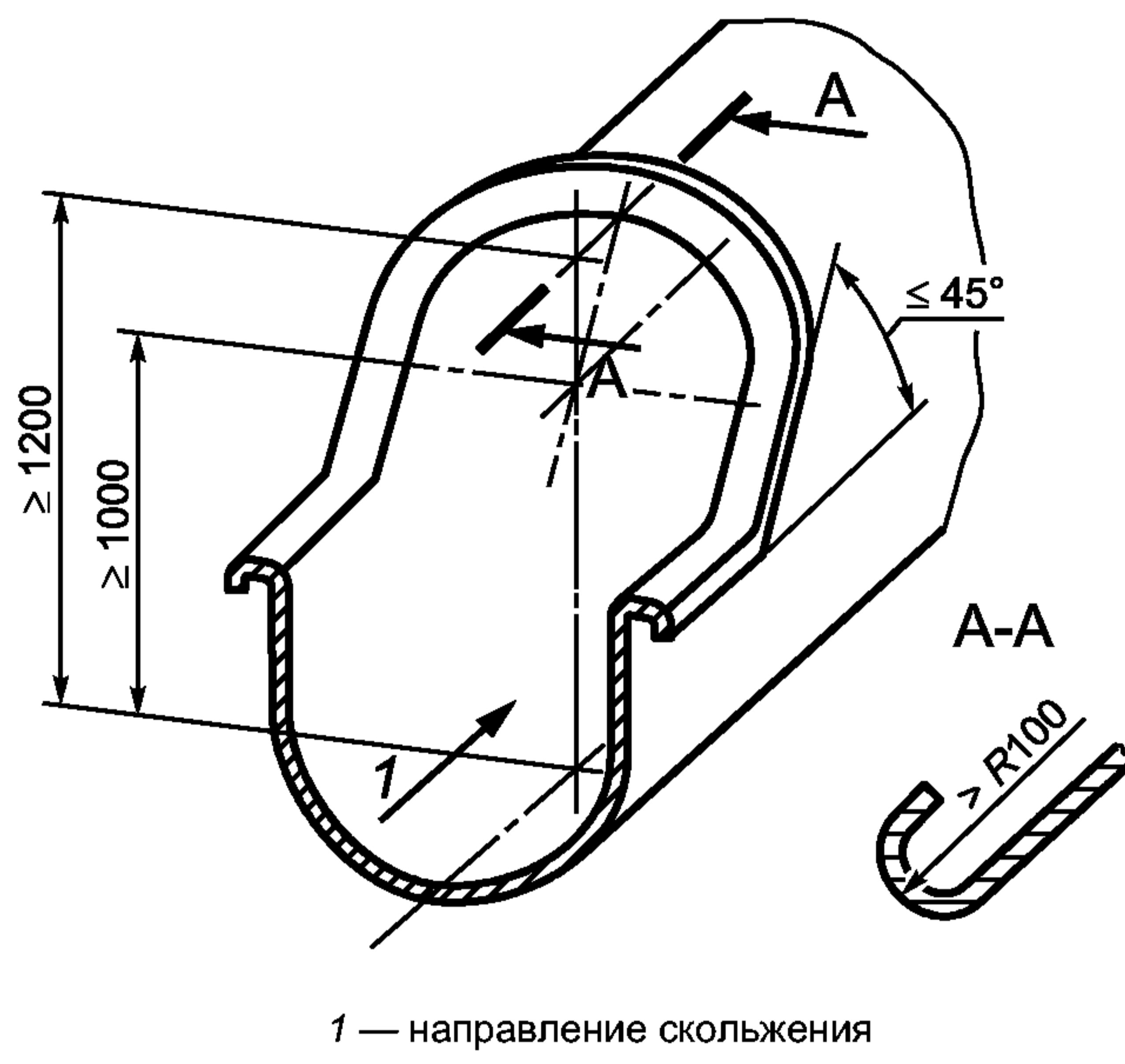
Рисунок 3 — Переход между элементами трассы спуска разной конструкции
