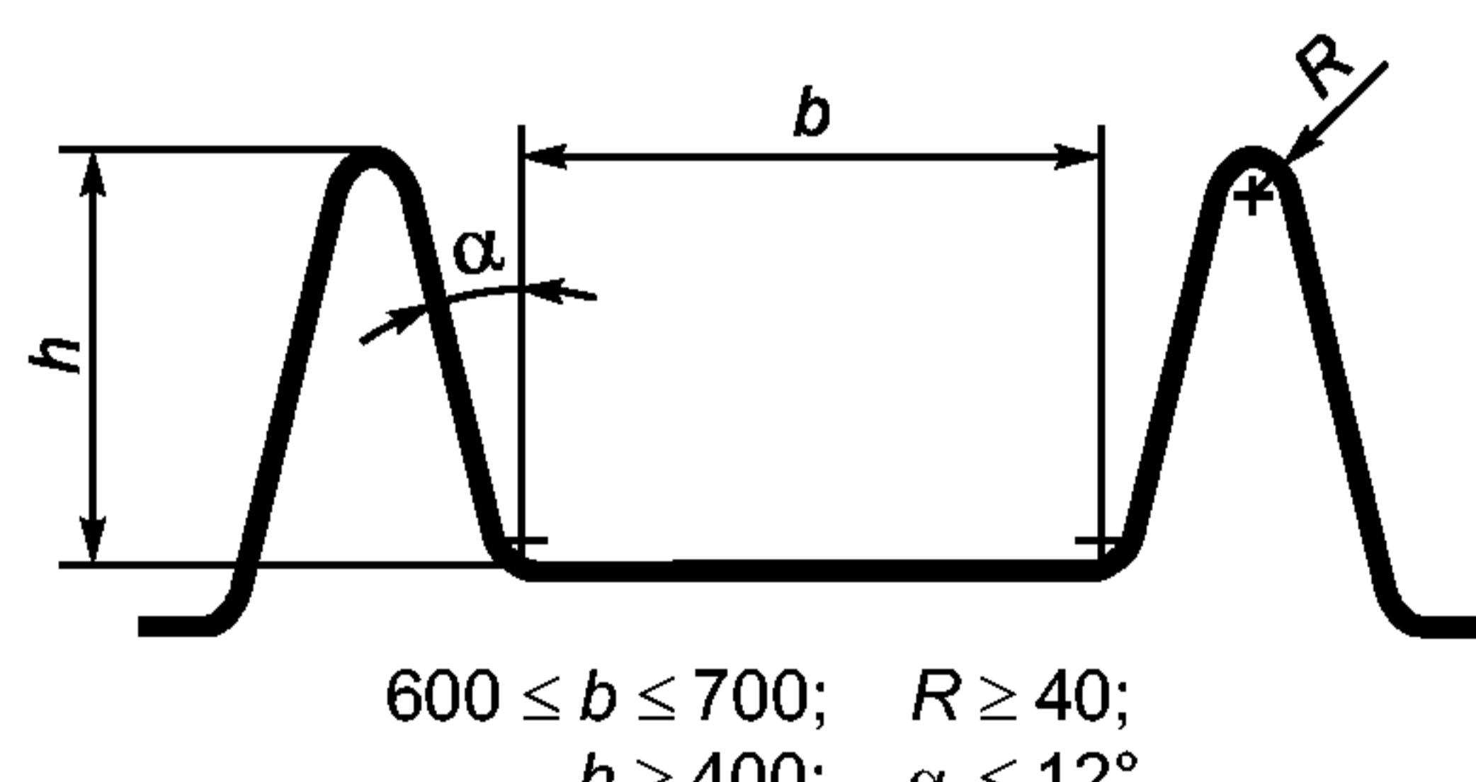
Рисунок 7 — Поперечное сечение горки типа 5
