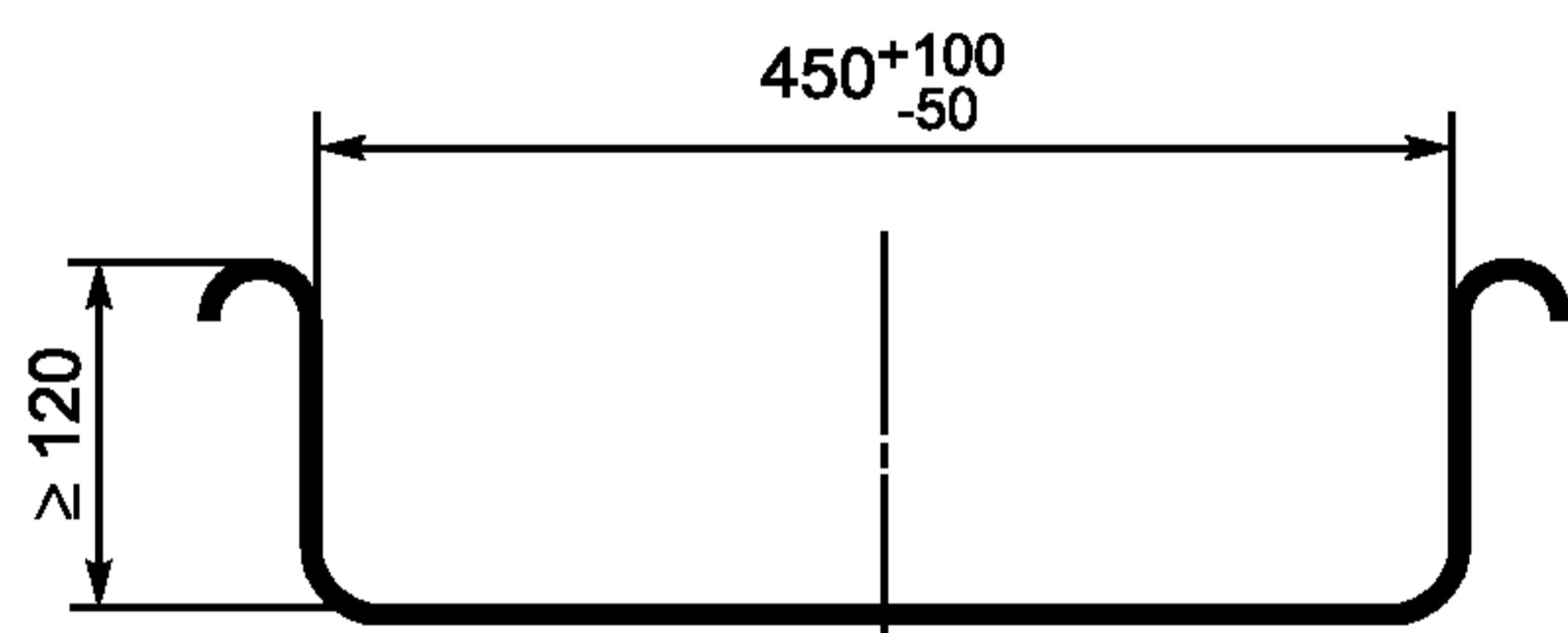
Рисунок 4 — Поперечное сечение горки типа 1
