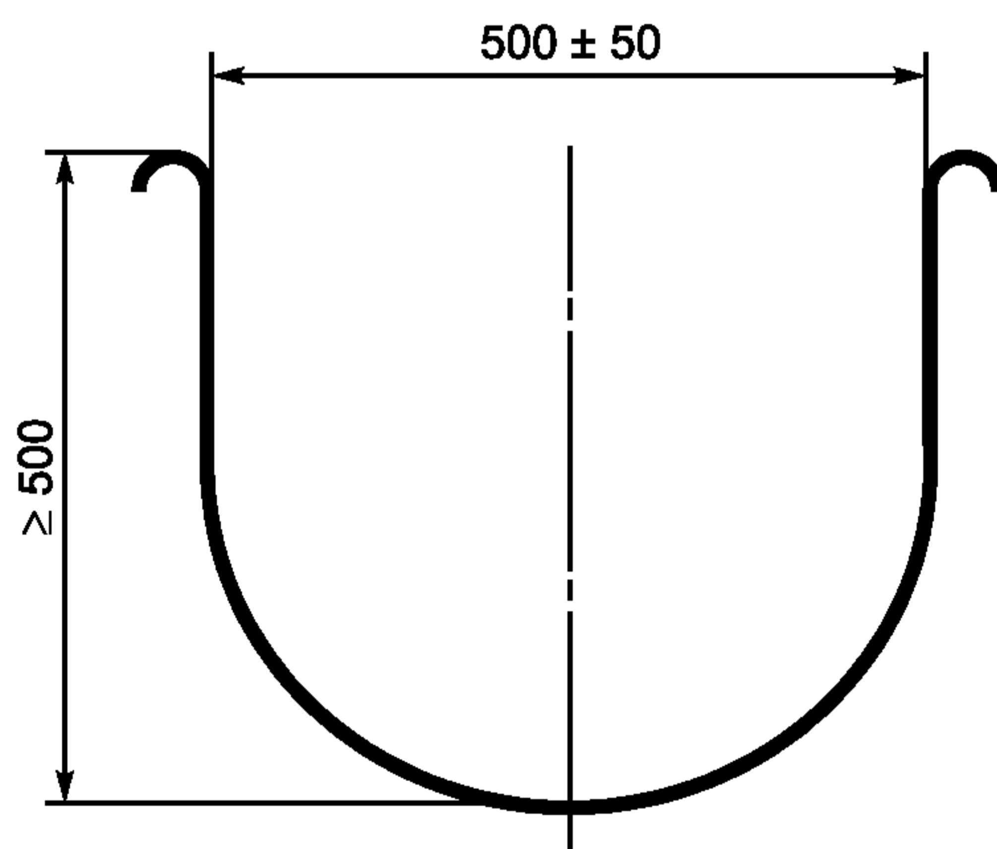
Рисунок 5 — Поперечное сечение горки типа 2
