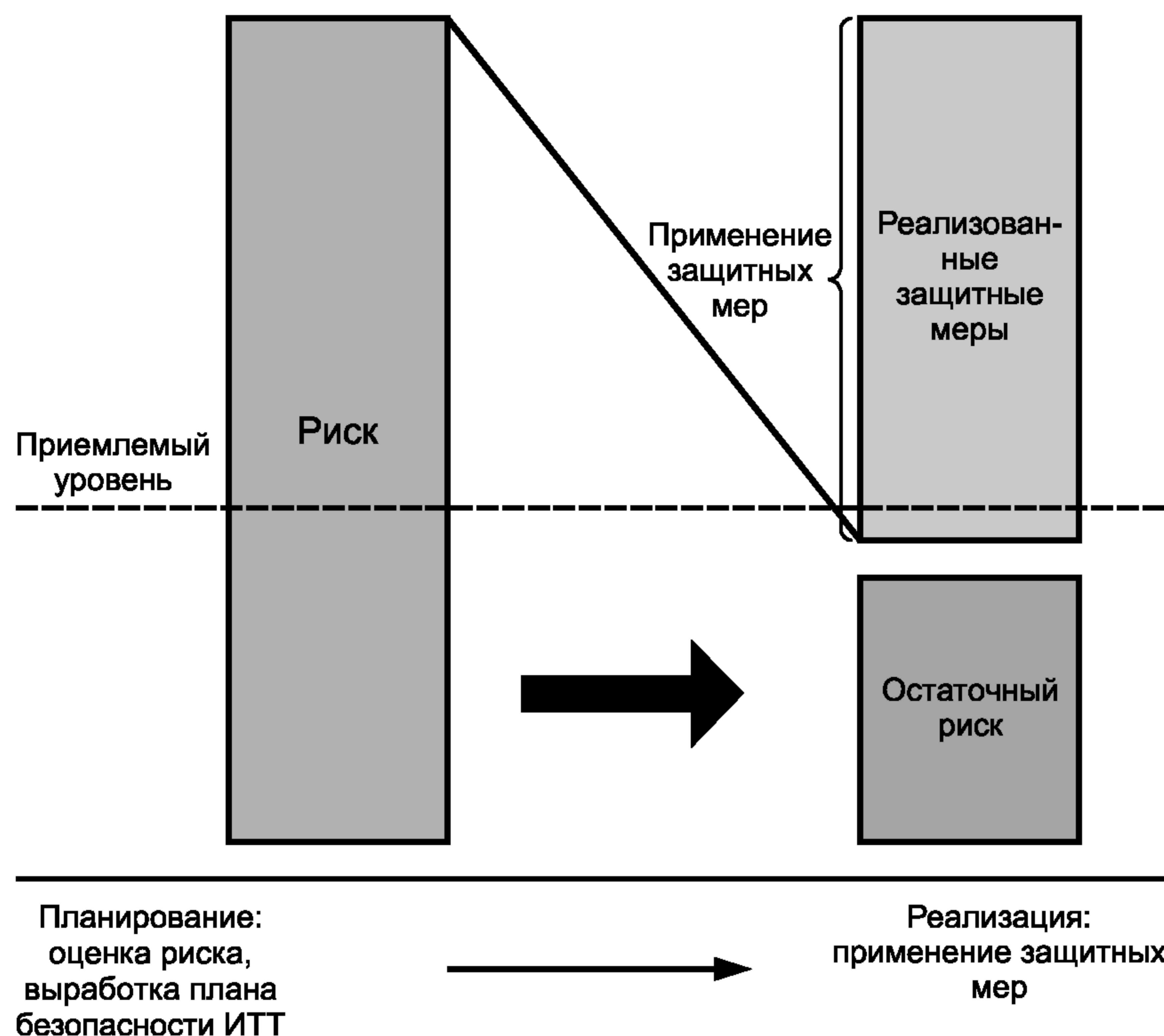
Рисунок 2 — Взаимосвязь защитных мер и риска
