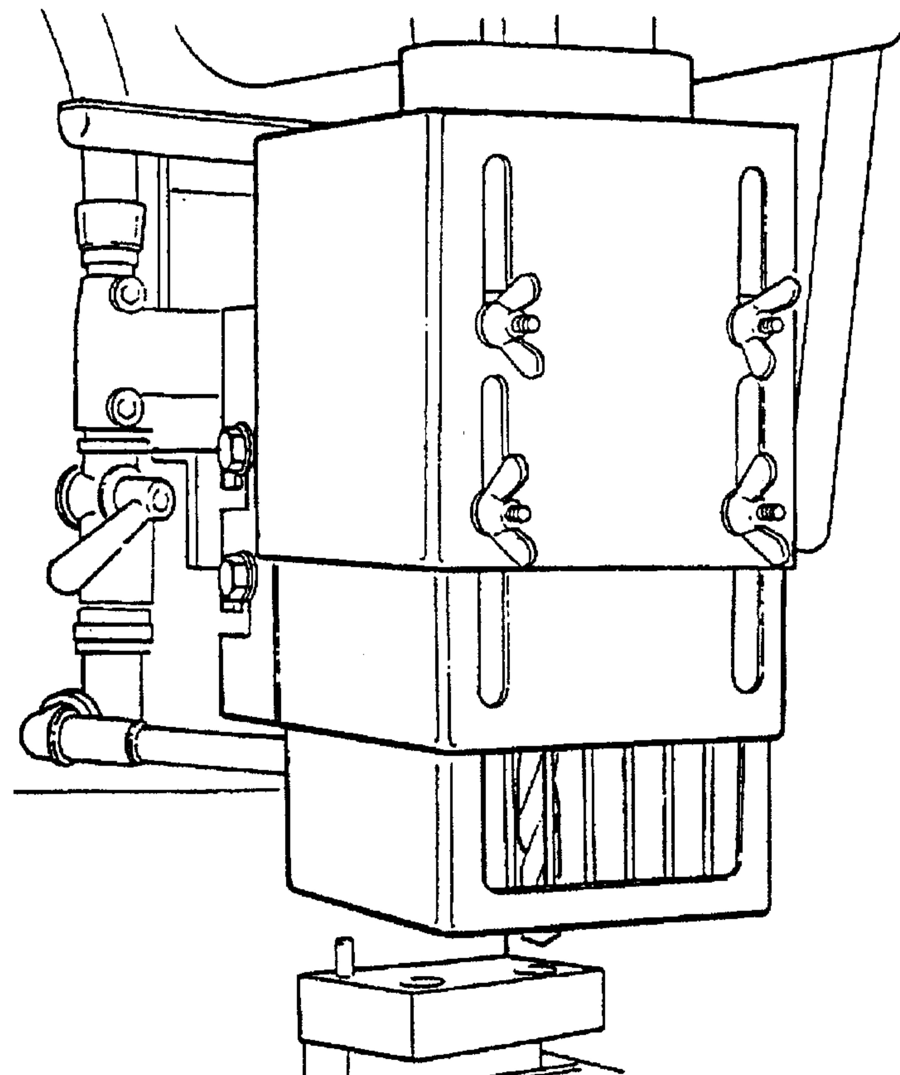
Рисунок А.6 (в) — Неподвижное регулируемое ограждение
