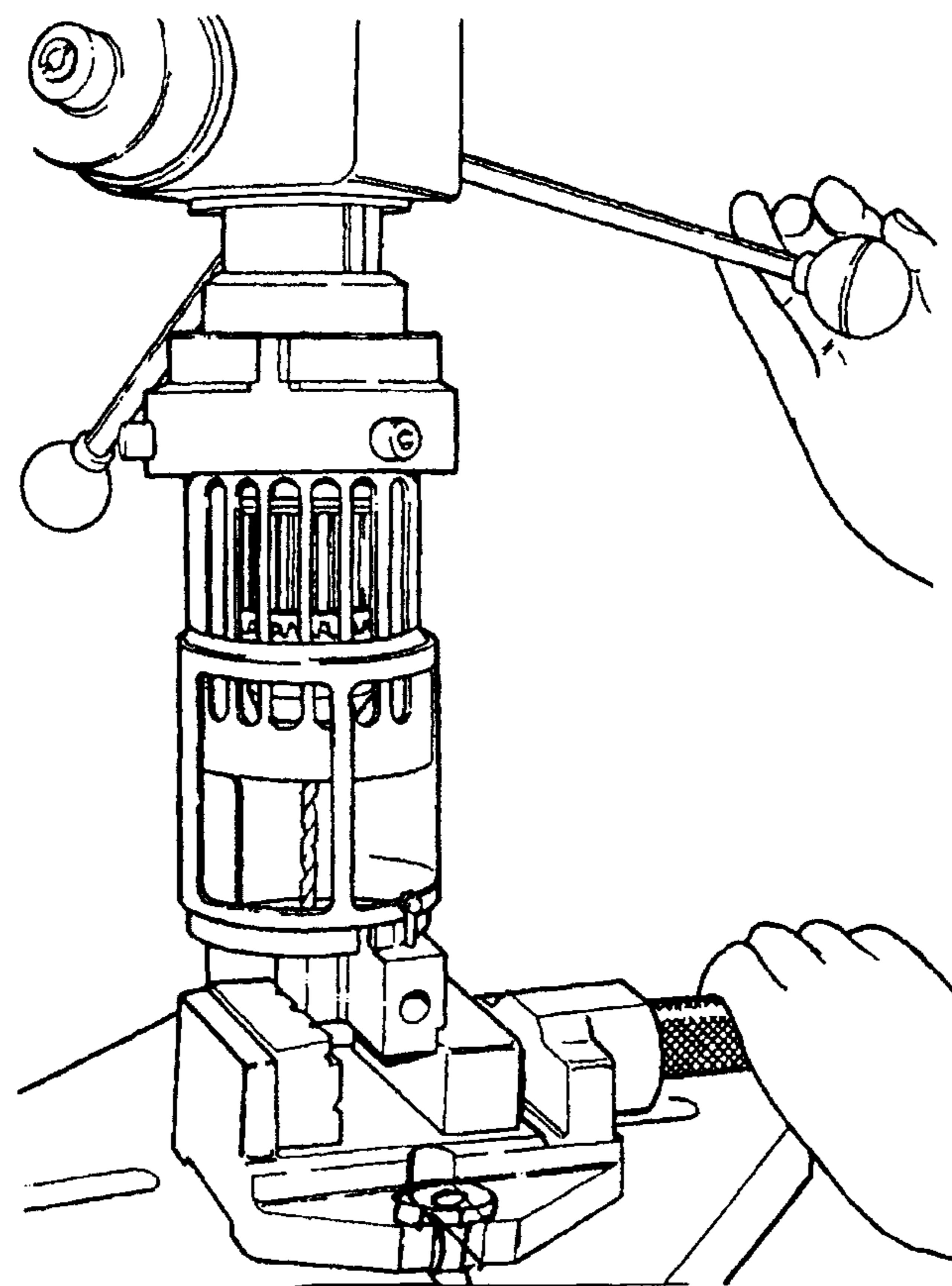
Рисунок А.6 (с) — Неподвижное регулируемое ограждение
