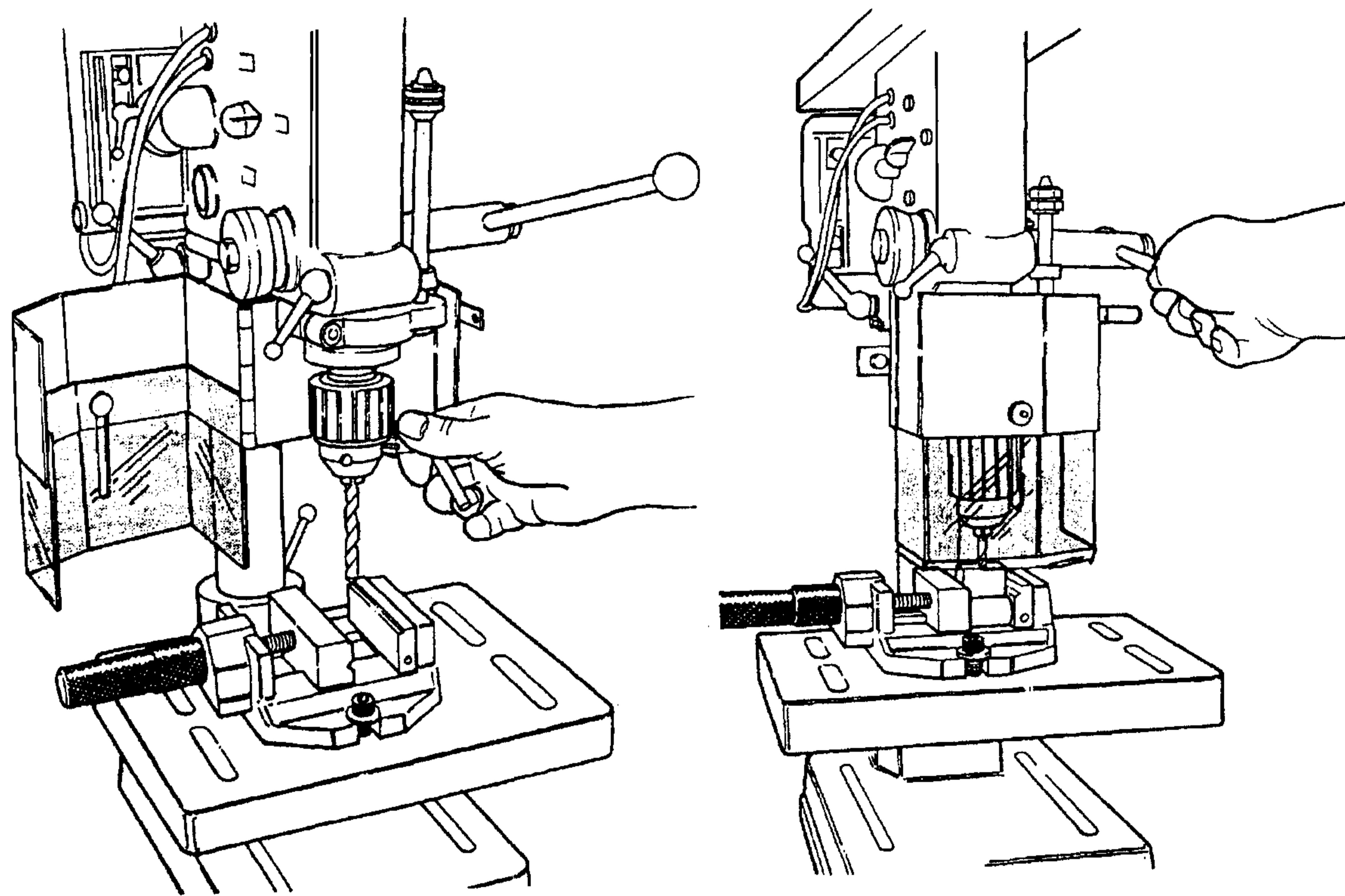
Рисунок А.6 (а) — Неподвижное регулируемое ограждение
