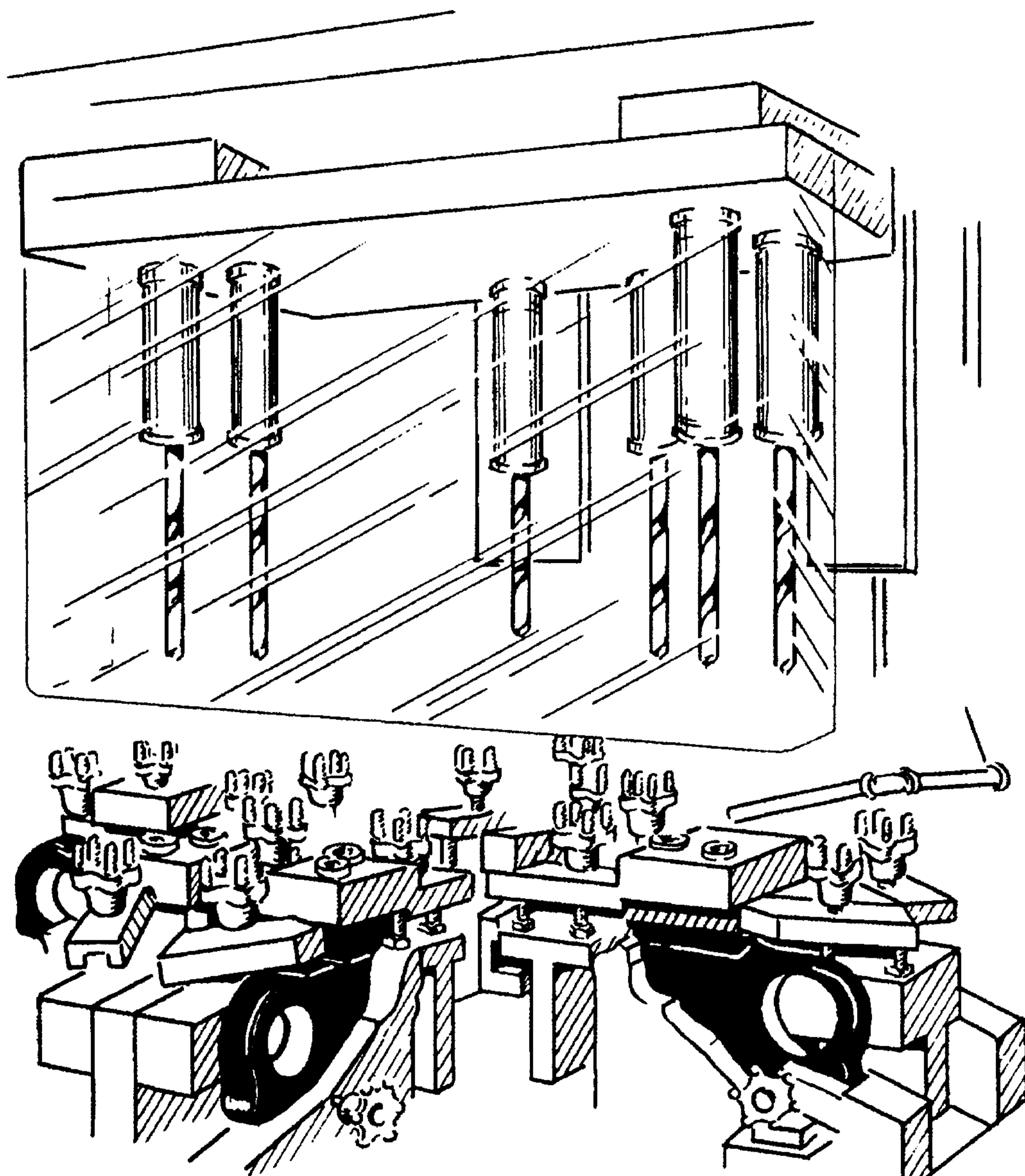
Рисунок А.5 — Многошпиндельный сверлильный станок
