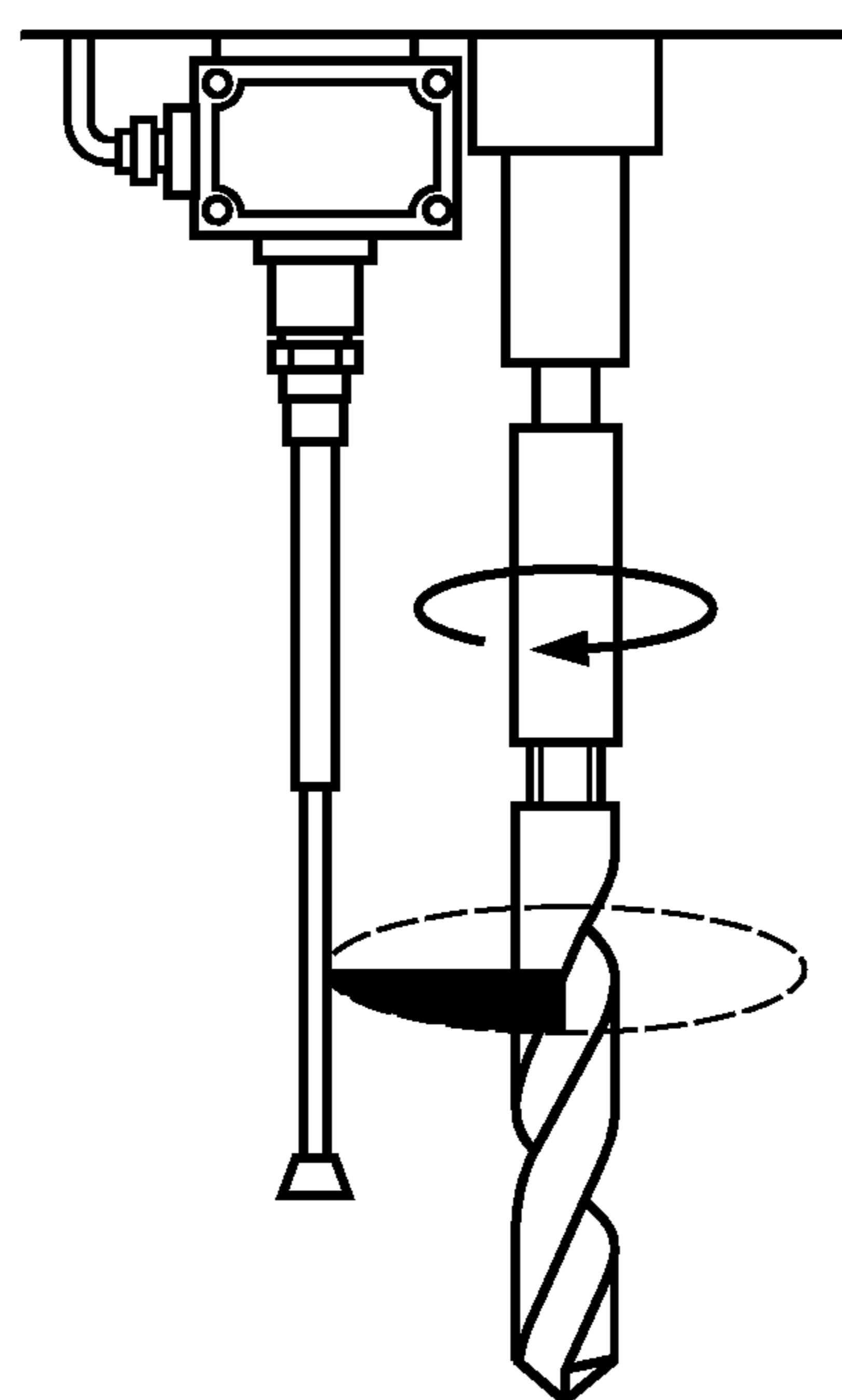
Рисунок А.7 — Телескопическое устройство для защиты сверла
