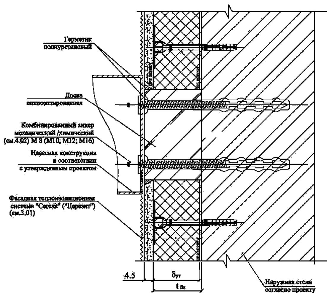
1. Допустимые нагрузки [кН] уточняются в проекте согласно расчету несущей способности элемента крепления и схемы установки анкеров, но не должны превышать следующих пороговых значений из расчета на один анкер [ $V_{эл}$ ], с учетом плеча прикладываемой нагрузки:
