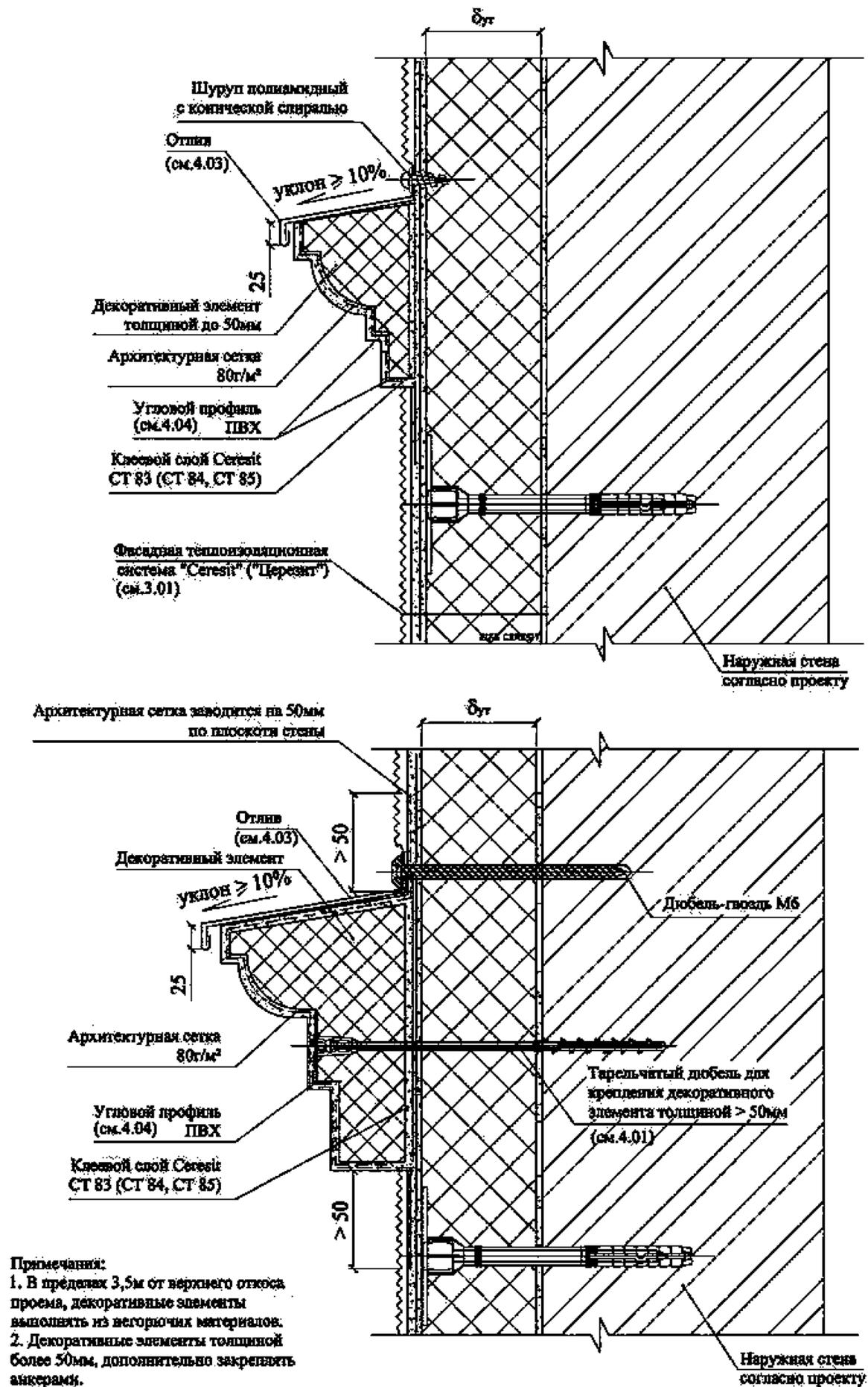
3.13 Конструктивное решение крепления двухслойной теплоизоляции толщиной более 200мм
