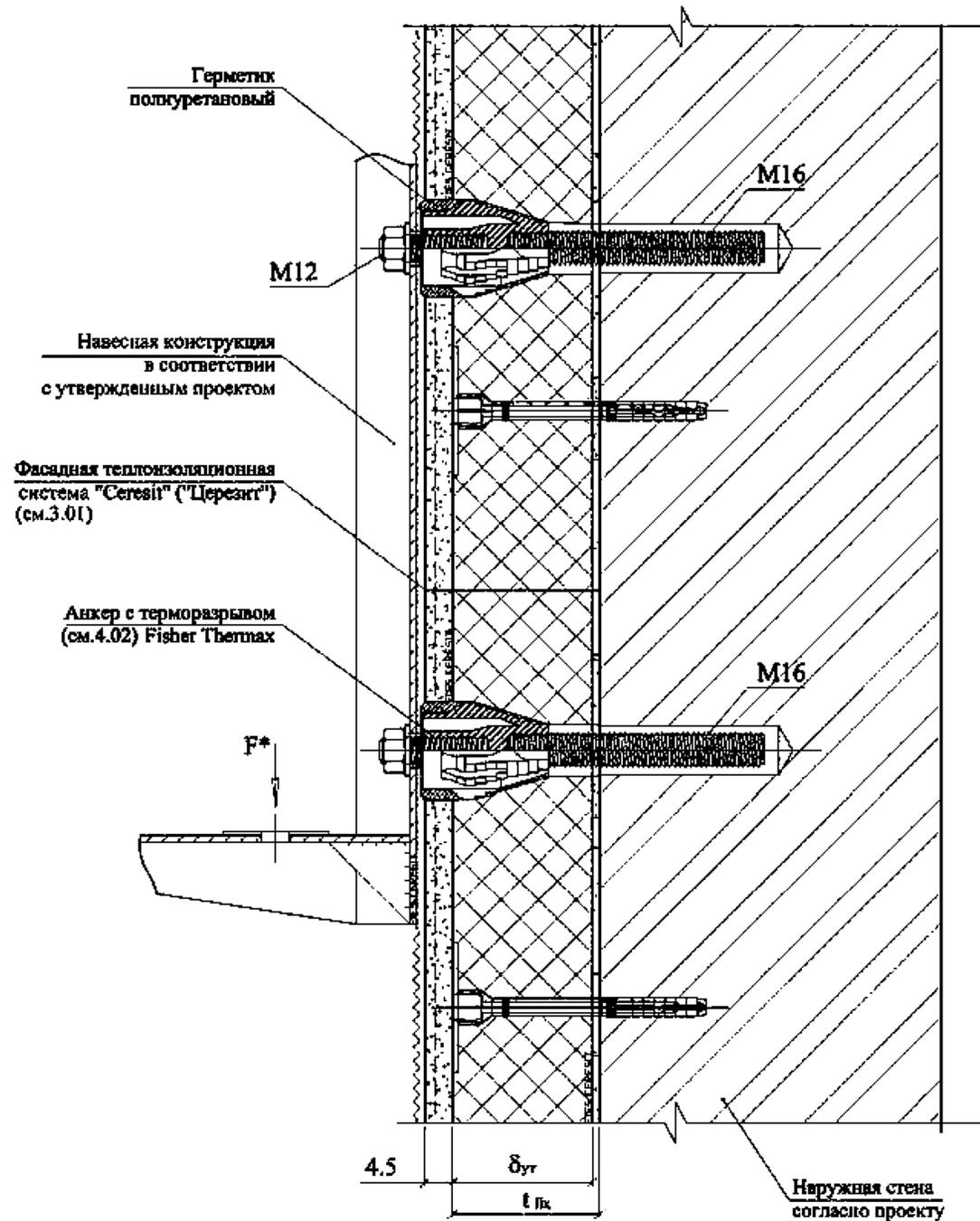
1. Допустимые нагрузки [кН] уточняются в проекте согласно расчету несущей способности элемента крепления и схемы установки анкеров, но не должны превышать следующих пороговых значений из расчета на один анкер [ $V_{зд}$ ], с учетом плеча прилагаемой нагрузки:
