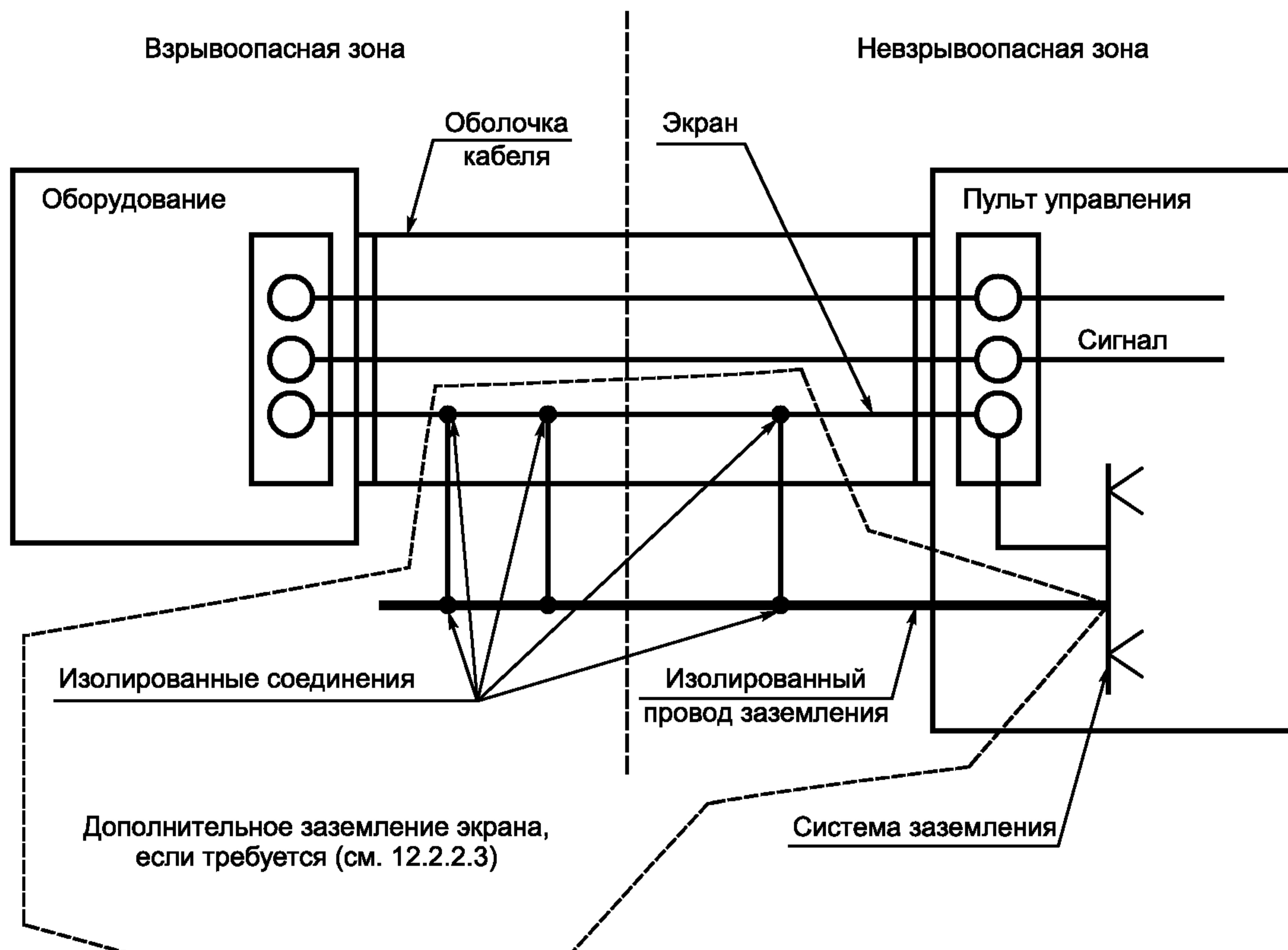
Рисунок 2 — Заземление проводящих экранов
