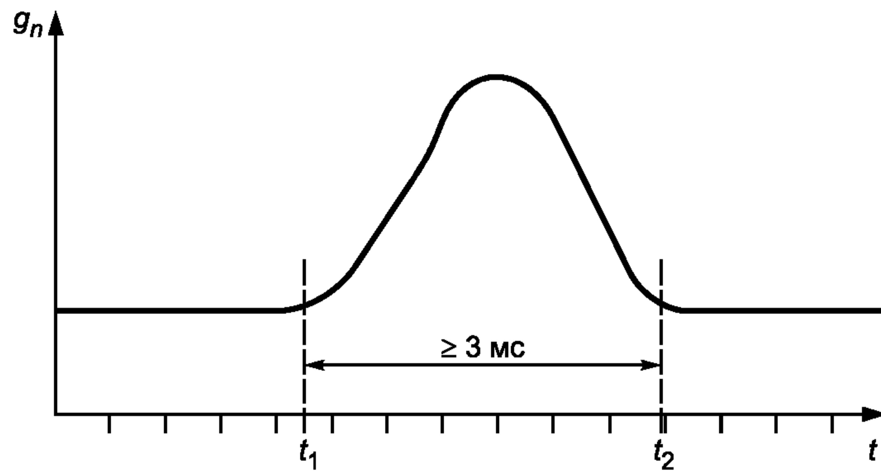
$g_n$  — ускорение,  $\text{м/с}^2$ ;  $t$  — время, с;  $t_1, t_2$  — продолжительность удара  $\geq 3 \text{ мс}$
