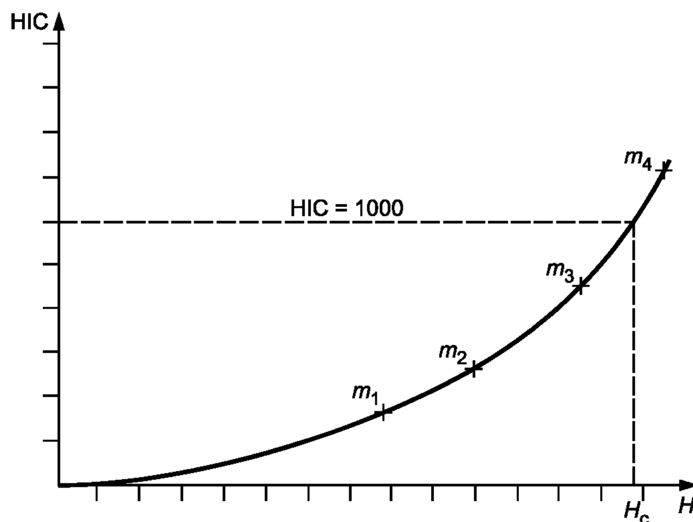
$m_1, m_2, m_3, m_4$  — точки измерения удара;  $H$  — высота сбрасывания;  $H_c$  — критическая высота падения
