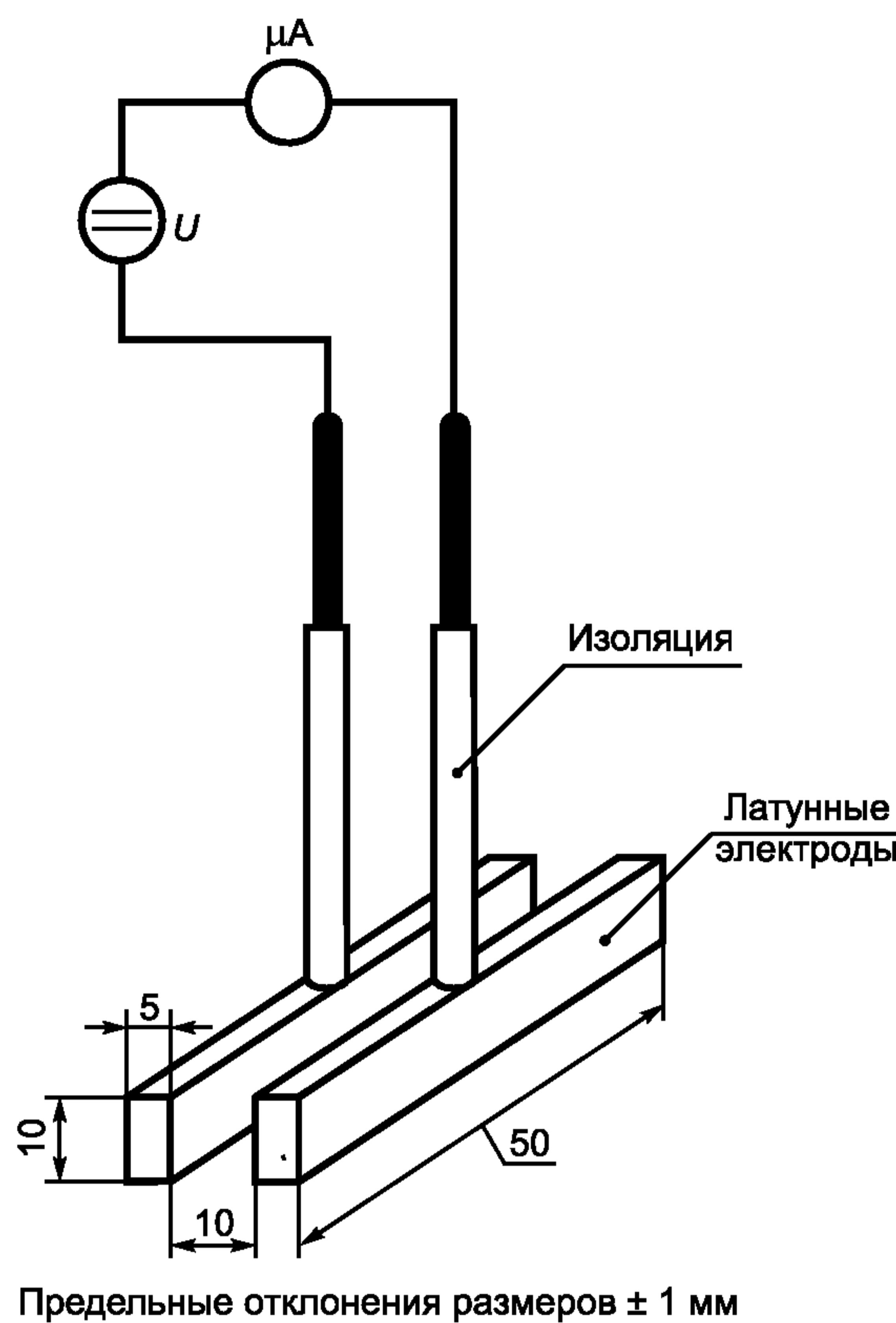
Рисунок 1 — Испытательная установка для определения диэлектрических свойств заполнителя
