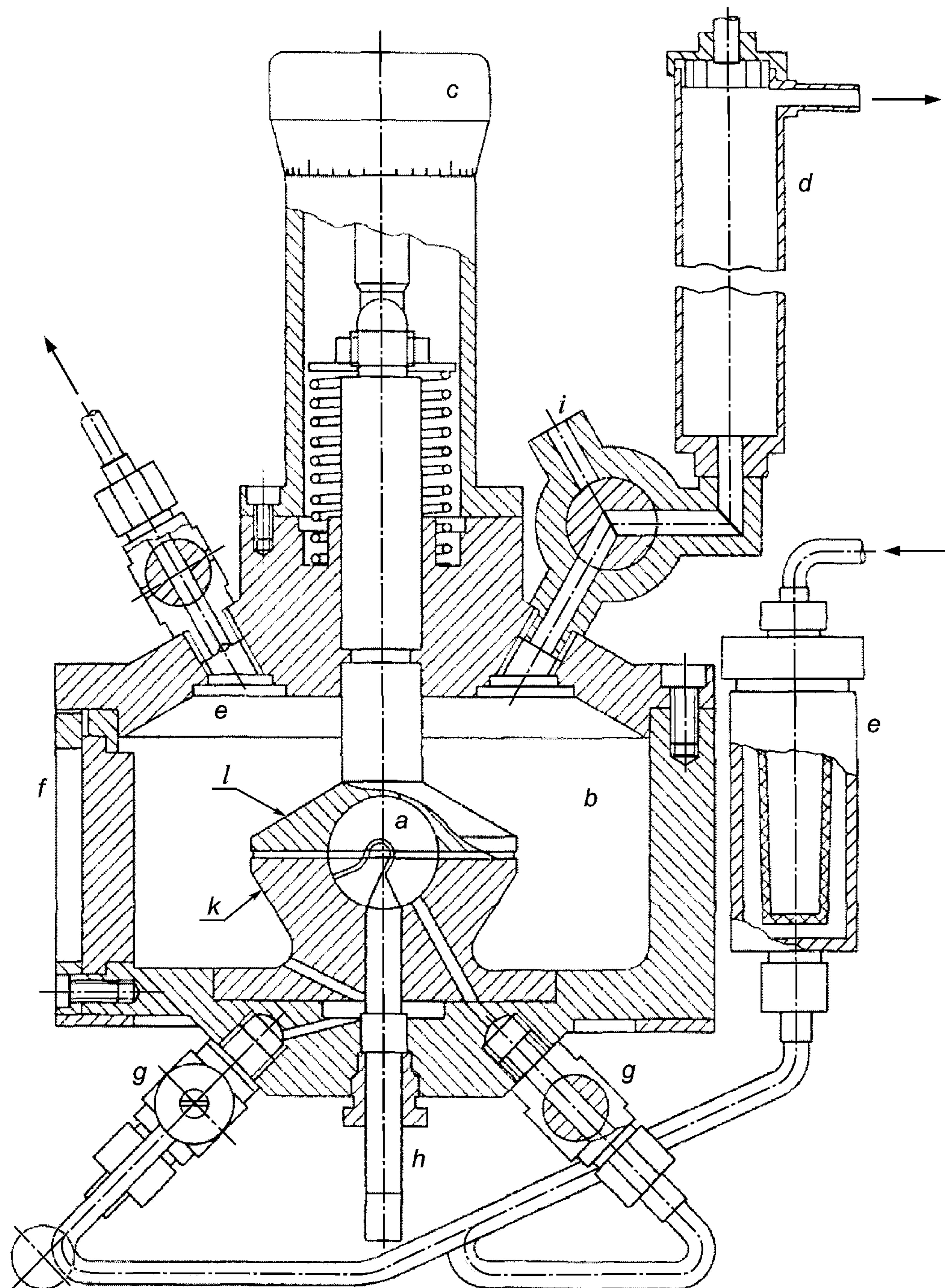
а — внутренняя камера; б — внешняя цилиндрическая оболочка; в — микрометрический винт; г — выходное отверстие;
