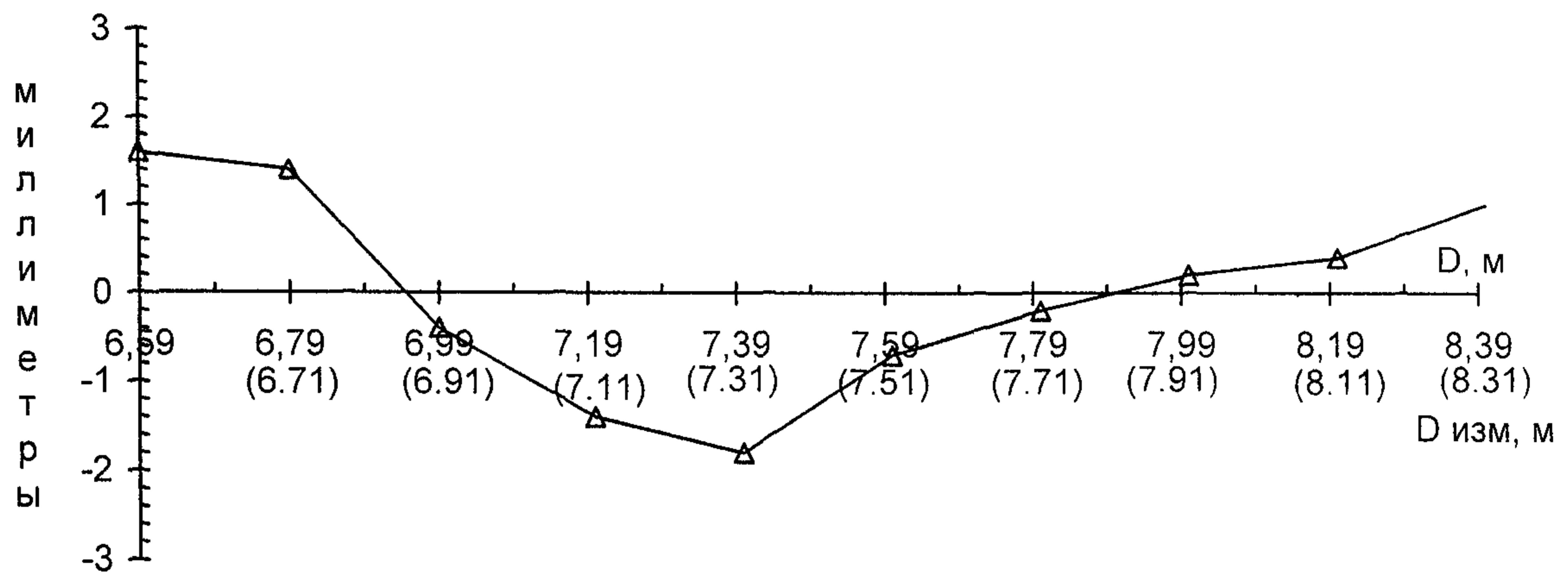
Рис.2 График поправок циклической погрешности
