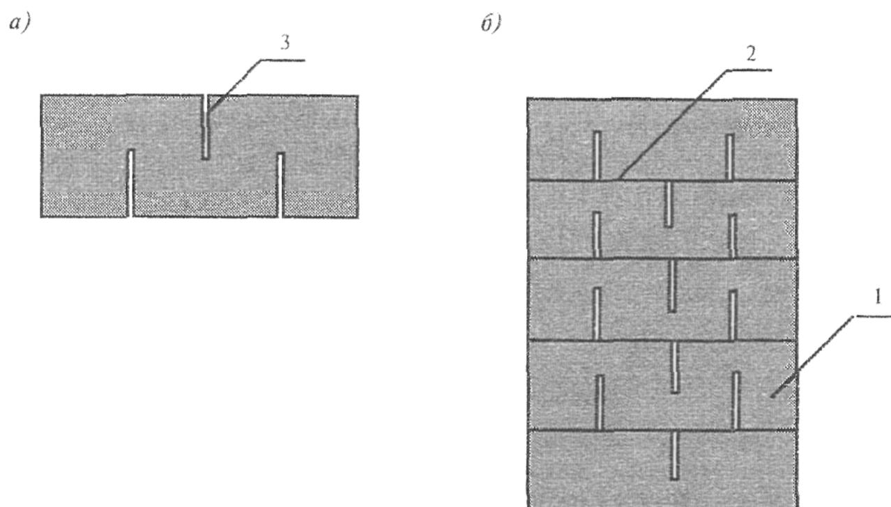
1 — слой; 2 — фрезерованные пласти; 3 — прорези
