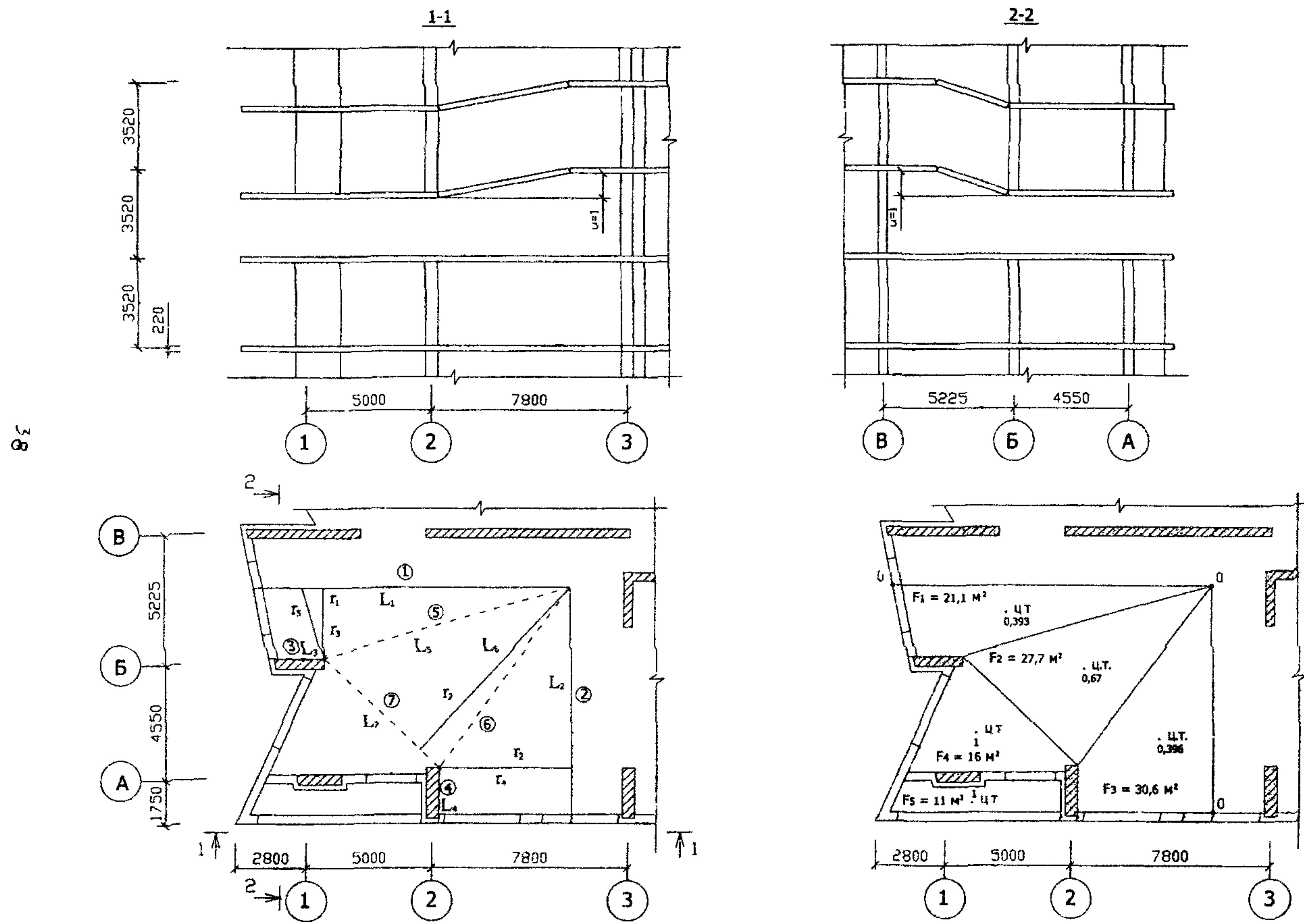
РИСУНОК А1.12 СХЕМА 3. ВАРИАНТ 3. МЕХАНИЗМ ОБРУШЕНИЯ ПЕРВОГО ТИПА.
