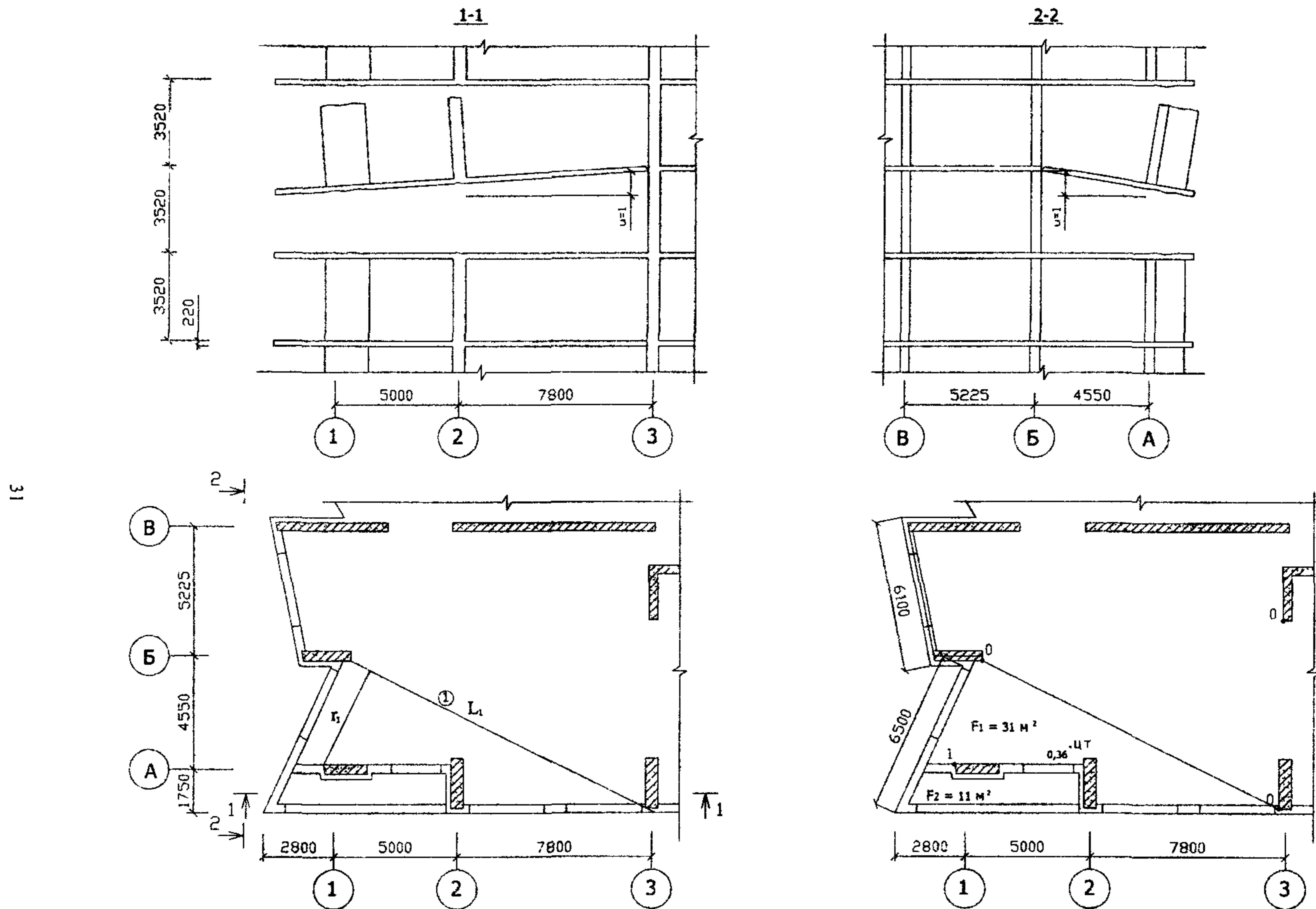
РИСУНОК А19 СХЕМА 2. МЕХАНИЗМ ОБРУШЕНИЯ ЧЕТВЕРТОГО ТИПА
