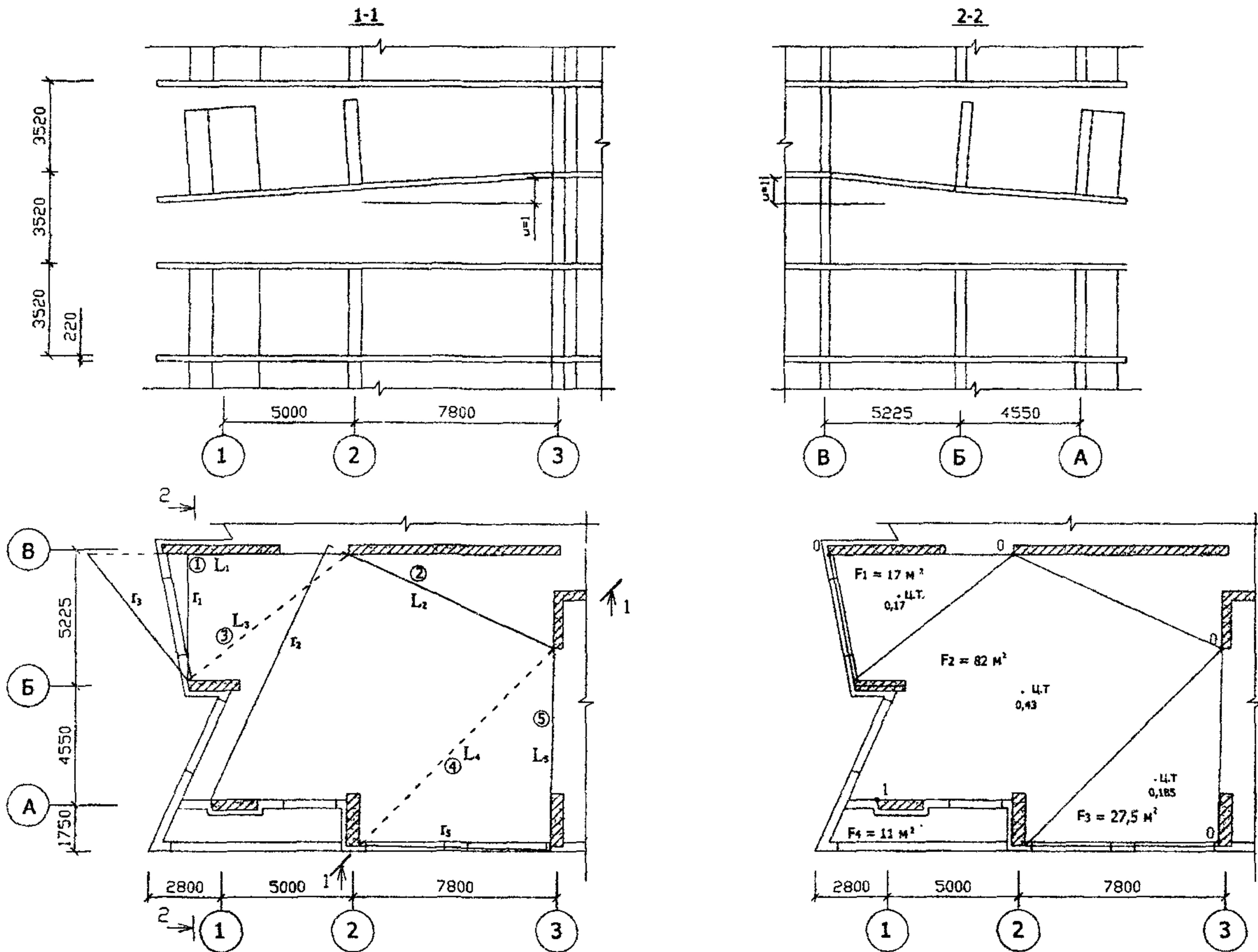
РИСУНОК А1.15 СХЕМА 3. МЕХАНИЗМ ОБРУШЕНИЯ ЧЕТВЕРТОГО ТИПА.
