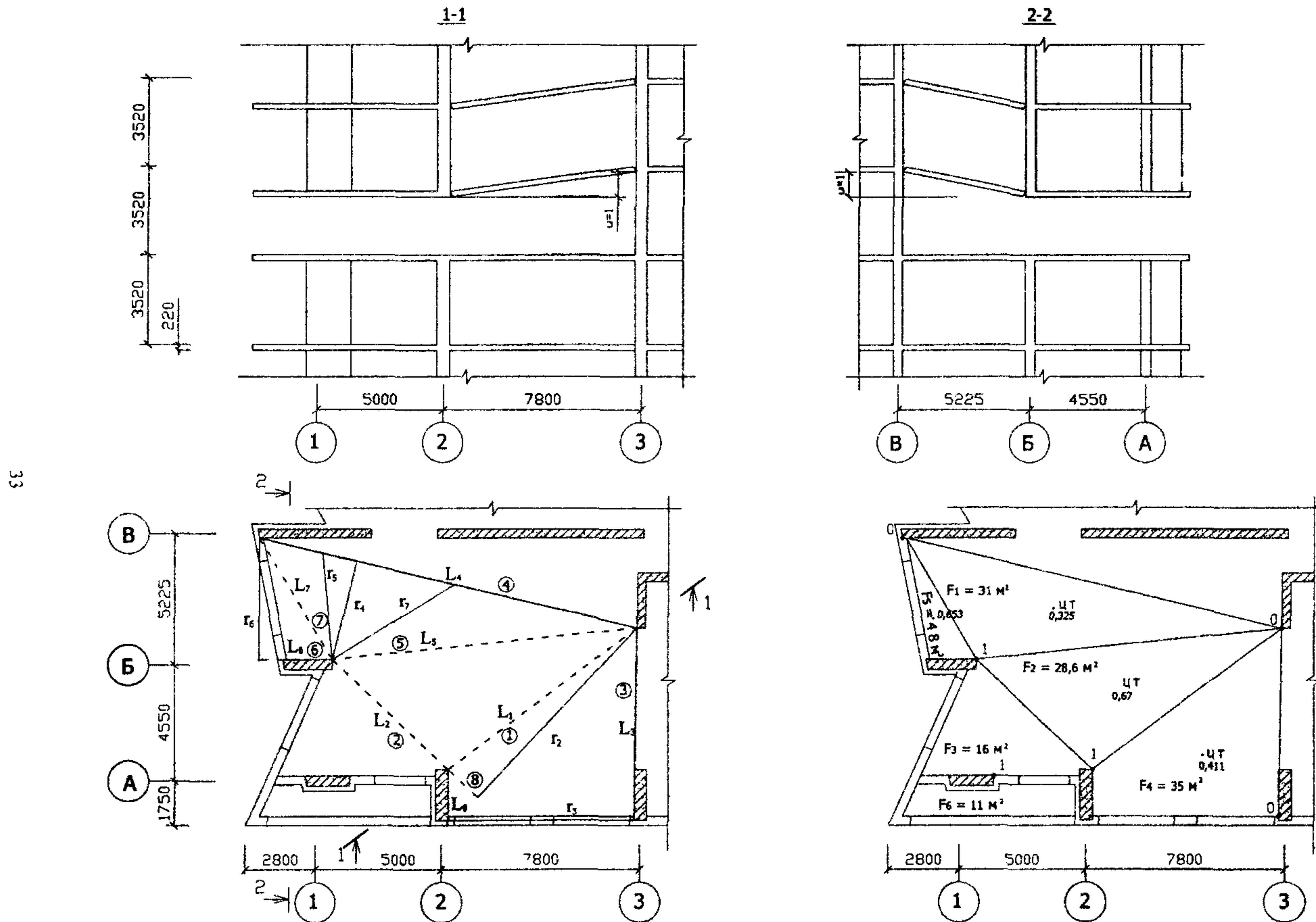
РИСУНОК А1 10 СХЕМА 1 ВАРИАНТ 1 МЕХАНИЗМ ОБРУШЕНИЯ ПЕРВОГО ТИПА.
