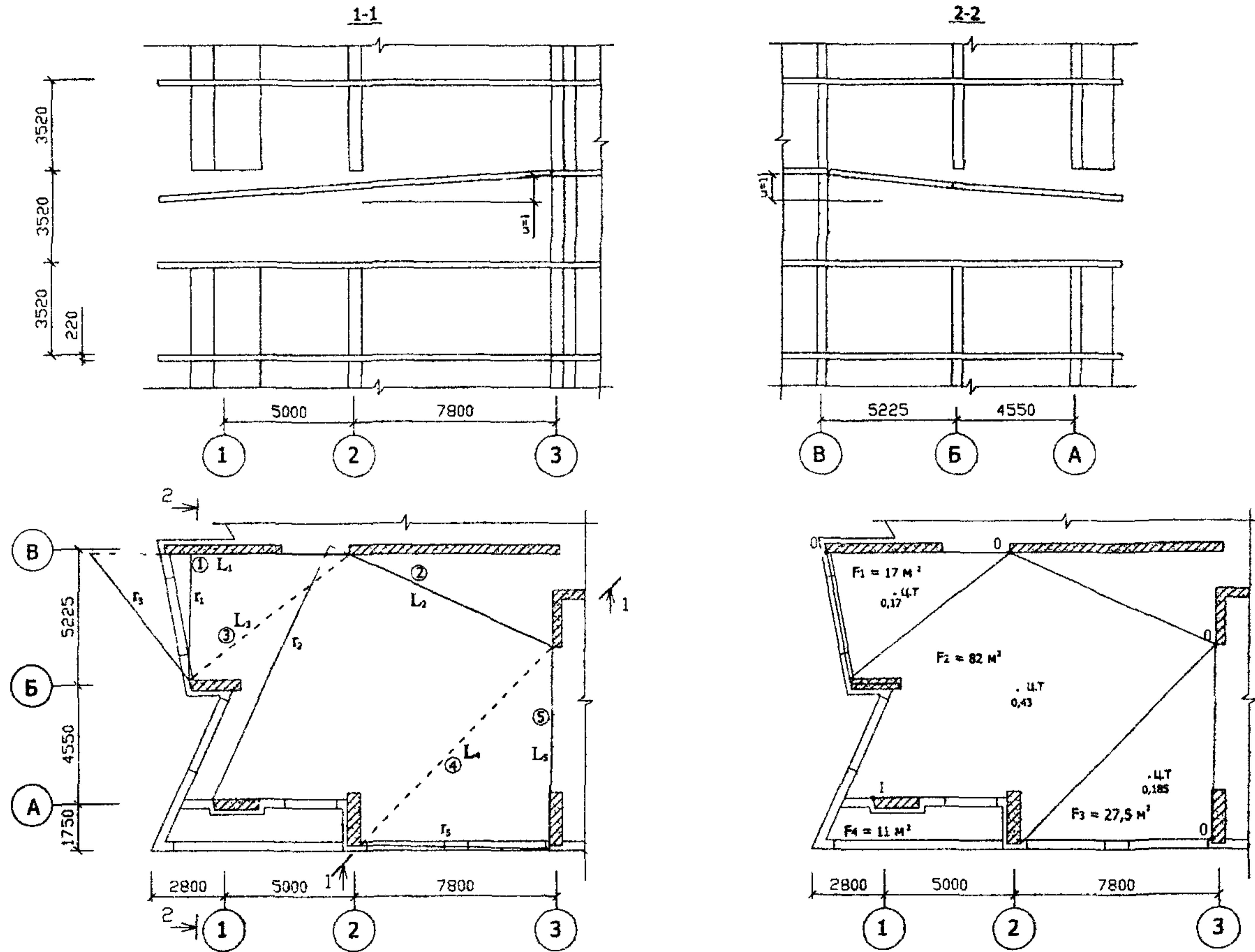
РИСУНОК А1.14 СХЕМА 3 МЕХАНИЗМ ОБРУШЕНИЯ ТРЕТЬЕГО ТИПА.
