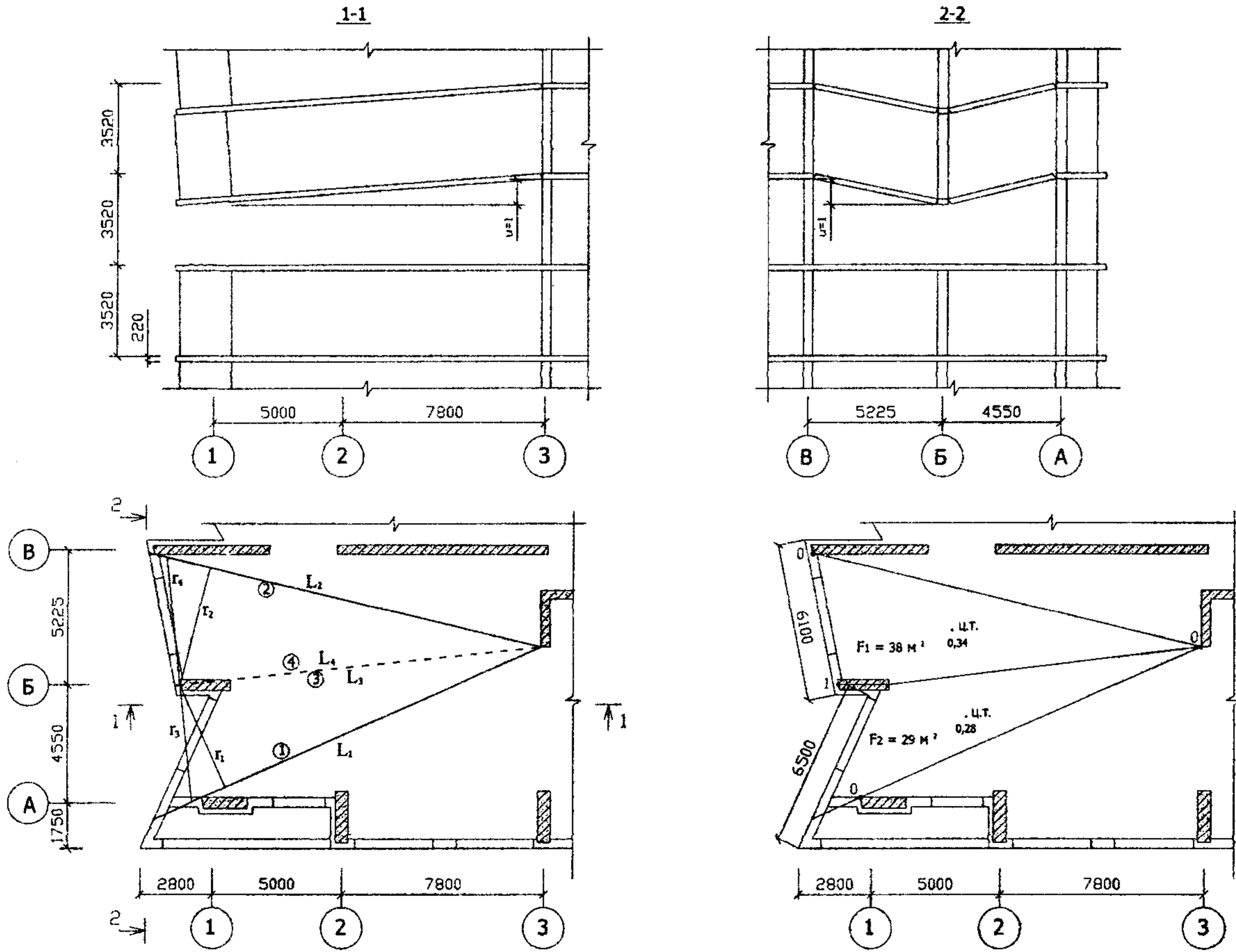
РИСУНОК А1.3 СХЕМА 1. МЕХАНИЗМ ОБРУШЕНИЯ ВТОРОГО ТИПА.
