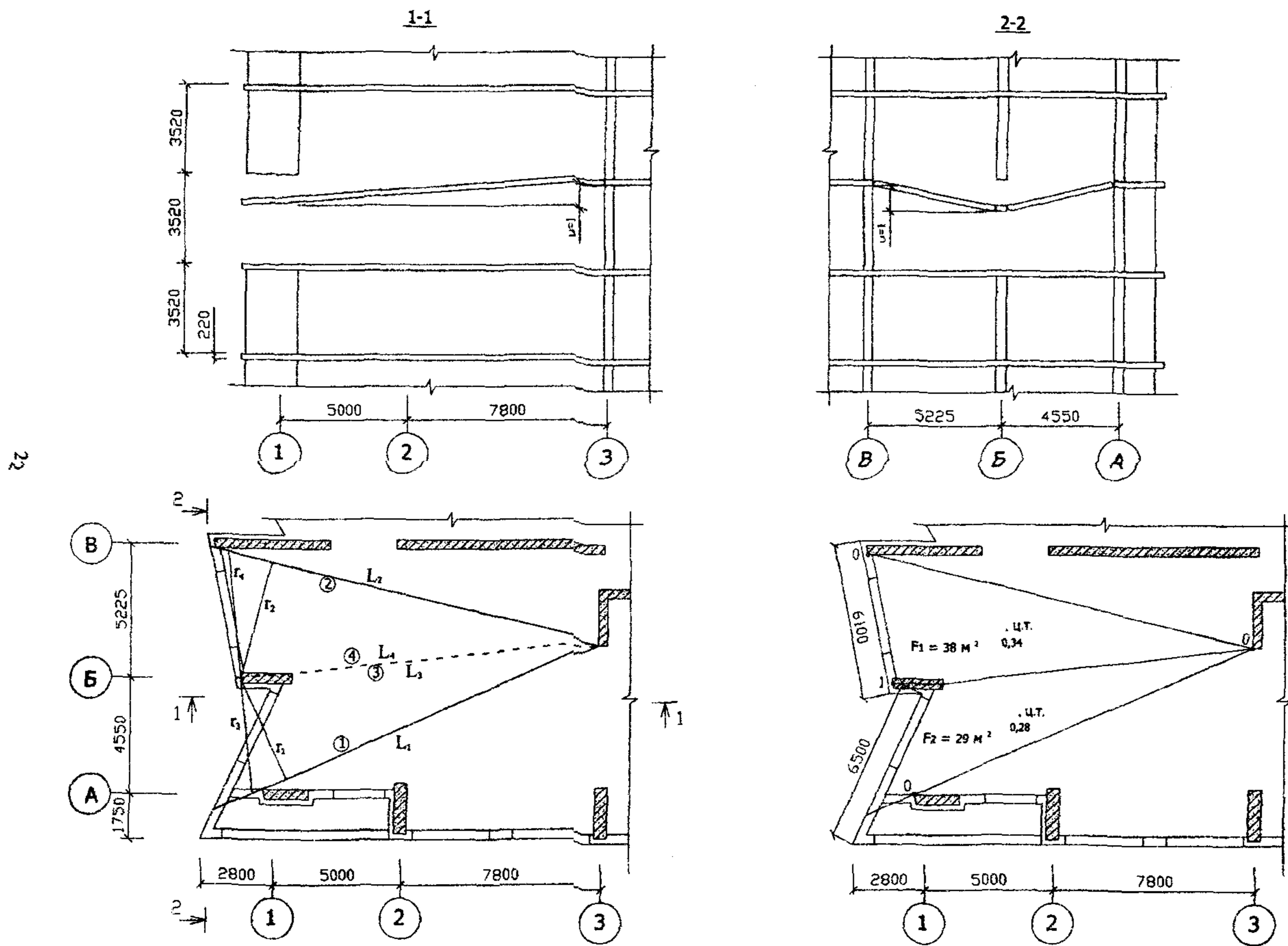
РИСУНОК А1.4 СХЕМА 1. МЕХАНИЗМ ОБРУШЕНИЯ ТРЕТЬЕГО ТИПА.
