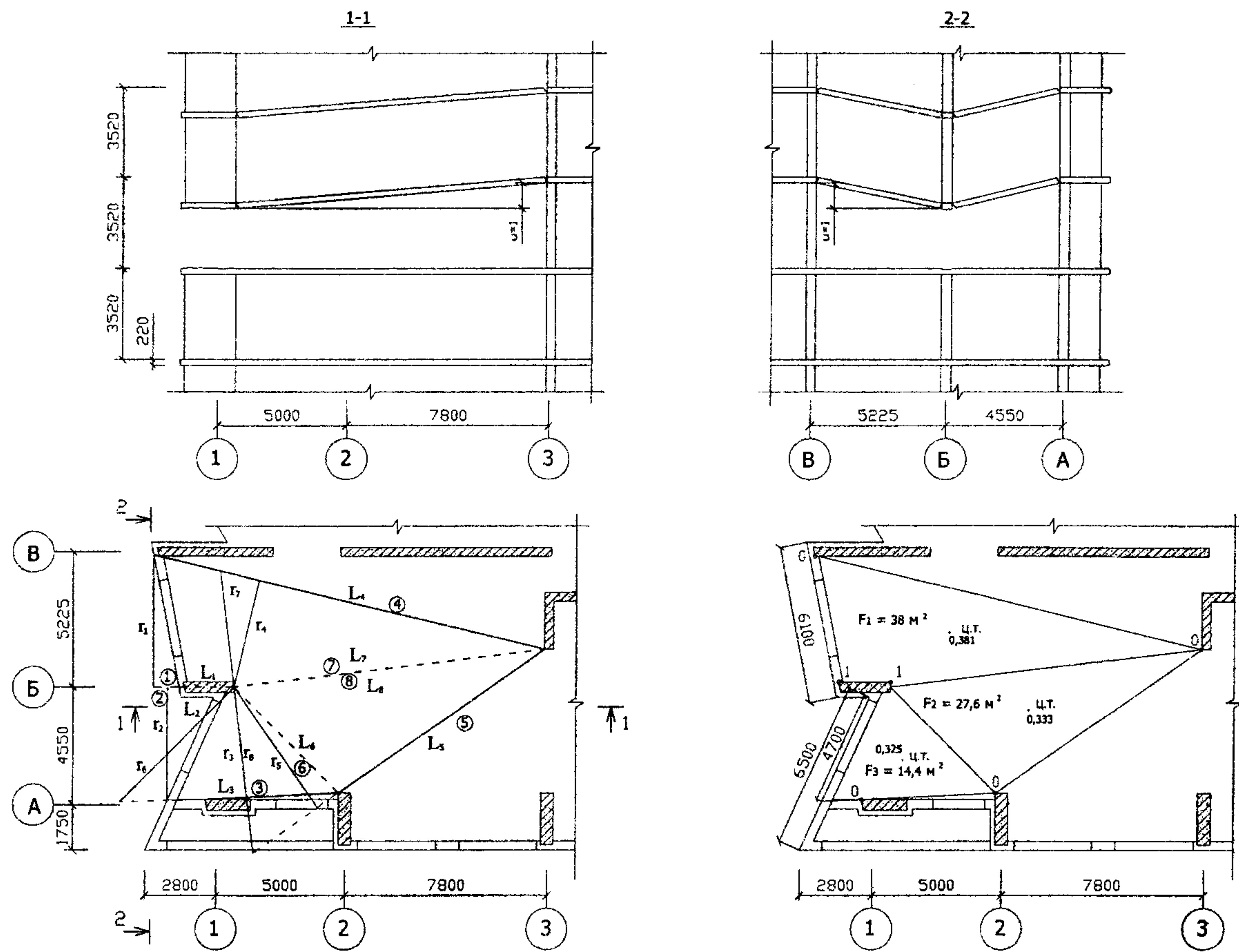
РИСУНОК А1.2 СХЕМА 1. МЕХАНИЗМ ОБРУШЕНИЯ ПЕРВОГО ТИПА.
