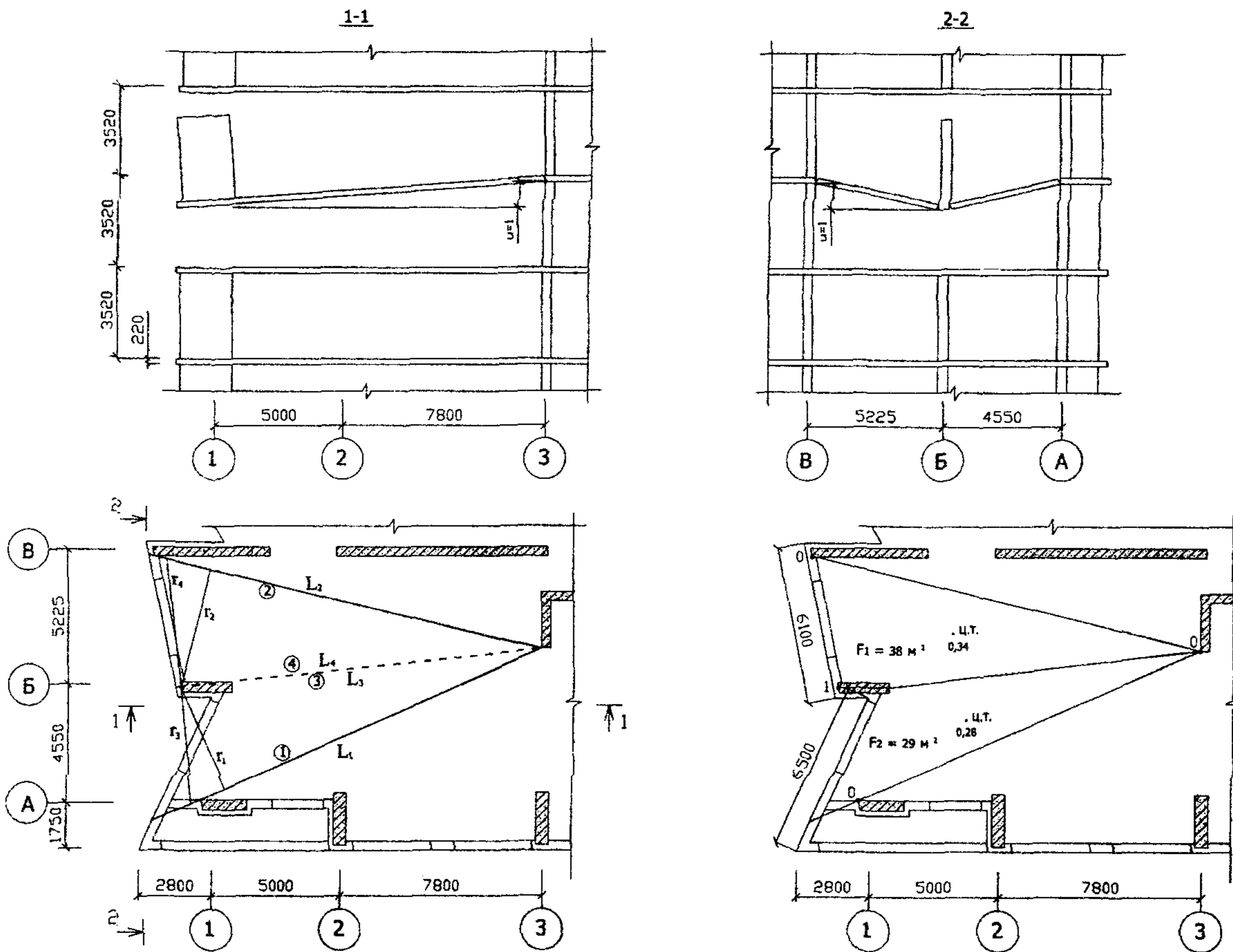
РИСУНОК А1.5 СХЕМА 1. МЕХАНИЗМ ОБРУШЕНИЯ ЧЕТВЕРТОГО ТИПА.
