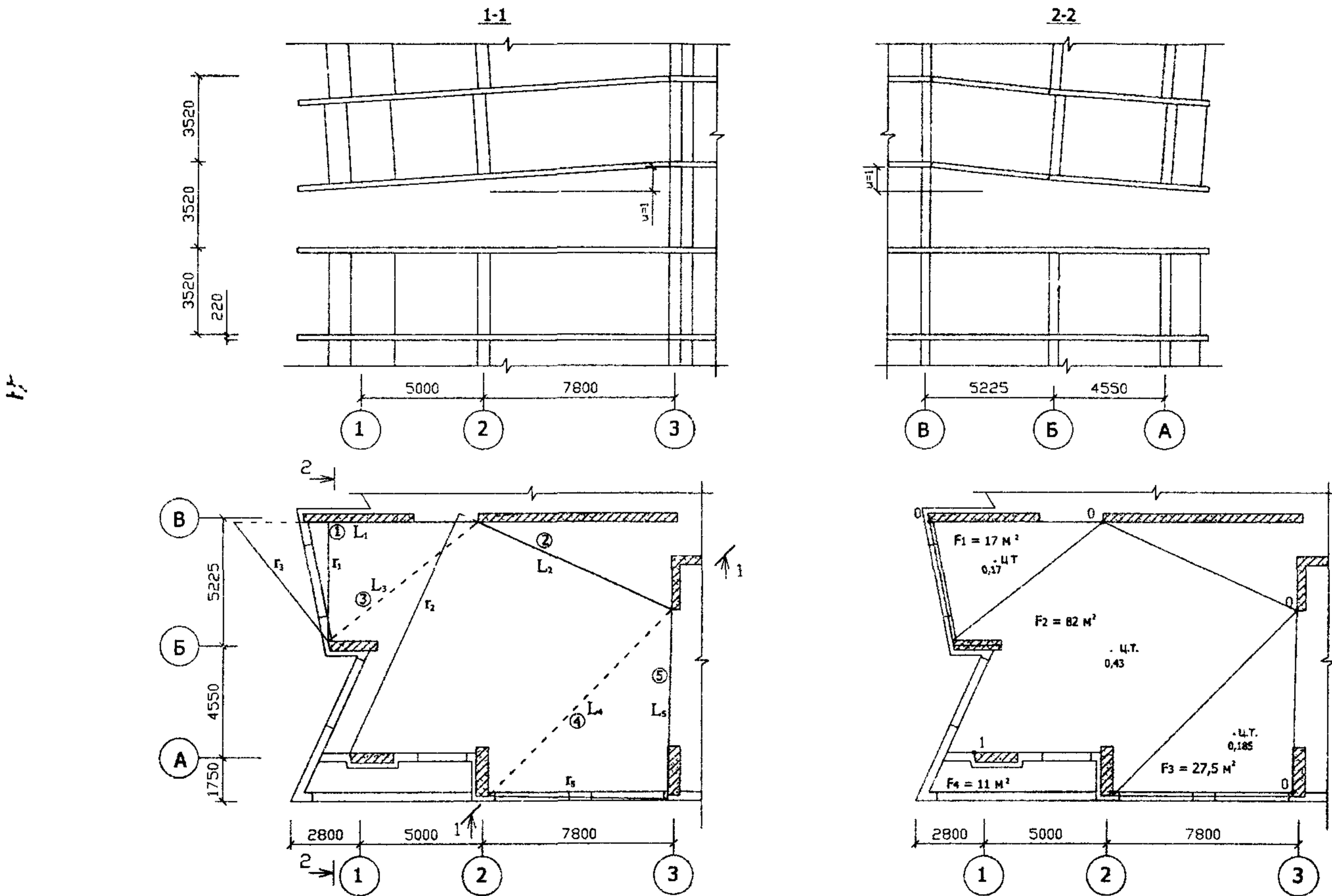
РИСУНОК А1.13 СХЕМА 3. МЕХАНИЗМ ОБРУШЕНИЯ ВТОРОГО ТИПА.
