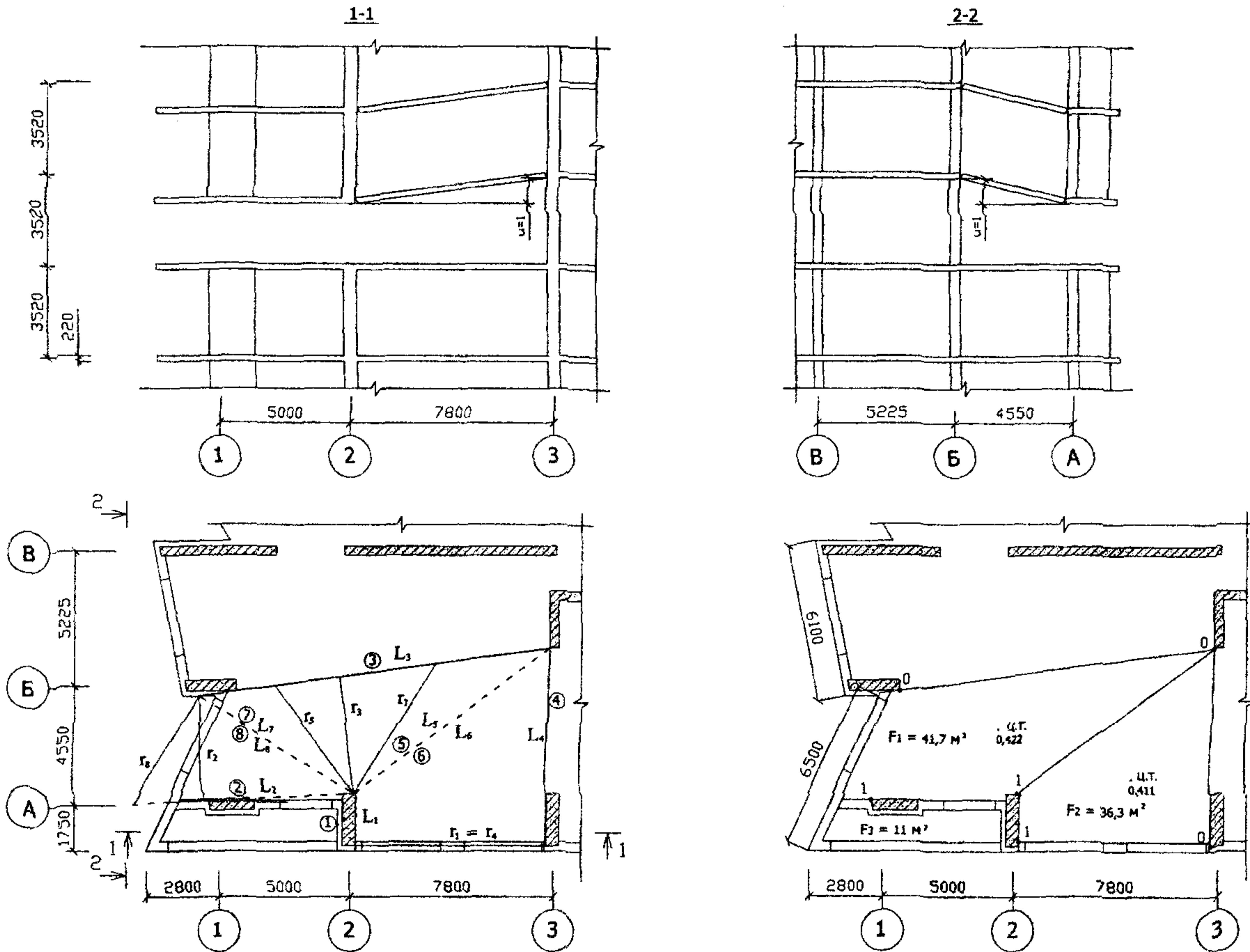
РИСУНОК А1.6 СХЕМА 2. МЕХАНИЗМ ОБРУШЕНИЯ ПЕРВОГО ТИПА.
