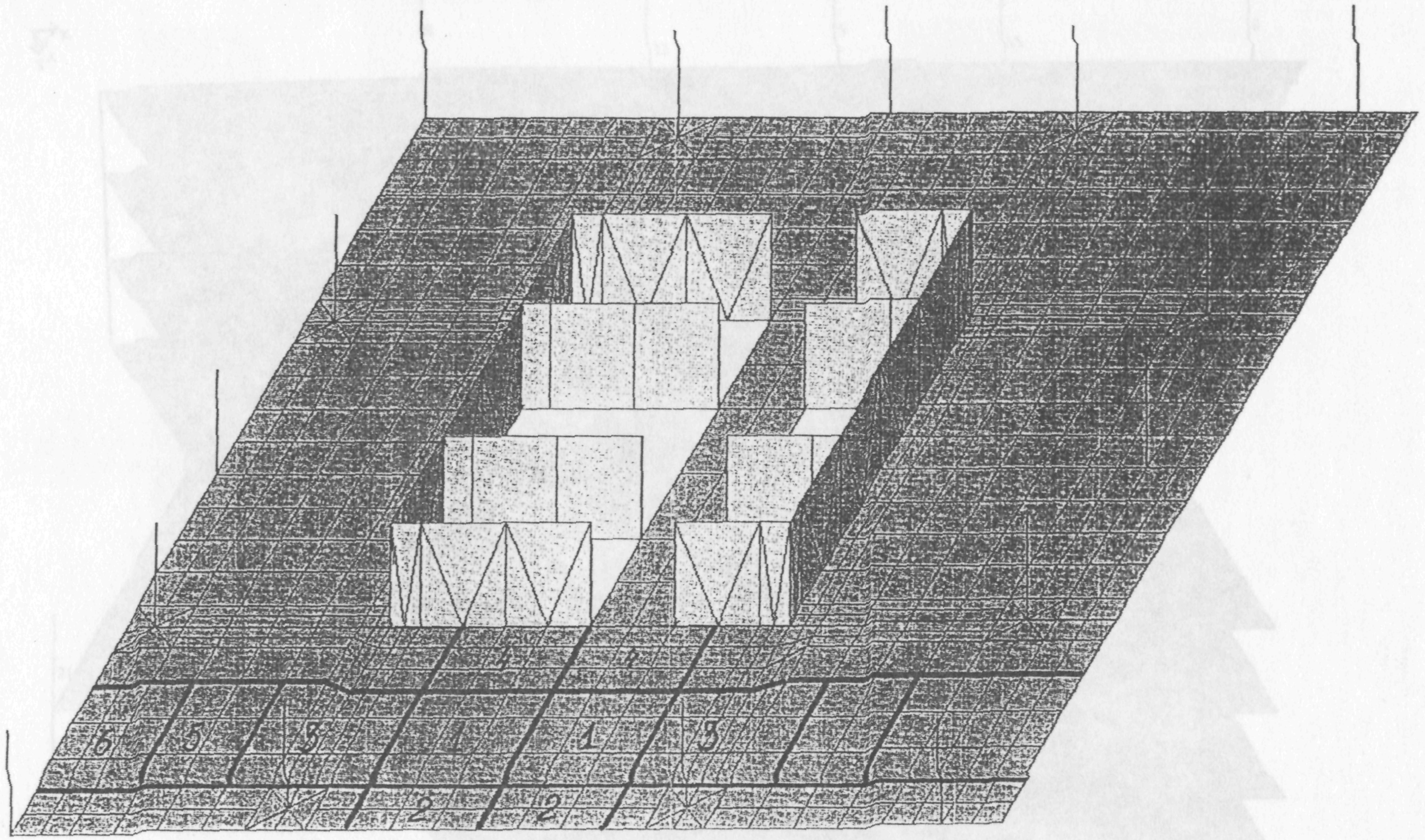
Рисунок А2.5 Объединение конечных элементов перекрытия в группы
