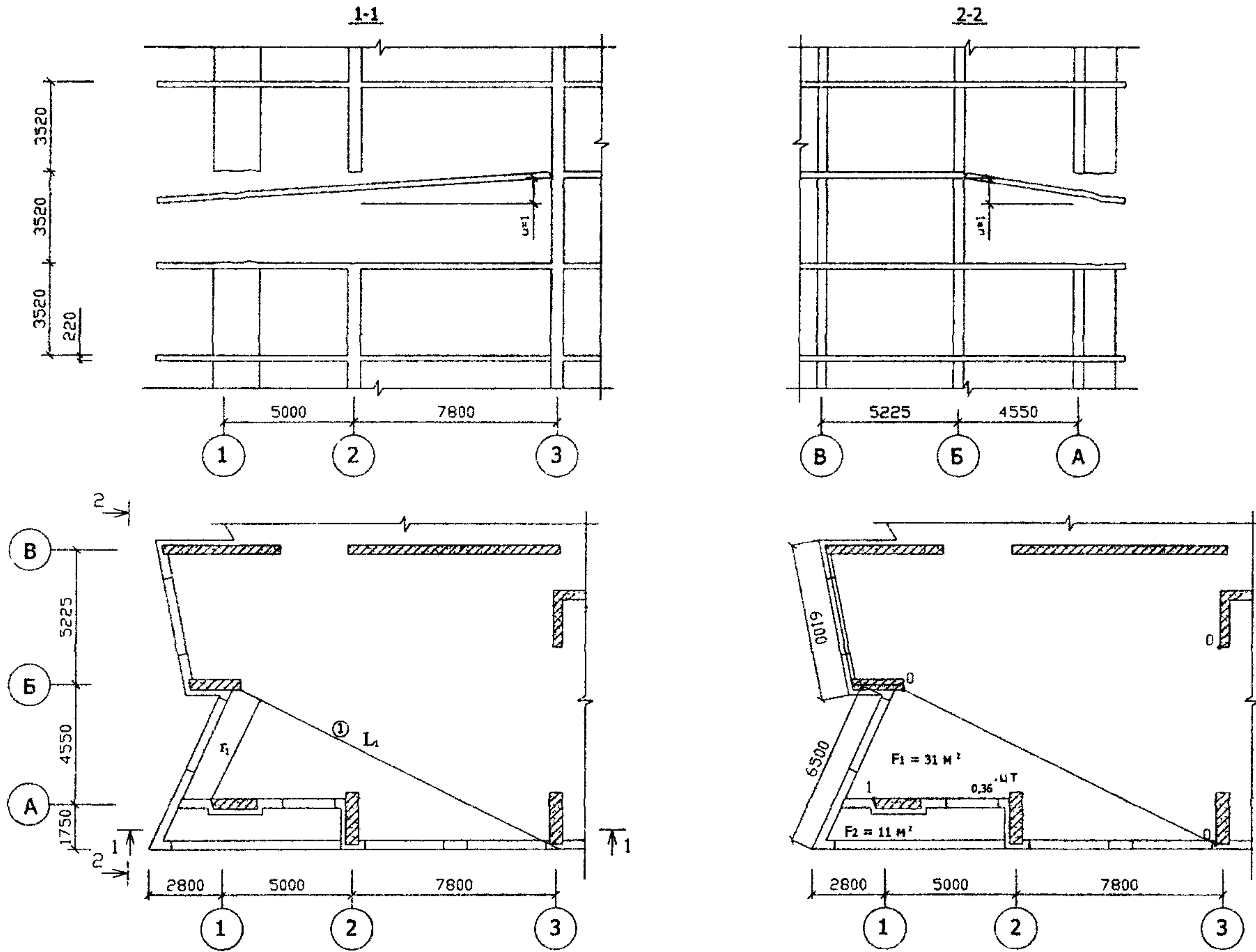
РИСУНОК А1.8 СХЕМА 2. МЕХАНИЗМ ОБРУШЕНИЯ ТРЕТЬЕГО ТИПА.
