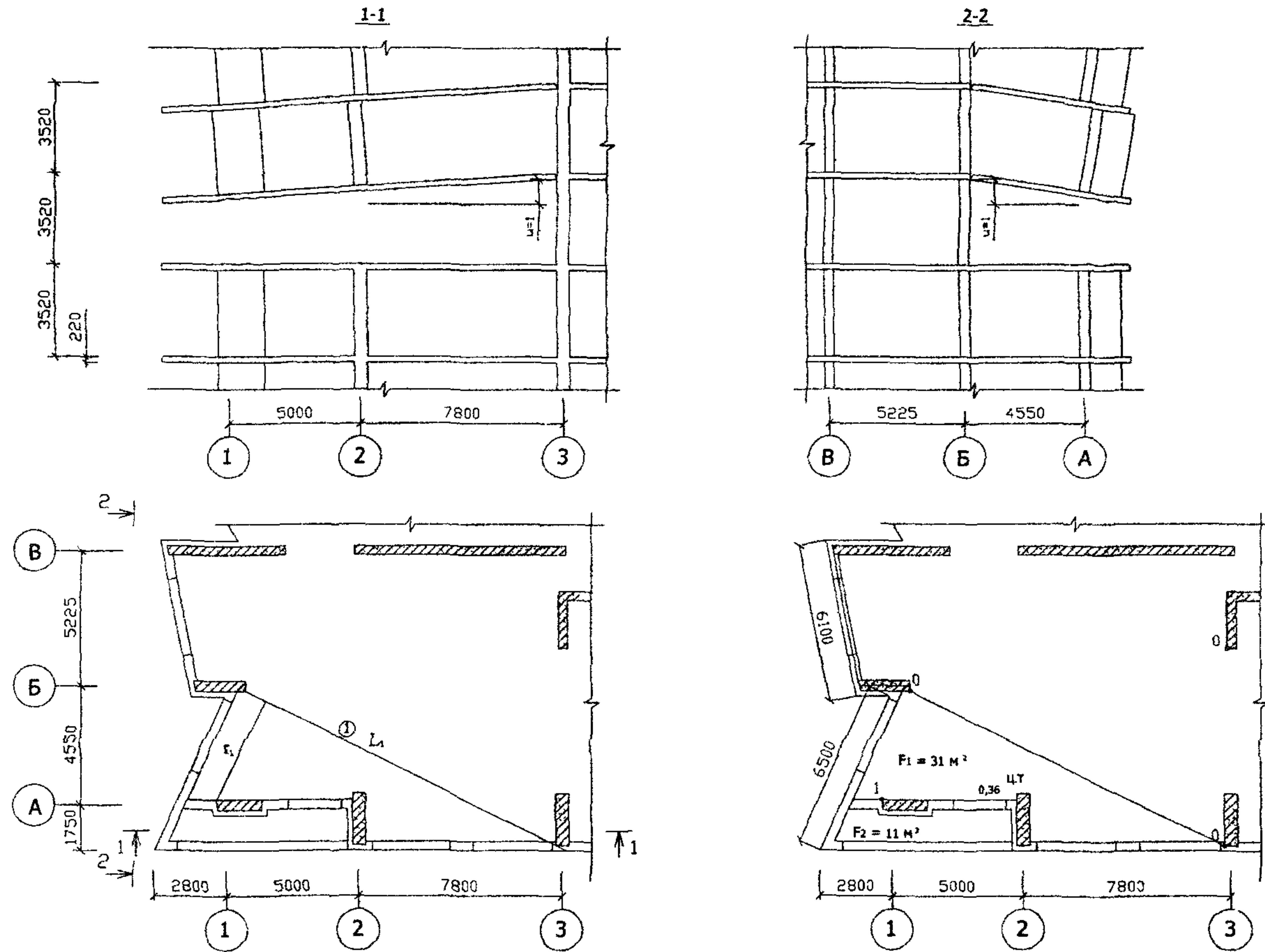
РИСУНОК А1.7 СХЕМА 2. МЕХАНИЗМ ОБРУШЕНИЯ ВТОРОГО ТИПА.
