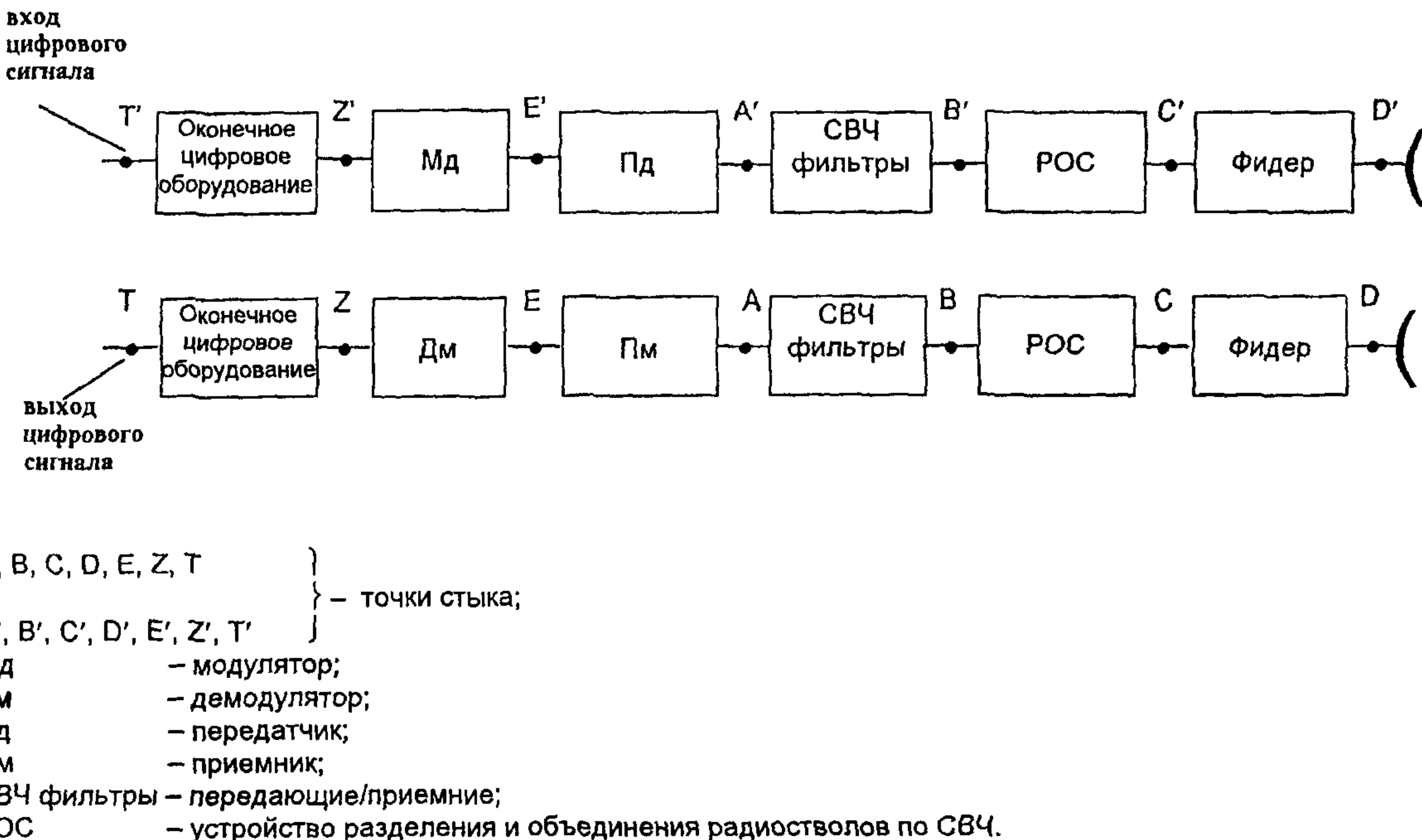
Рис. 2. Структурная схема радиорелейного оборудования
