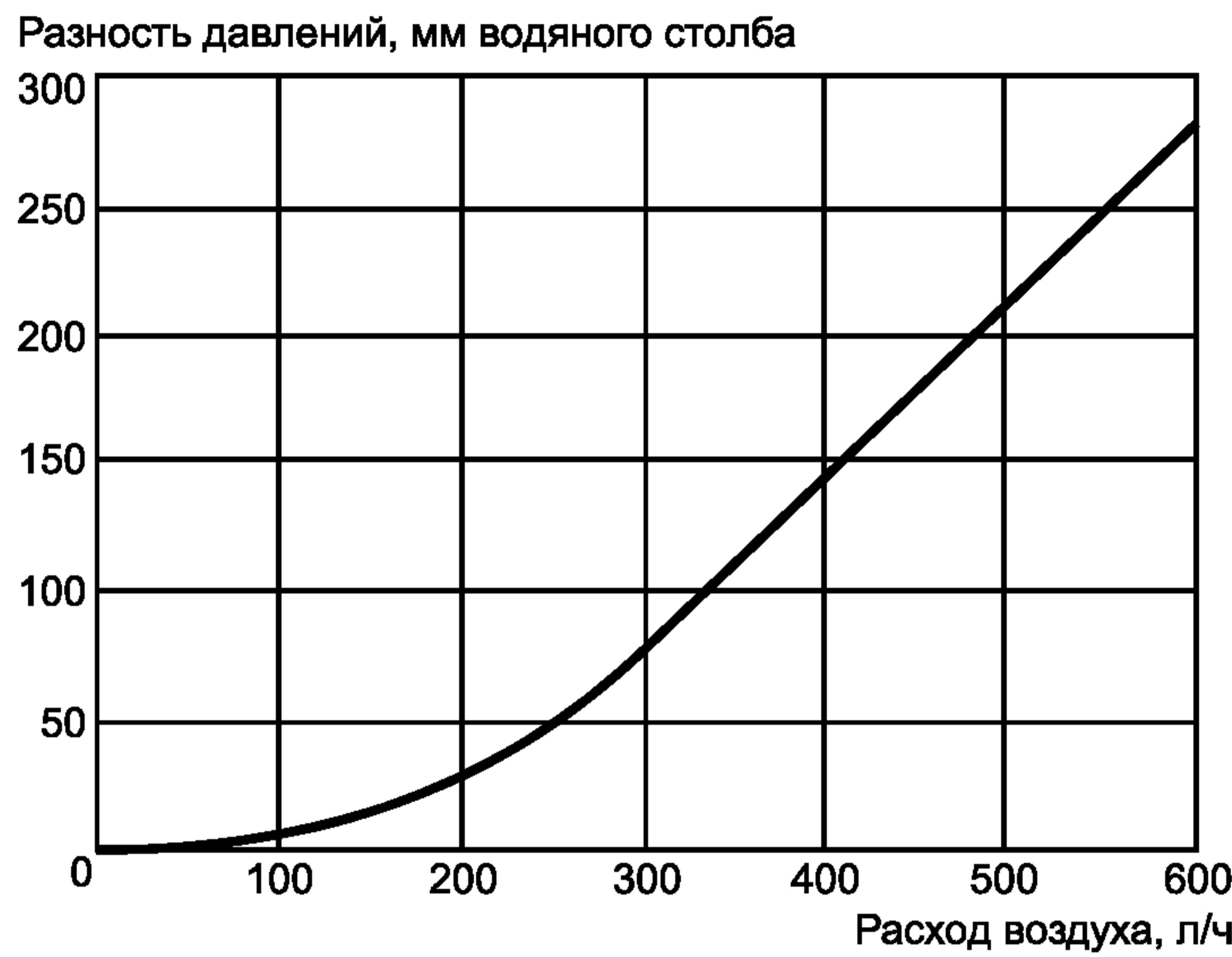
Рисунок 4 — Калибровочная диаграмма капиллярной трубы (диаметр  $d = 2$  мм; длина  $l = 70$  мм) расходомера для измерения скорости потока воздуха в термостате по методу 2
