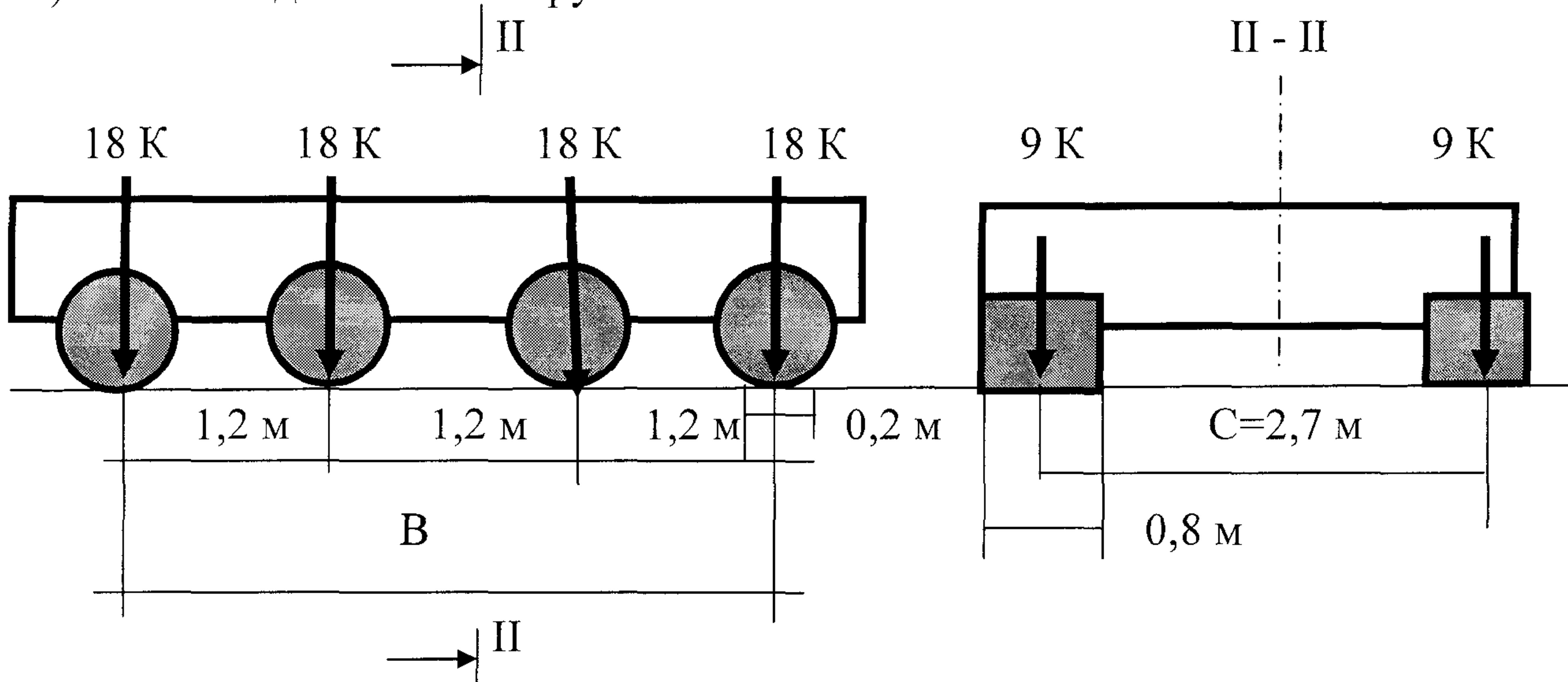
Рис. 1. Схема нормативной нагрузки для расчета дорожной одежды, земляного полотна, подпорных стен и мостовых сооружений.
