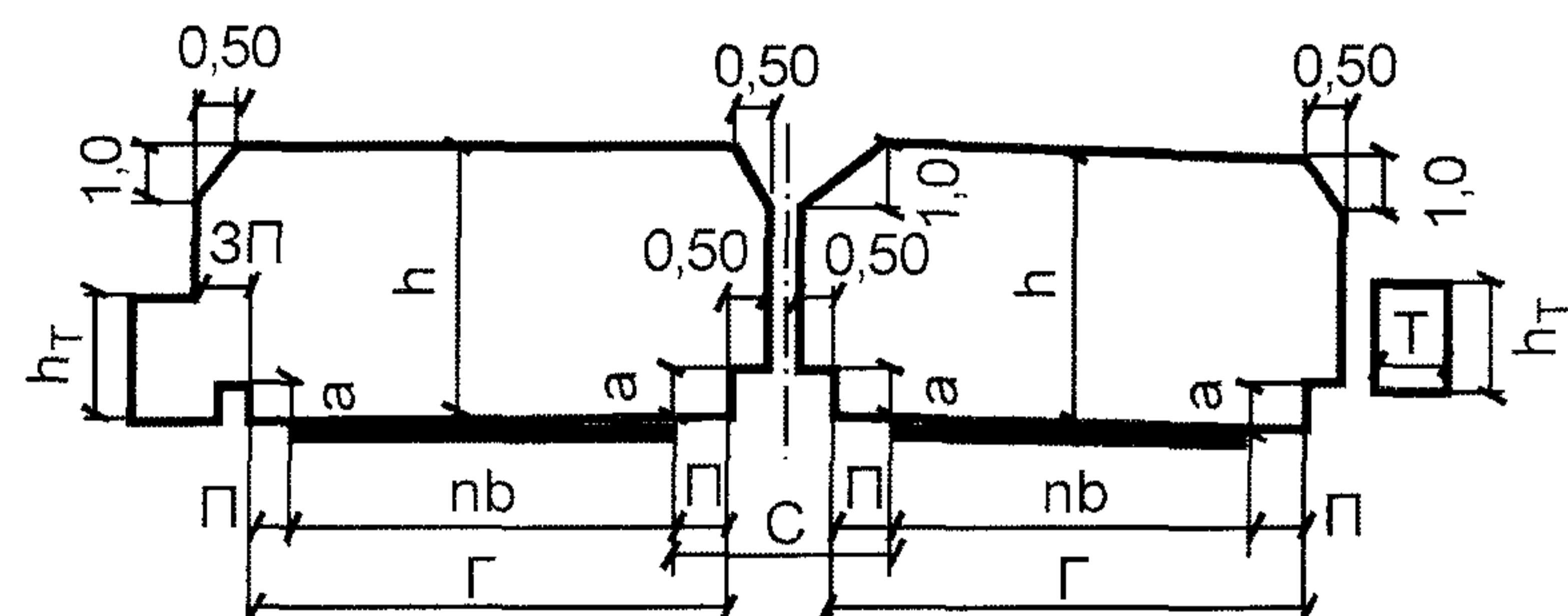
Рис. 2. Схемы габаритов приближения конструкций на автодорожных мостах и путепроводах.
