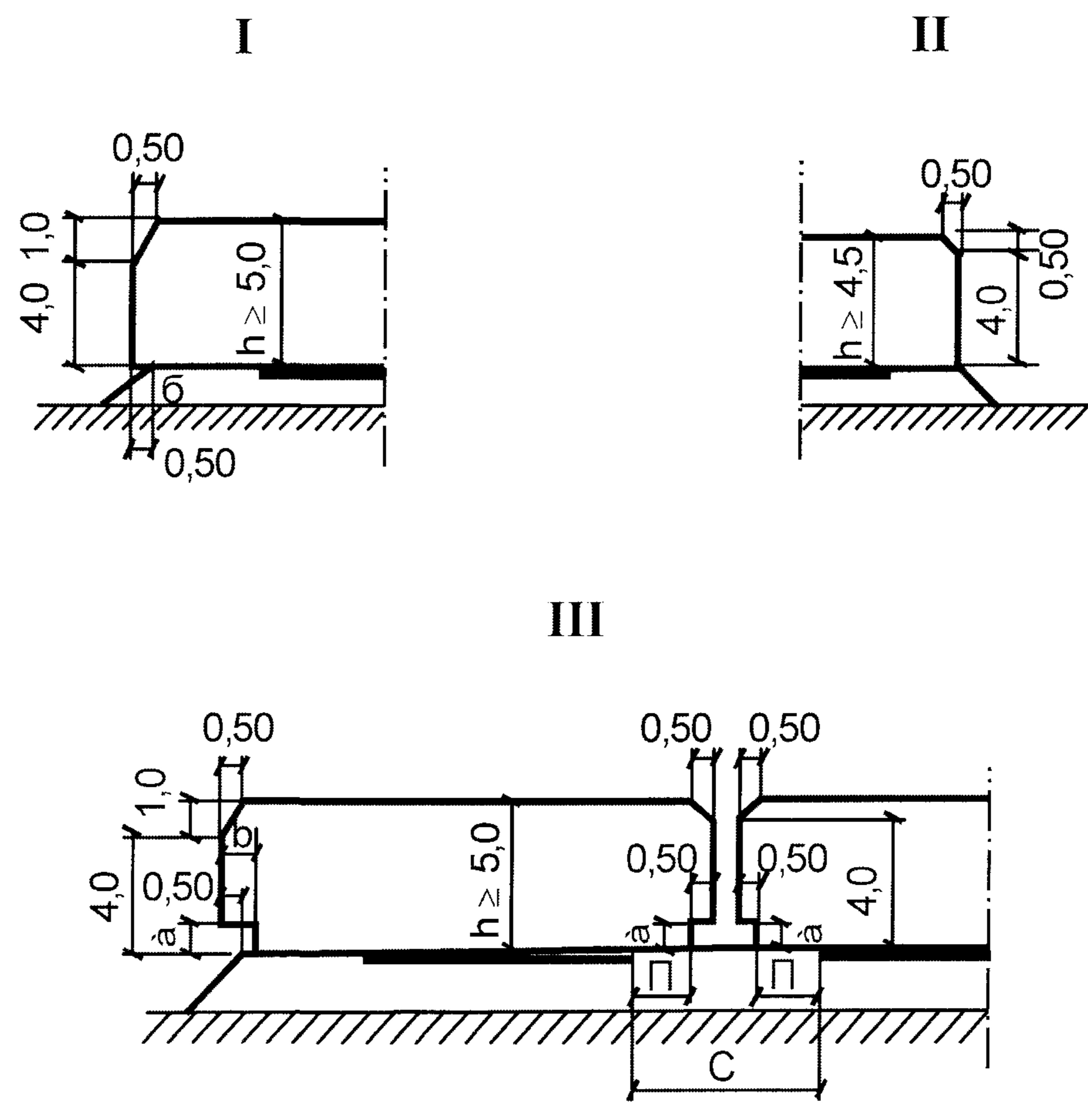
Рис. 3. Схемы габаритов приближения конструкций под путепроводами.
