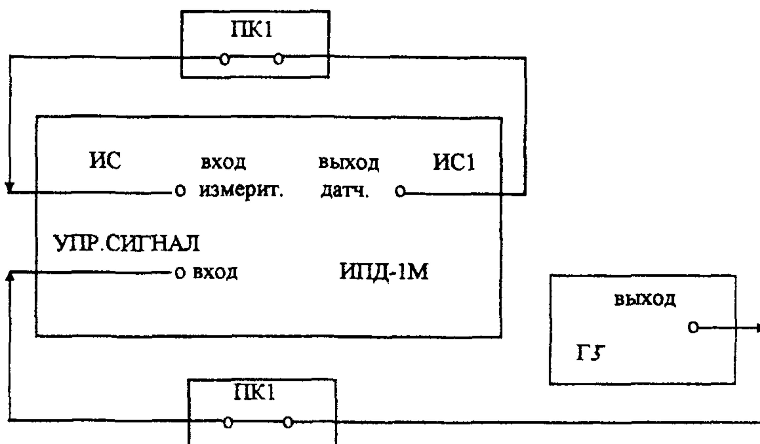
**Г5** - генератор импульсов Г5-53;
