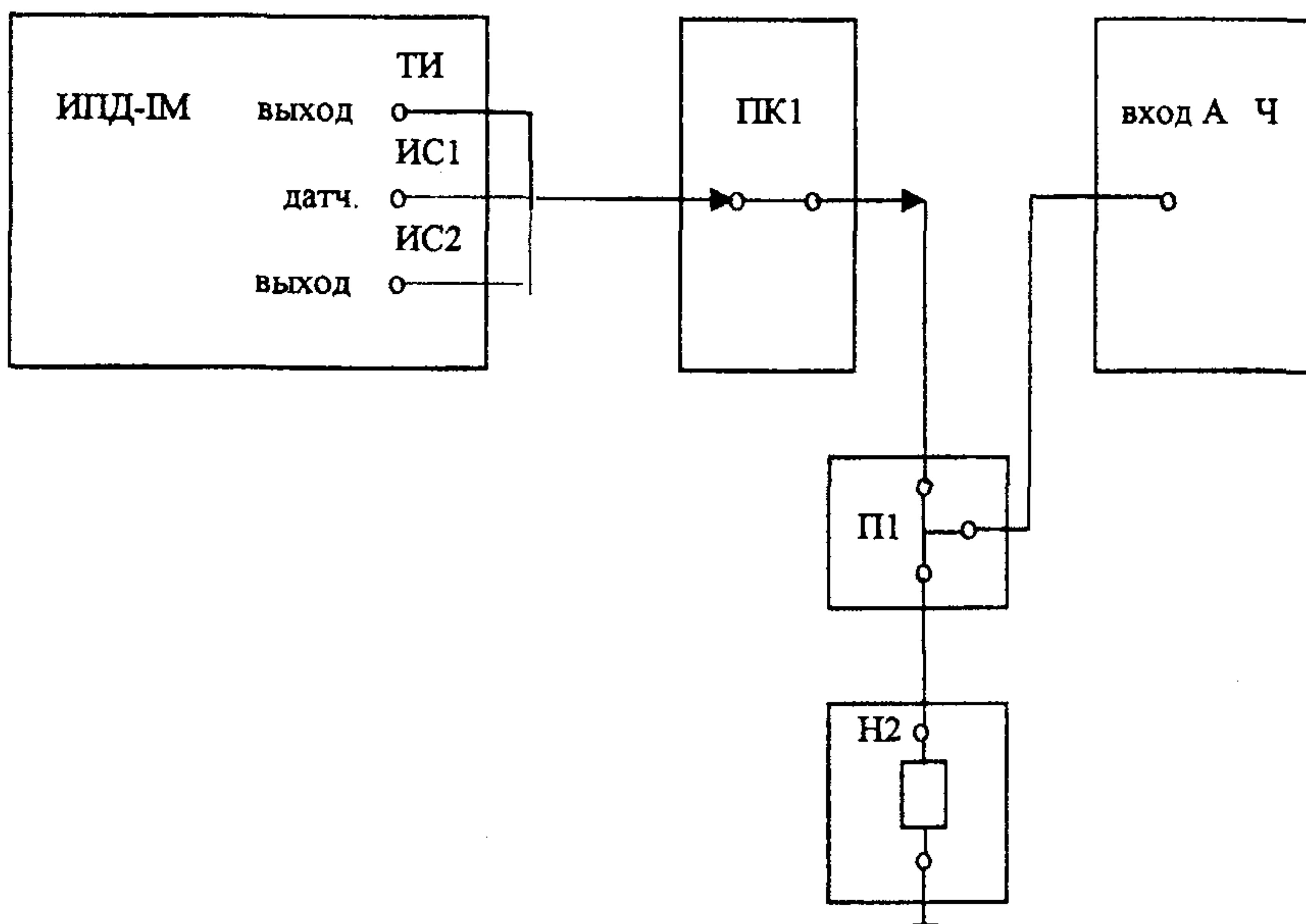
Ч - частотомер электронно-счетный ЧЗ-54 (ЧЗ-63);
