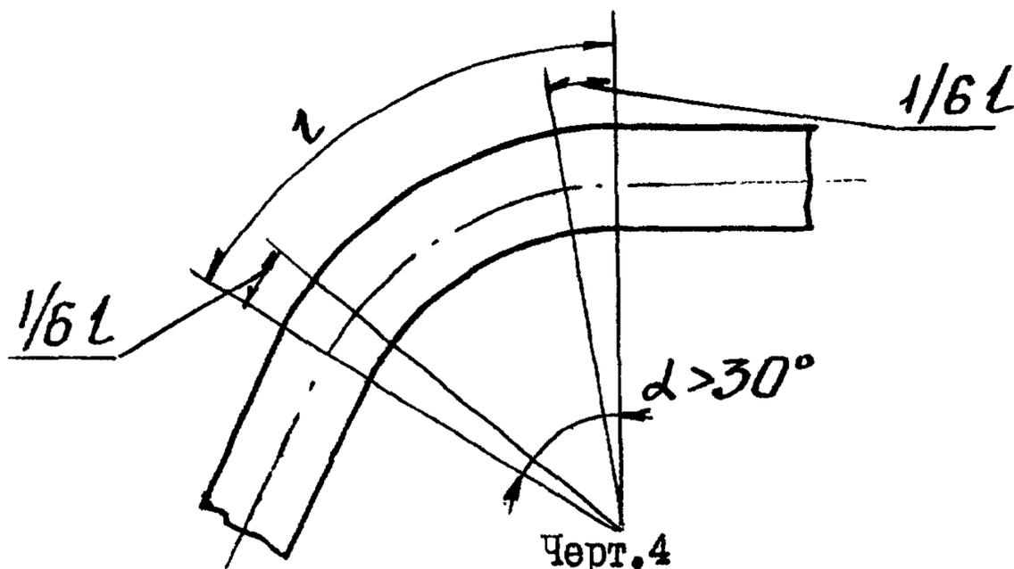
При диаметре труб менее 108 мм контроль на овальность производится выборочно, но не менее 0,5% от числагибов одного типоразмера.
