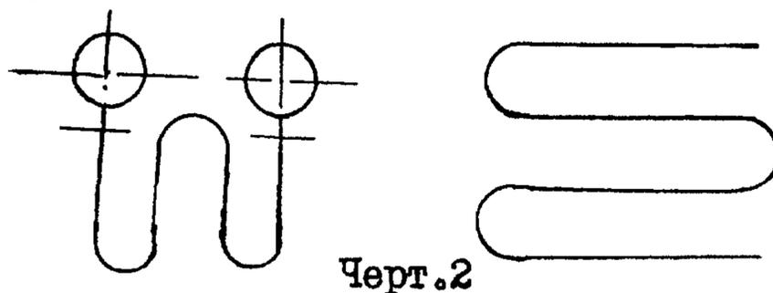
4.4.5. Перед контактной сваркой стыкуемые концы труб должны быть зачищены до металлического блеска в соответствии с требованиями ГОСТ 24663-81. Концы труб, подлежащих контактной сварке, должны быть отрезаны механическим способом под прямым углом к оси трубы. Неперпендикулярность плоскости торца к оси трубы не должна превышать значений:
