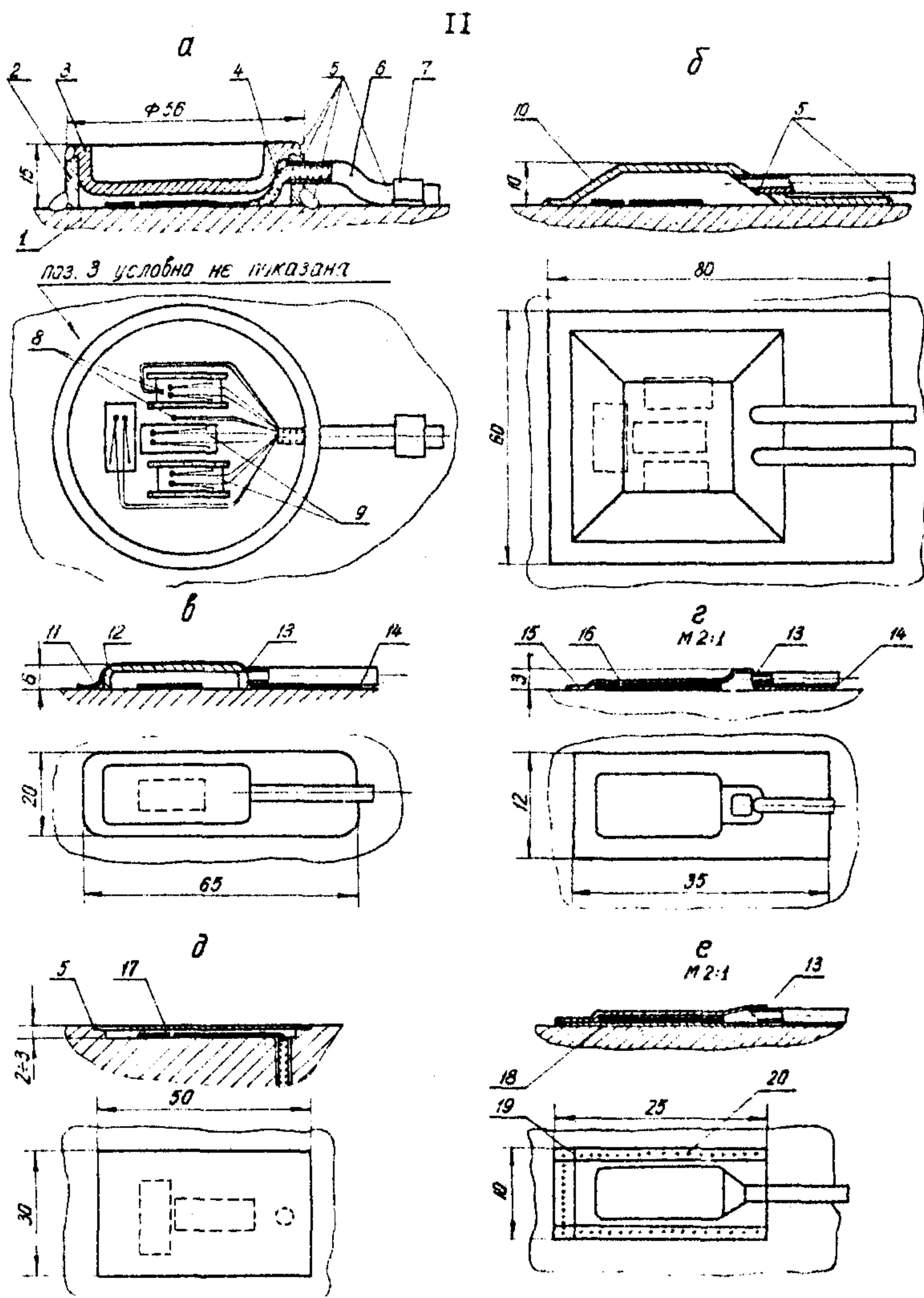
Рис.I.I. Типы защитных устройств тензорезисторов
