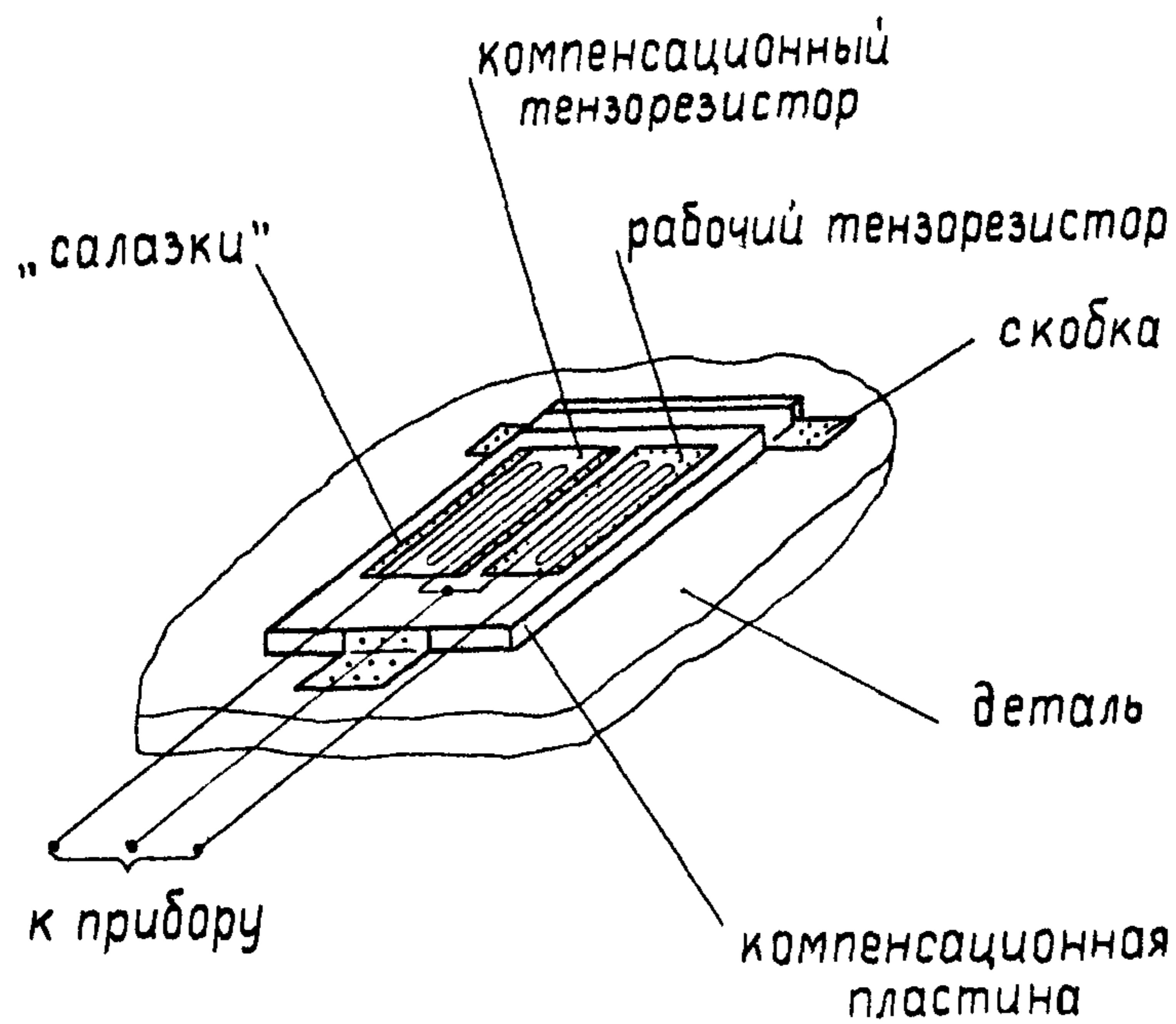
Рис.2.1. Схема установки тензорезисторов – "свидетелей"
