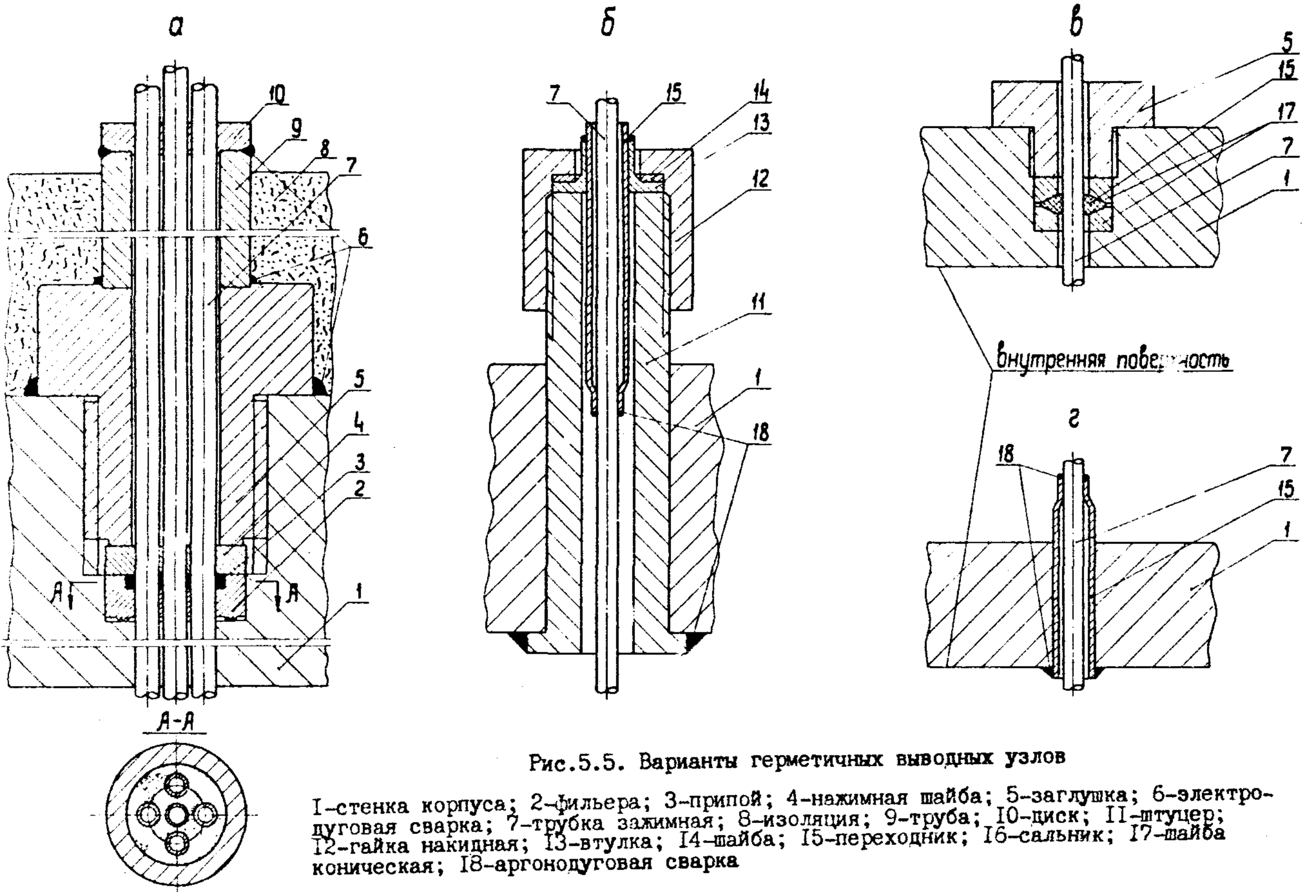
Рис.5.5. Варианты герметичных выводных узлов
