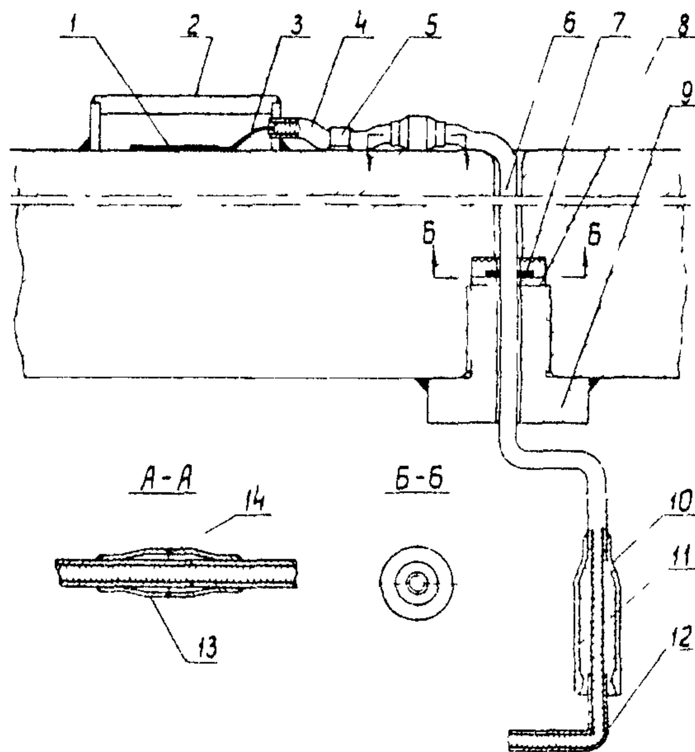
Рис.5.4. Система защиты тензосхемы
