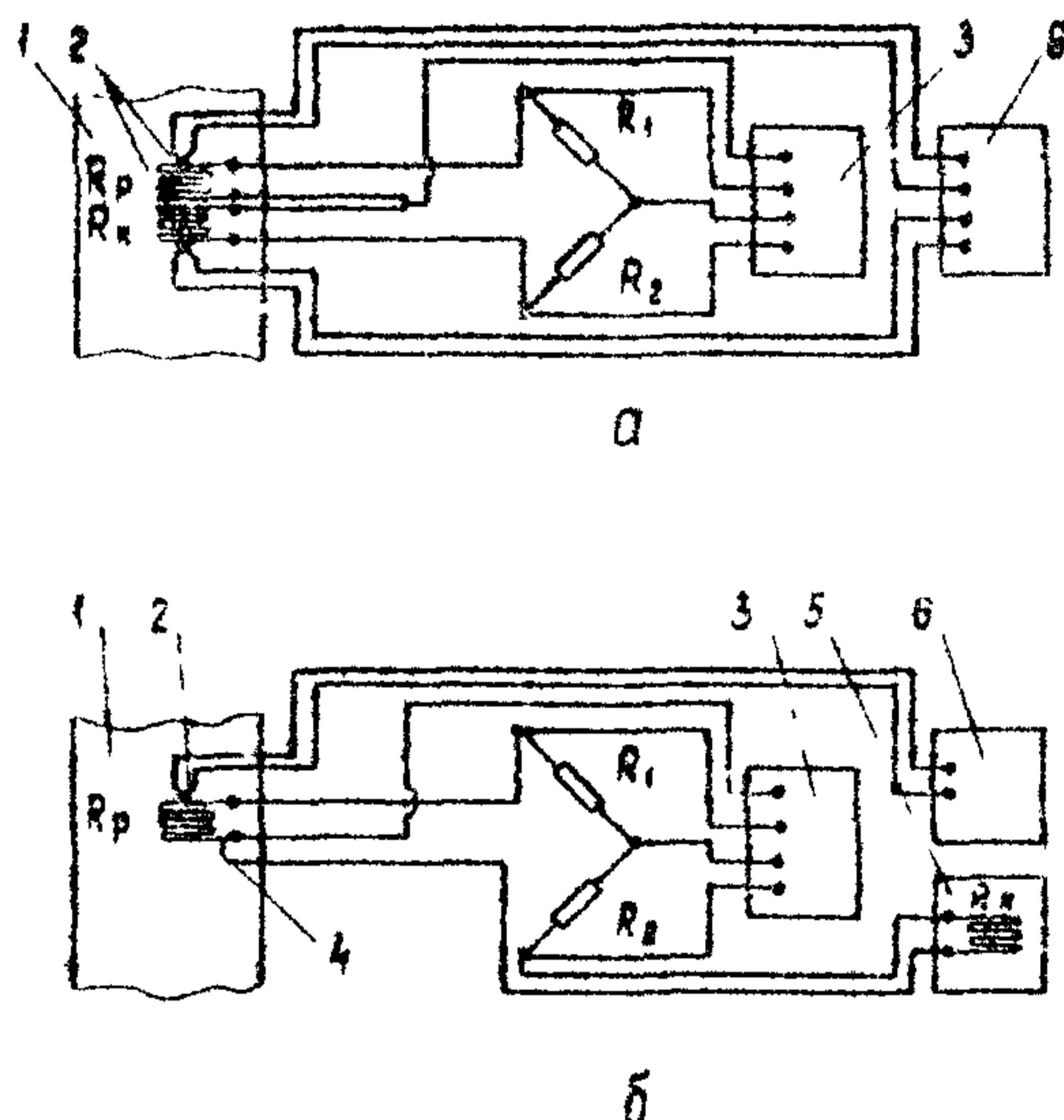
Рис.5.1. Способы температурной компенсации
