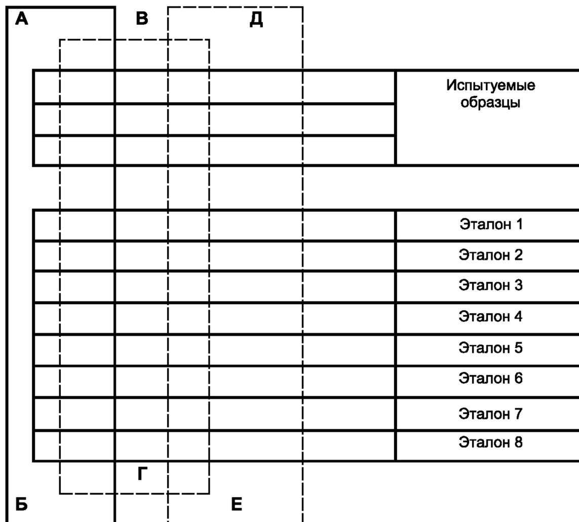
АБ — покрытие, закрывающее образцы и синие эталоны при закреплении их на кассетах; ВГ — второе покрытие; ДЕ — третье покрытие
