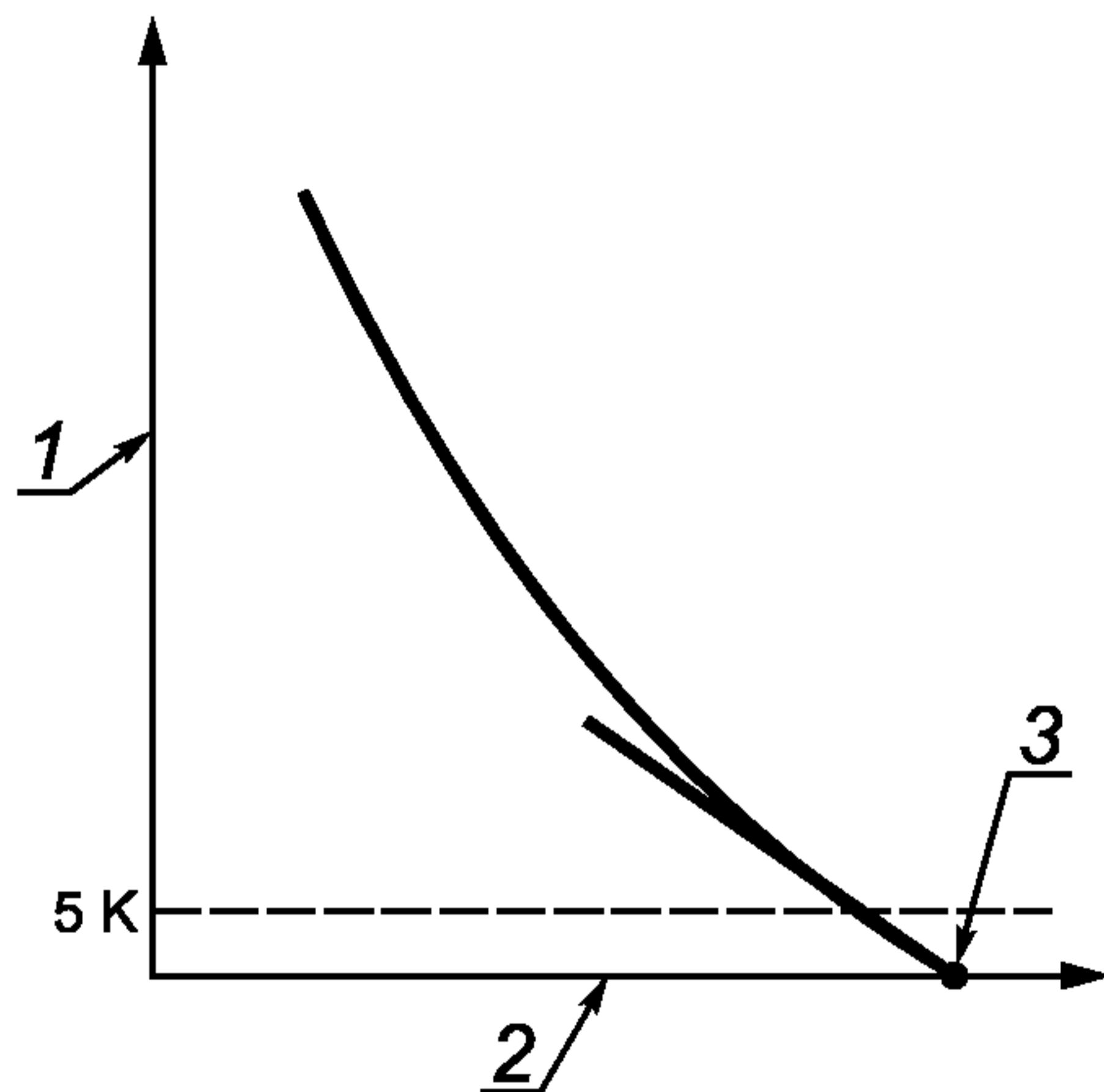
1 — температура образца минус температура воздуха в печи ( $T_s - T_o$ ), К; 2 — температура в печи  $T_o$ , °C; 3 — зарегистрированное значение температуры  $T_s$ , °C
