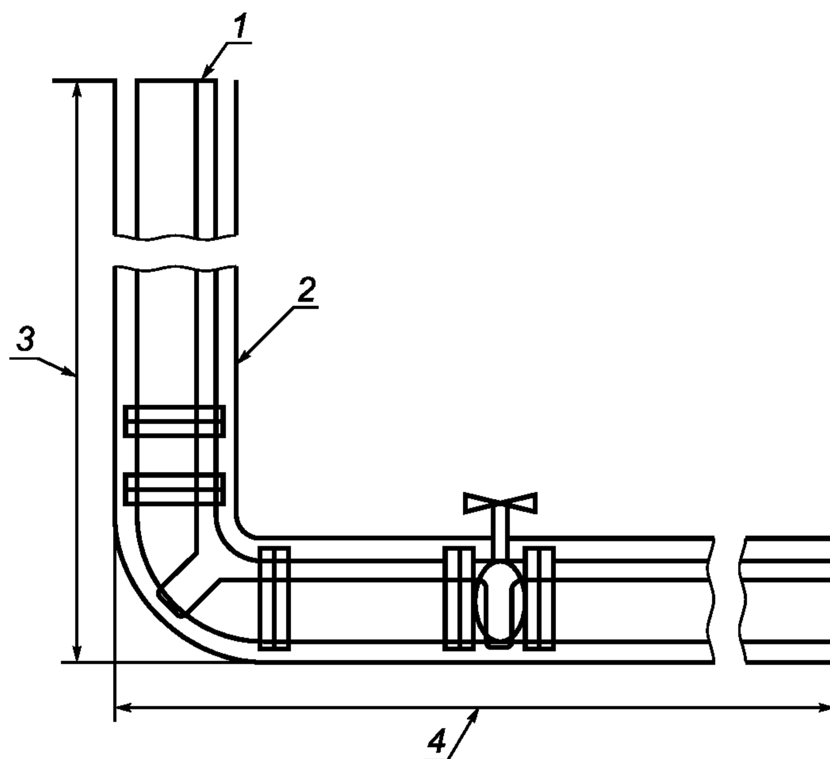
1 — номинальное сечение трубы от 50 до 150 мм; 2 — изоляция из стекловолокна. Минимальная толщина 25 мм, плотность около  $3,25 \text{ кг}/\text{м}^3$ ; 3 — 1,5 м; 4 — 3 м
