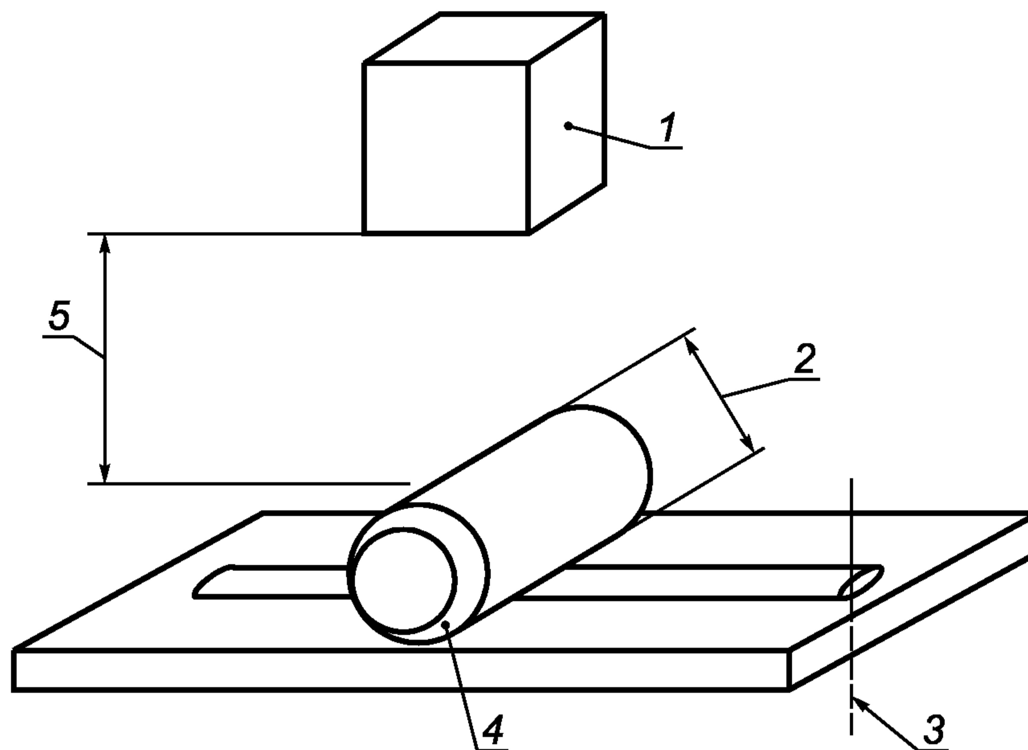
1 — боец массой 1 кг; 2 — цилиндр диаметром 25 мм; 3 — меньшая поперечная ось нагревательного кабеля некруглого сечения; 4 — цилиндр длиной 25 мм и радиусом скругления кромок 5 мм, используемый для испытания прокладок и нагревательных панелей; 5 — высота падения бойка — 700 мм или 400 мм
