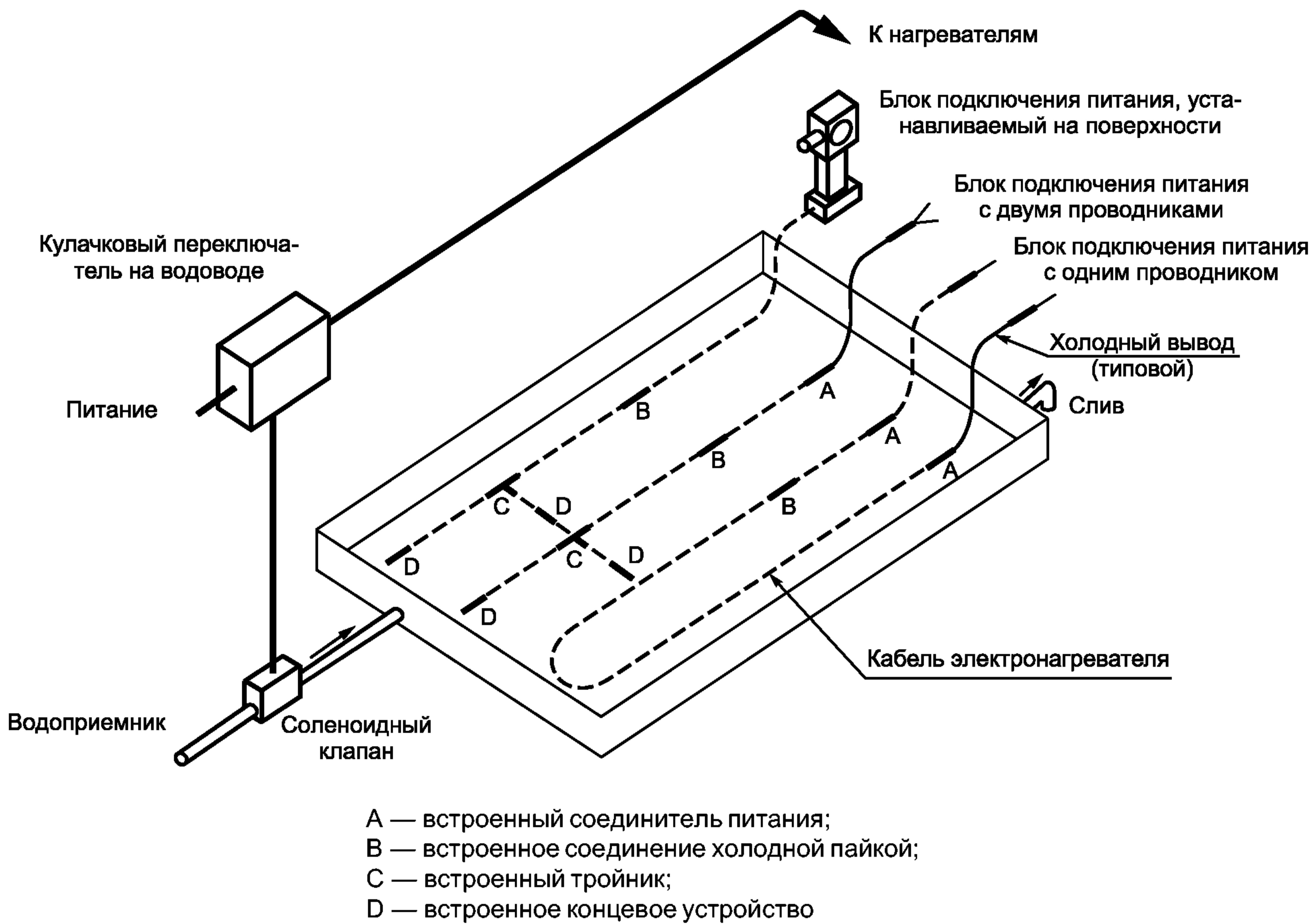
Рисунок 4 — Испытание встроенных компонентов на влагоустойчивость
