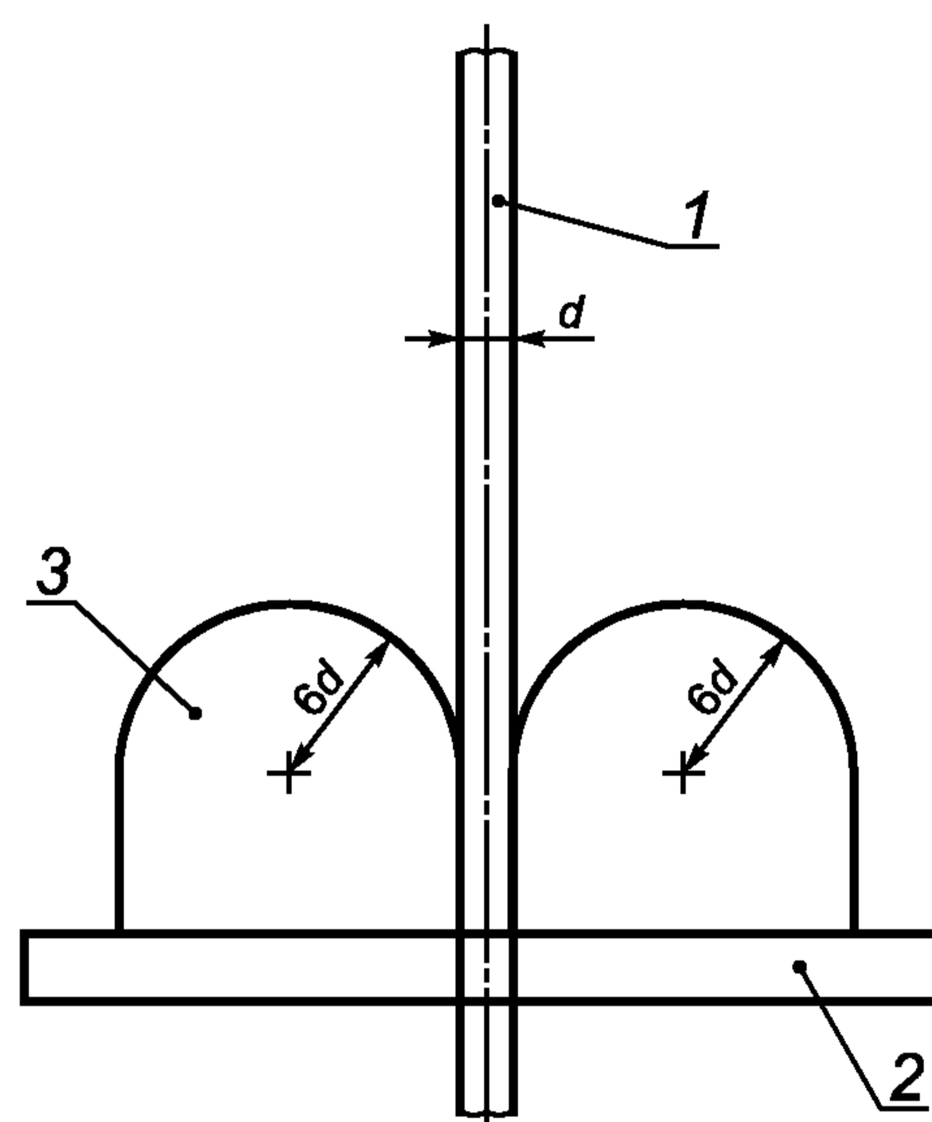
1 — образец сетевого электронагревателя; 2 — стальное основание; 3 — металлическая оправка;
