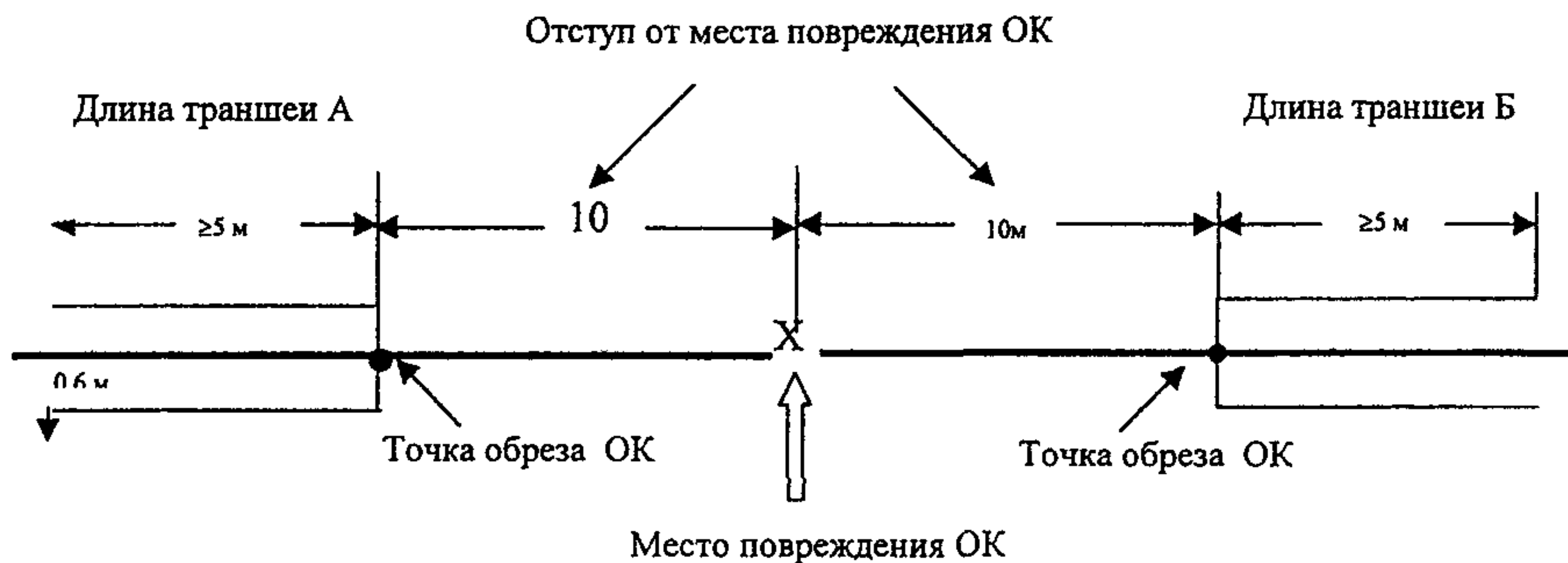
Рисунок 12.2 - Схема траншей при восстановлении ВОЛП с помощью ВОКВ
