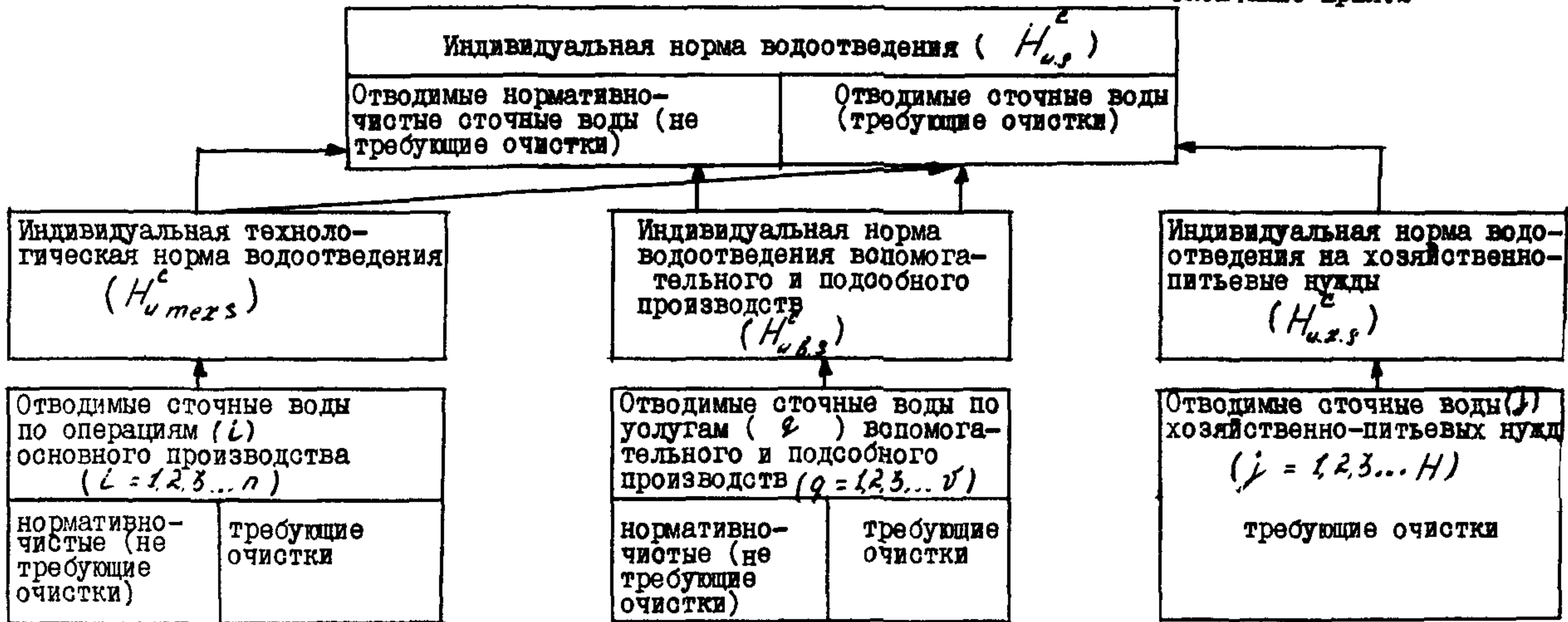
Рис. 3. Состав индивидуальной нормы водоотведения на единицу продукции  $S$
