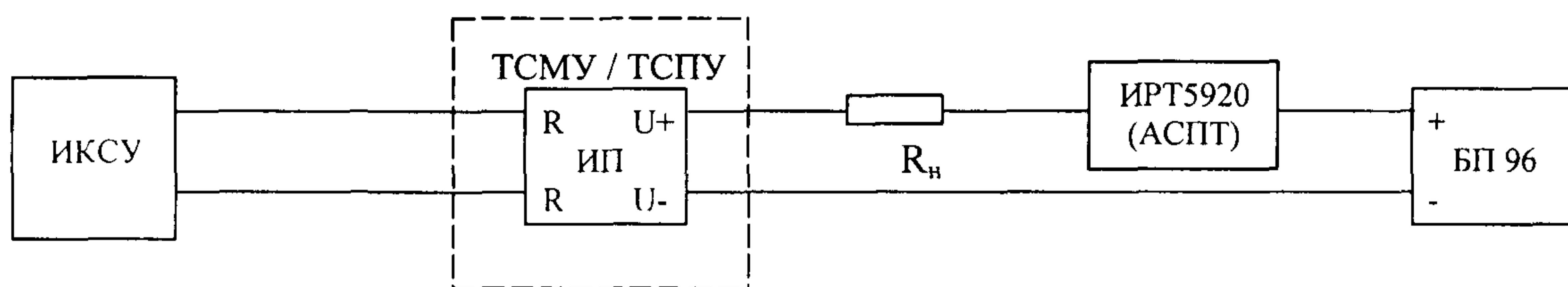
Термопреобразователи с унифицированным выходным сигналом (0...5) мА
