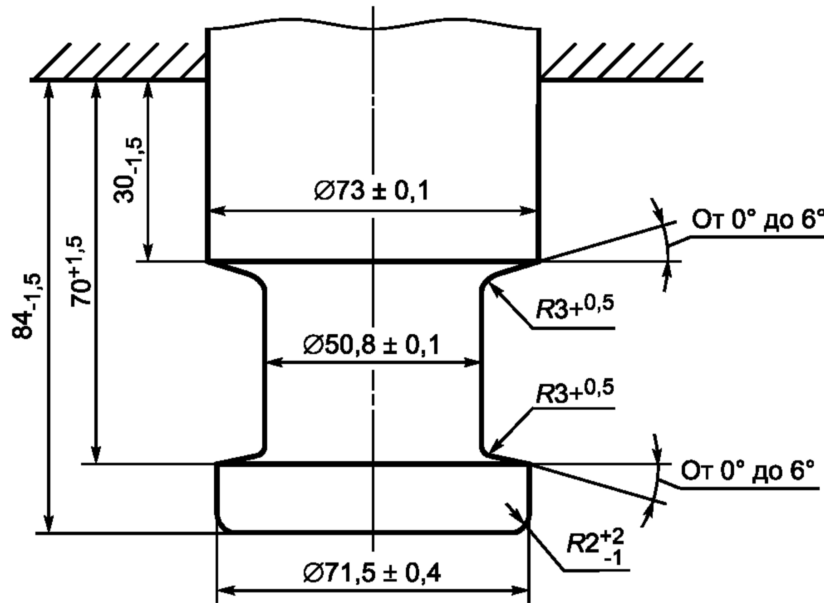
Рисунок 18 — Размеры шкворней седельно-сцепных устройств класса Н50
