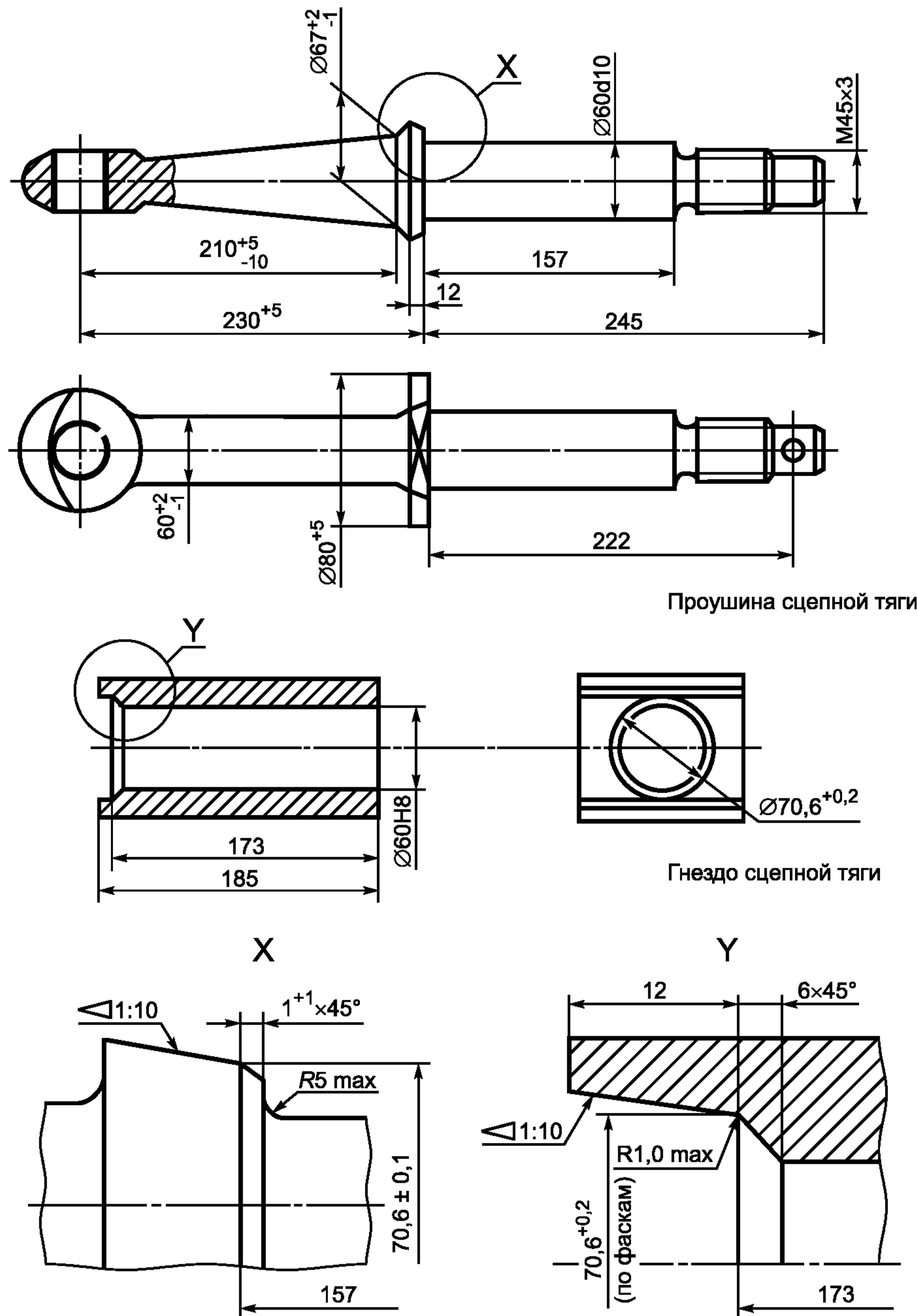
Рисунок 12 — Размеры проушин сцепных тяг класса D50-В
