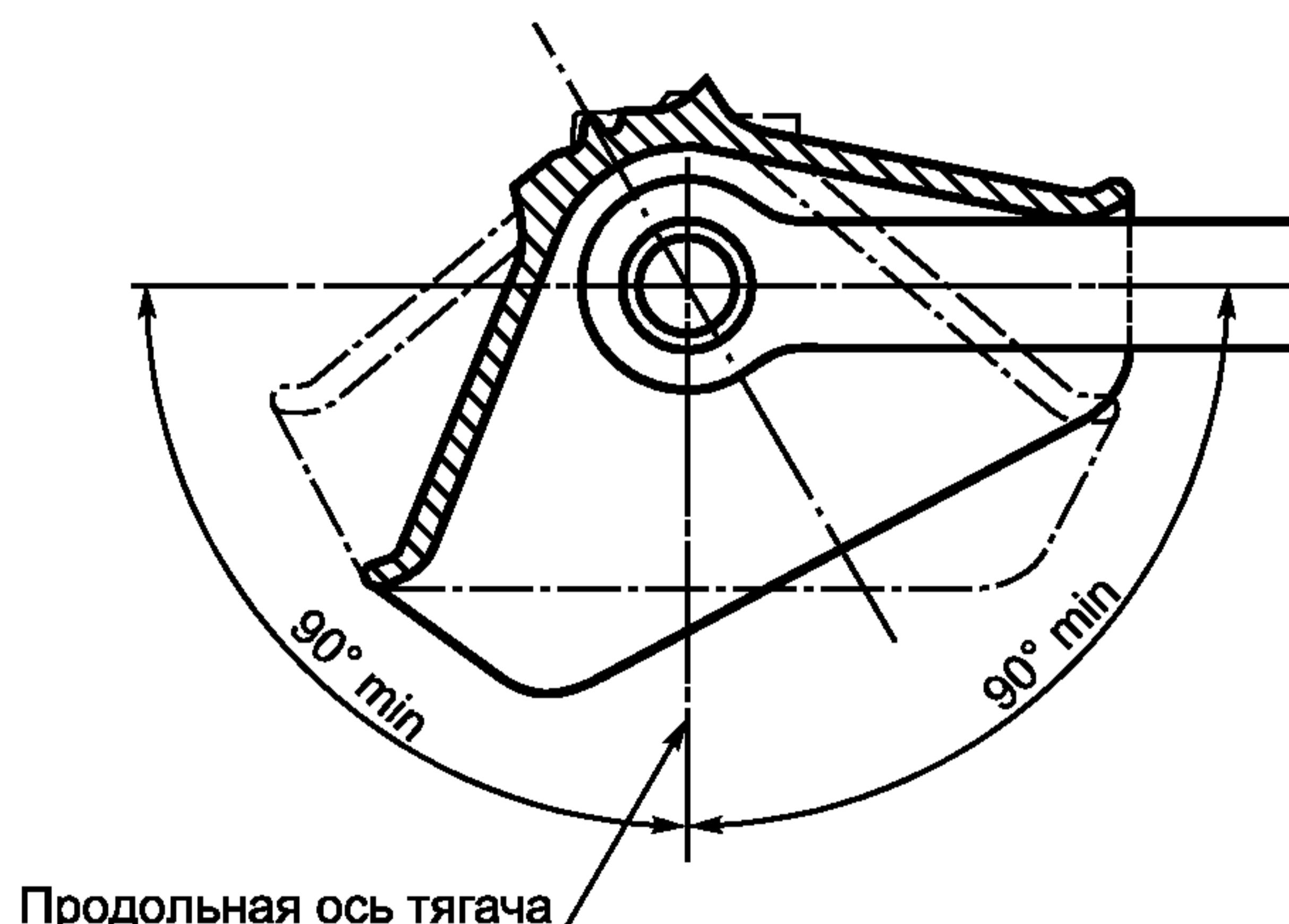
Рисунок 5 — Поворот сцепленной проушины сцепной тяги по горизонтали
