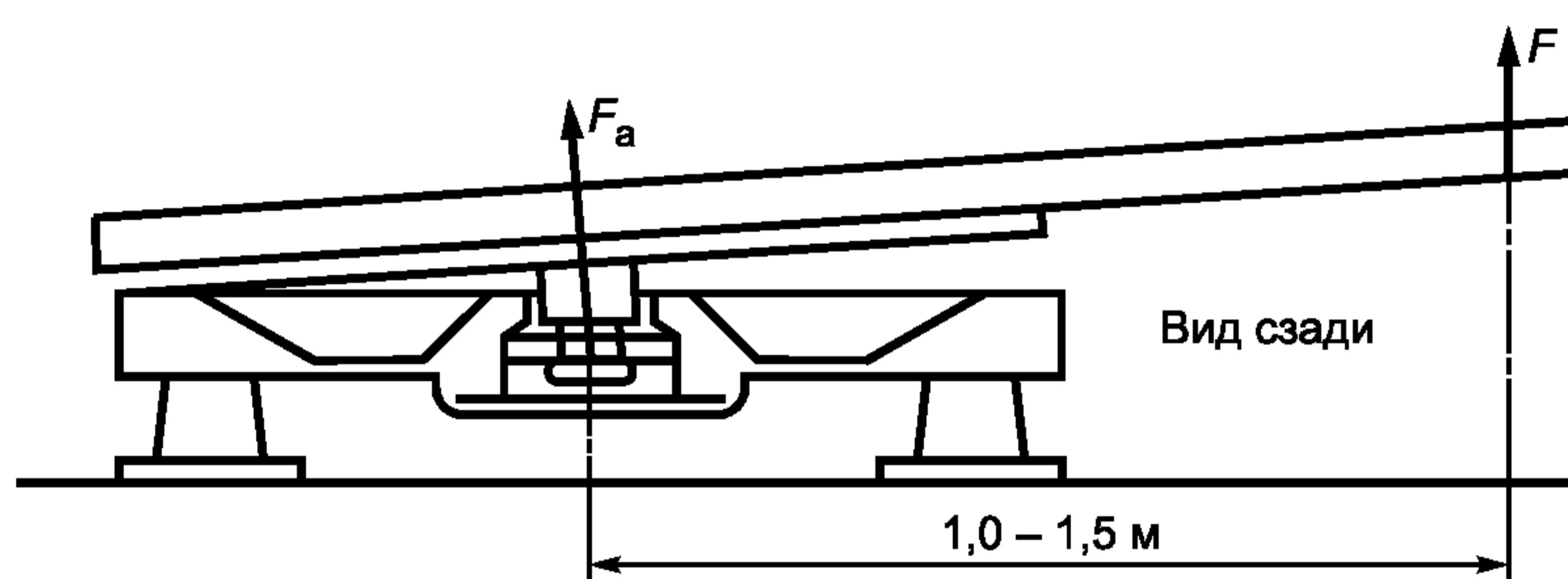
Рисунок 24 — Испытание седельно-сцепных устройств на подъем
