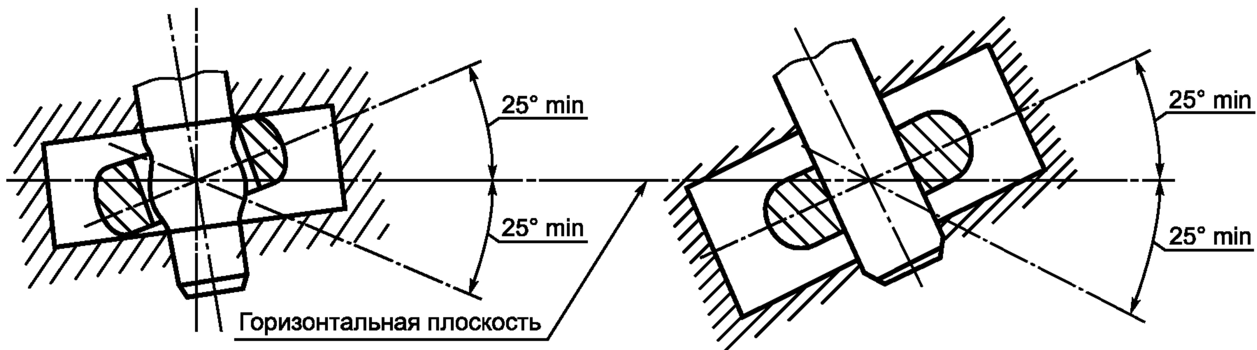
Рисунок 7 — Поворот сцепленной проушины сцепной тяги вокруг оси
