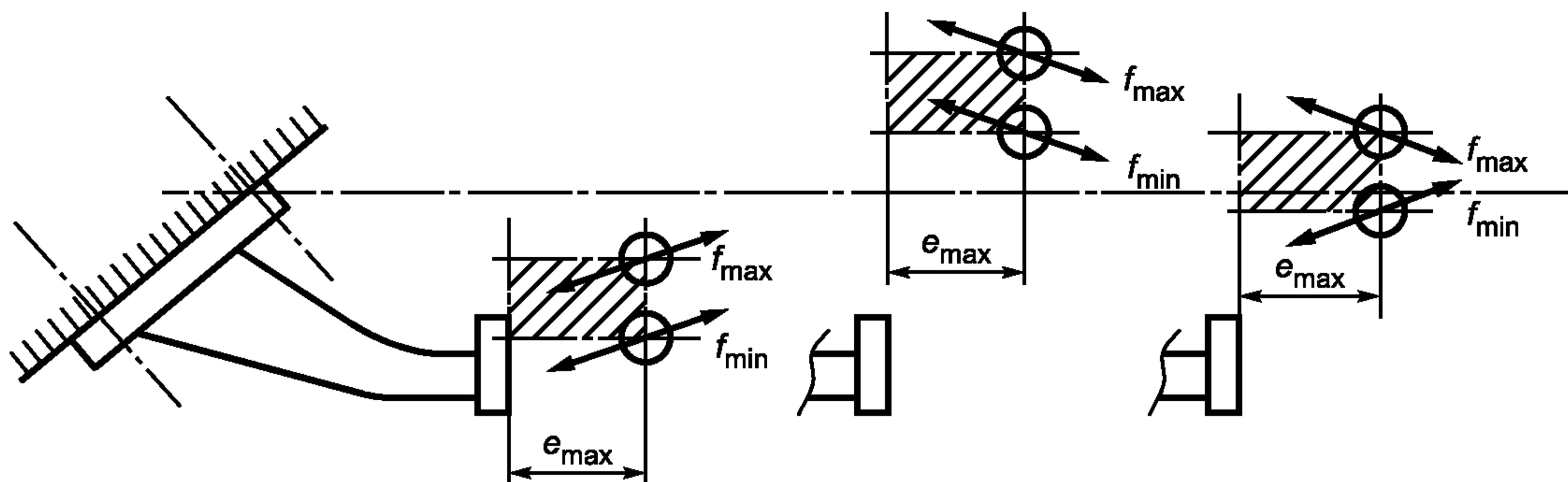
Рисунок 22 — Углы приложения испытательной силы
