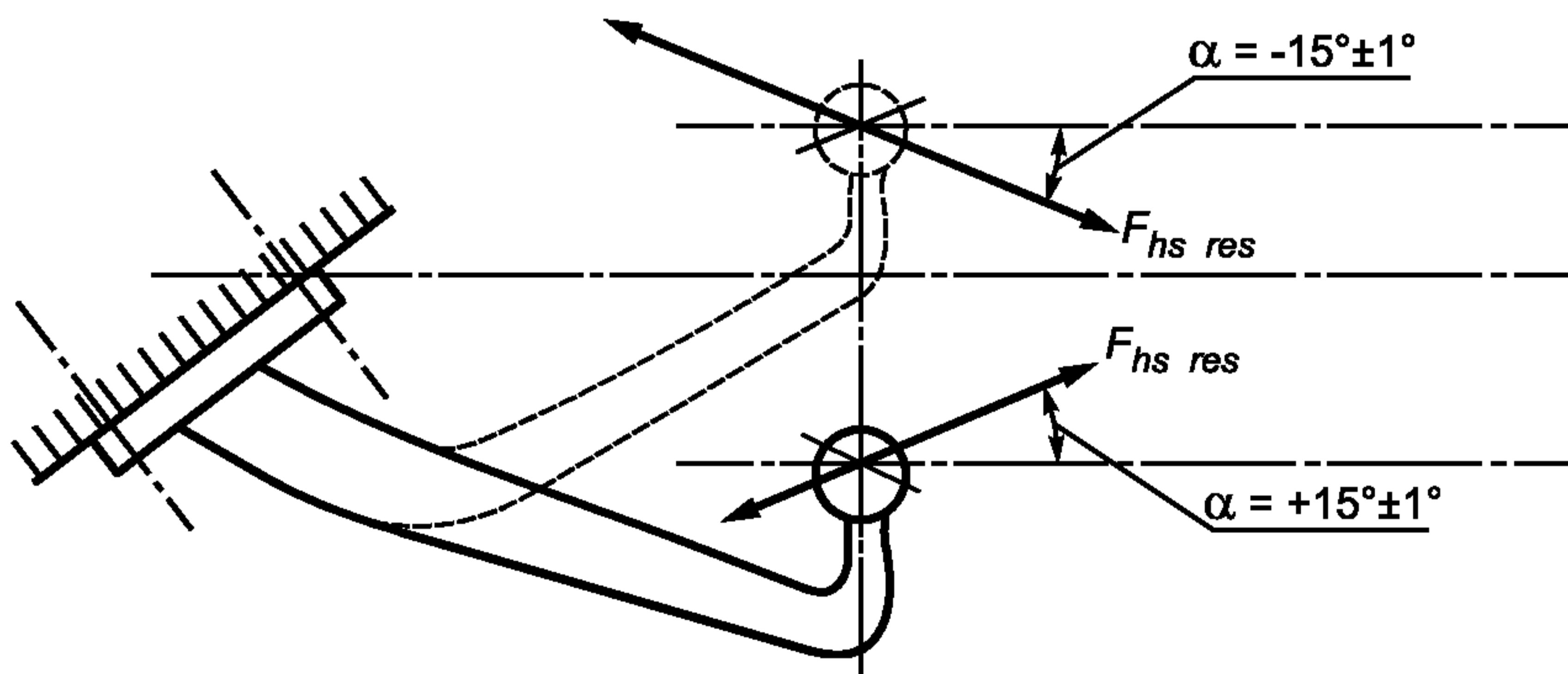
Рисунок 21 — Углы приложения испытательной силы
