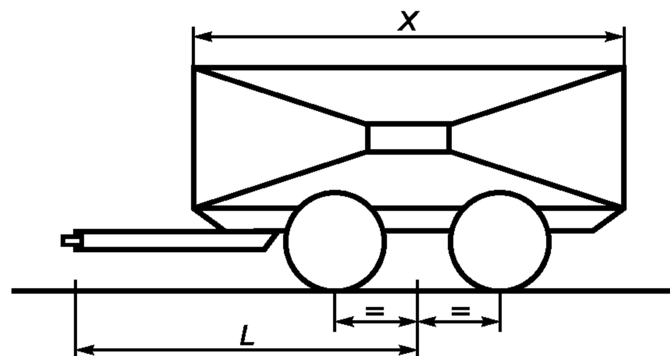
Рисунок 1 — Габаритные размеры прицепа с центрально расположенной осью
