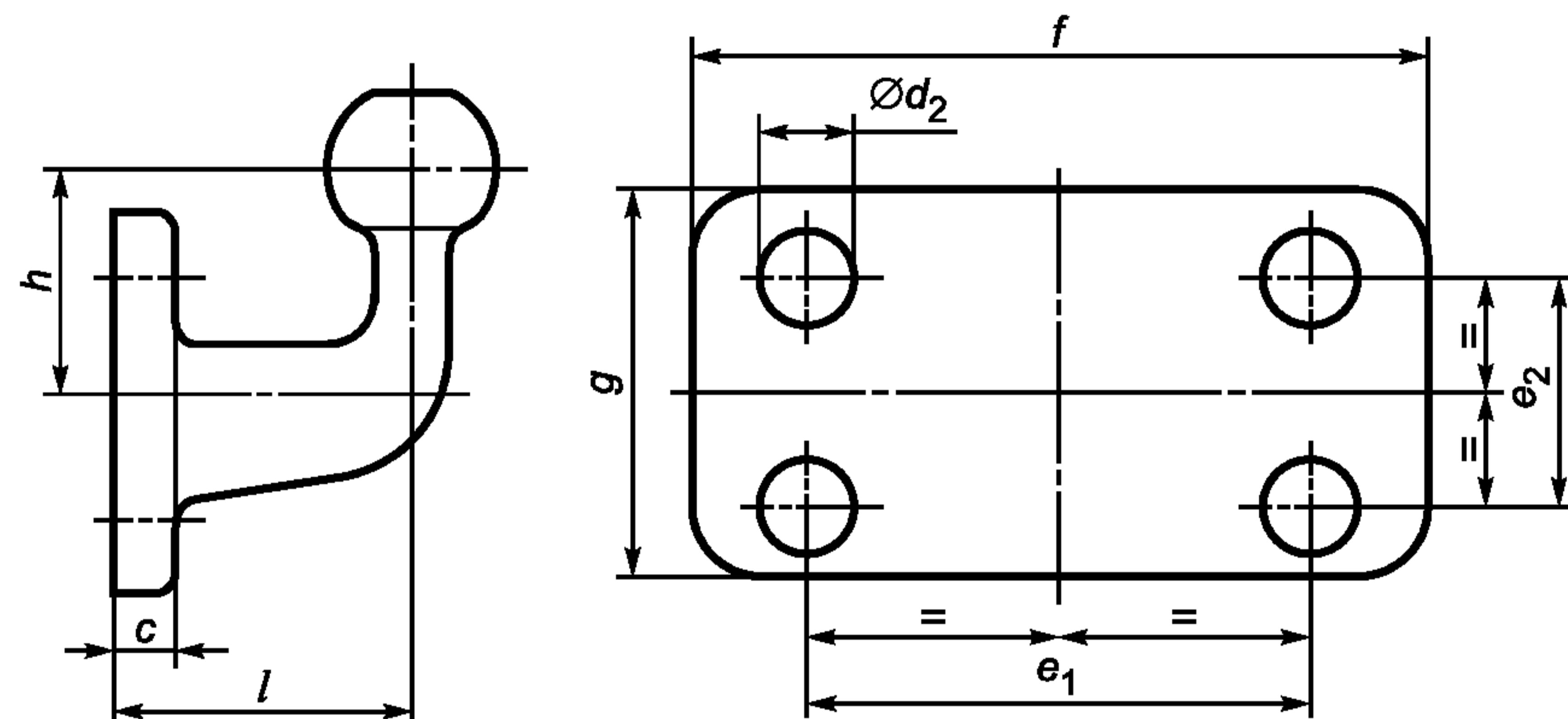
Рисунок 4 — Размеры стандартных фланцевых шаровых наконечников классов А50-2 — А50-5 (см. таблицу 6.1)
