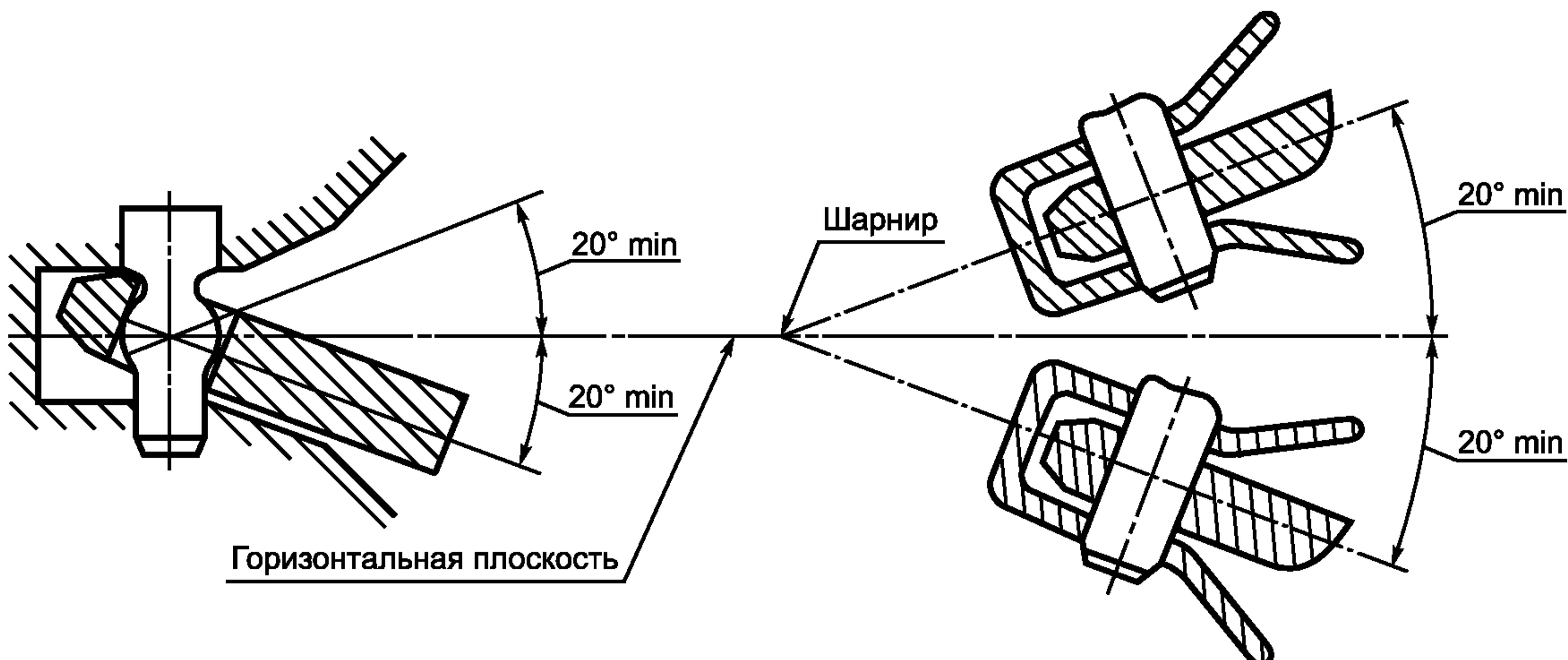
Рисунок 6 — Поворот сцепленной проушины сцепной тяги по вертикали
