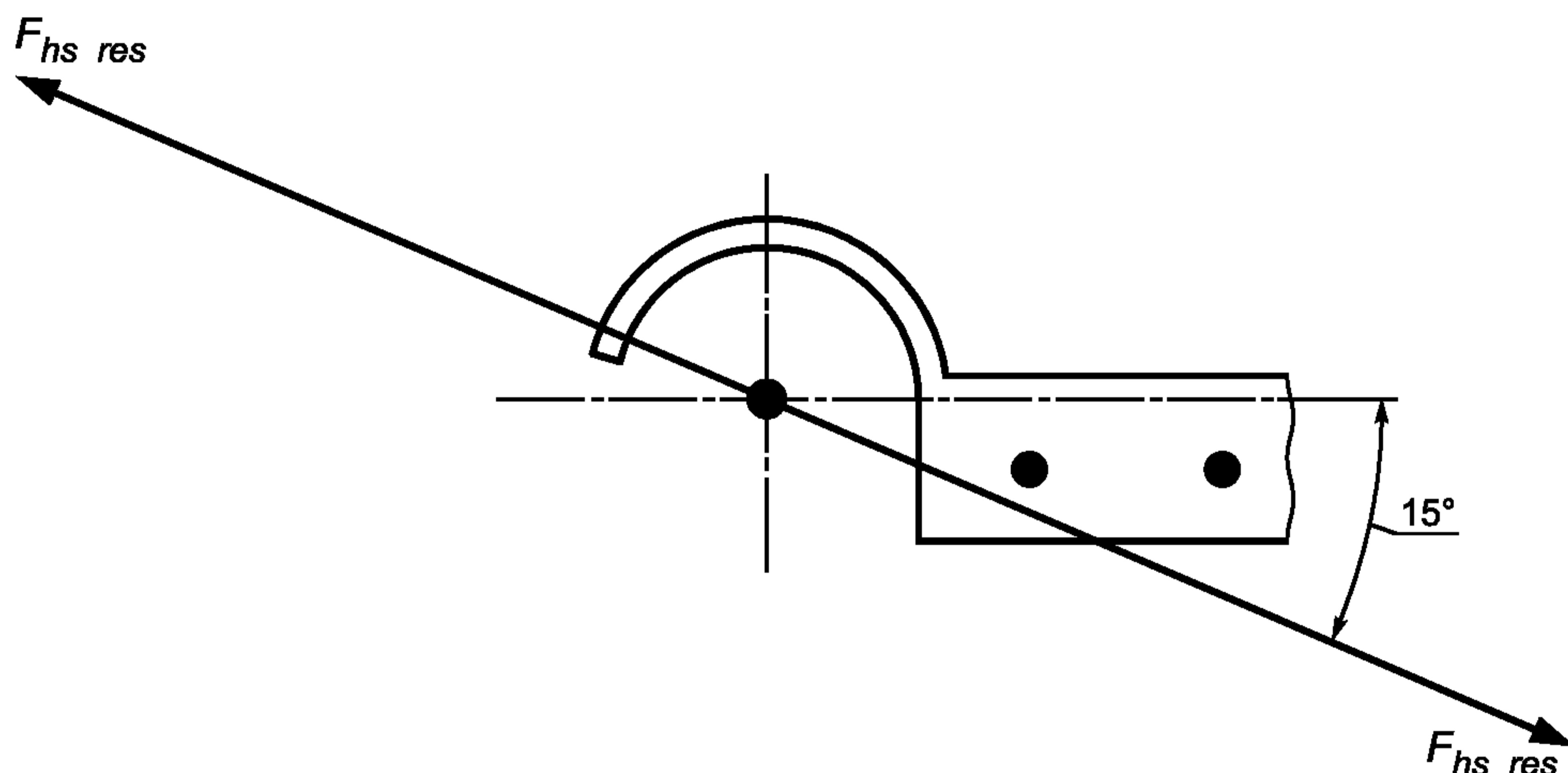
Рисунок 23 — Динамическое испытание
