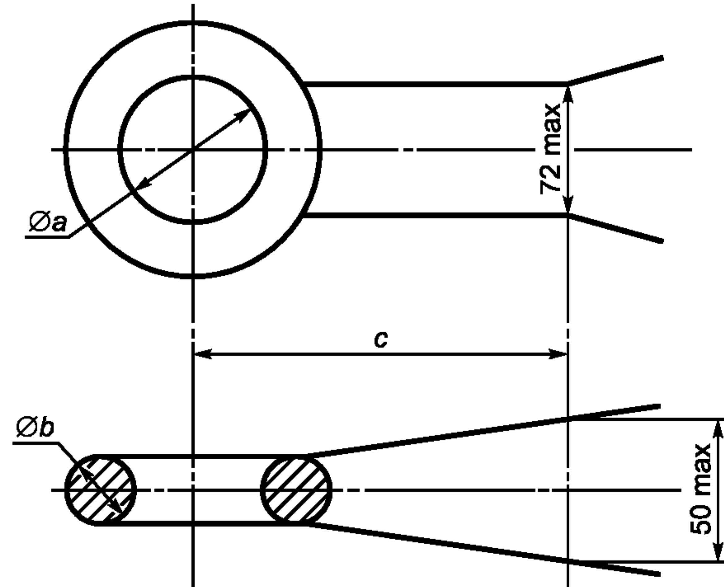
Рисунок 14 — Размеры торOIDальных проушин сцепных тяг класса L (см. таблицу 6.7)
