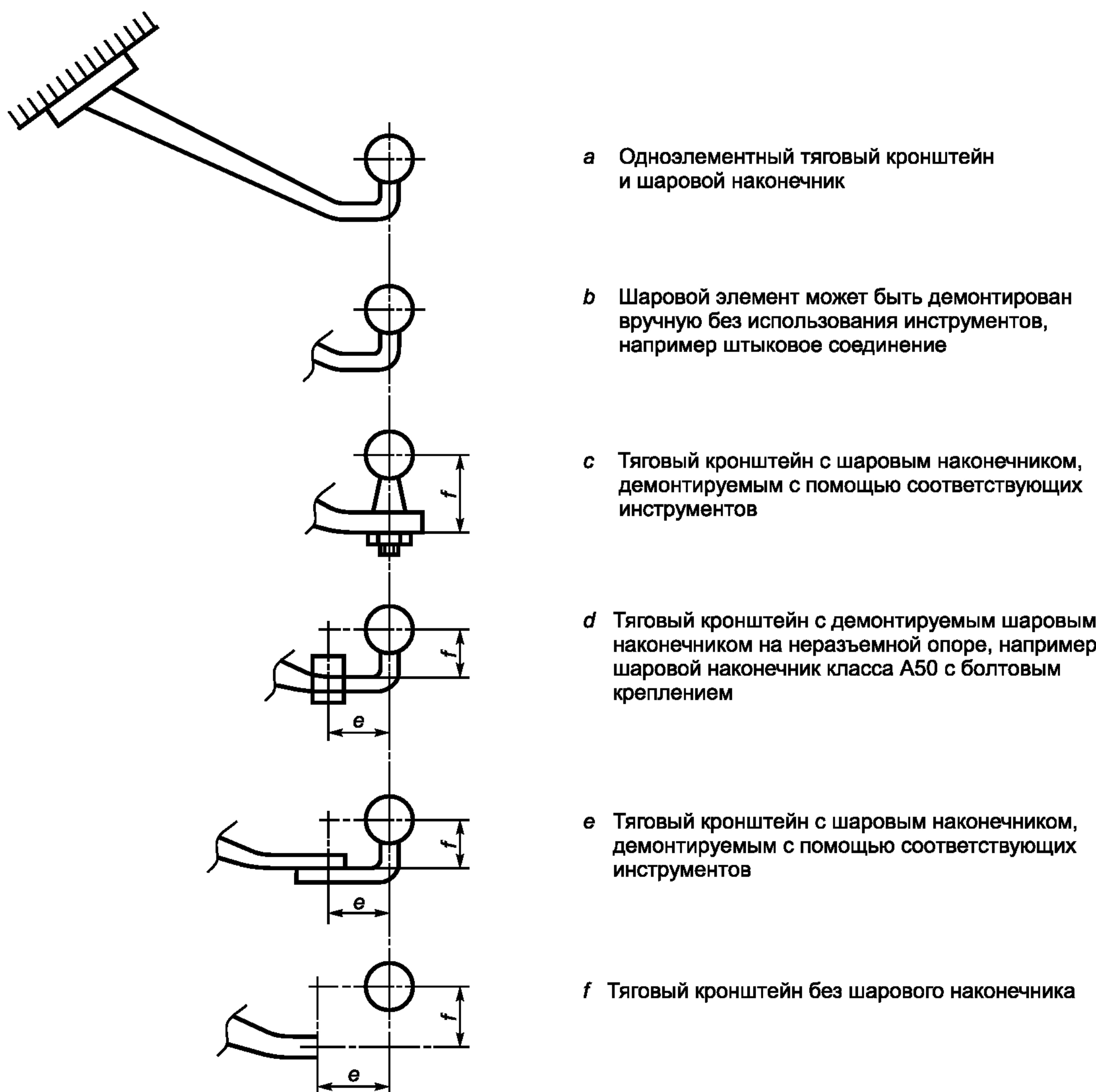
Рисунок 20 — Схема тяговых кронштейнов шарового типа
