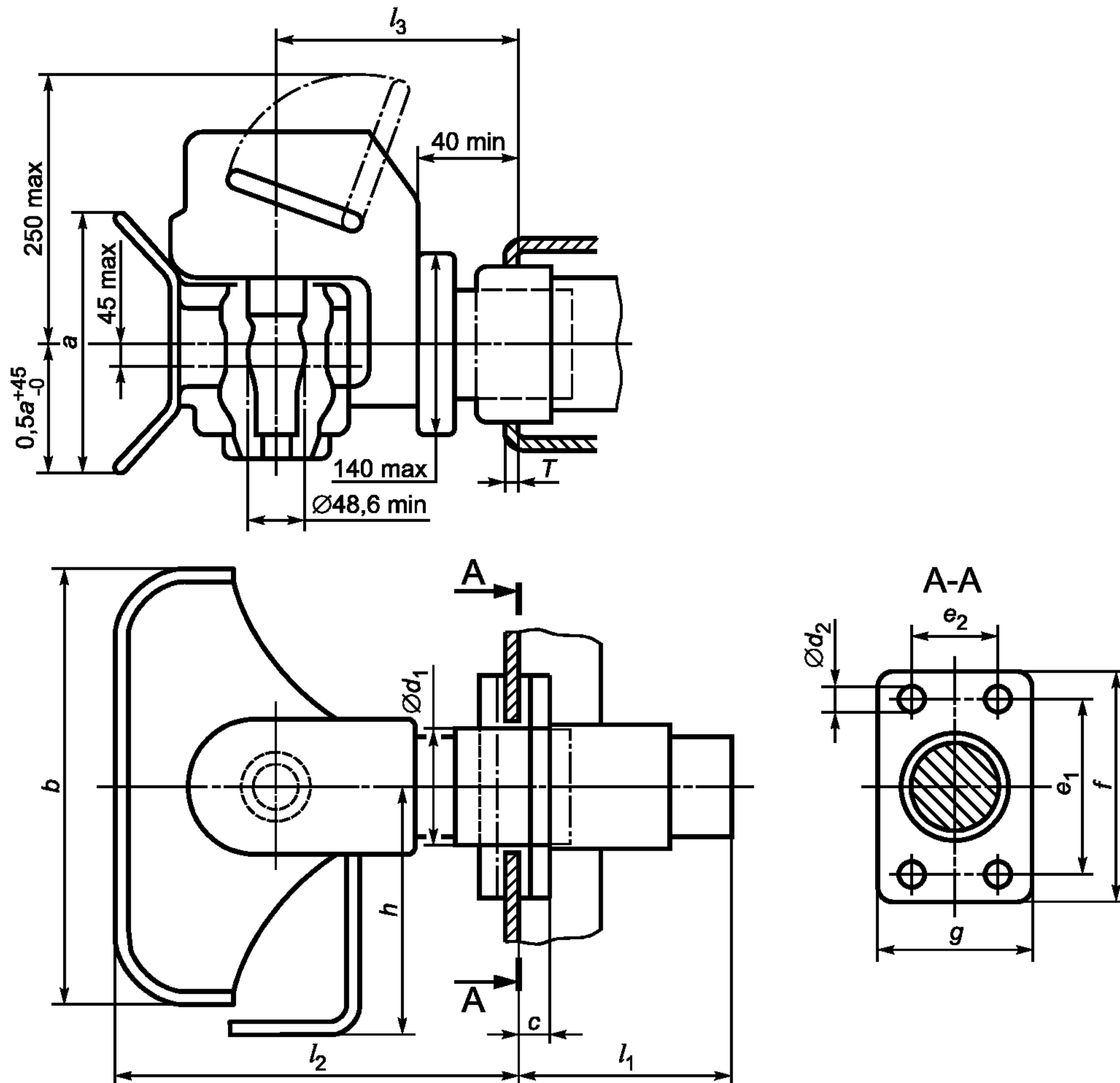
Рисунок 8 — Размеры стандартных соединительных фланцев сцепных тяг
