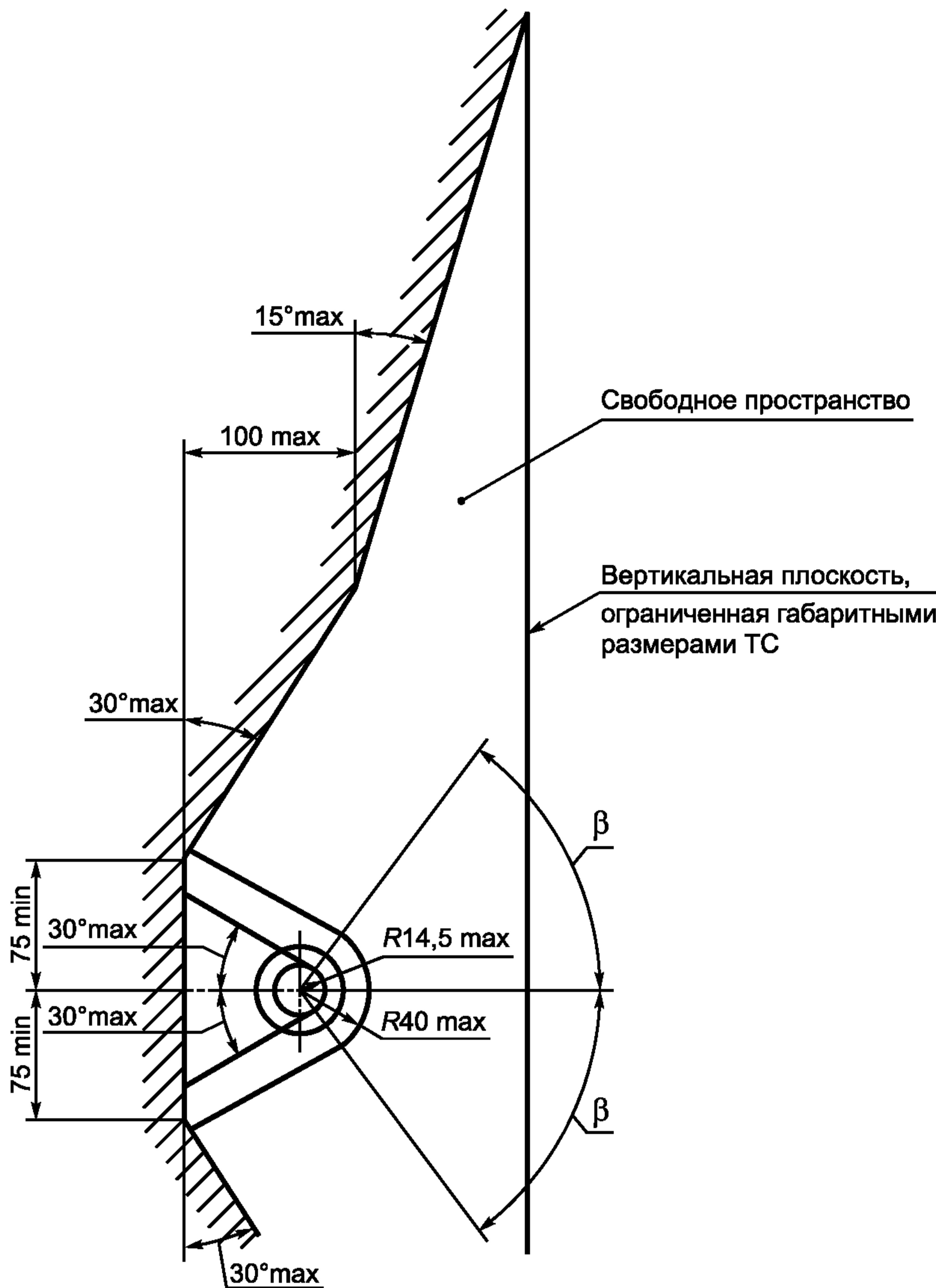
Рисунок 25б — Свободное пространство для шарового наконечника, вид в плане
