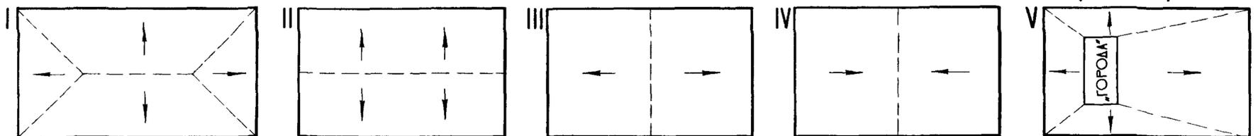
**ОТВОД ВОДЫ ИЗ КОНСТРУКЦИИ ПОЛОТНА**
