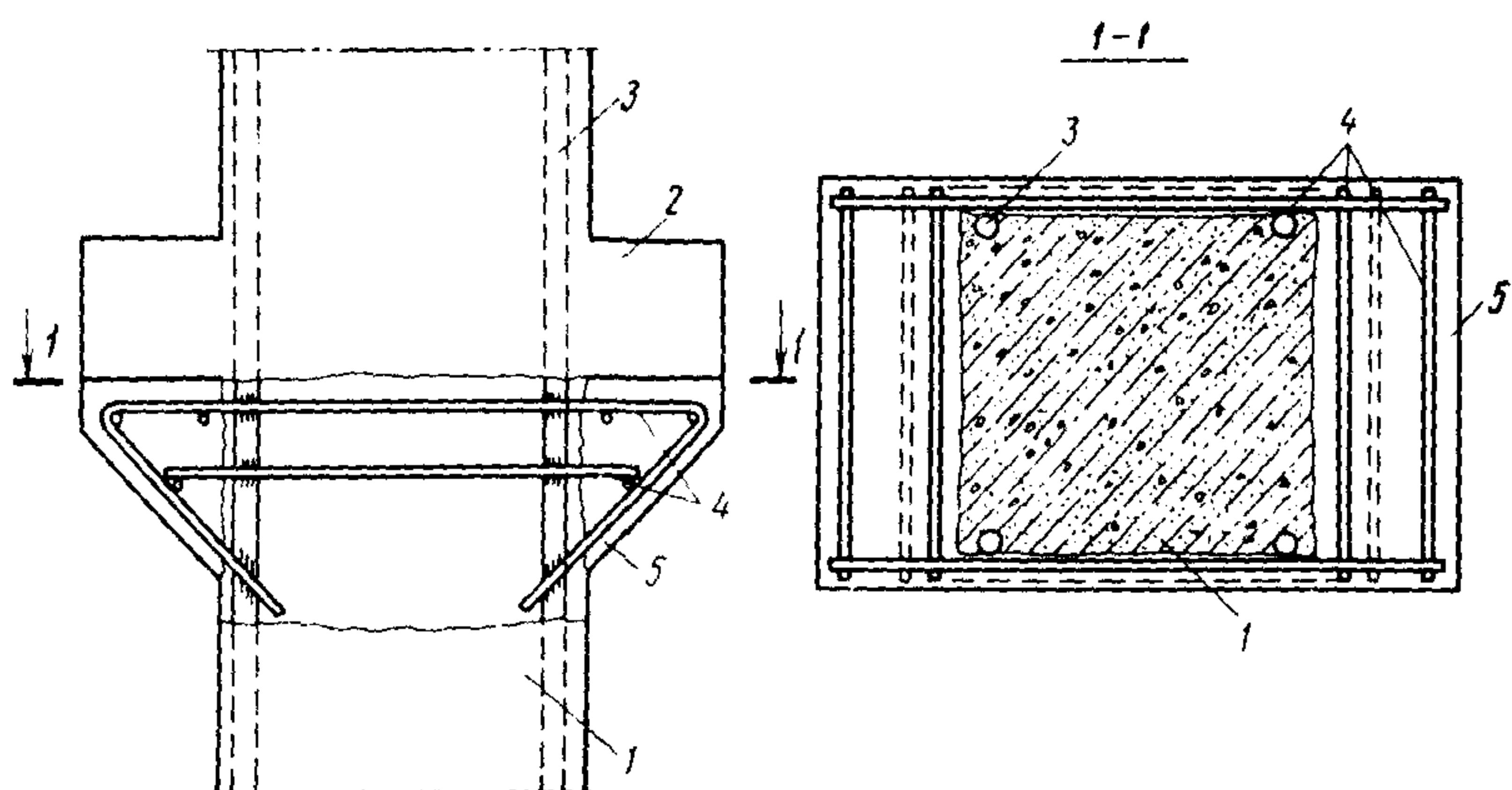
Рис. 6. Усиление консоли железобетонным хомутом
