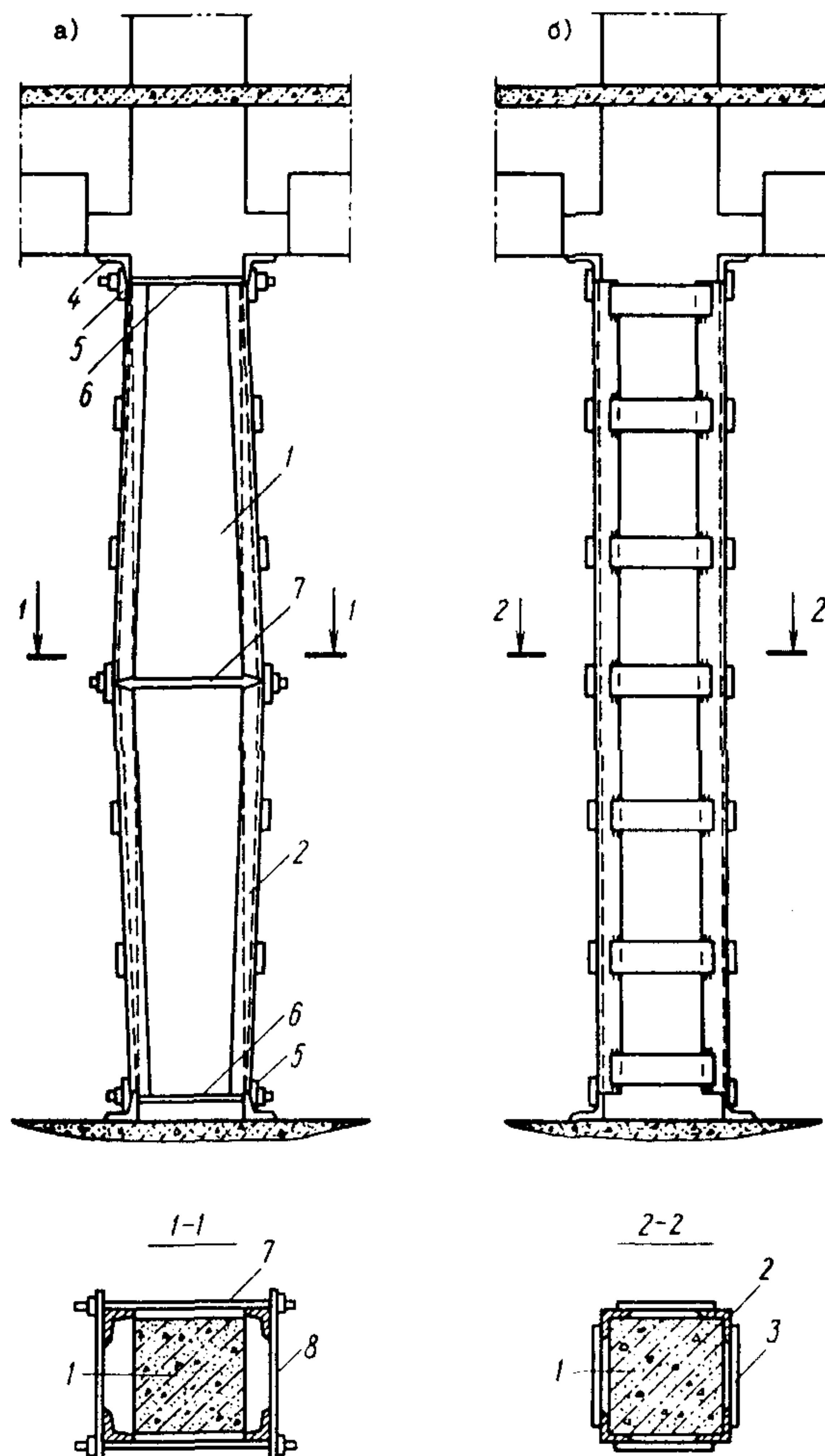
Рис. 7. Усиление колонны предварительно напряженными распорками
