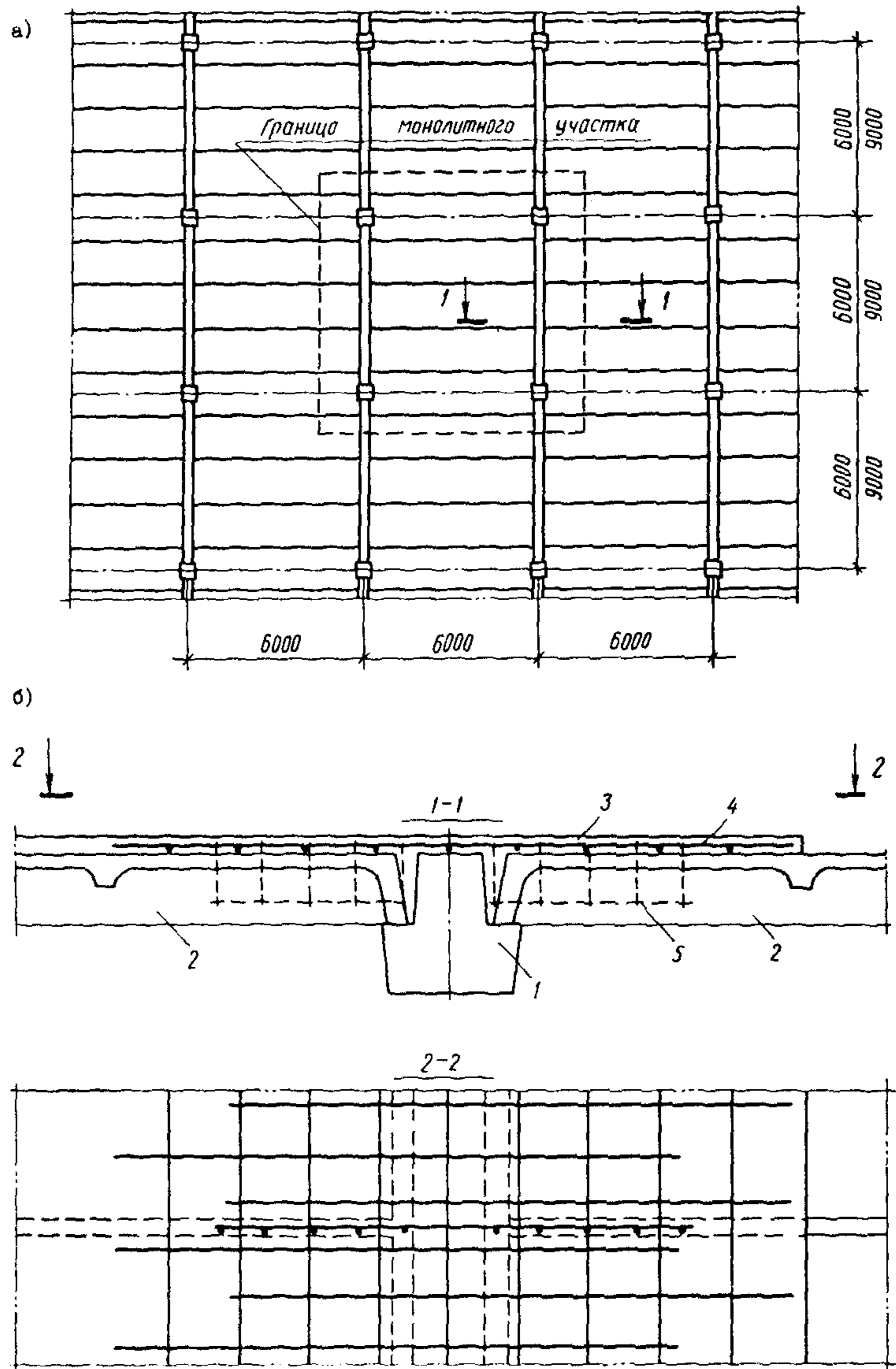
Рис. 1. Усиление ячейки перекрытия
