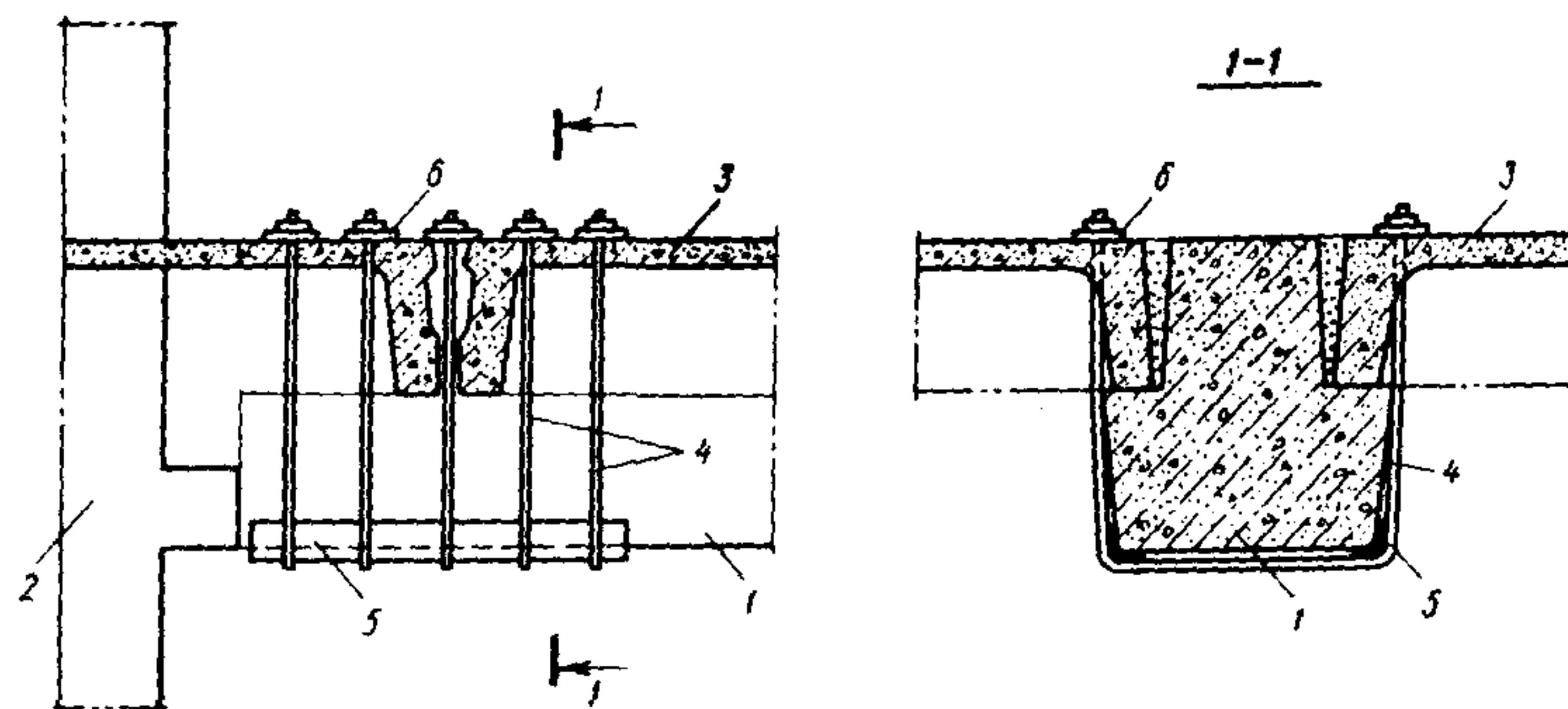
Рис. 5. Усиление ригеля на восприятие поперечных сил
