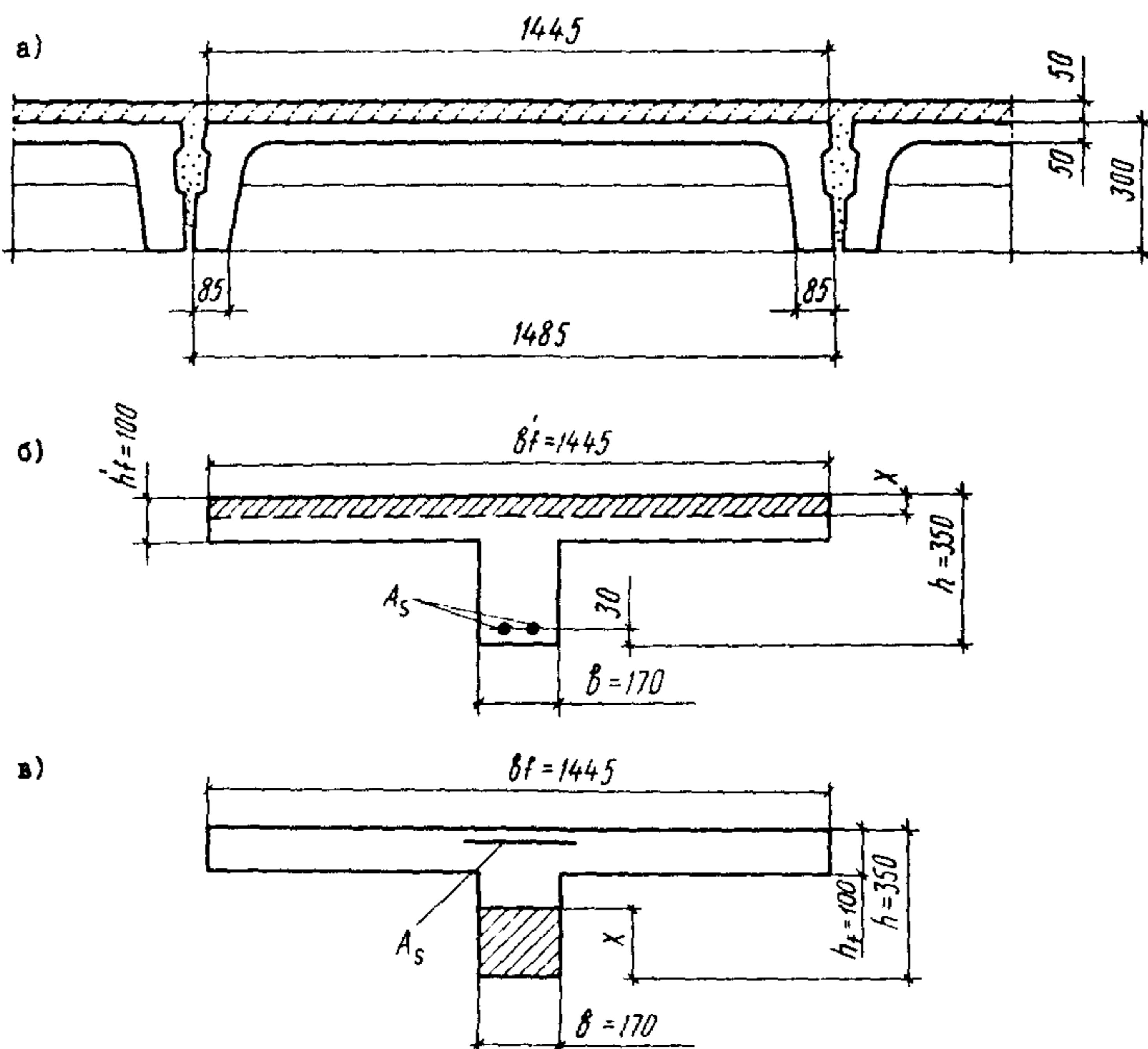
**Рис. 2. Поперечные расчетные сечения неразрезной ребристой плиты с усилением**
