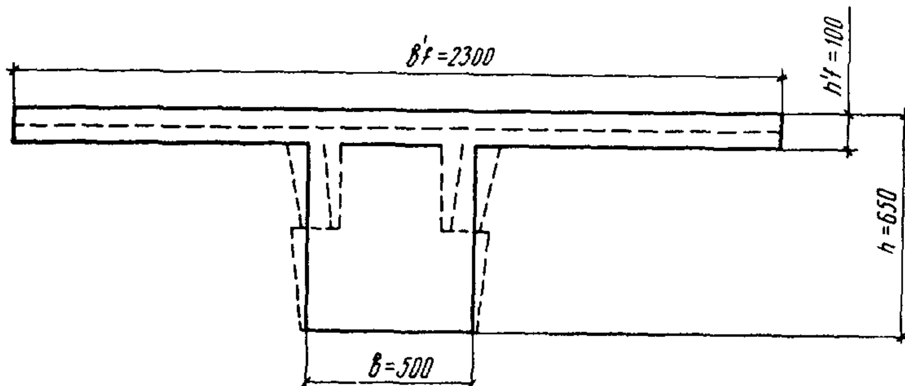
Рис. 4. Поперечное расчетное сечение ригеля с усилением
