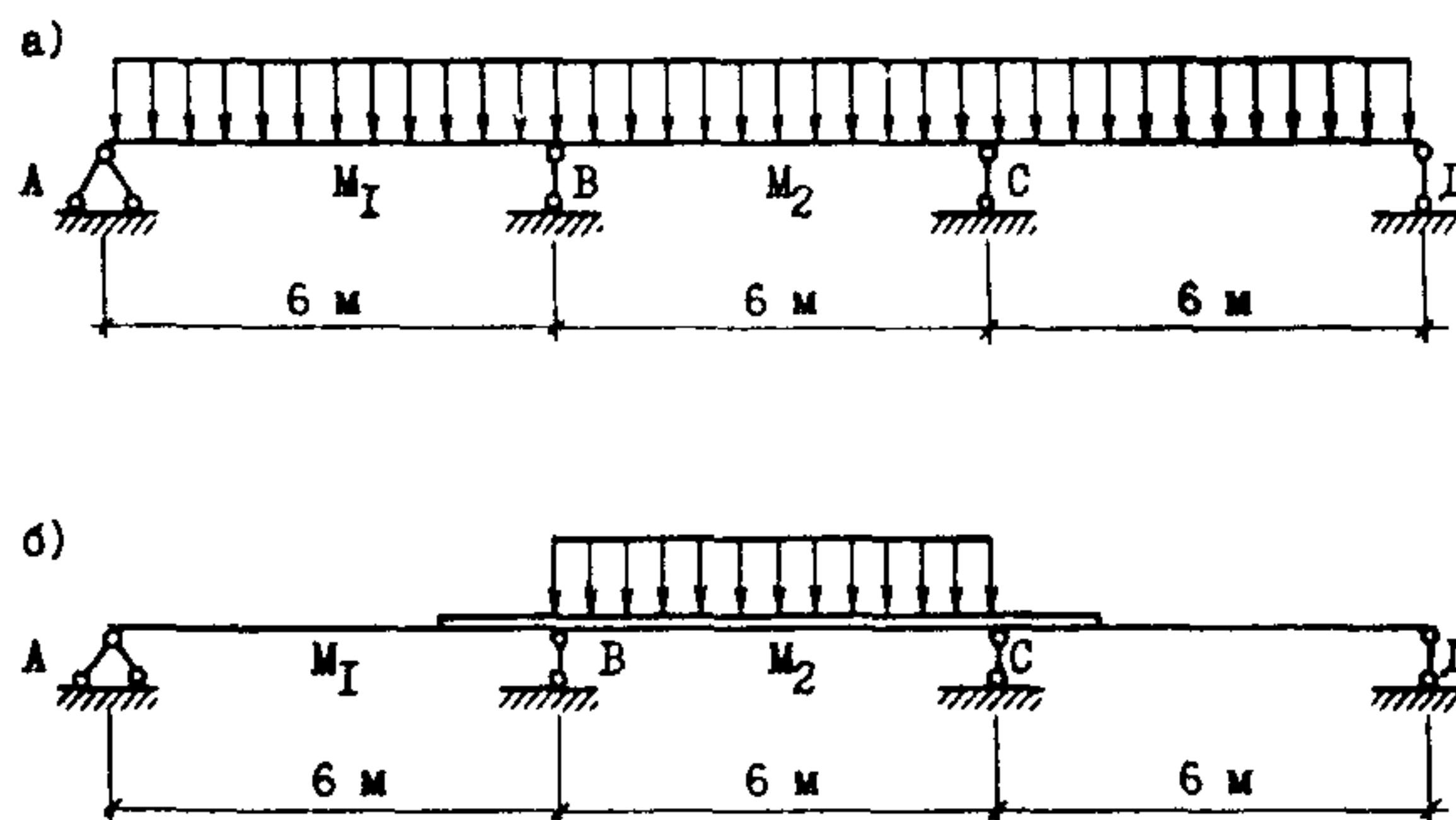
**Рис. 3. Схемы загружения неразрезных плит усиленного участка**
