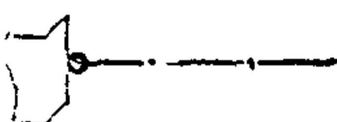
Защитный проводник, присоединяемый к корпусу электрооборудования
