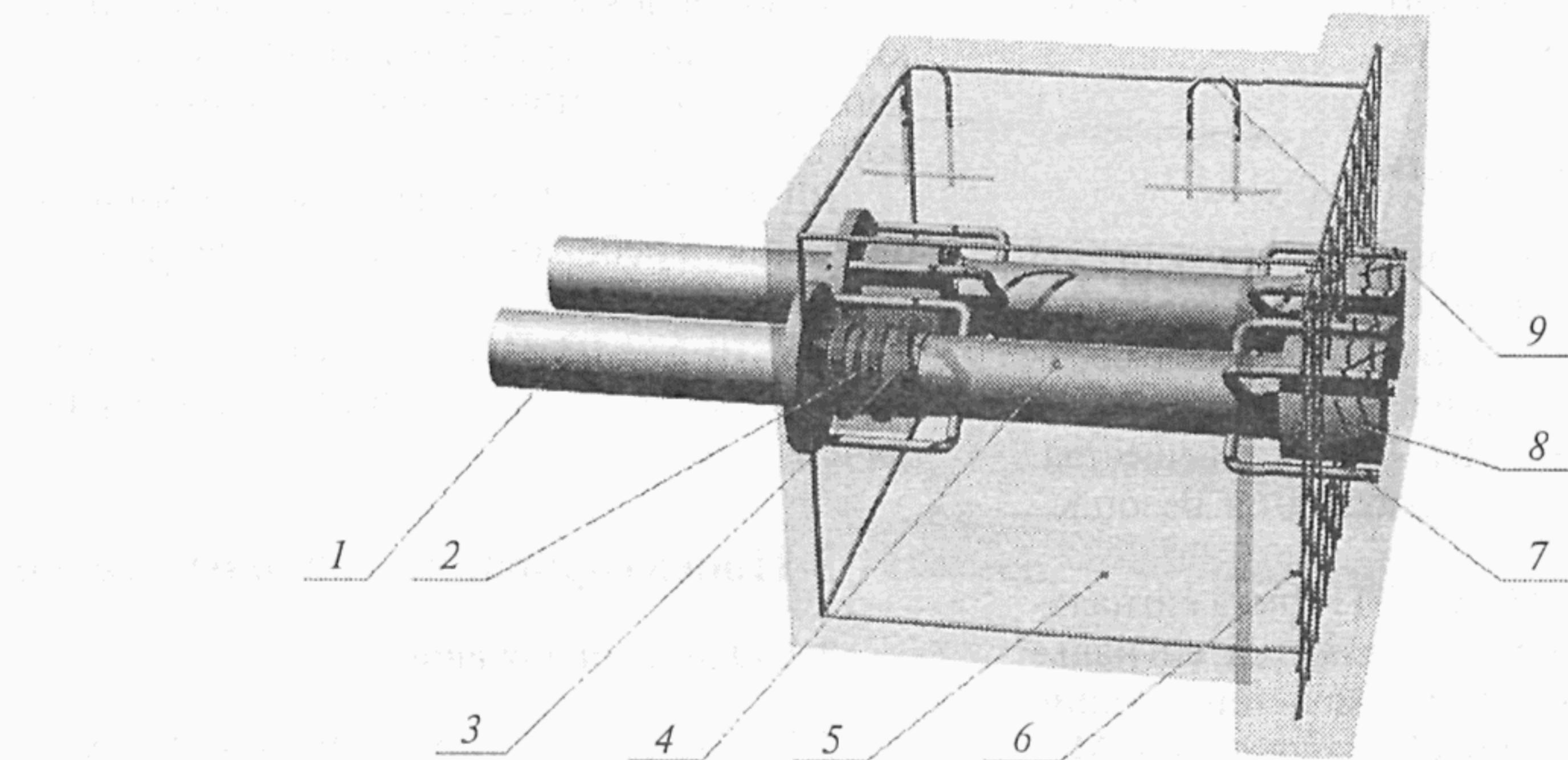
1 — стальная труба с фланцем; 2 — уплотнительное кольцо; 3 — наконечник; 4 — патрубок; 5 — бетонный монолит; 6 — арматурный каркас; 7 — кронштейн с гайкой; 8 — асбестоцементная муфта; 9 — проушина
