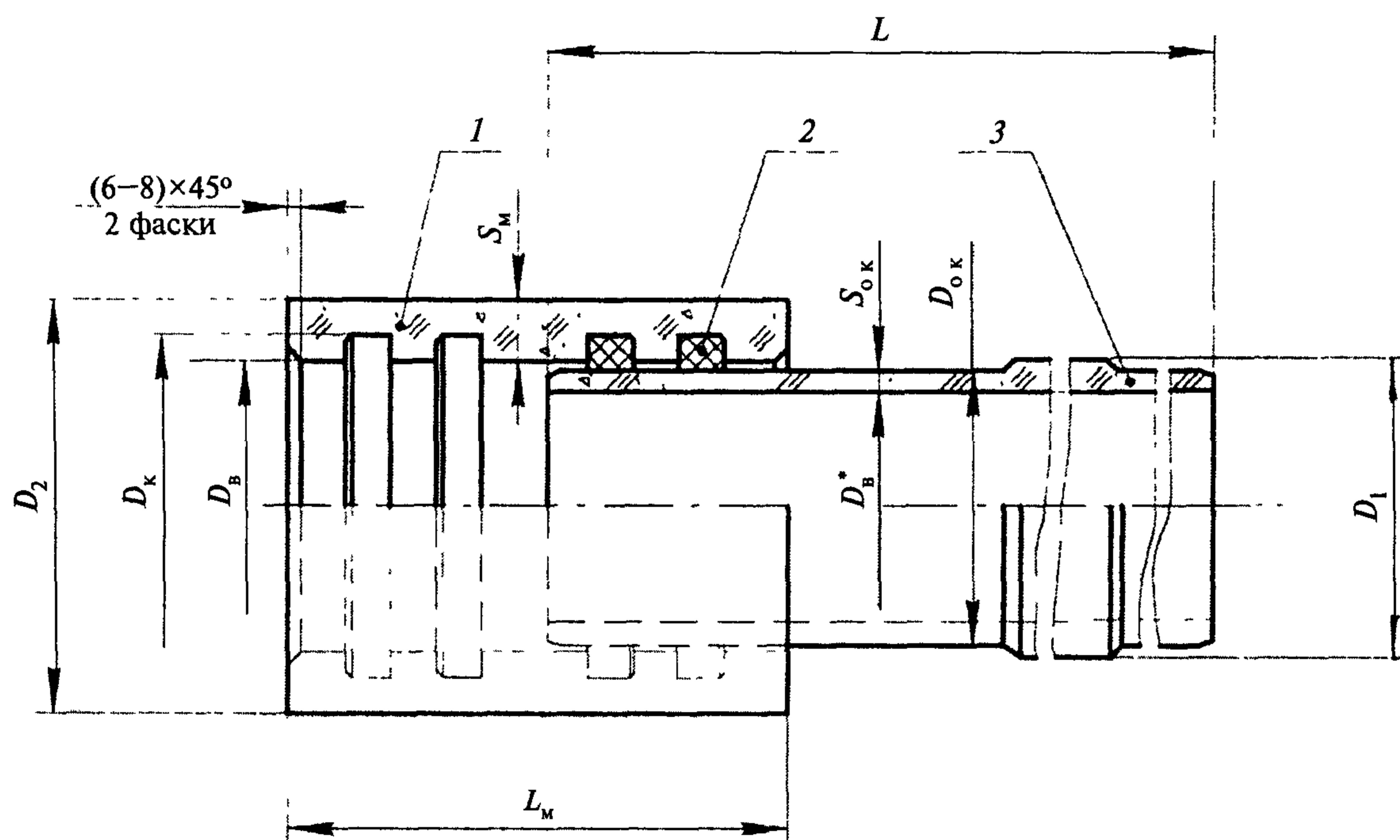
1 — муфта; 2 — кольцо; 3 — труба;  $D_k$  — диаметр канавки;  $D_b$  — внутренний диаметр муфты;  $D_2$  — наружный диаметр муфты;  $D_{o,k}$  — диаметр обточенного конца;  $S_m$  — толщина стенки муфты;  $L_m$  — длина муфты;  $D_1$  — наружный диаметр трубы;  $D_b^*$  — внутренний диаметр трубы;  $S_{o,k}$  — толщина стенки трубы по обточенному концу;  $L$  — длина трубы
