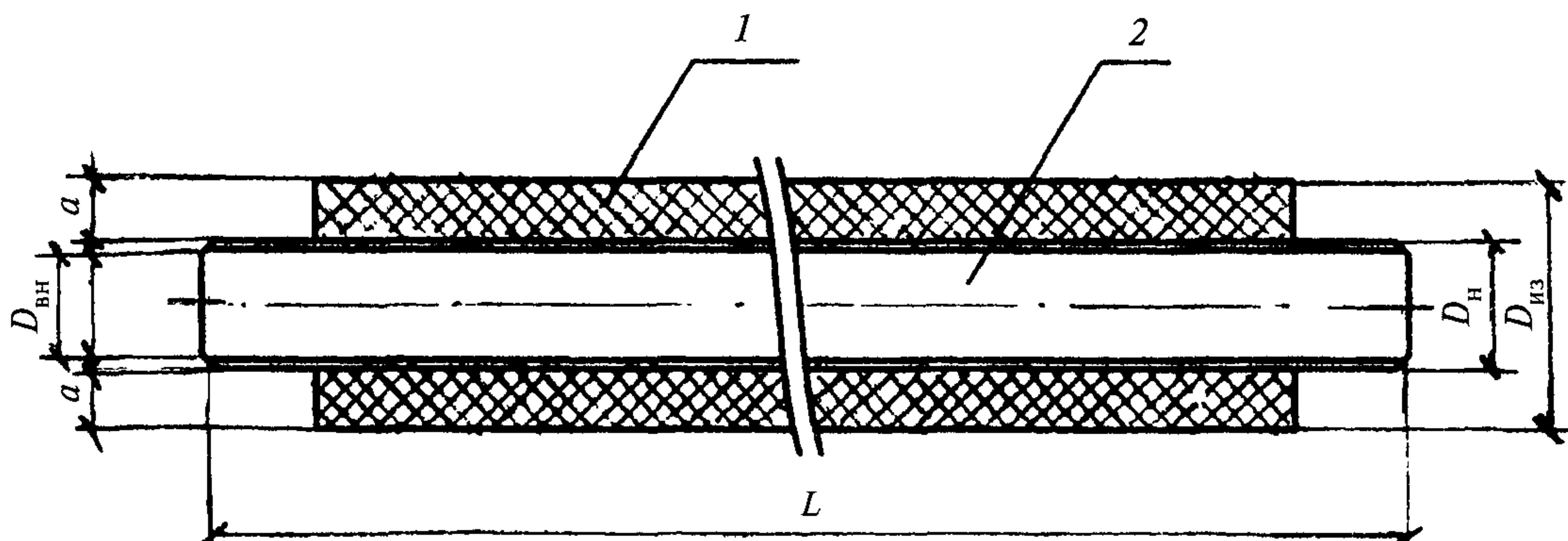
1 — изоляция из ППМ; 2 — асбестоцементная труба;  $D_{вн}$  — внутренний диаметр трубы;  $D_h$  — наружный диаметр трубы;  $D_{из}$  — внешний диаметр изоляции;  $L$  — длина трубы;  $a$  — толщина изоляции
