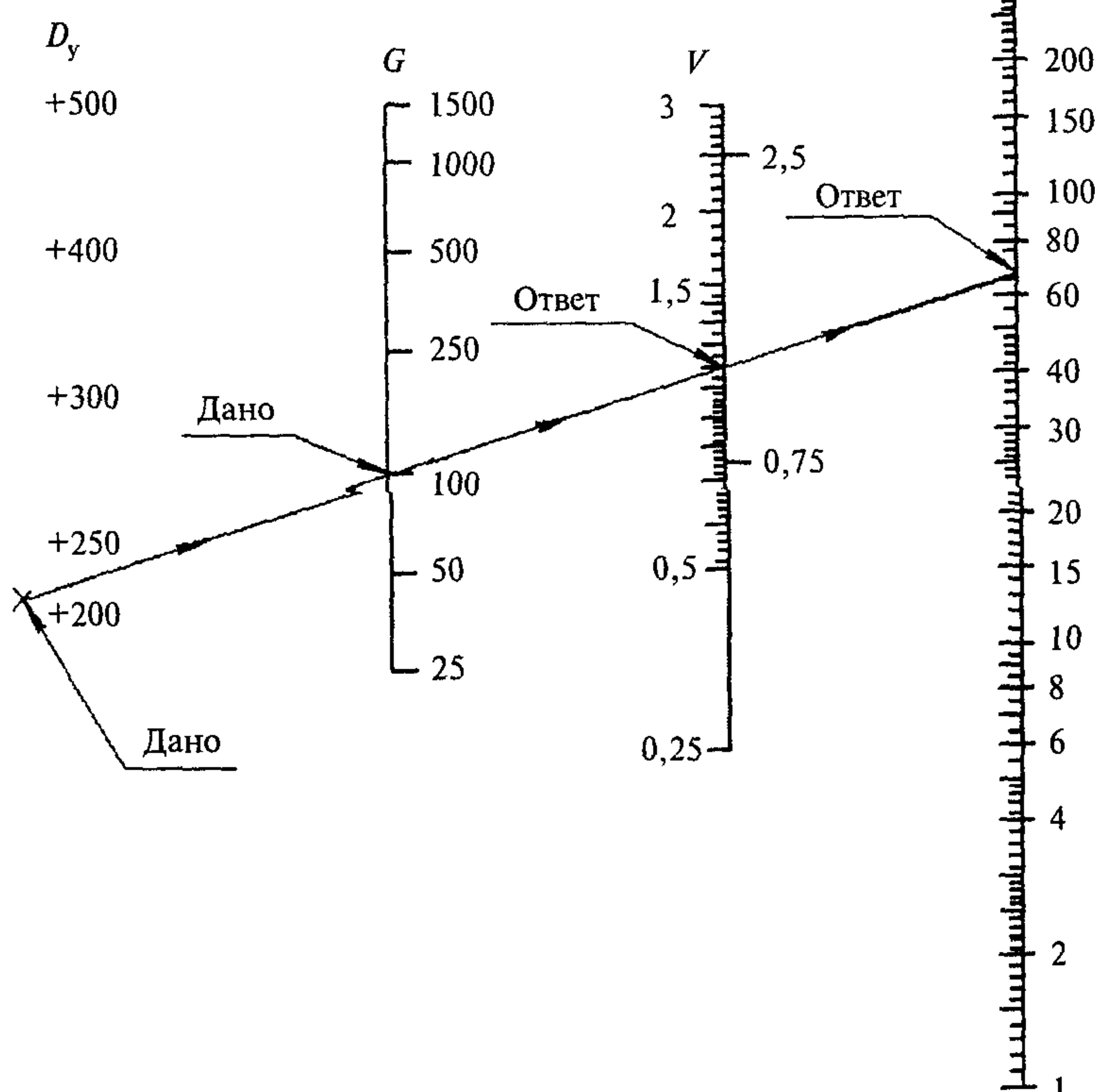
$D_y$  — условный диаметр труб, мм;  $G$  — расход теплоносителя, кг/ч;  $V$  — средняя скорость теплоносителя, м/с;  $P_y$  — удельное падение давления, Па/м
