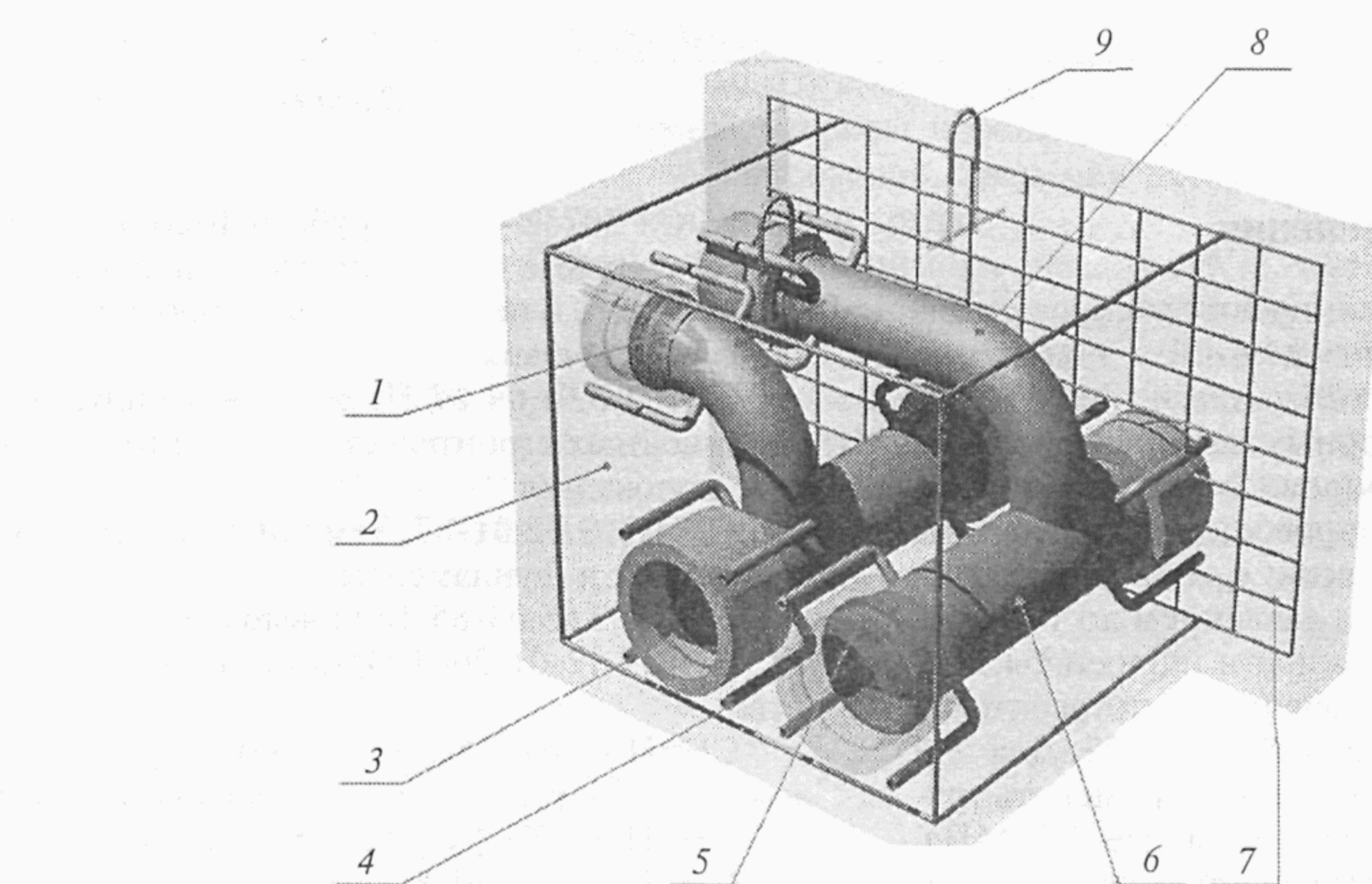
1 — наконечник; 2 — бетонный монолит; 3 — асбестоцементная муфта; 4 — кронштейн с гайкой; 5 — уплотнительное кольцо; 6 — патрубок; 7 — арматурный каркас; 8 — стальной отвод; 9 — проушина
